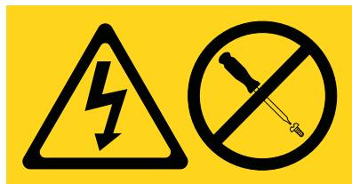
**OPASNOST:** Unutar svake komponente na kojoj se nalazi ovakva naljepnica su prisutne rizične razine napona, električnog toka i energije. Ne otvarajte nikakav poklopac ili pretinac koji ima ovu naljepnicu. (L001)
