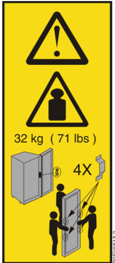
Figure 99. Poids de l'échangeur de chaleur et poignées de levage
