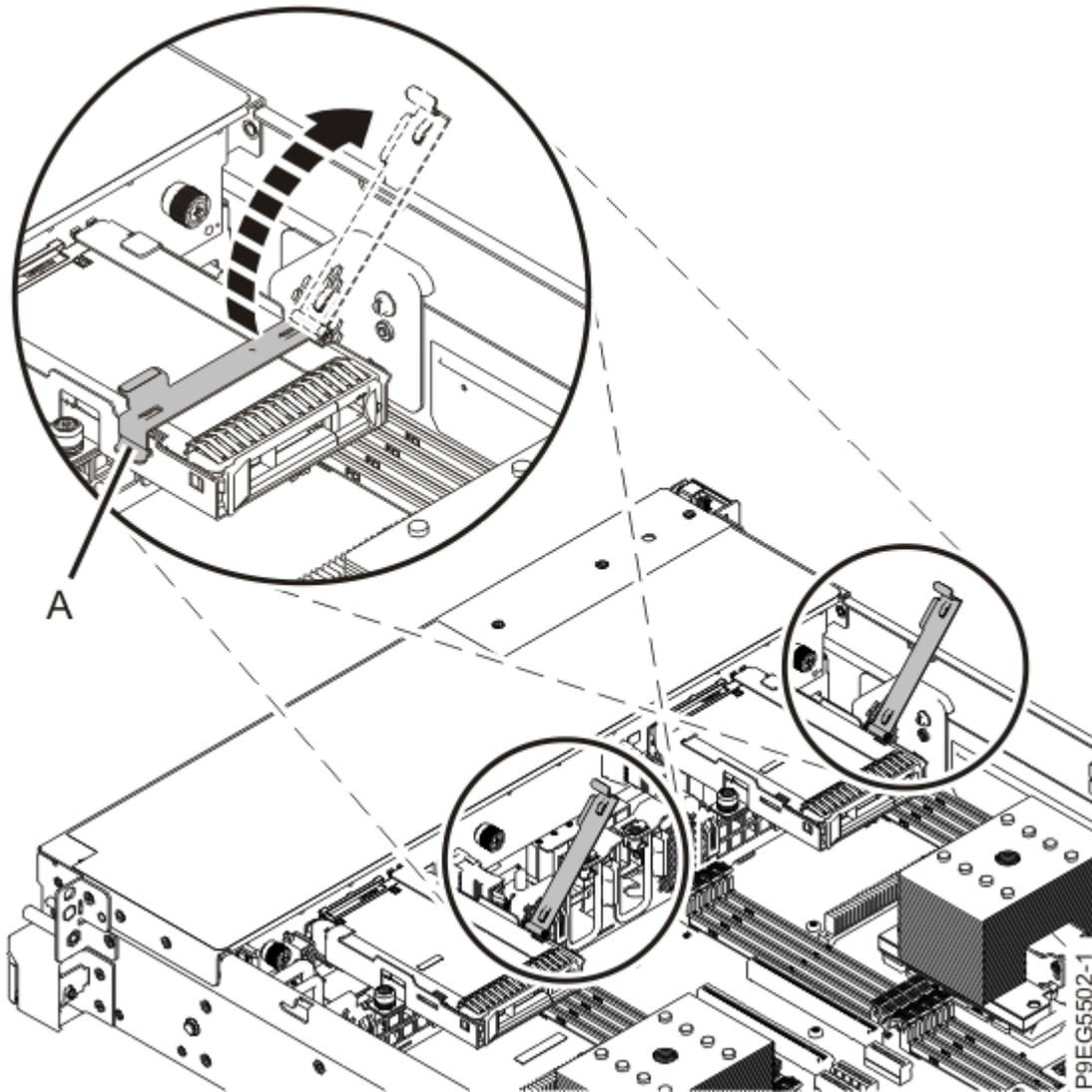
Figure 49. Ouverture du levier de maintien du disque
