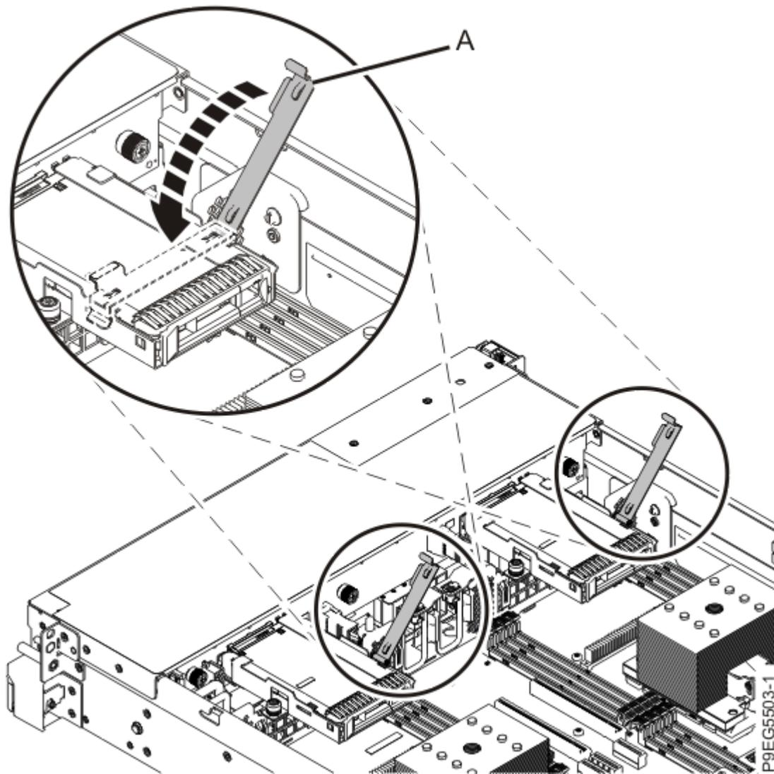
Figure 64. Fermeture du levier de maintien du disque
