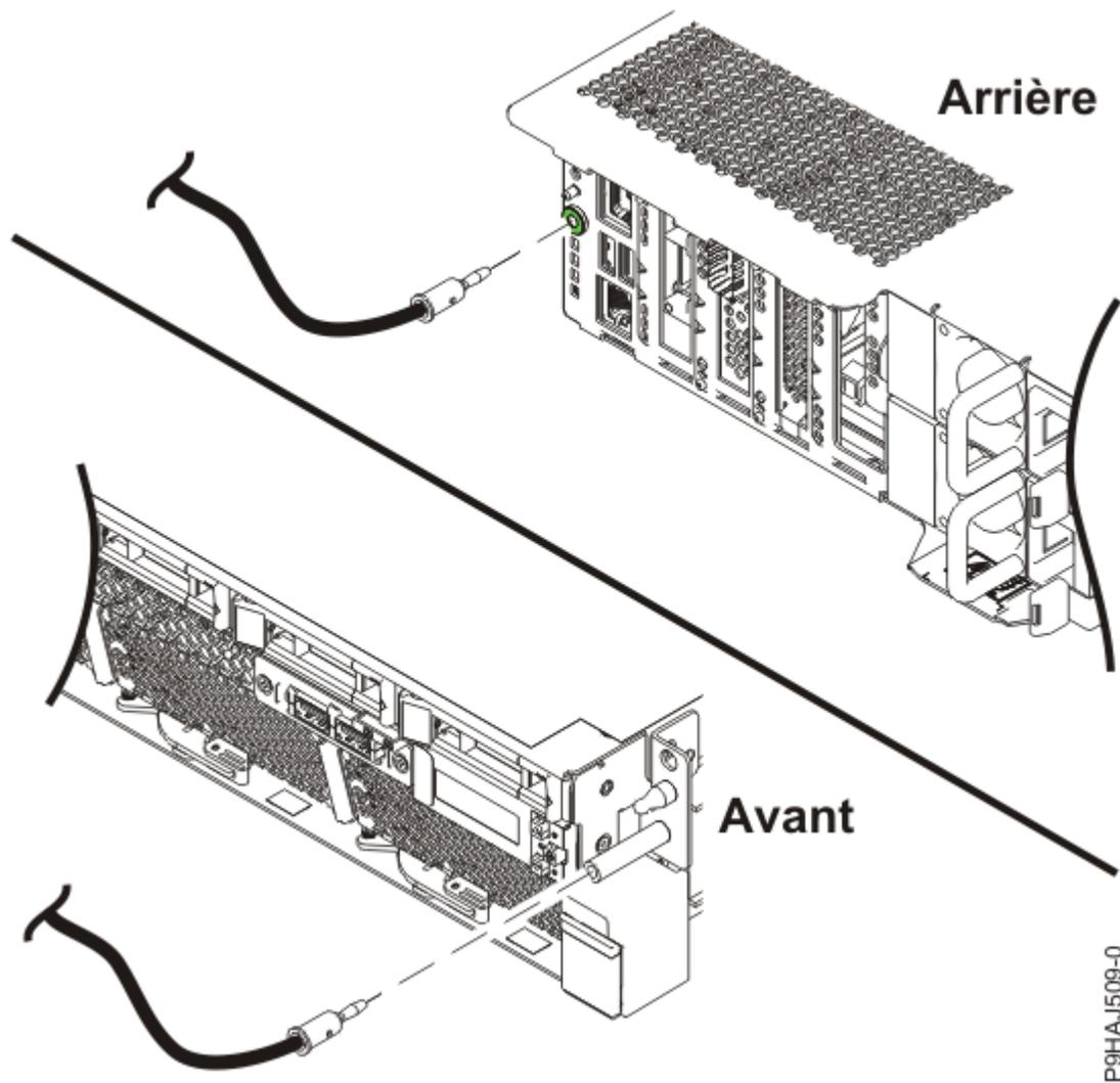
Figure 41. Emplacement des fiches de décharge électrostatique sur un système 9008-22L, 9009-22A ou 9223-22H
