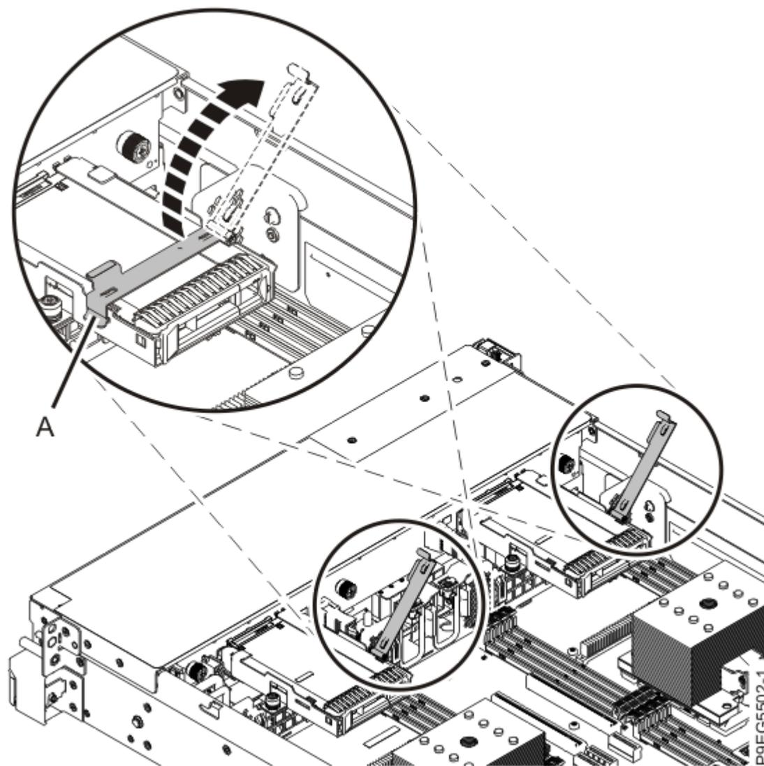
Figure 27. Ouverture du levier de maintien du disque
