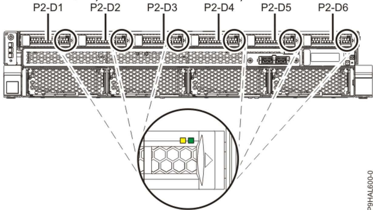
*Figure 79. Emplacements des unités de disque avant et des voyants d'activité d'un système 9008-22L, 9009-22A ou 9223-22H*
