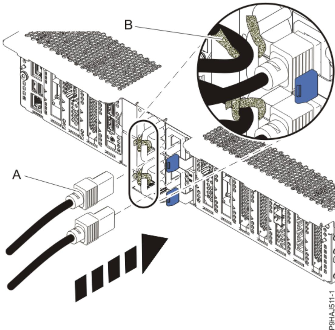
Figure 35. Connexion des cordons d'alimentation
