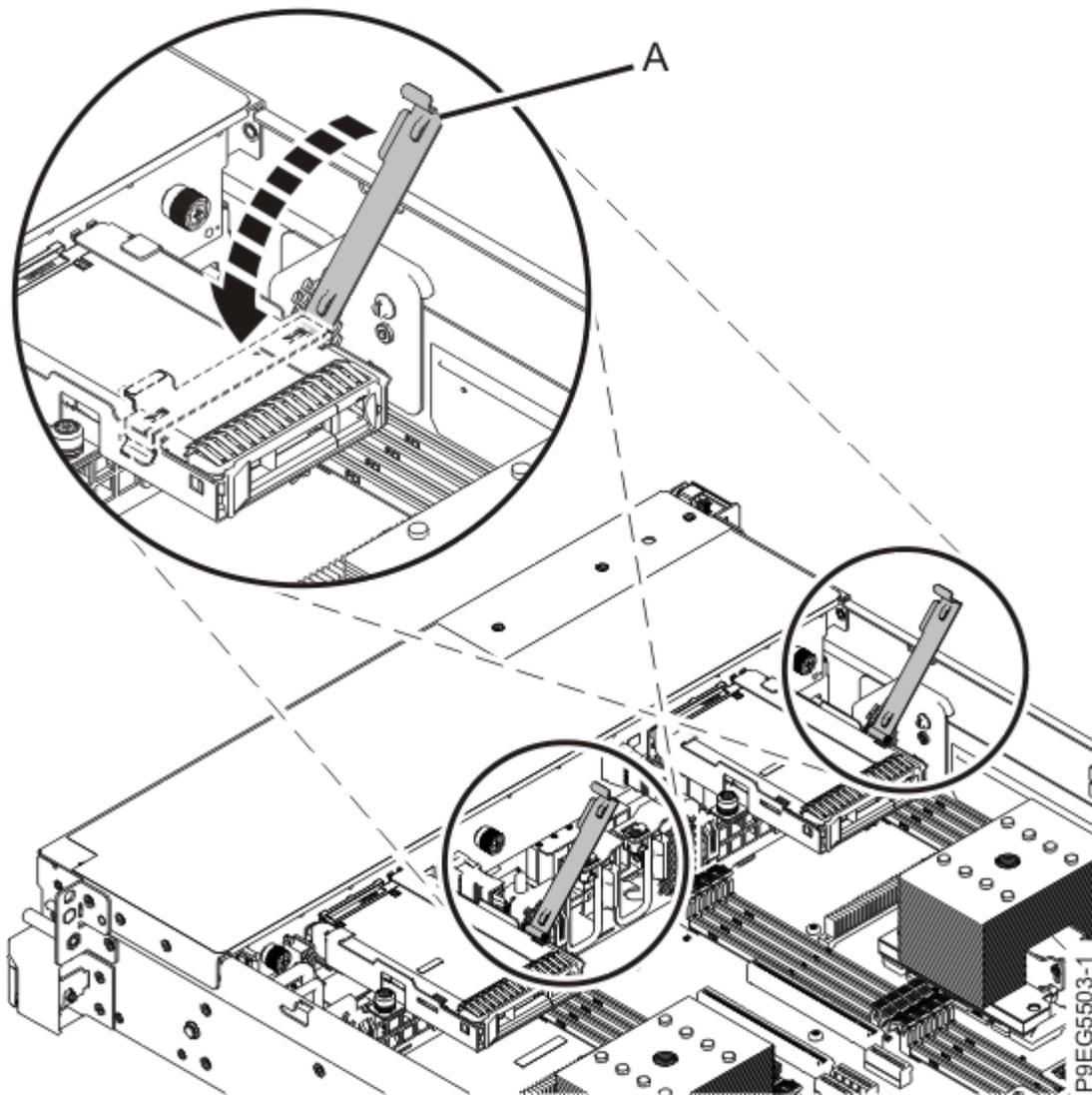
Figure 72. Fermeture du levier de maintien du disque
