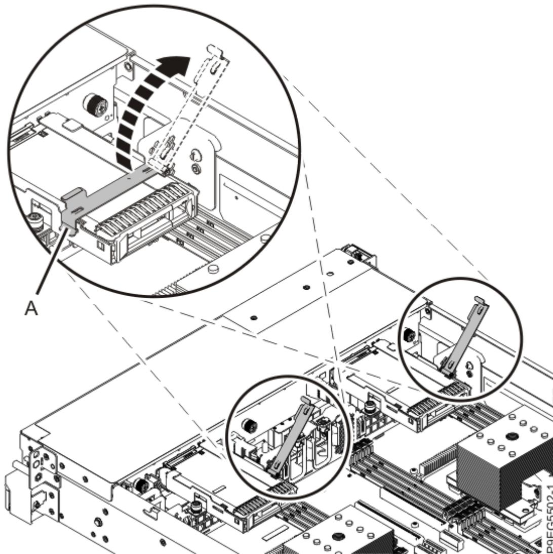
Figure 85. Ouverture du levier de maintien du disque
