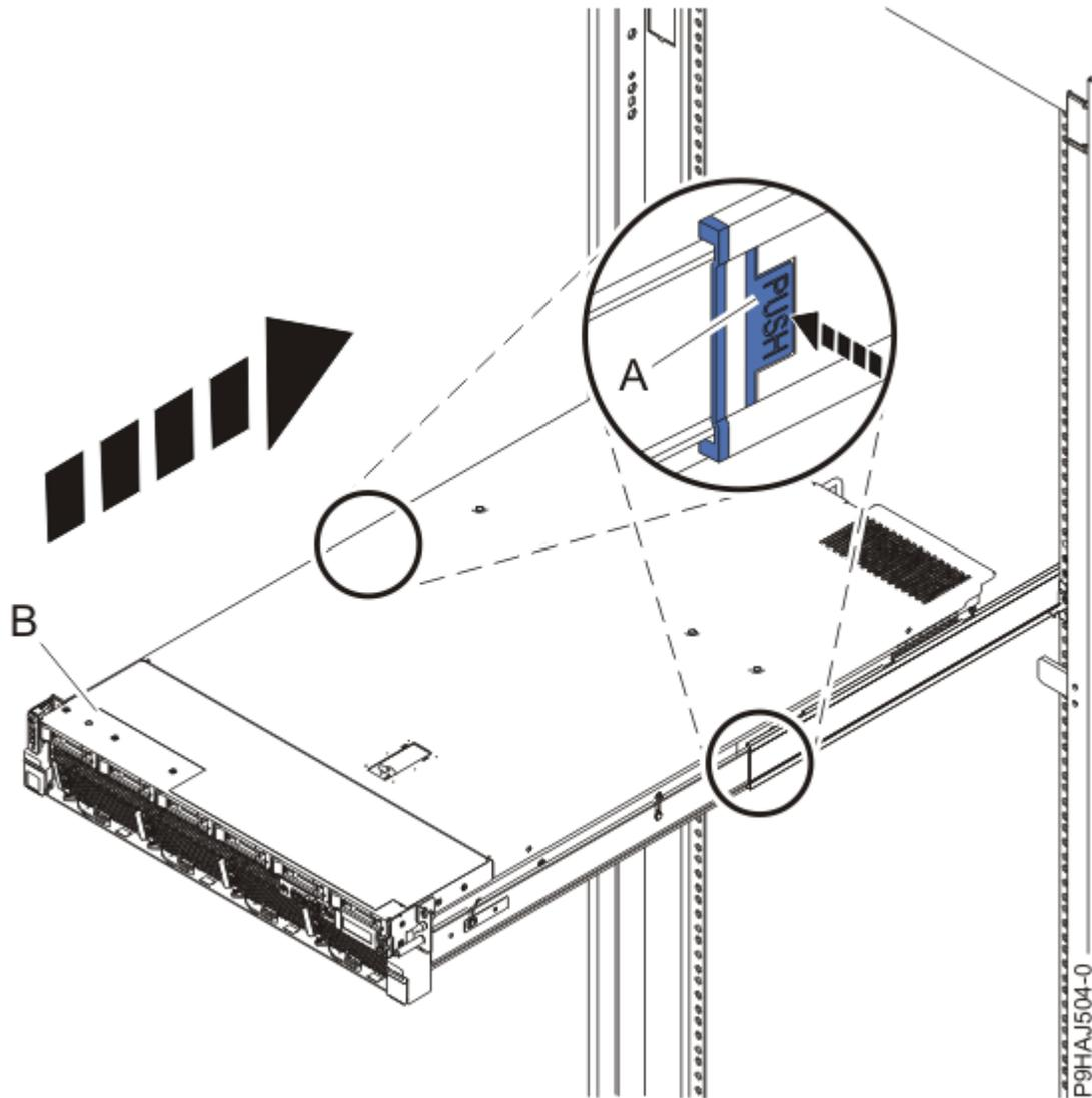
Figure 34. Mise en position de fonctionnement du système
