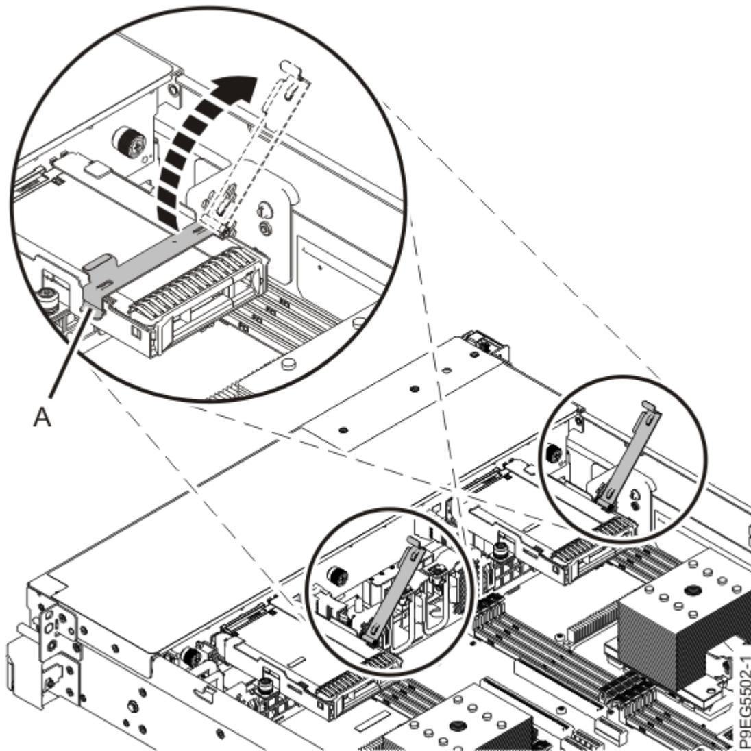
Figure 17. Ouverture du levier de maintien du disque
