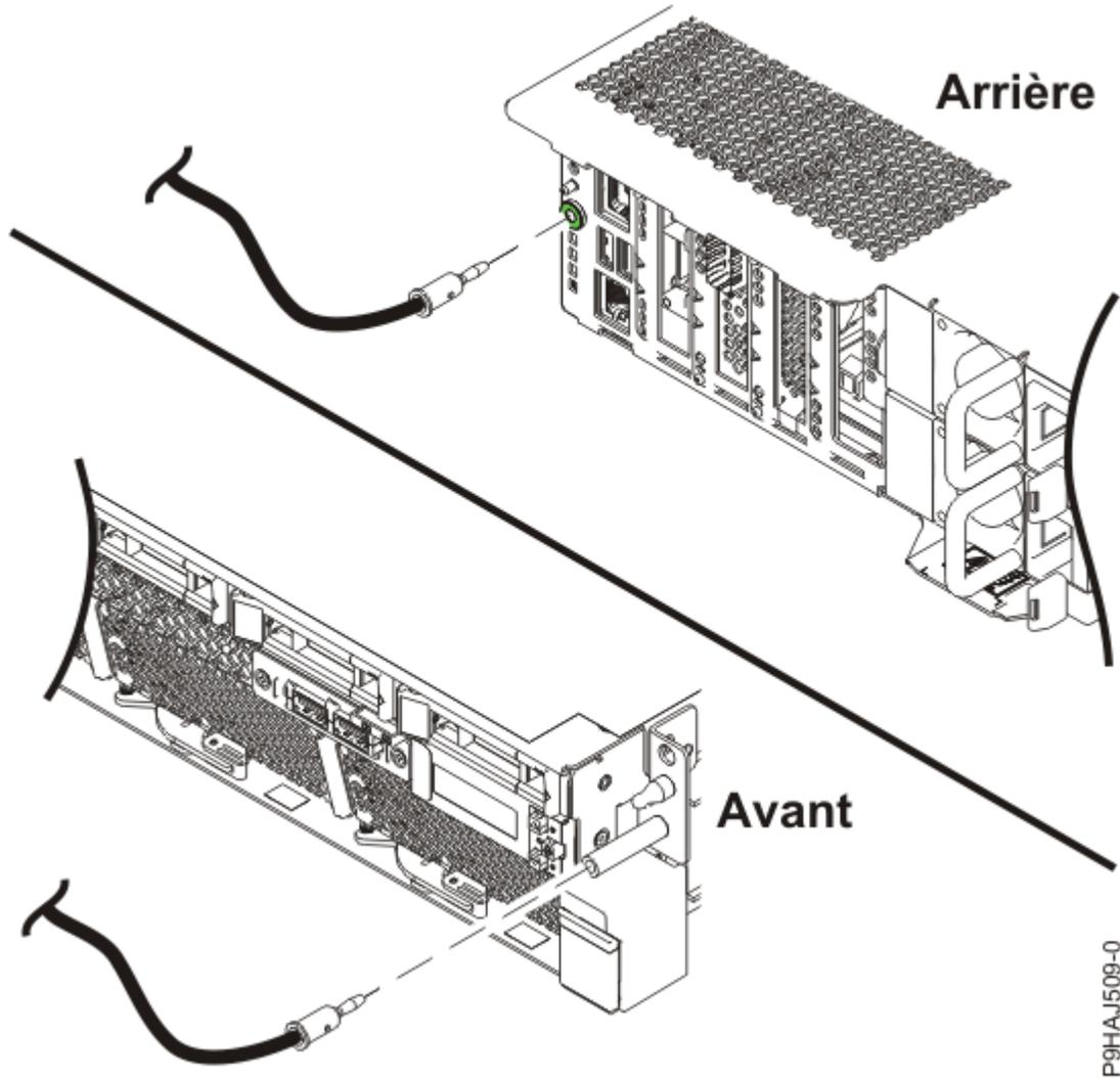
Figure 9. Emplacement des fiches de décharge électrostatique sur un système 9008-22L, 9009-22A ou 9223-22H
