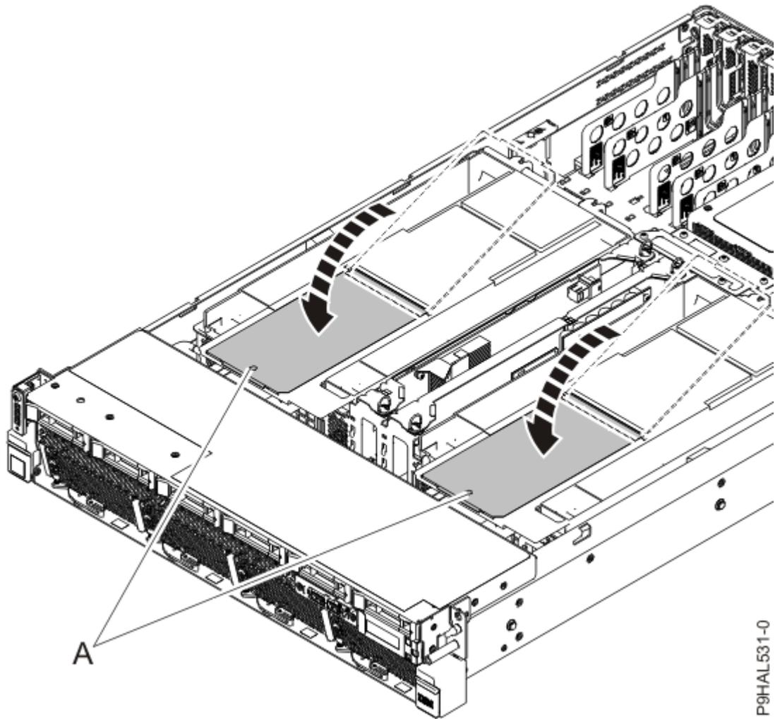
Figure 91. Fermeture des trappes d'accès articulées sur les déflecteurs d'air dans le système 9008-22L, 9009-22A ou 9223-22H
