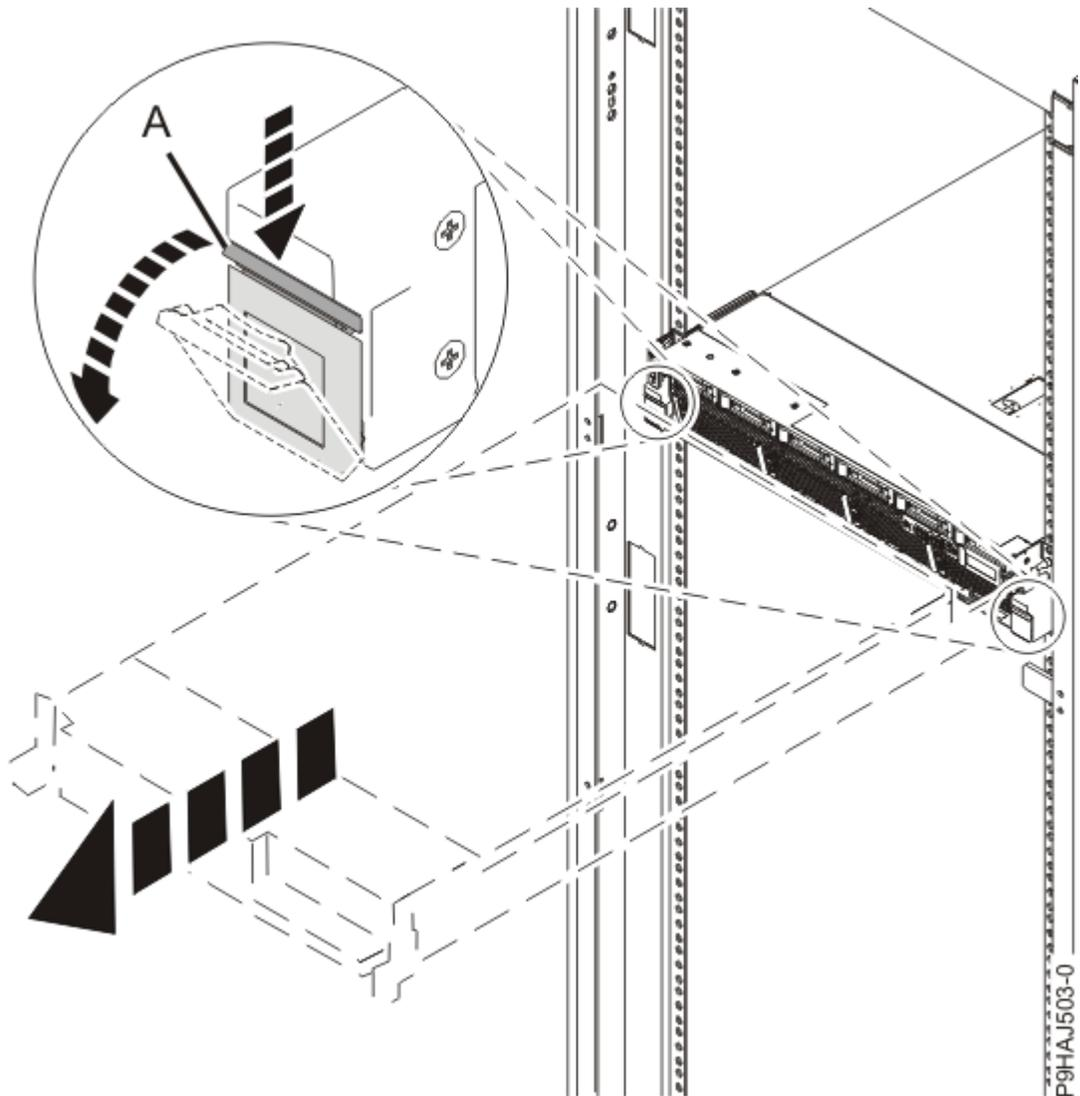
Figure 82. Déblocage des loquets latéraux
