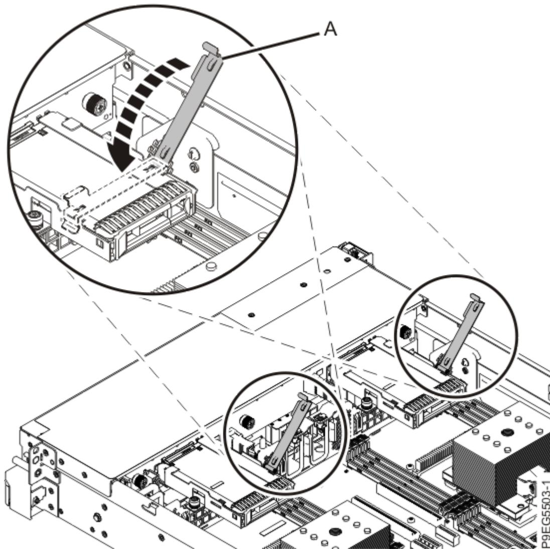
Figure 29. Fermeture du levier de maintien du disque
