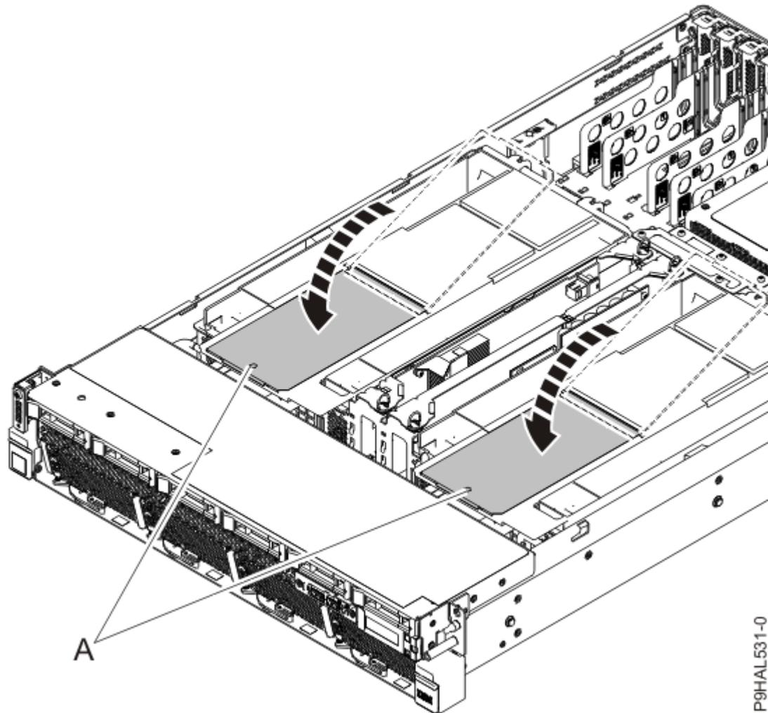
Figure 32. Fermeture des trappes d'accès articulées sur les déflecteurs d'air dans le système 9008-22L, 9009-22A ou 9223-22H
