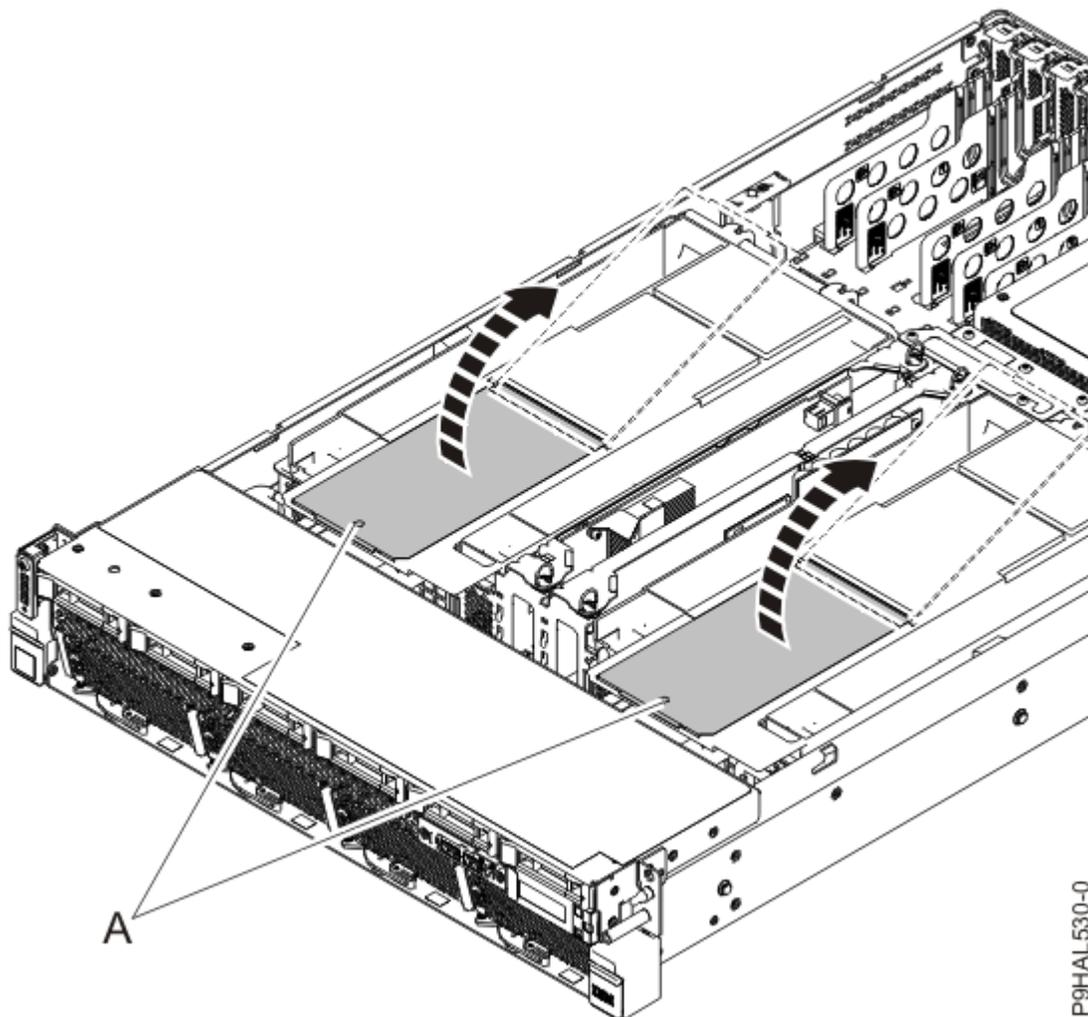
Figure 84. Ouverture des trappes d'accès articulées sur les déflecteurs d'air dans le système 9008-22L, 9009-22A ou 9223-22H
