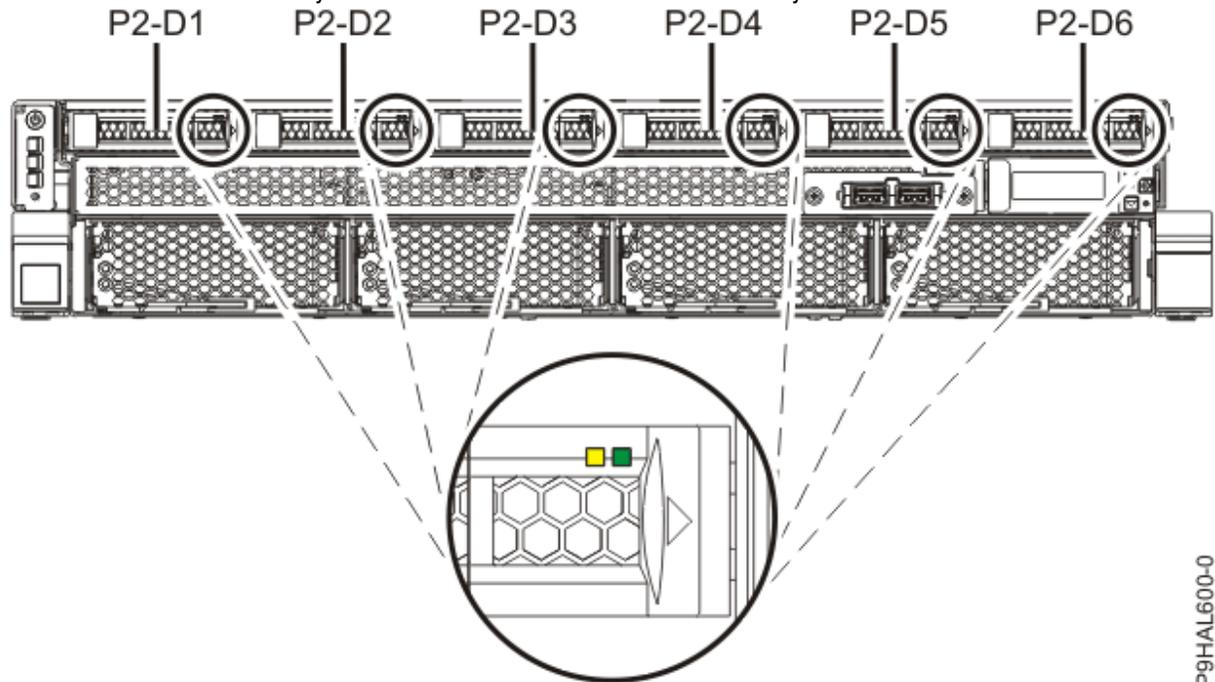
*Figure 36. Emplacements des unités de disque avant et des voyants d'activité d'un système 9008-22L, 9009-22A ou 9223-22H*
