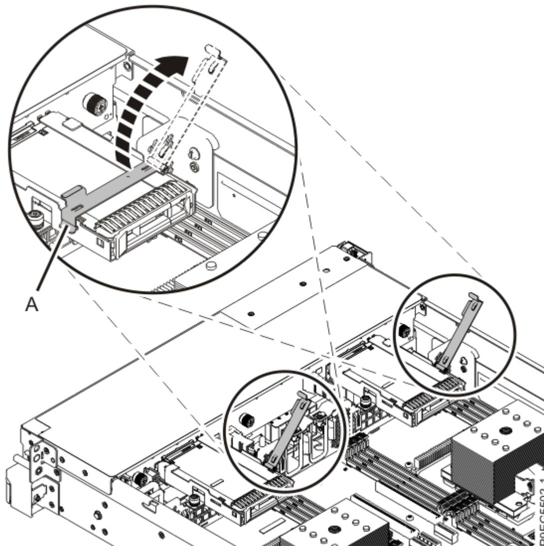
Figure 11. Ouverture du levier de maintien du disque
