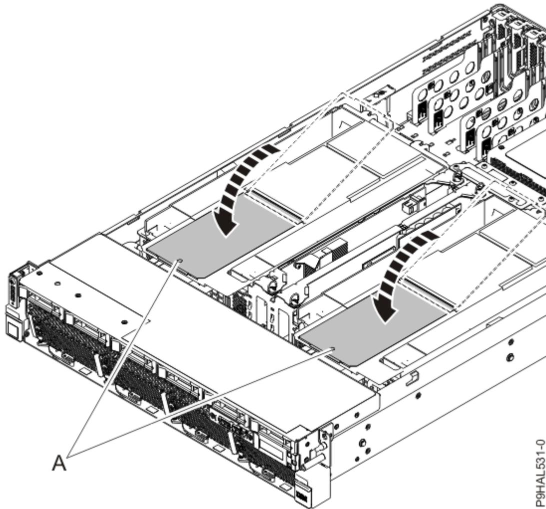
Figure 75. Fermeture des trappes d'accès articulées sur les déflecteurs d'air dans le système 9008-22L, 9009-22A ou 9223-22H
