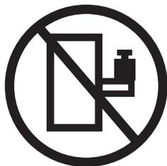
**DANGER :** Un serveur monté en armoire n'est pas une étagère ou un espace de travail. Ne posez pas d'objets sur les unités montées en armoire. En outre, ne vous appuyez pas sur des unités montées en armoire et ne les utilisez pas pour vous stabiliser, par exemple lorsque vous êtes en haut d'une échelle.
