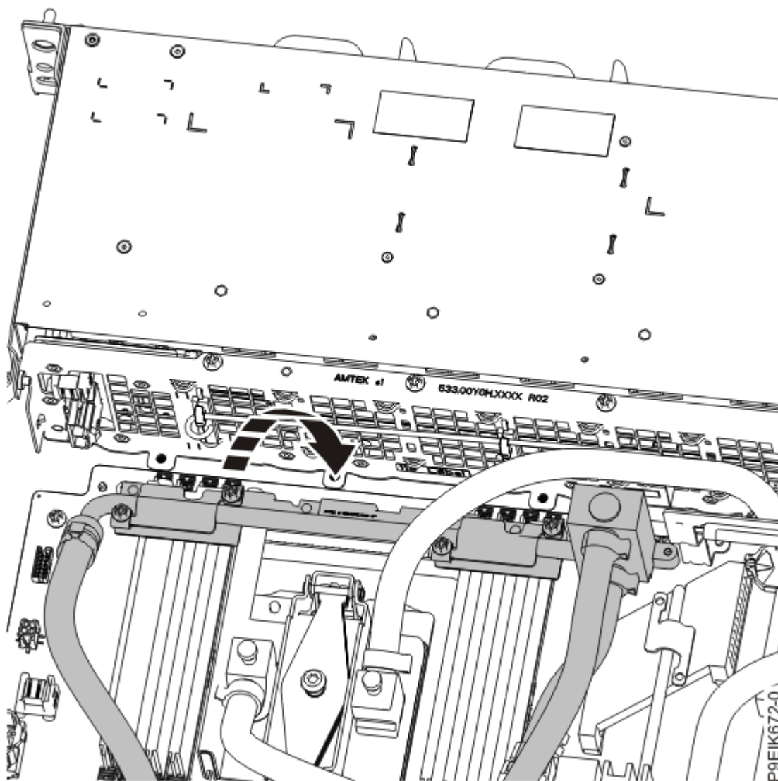
Figure 73. Remplacement de la conduite et de la pince avant
