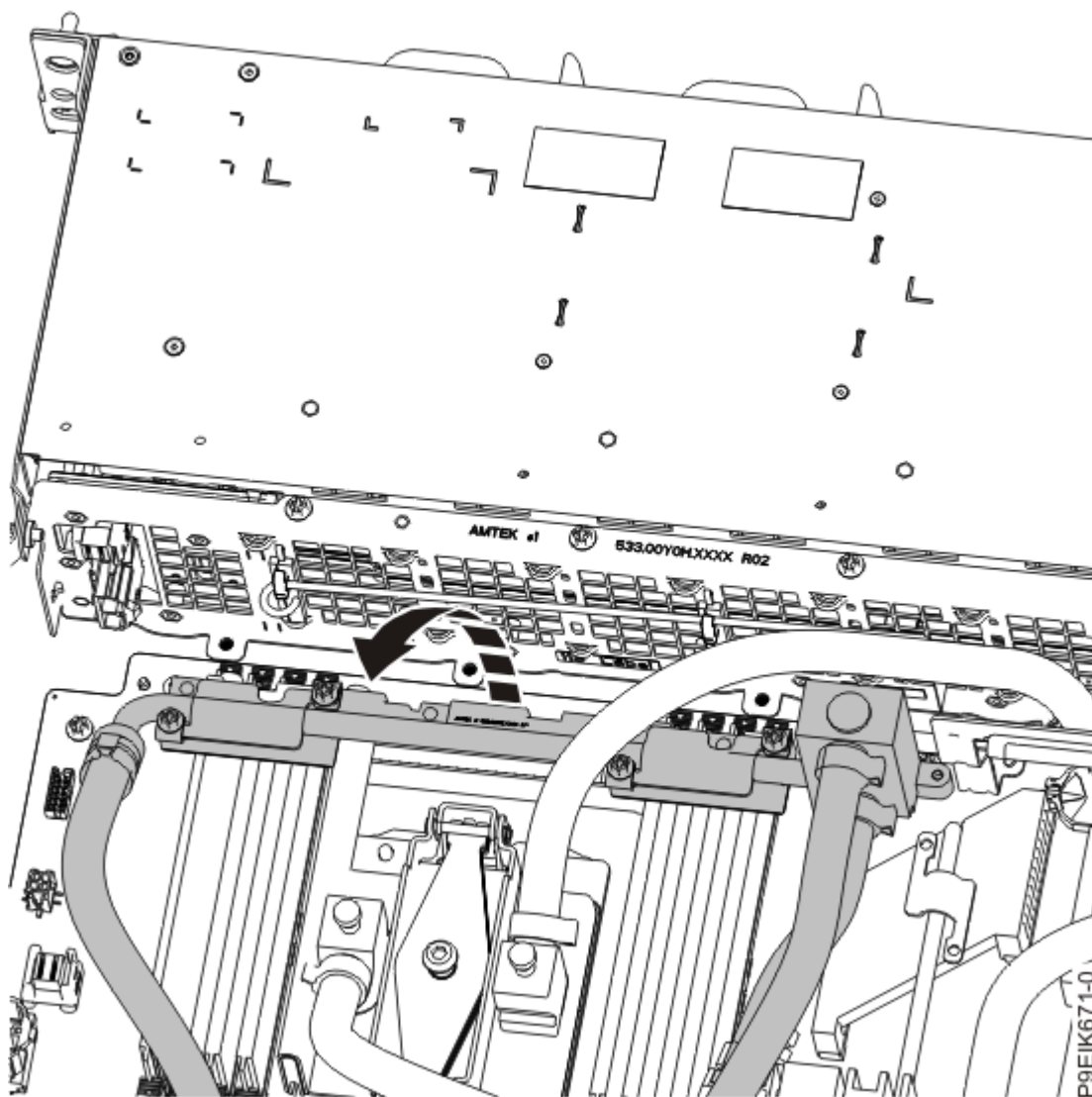
Figure 67. Eloignement de la conduite avant
