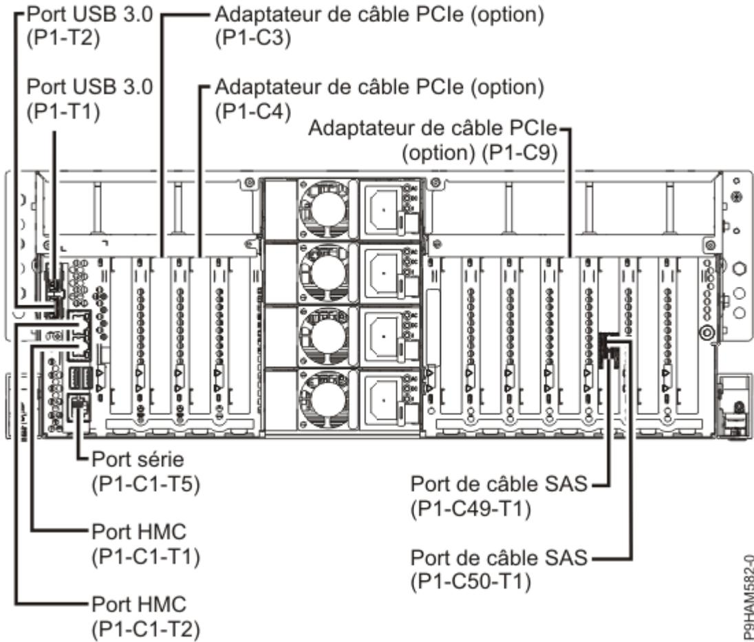
Figure 22. Emplacement des connecteurs des systèmes 9009-41A, 9009-41G, 9009-42A, 9009-42G et 9223-42H
