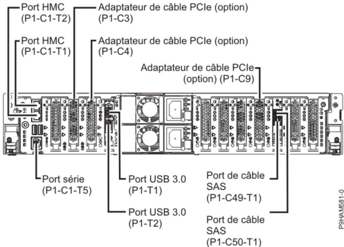
Figure 21. Emplacement des connecteurs des systèmes 5105-22E, 9008-22L, 9009-22A, 9009-22G et 9223-22H
