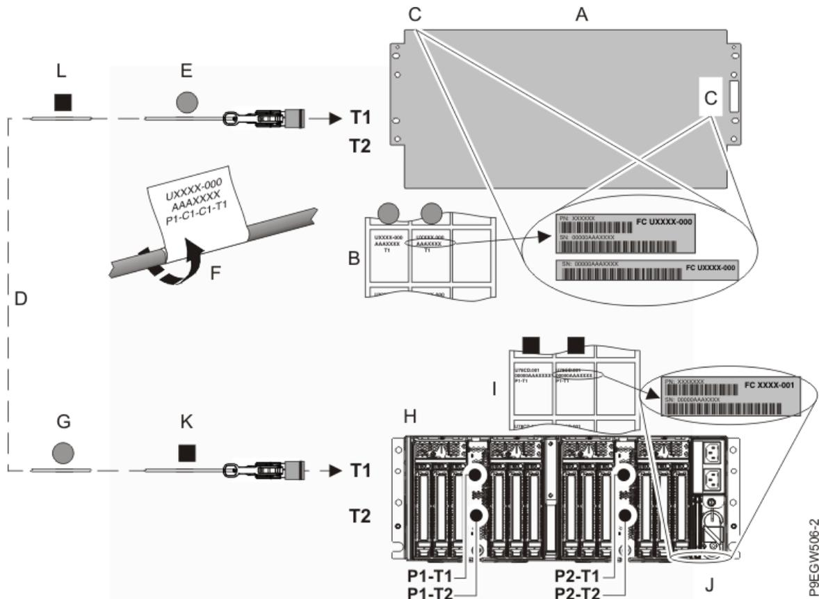
Figure 15. Etiquetage d'un câble de tiroir d'extension
