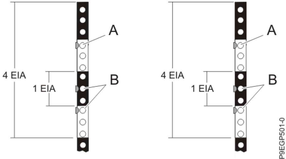
Figure 3. Marquage des emplacements d'installation à l'avant
