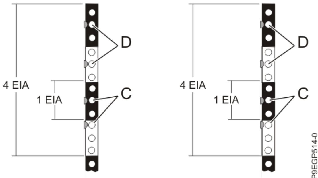
Figure 4. Marquage des emplacements d'installation à l'arrière
