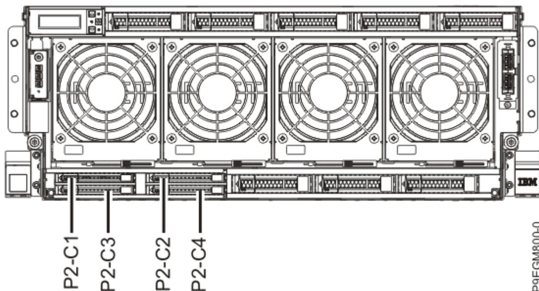
Figure 1. Emplacement des unités NVMe U.2 dans le système 9040-MR9
