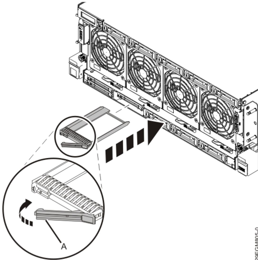
Figure 17. Installation d'un panneau d'obturation d'unité NVMe dans le système 9040-MR9
