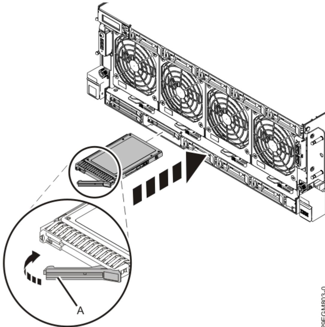
Figure 12. Installation ou remise en place d'une unité NVMe U.2 dans le système 9040-MR9
