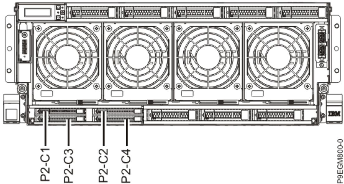
Figure 4. Emplacement des unités NVMe U.2 dans le système 9040-MR9
