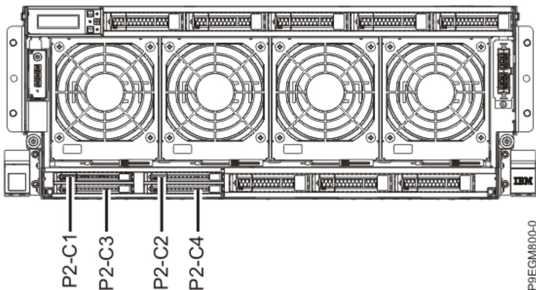
Figure 8. Emplacement des unités NVMe U.2 dans le système 9040-MR9
