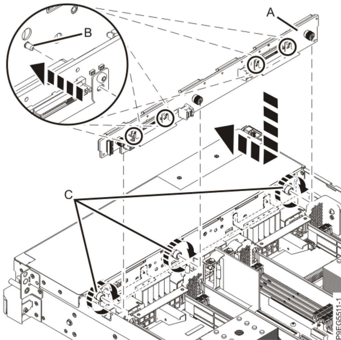
*Figure 14. Remise en place du fond de panier d'unité de disque*
