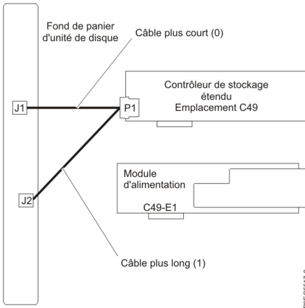
Figure 19. Reconnexion du câble SAS en "Y" dans une configuration de contrôleur de stockage hautes performances
