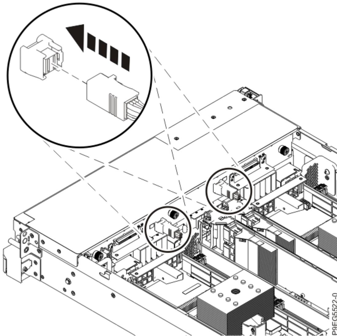
Figure 16. Reconnexion des câbles SAS avant
