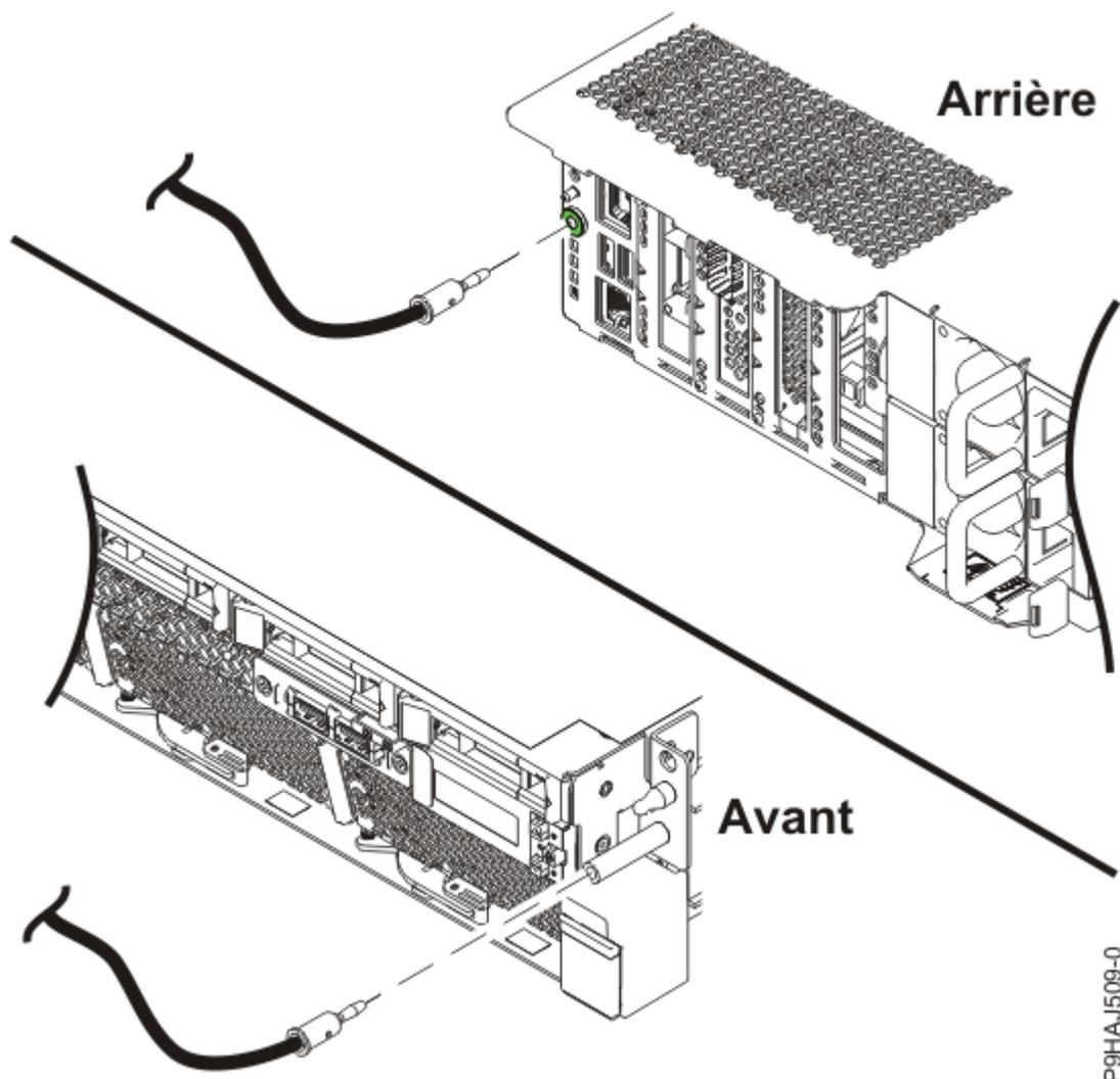
Figure 3. Emplacement des fiches de décharge électrostatique
