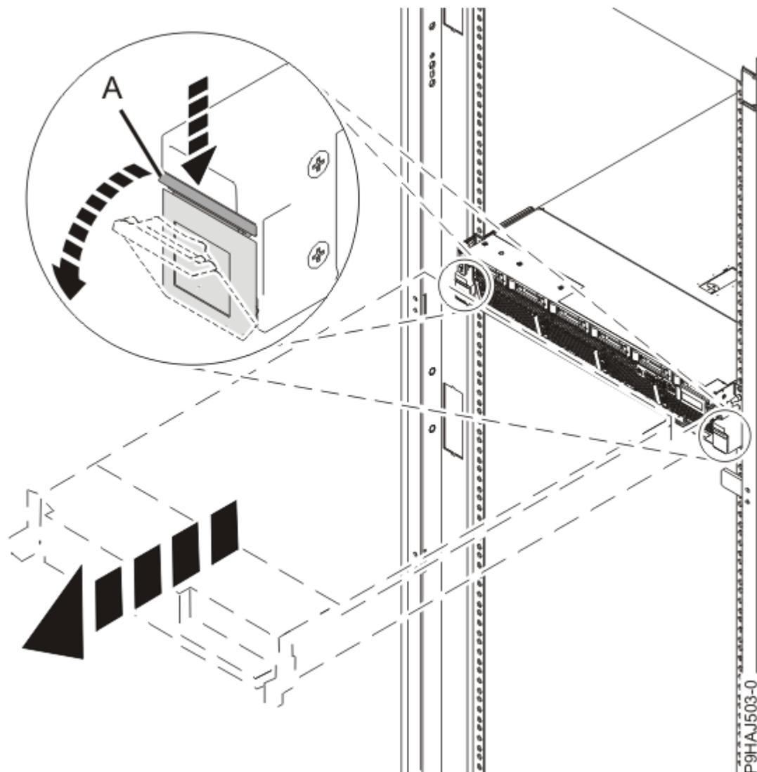
Figure 2. Déblocage des loquets latéraux
