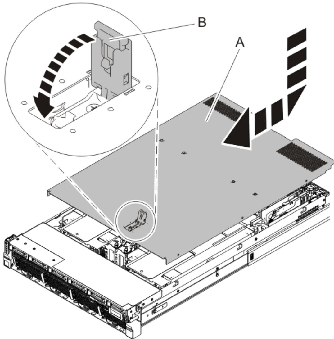
Figure 25. Installation du capot d'accès
