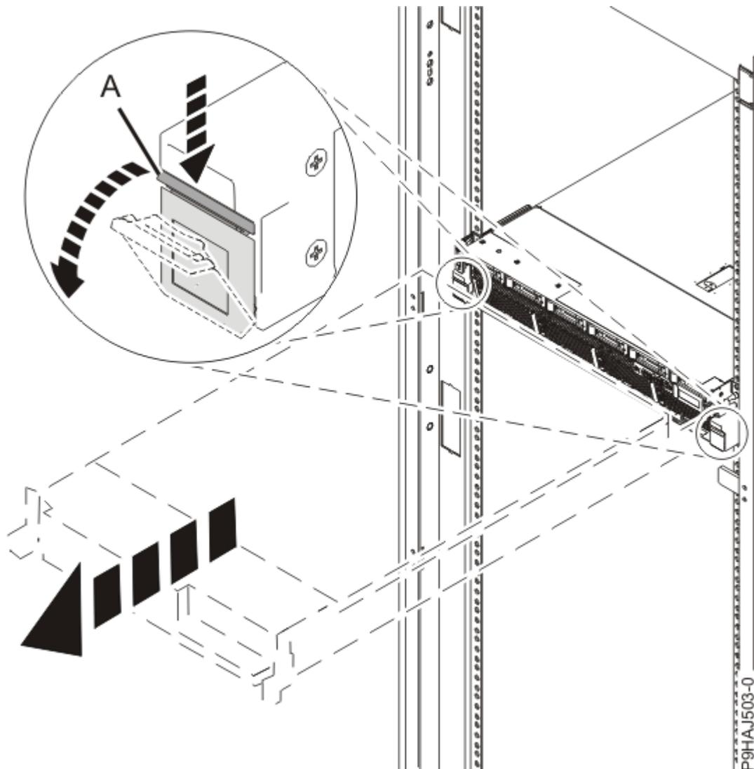
Figure 37. Déblocage des loquets latéraux
