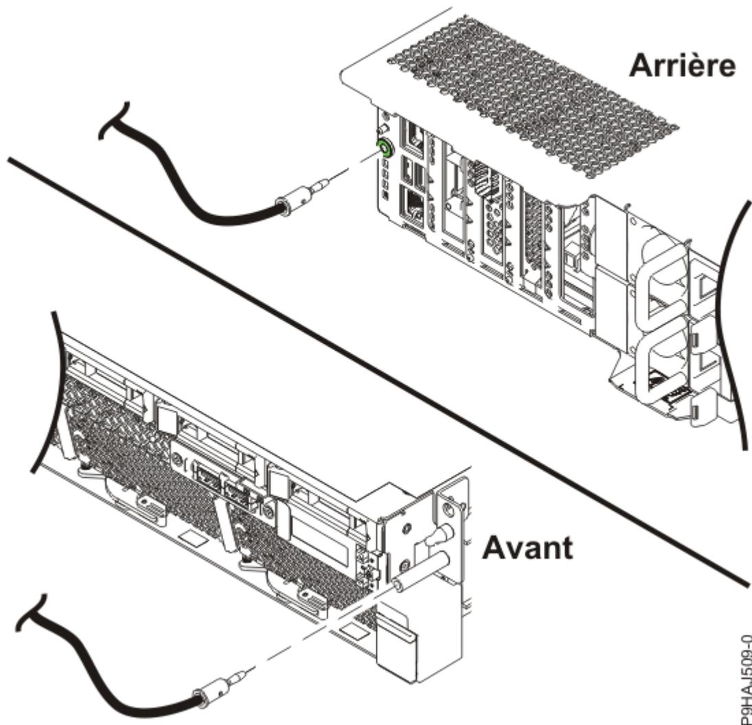
Figure 38. Emplacement des fiches de décharge électrostatique
