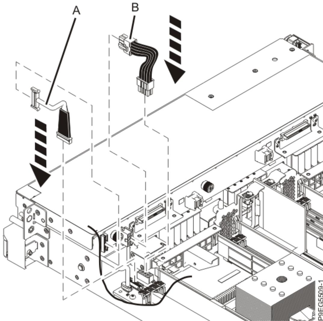
*Figure 15. Reconnexion du cordon d'interface et du câble d'alimentation*
