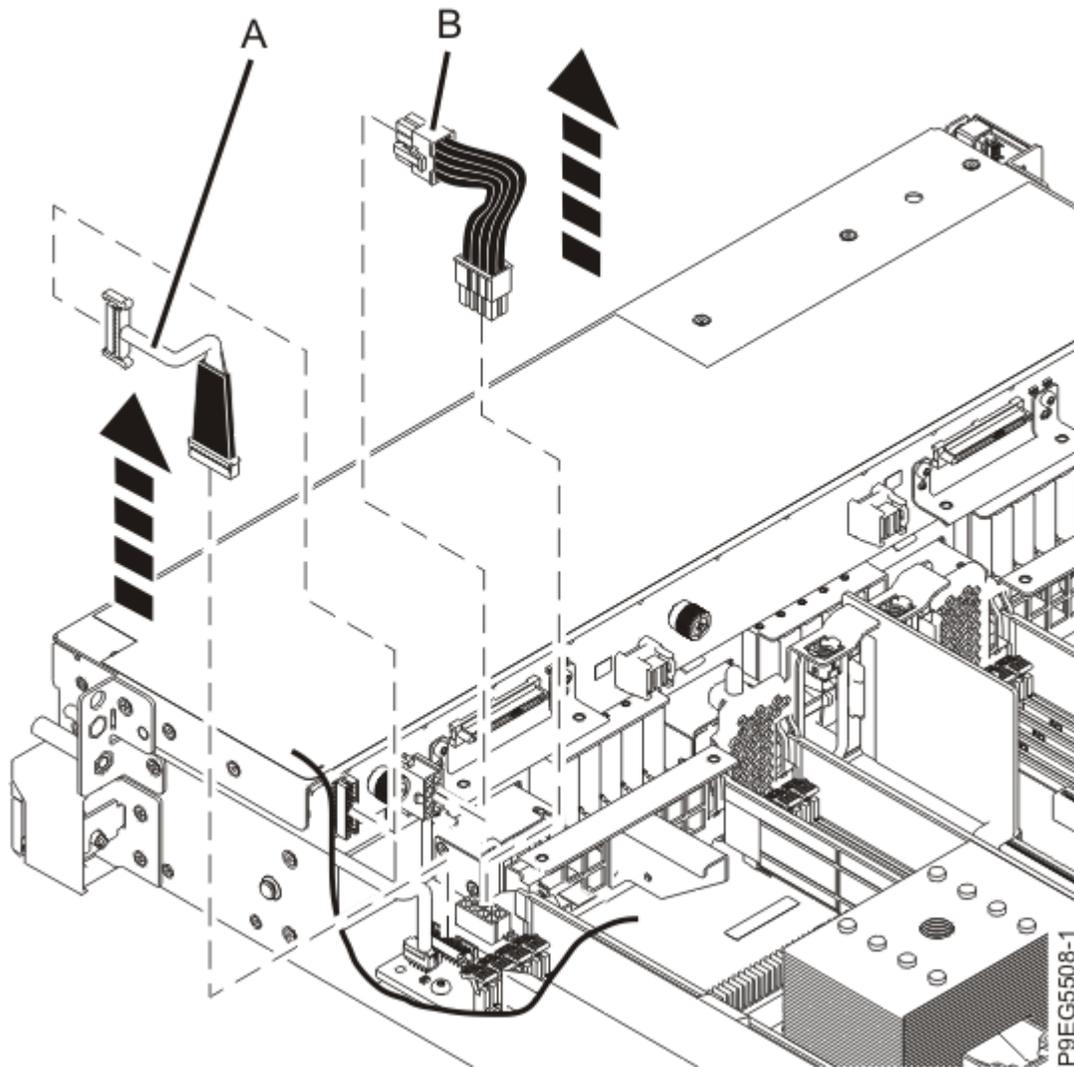
Figure 32. Déconnexion du cordon d'interface et du câble d'alimentation
