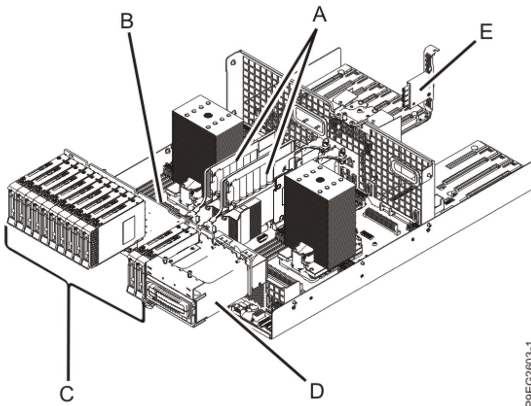
Figure 6. Composants de sous-système SAS avec la configuration de stockage à fonction étendue dans un système 9009-41A, 9009-42A ou 9223-42H
