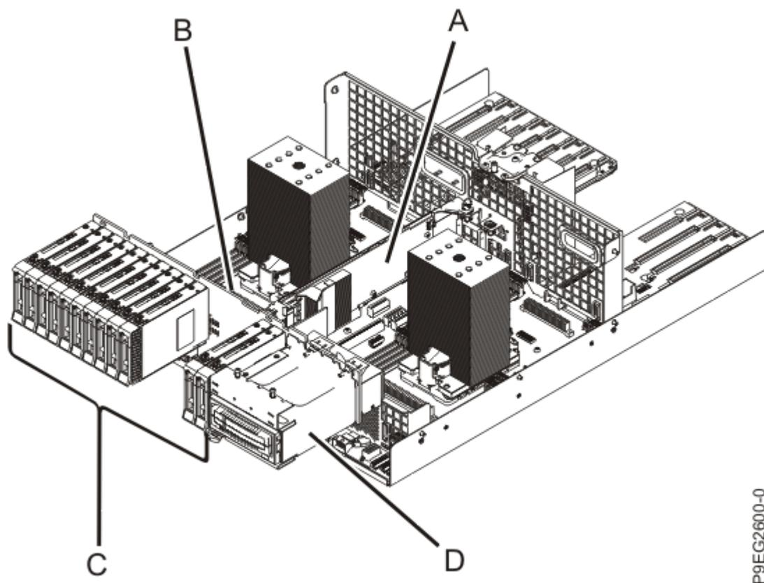
Figure 2. Composants de sous-système SAS dans la configuration de stockage à fonction de base des systèmes 9009-41A, 9009-42A ou 9223-42H
