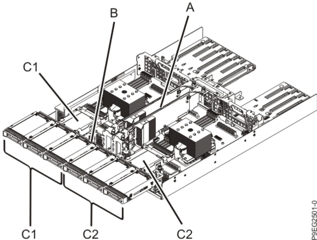
Figure 3. Composants de sous-système SAS dans la configuration de stockage à fonction de base avec le dispositif de disque partagé dans le système 9008-22L, 9009-22A ou 9223-22H
