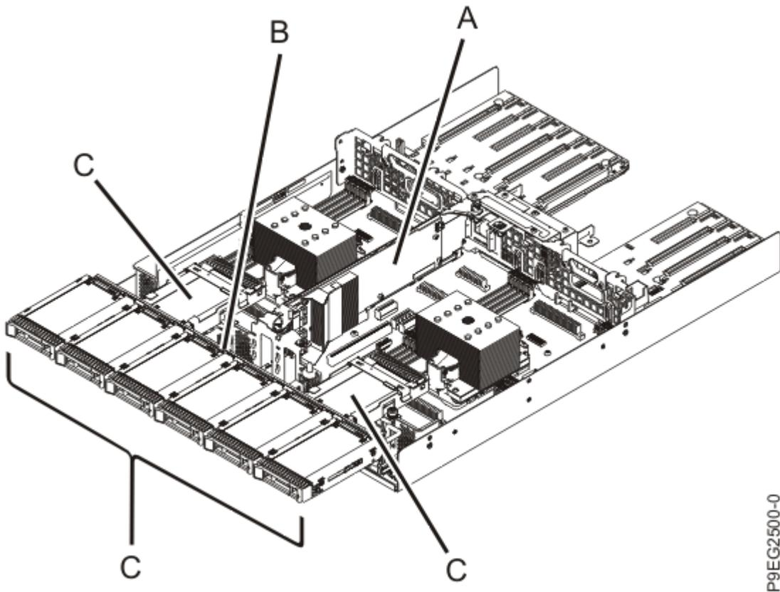
Figure 1. Composants de sous-système SAS dans la configuration de stockage à fonction de base des systèmes 9008-22L, 9009-22A ou 9223-22H
