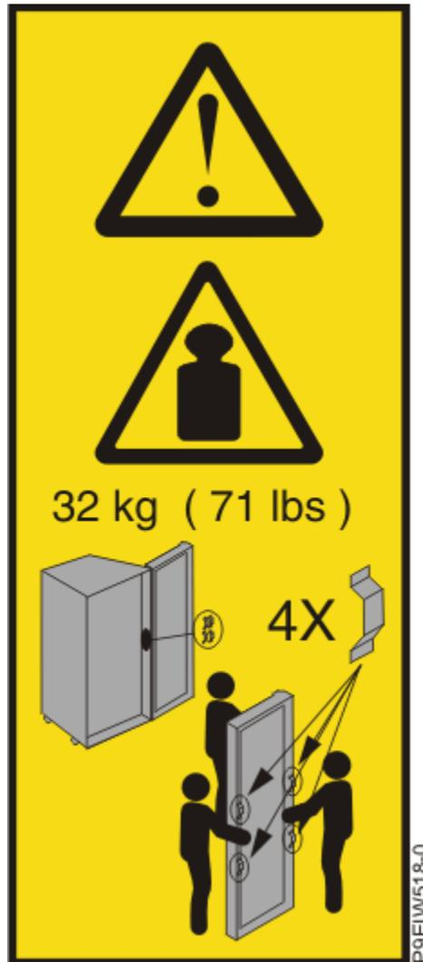
Figura 99. Peso del intercambiador de calor y asas de sujeción
