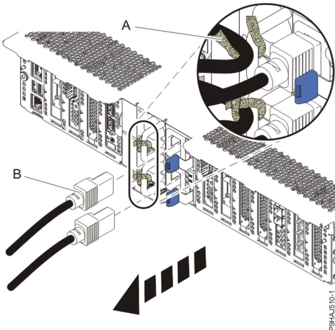
Figura 2. Extracción de los cables de alimentación
