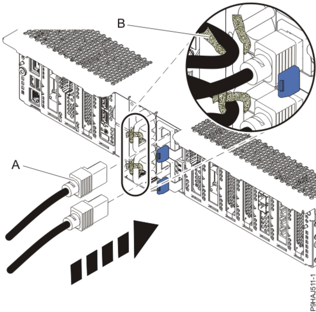
Figura 16. Conexión de los cables de alimentación
