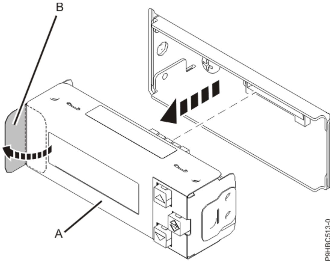
*Figura 20. Extracción de la pantalla del panel de control*
