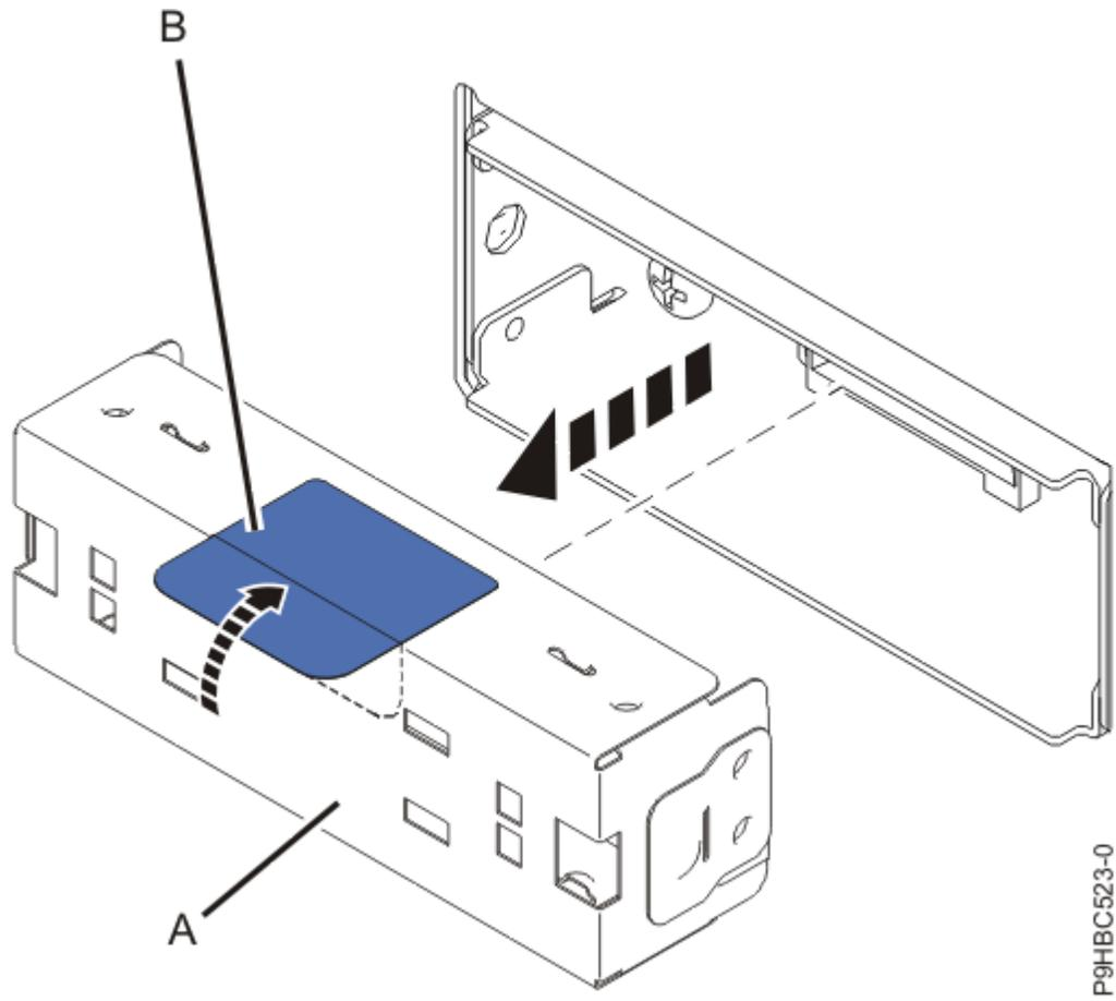
*Figura 22. Extracción del panel de relleno*
