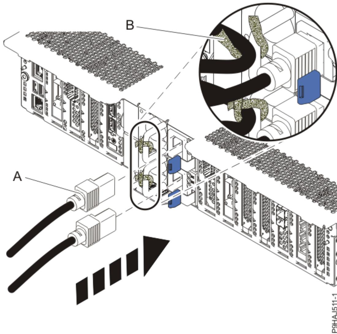
Figura 46. Conexión de los cables de alimentación
