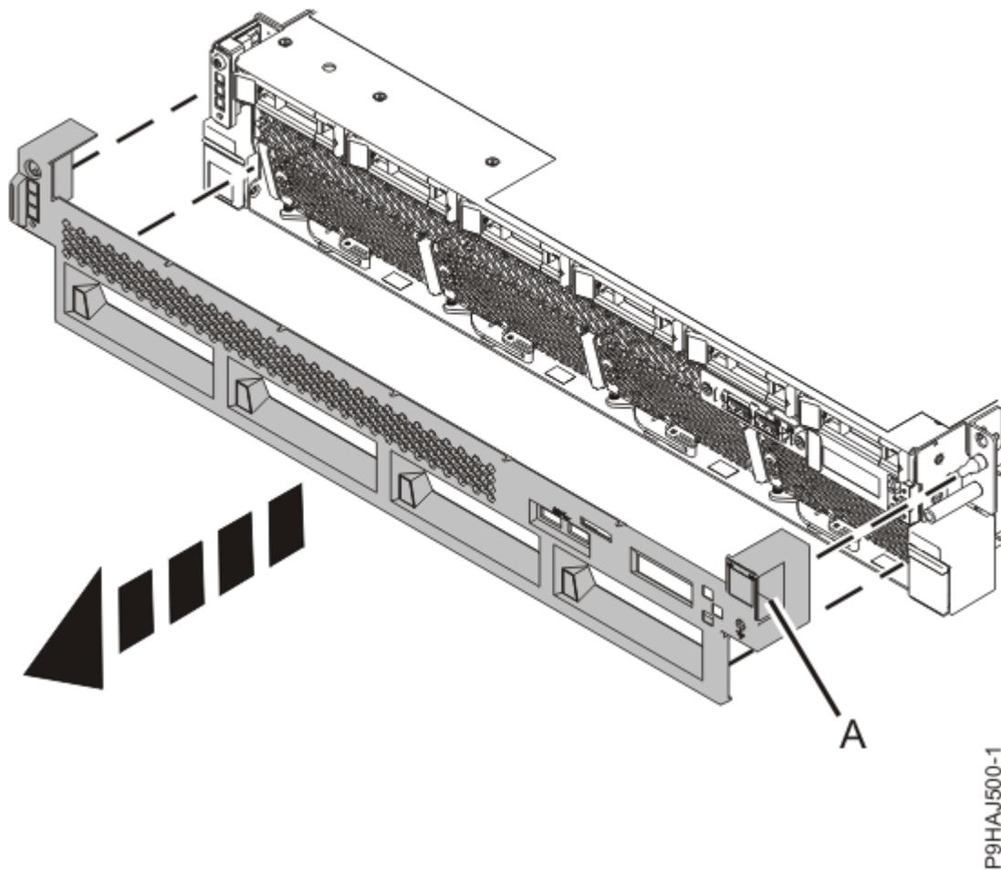
*Figura 26. Extracción de las cubiertas frontales*
