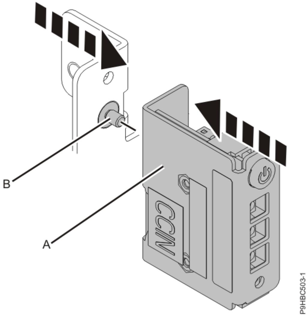
Figura 12. Sustitución del panel de control en la abrazadera
