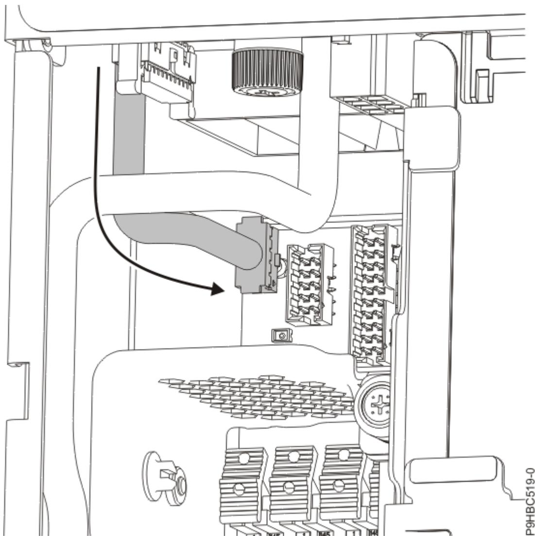
*Figura 59. Vía de acceso del cable de pantalla del panel de control*
