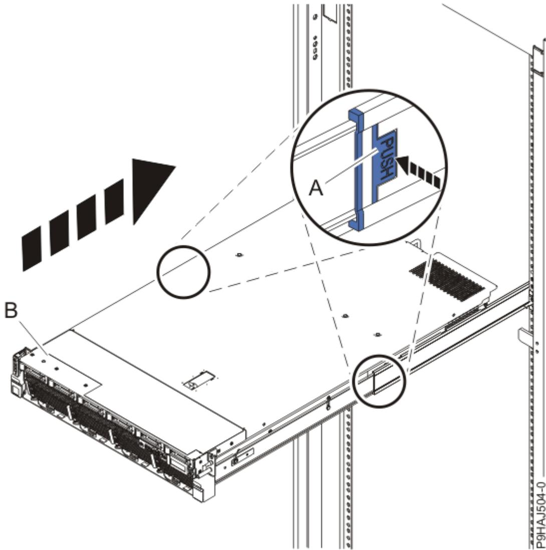
*Figura 14. Colocación del sistema en la posición operativa*
