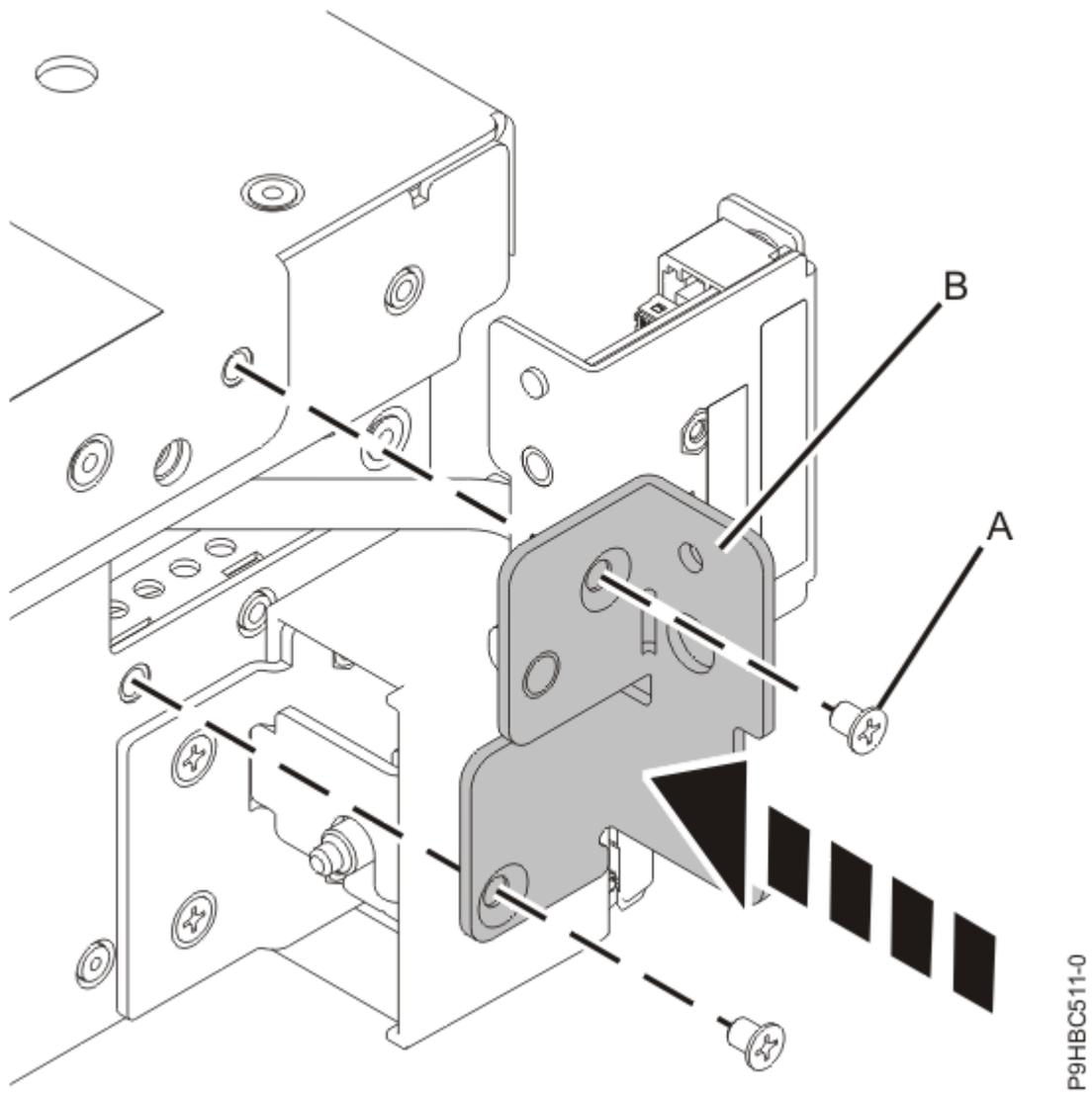
*Figura 39. Sustitución de la abrazadera del panel de control*
