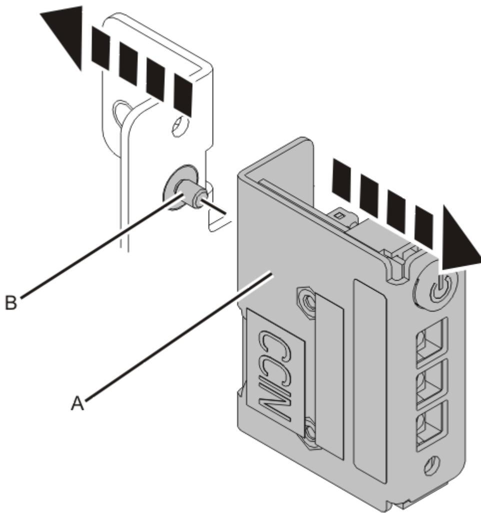
*Figura 32. Extracción del panel de control de la abrazadera*
