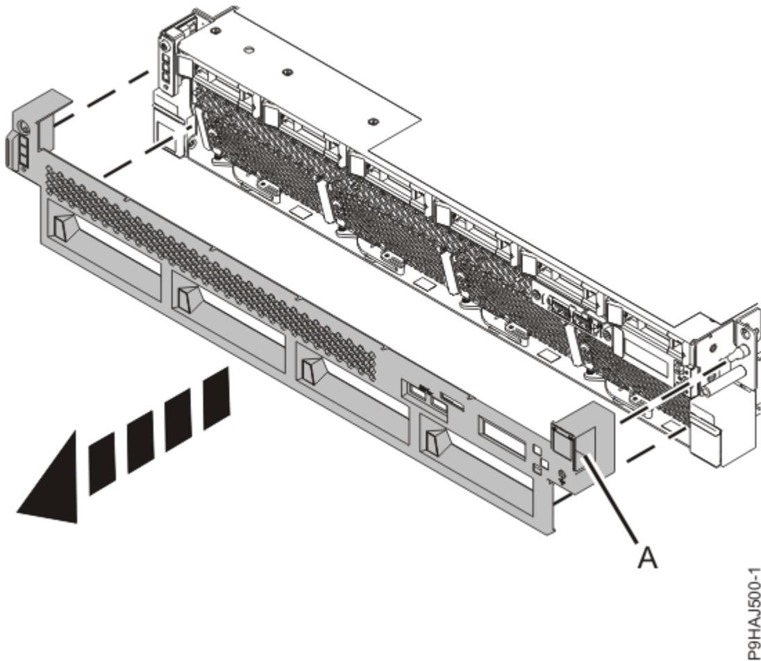
*Figura 49. Extracción de las cubiertas frontales*
