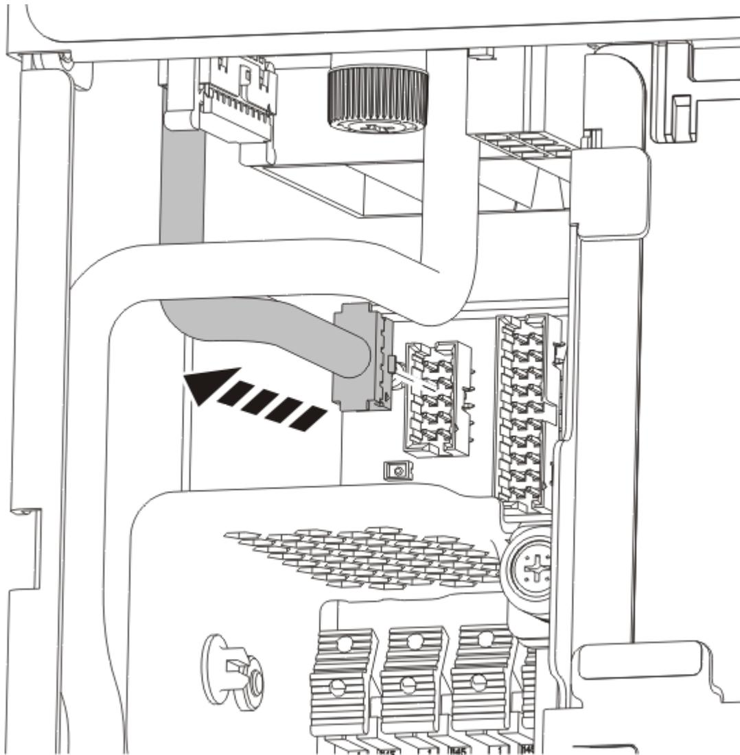
Figura 54. Desconexión del cable de pantalla del panel de control de la placa posterior del sistema
