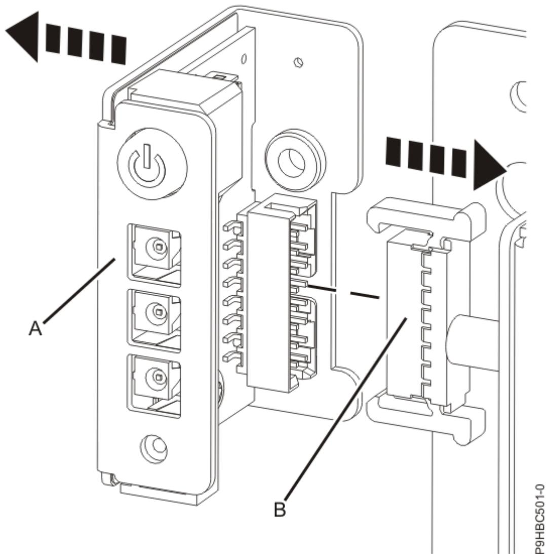
Figura 10. Desconexión del panel de control del cable
