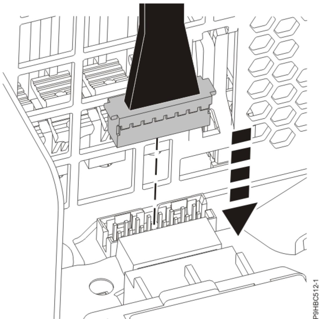
*Figura 41. Conexión del cable del panel de control a la placa posterior del sistema*
