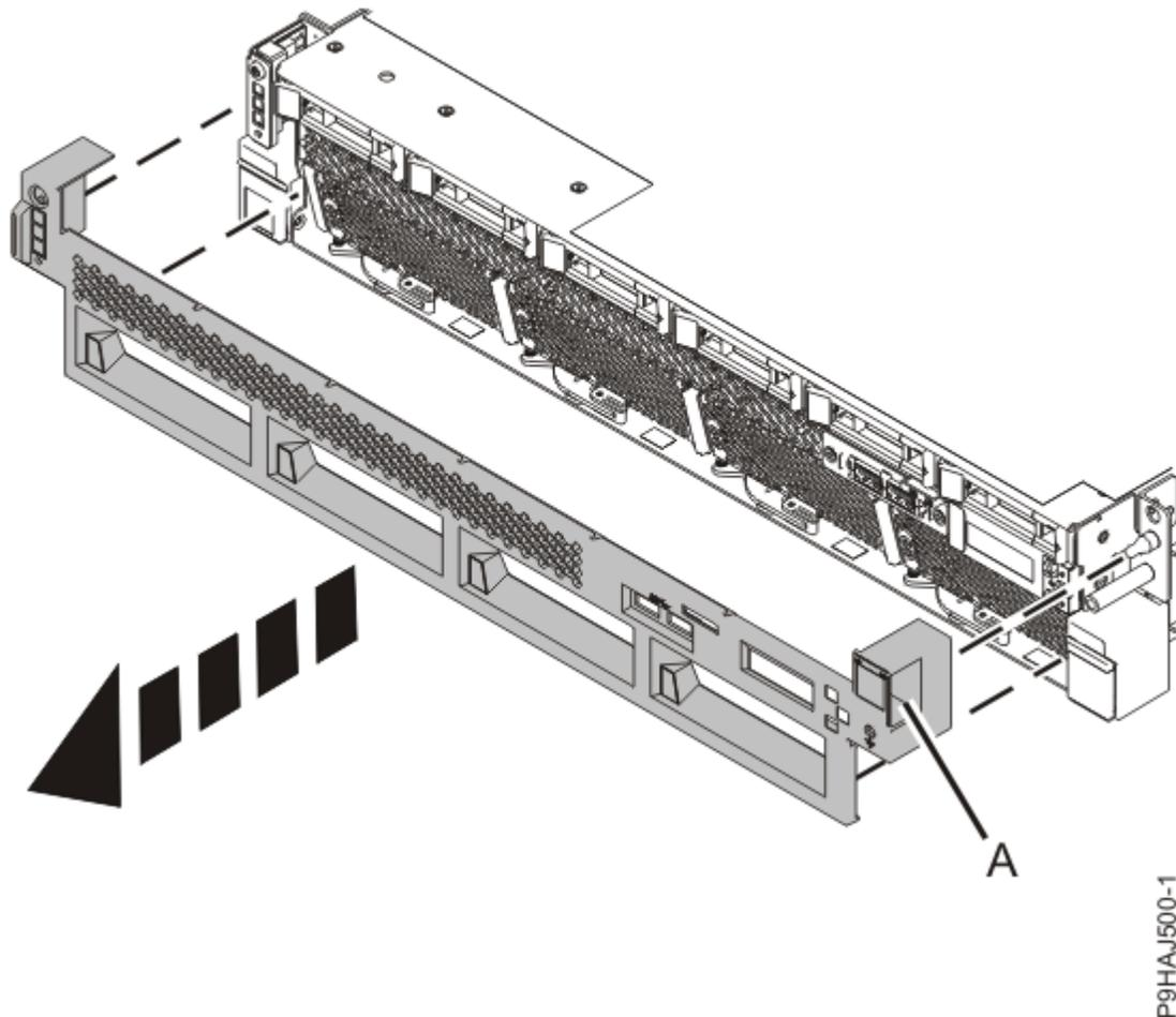
*Figura 18. Extracción de las cubiertas frontales*
