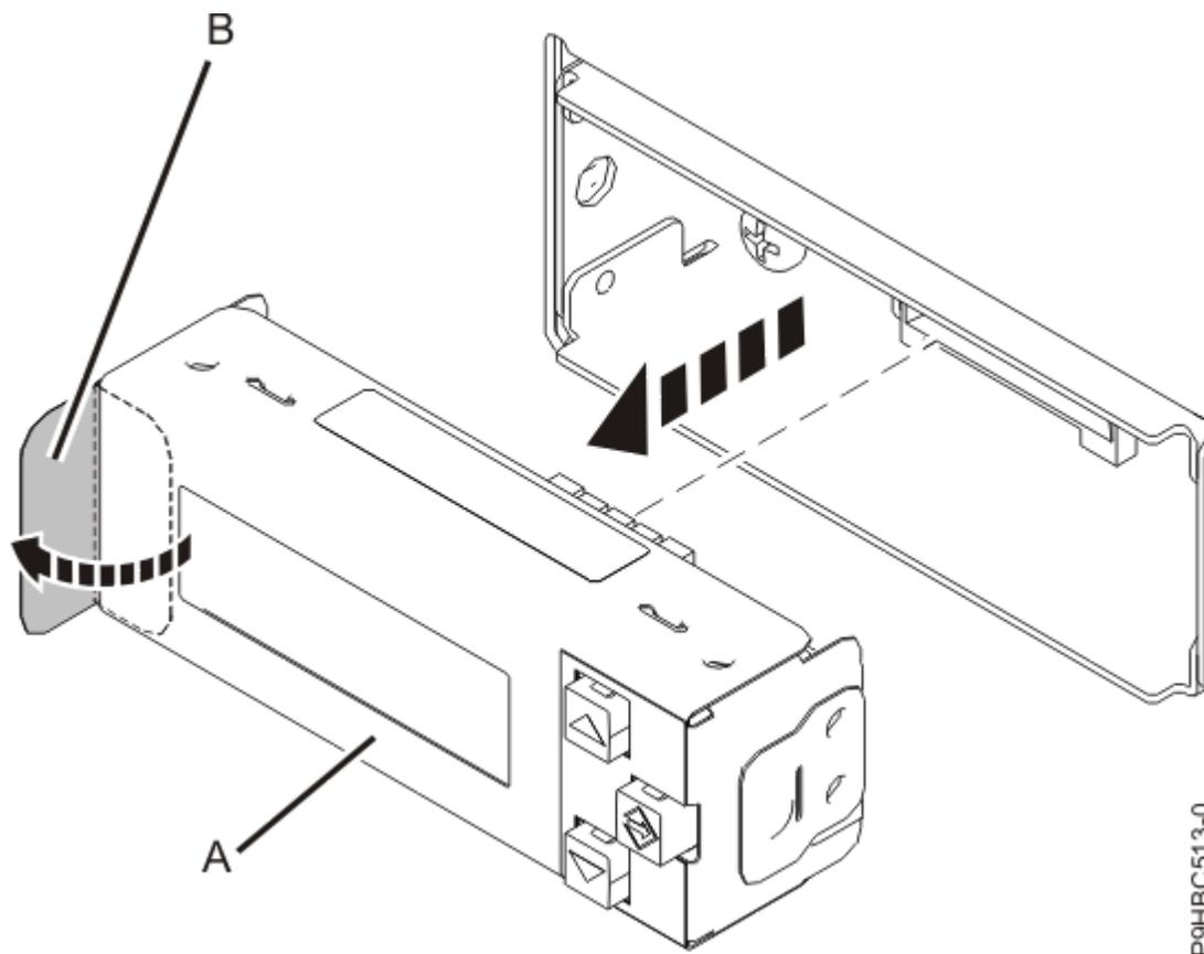
*Figura 55. Extracción de la pantalla del panel de control*
