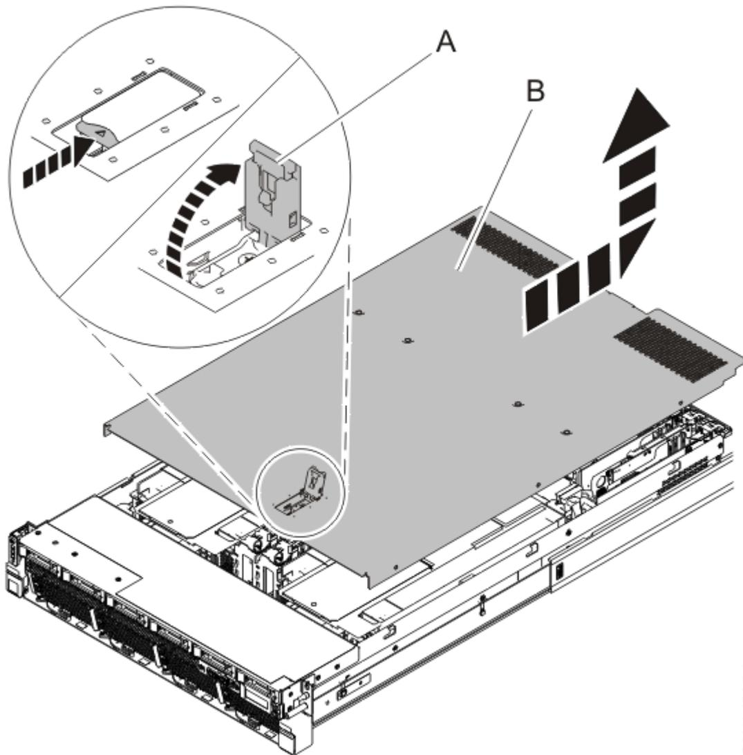
Figura 52. Extracción de la cubierta de acceso de servicio
