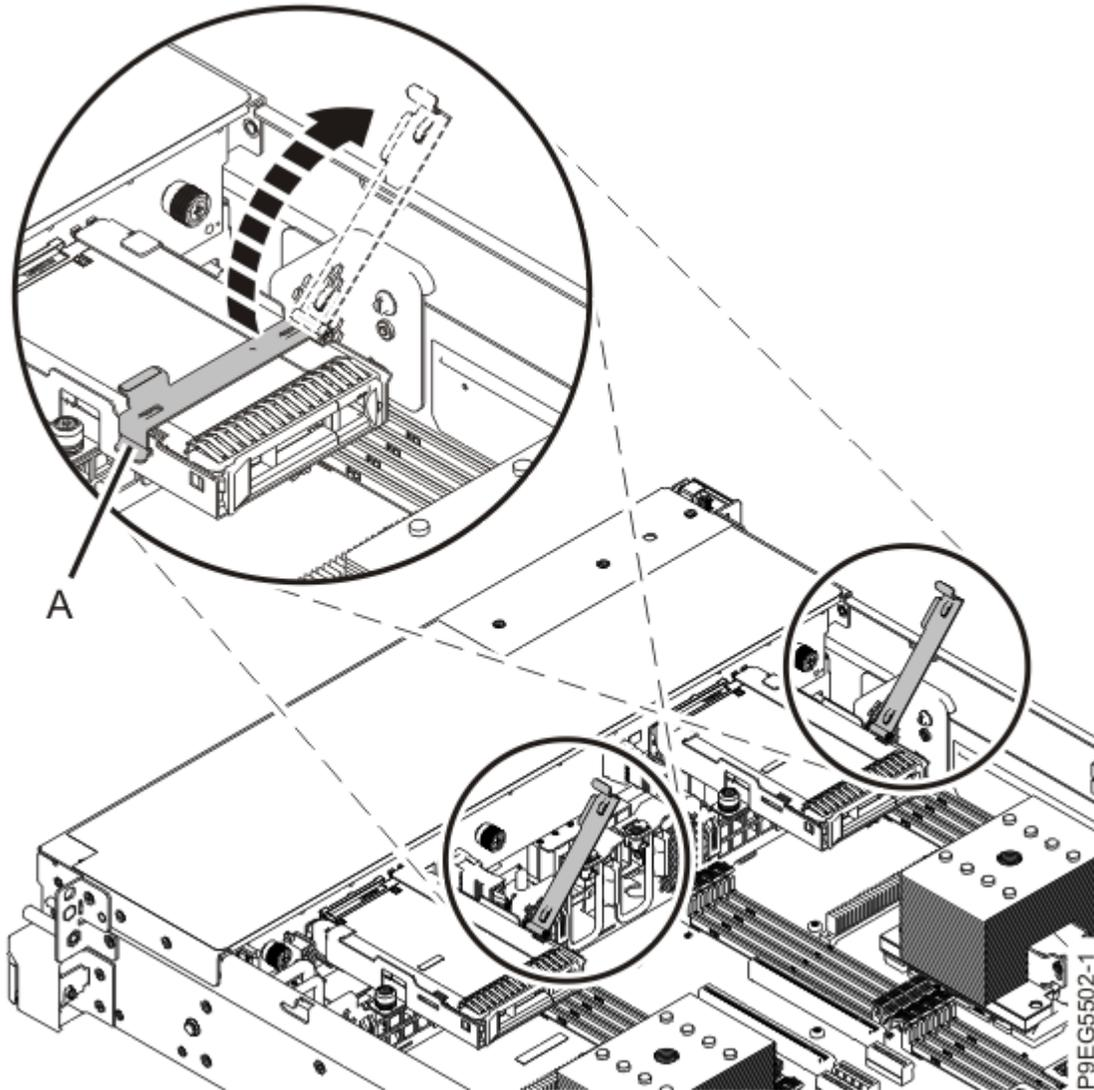
Figura 49. Apertura de la palanca del soporte de la unidad
