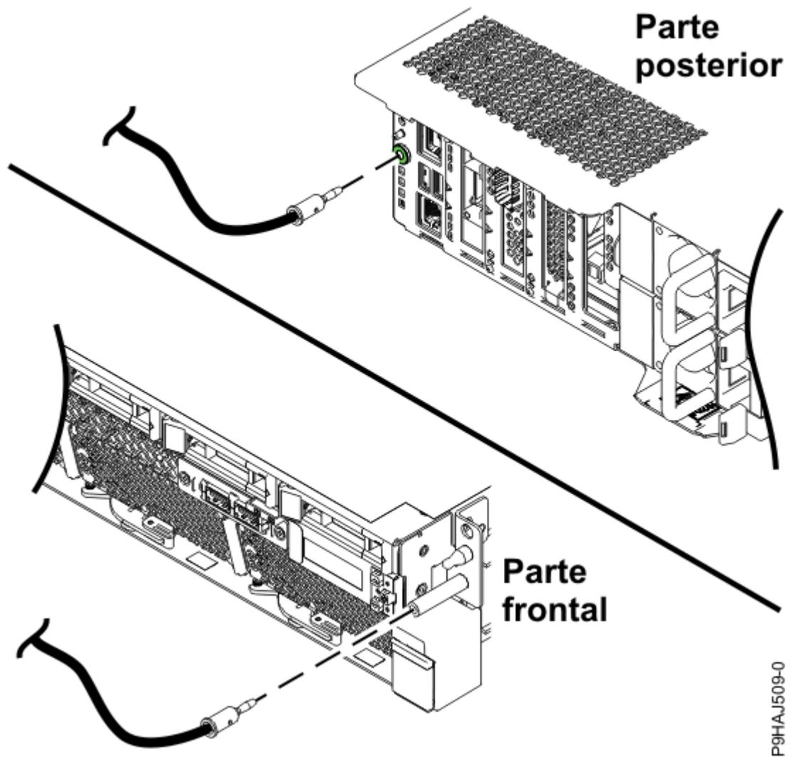
Figura 6. Ubicación de los enchufes de descarga electrostática en un sistema 9008-22L, 9009-22A o 9223-22H
