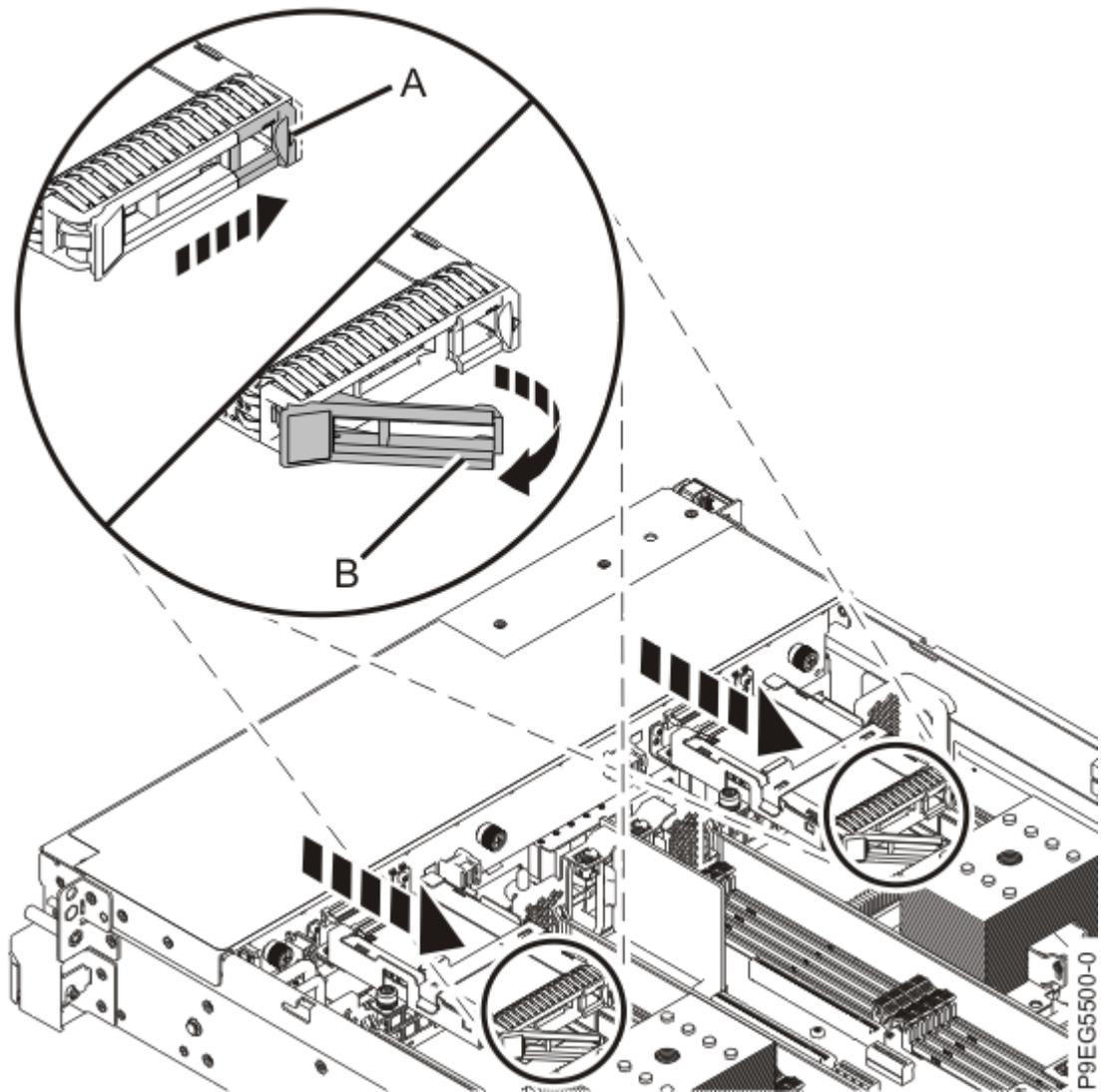
*Figura 44. Desbloqueo del asa de la unidad*
