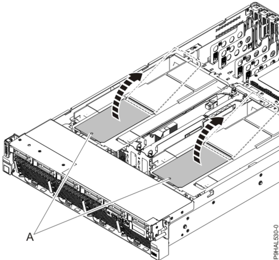
Figura 84. Apertura de las puertas de acceso abatibles en los deflectores de aire del sistema 9008-22L, 9009-22A o 9223-22H
