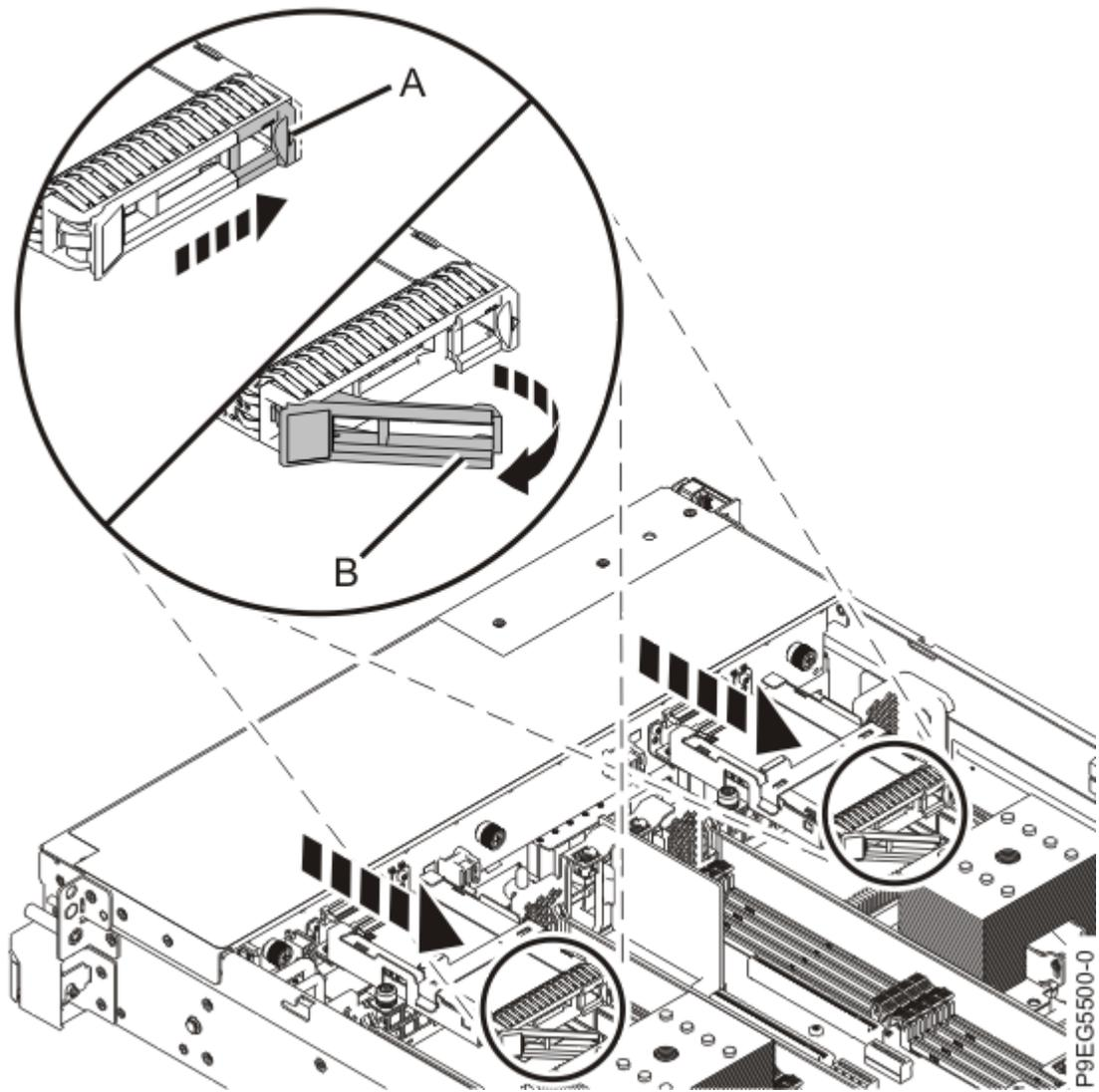
*Figura 12. Desbloqueo del asa de la unidad*
