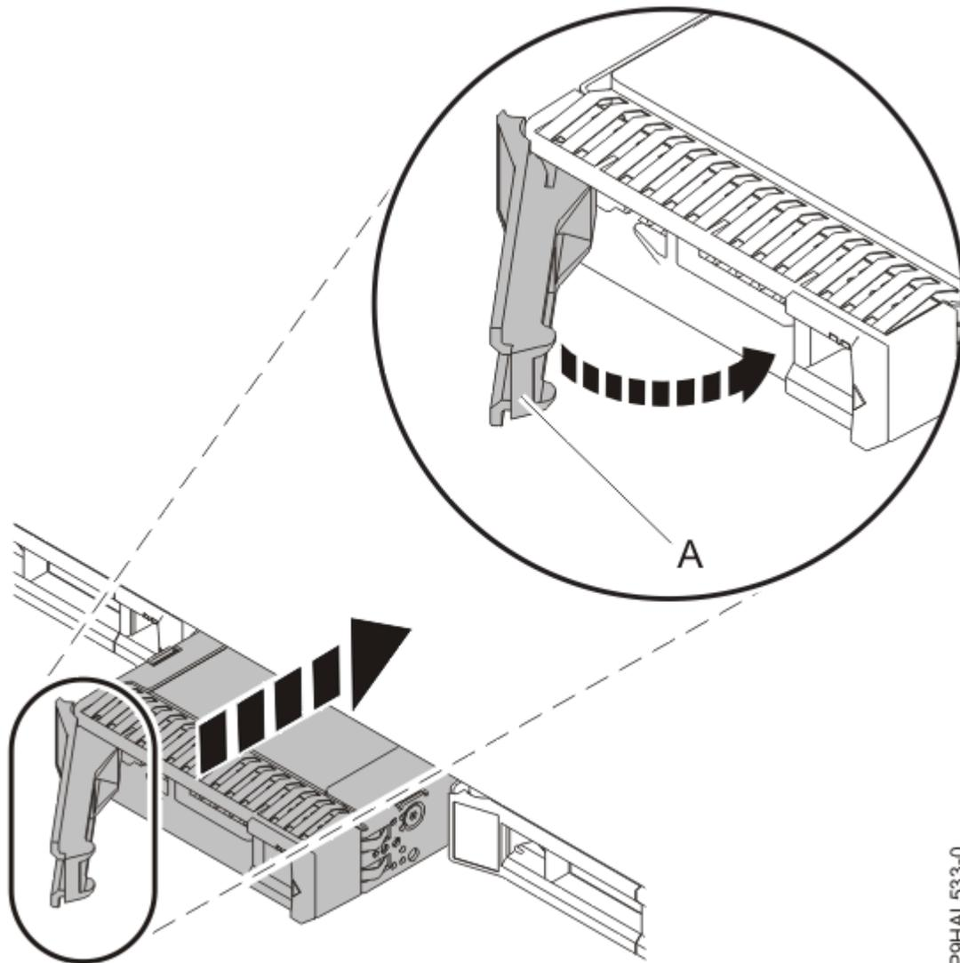
Figura 26. Instalación de una unidad en un sistema
