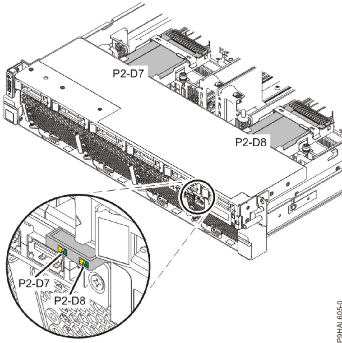
Figura 2. Ubicaciones de unidades internas e indicadores de servicio para un sistema 9008-22L, 9009-22A o 9223-22H
