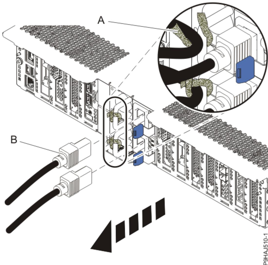
*Figura 38. Extracción de los cables de alimentación*
