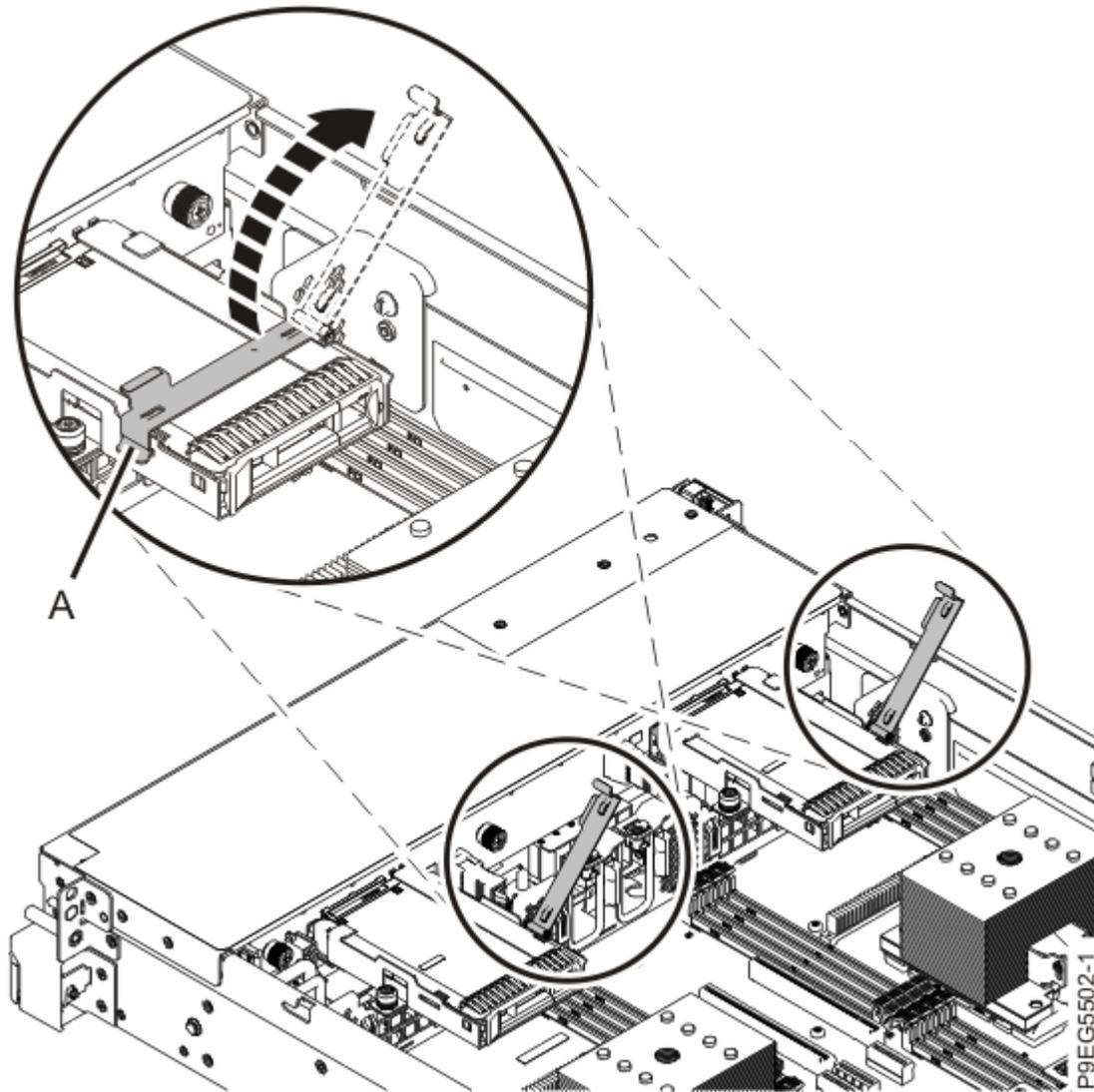
*Figura 11. Apertura de la palanca del soporte de la unidad*
