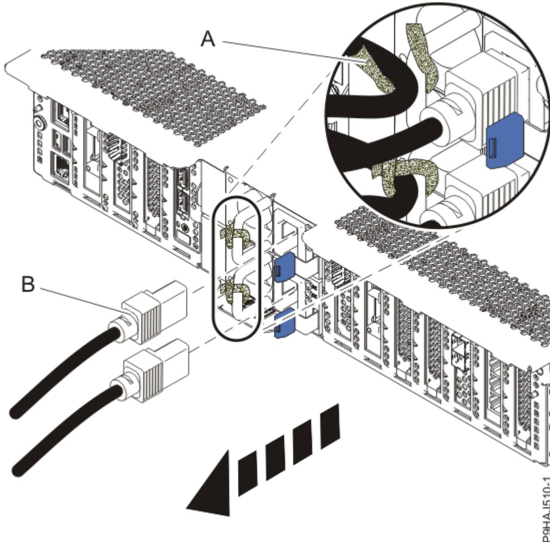
Figura 81. Extracción de los cables de alimentación
