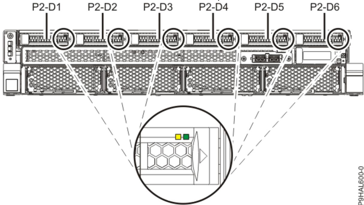
Figura 36. Ubicaciones de unidades de disco e indicadores de servicio para un sistema 9008-22L, 9009-22A o 9223-22H
