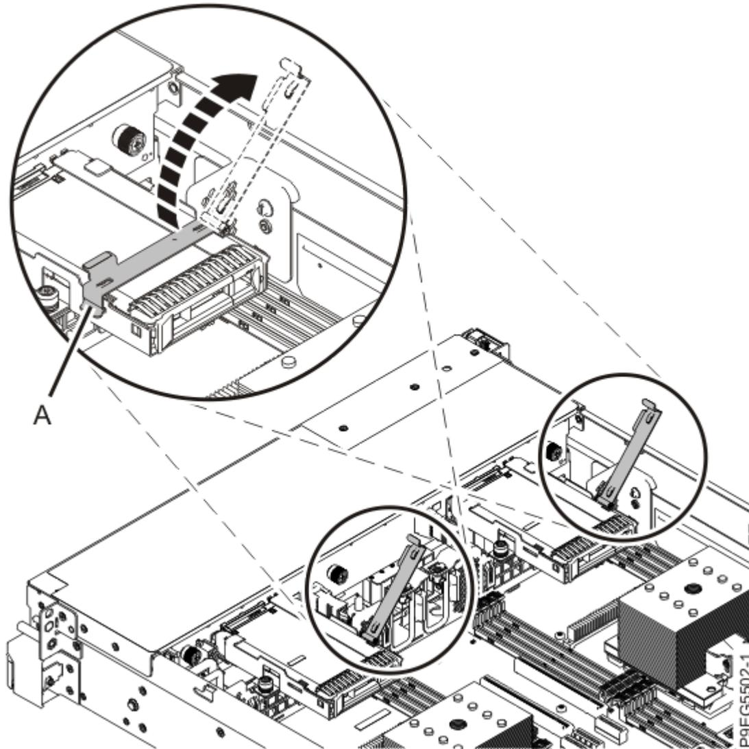
*Figura 85. Apertura de la palanca del soporte de la unidad*
