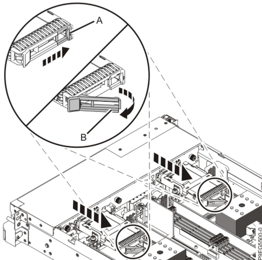
Figura 57. Desbloqueo del asa de la unidad
