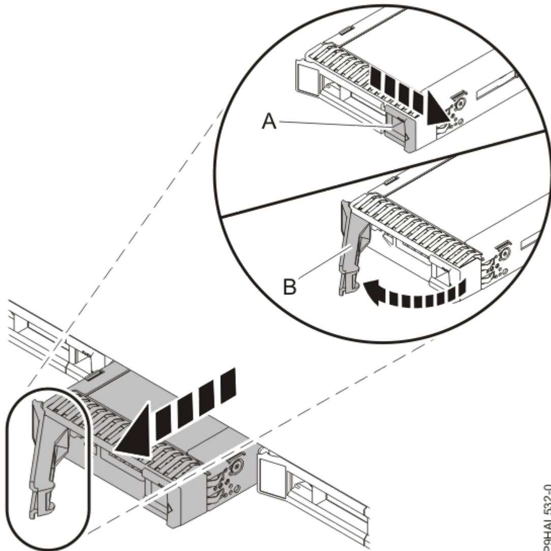
Figura 52. Desbloqueo y extracción de la unidad
