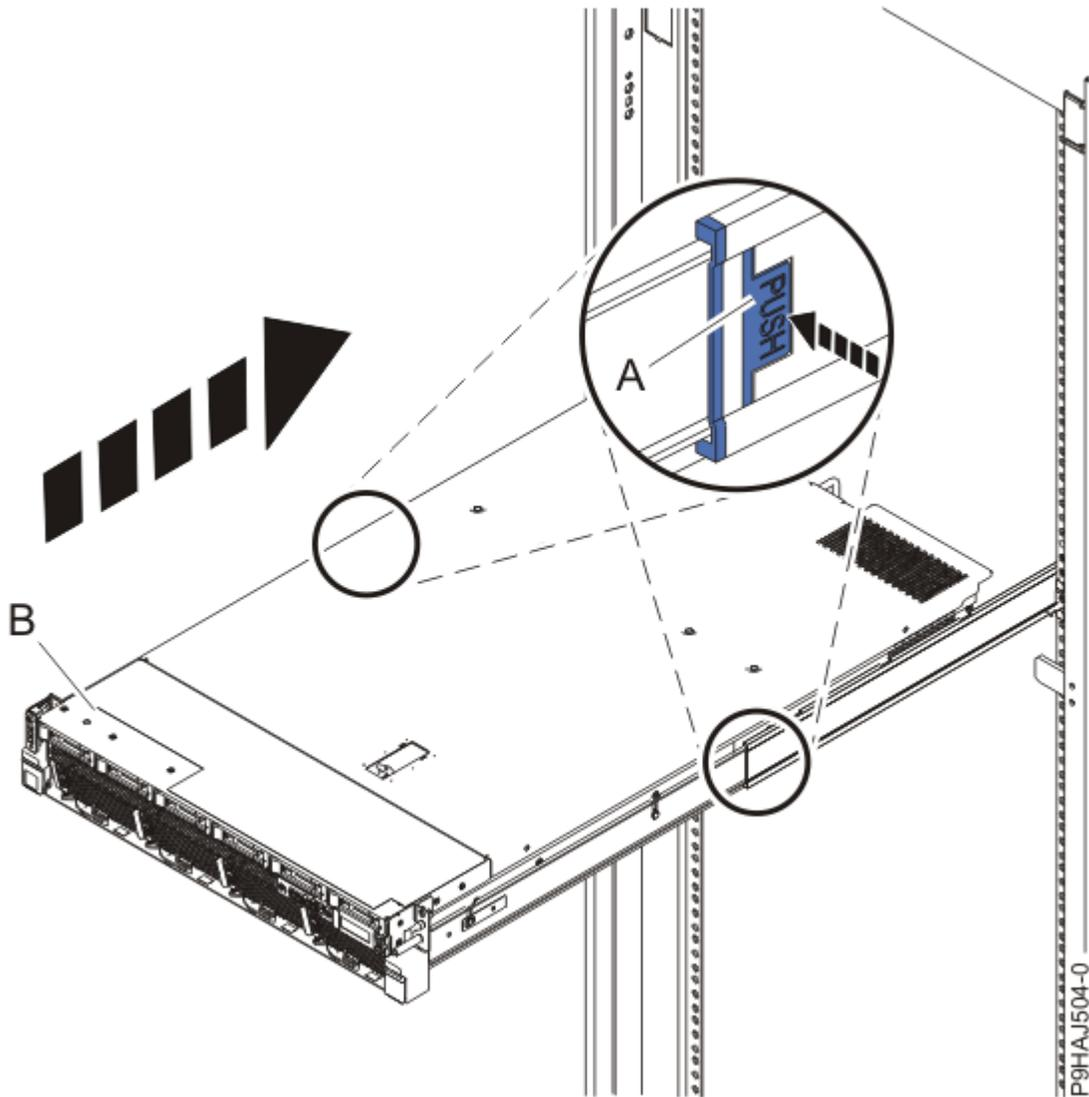
*Figura 77. Colocación del sistema en la posición operativa*
