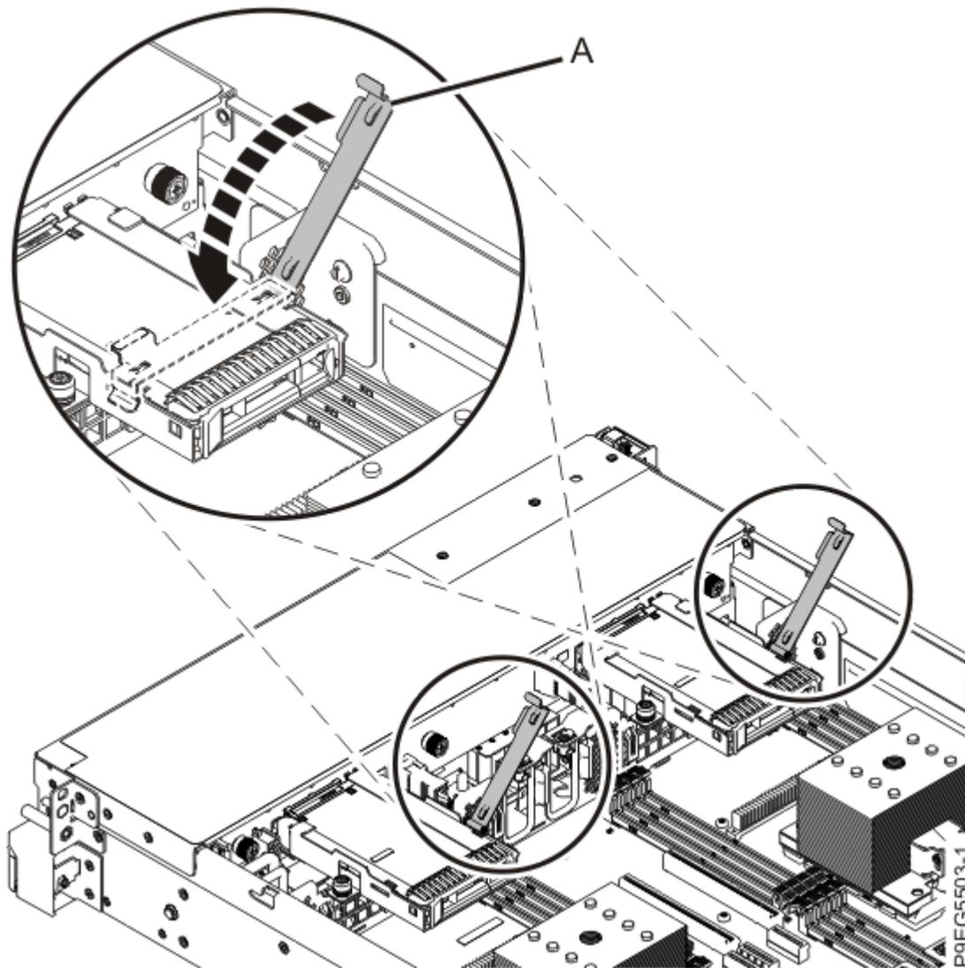
Figura 88. Cierre de la palanca del soporte de la unidad
