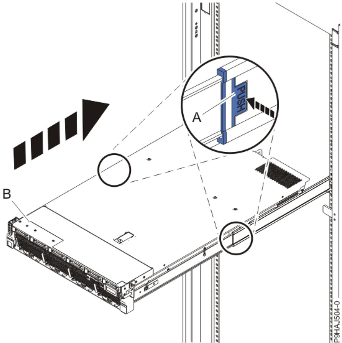
*Figura 34. Colocación del sistema en la posición operativa*
