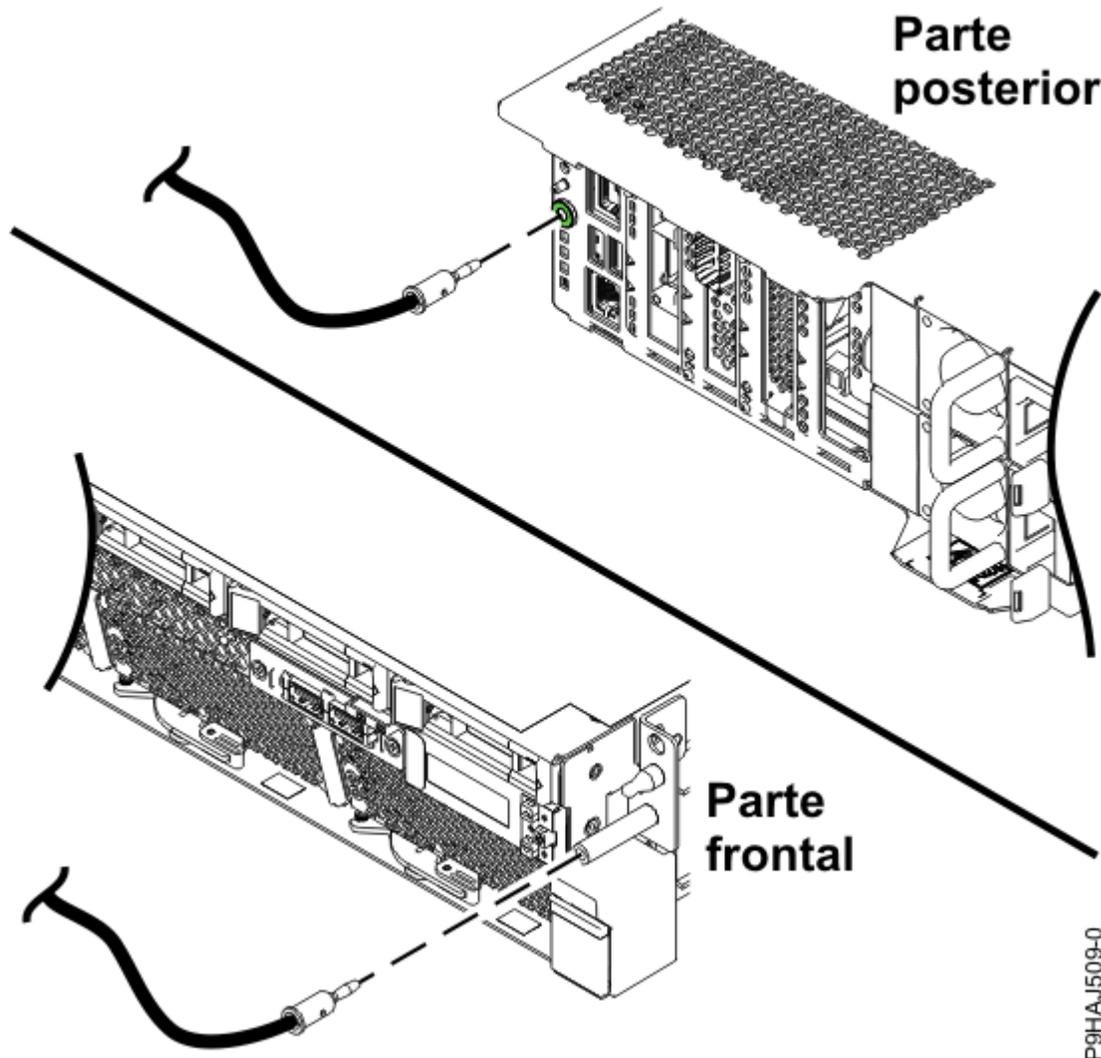
Figura 9. Ubicación de los enchufes de descarga electrostática en un sistema 9008-22L, 9009-22A o 9223-22H
