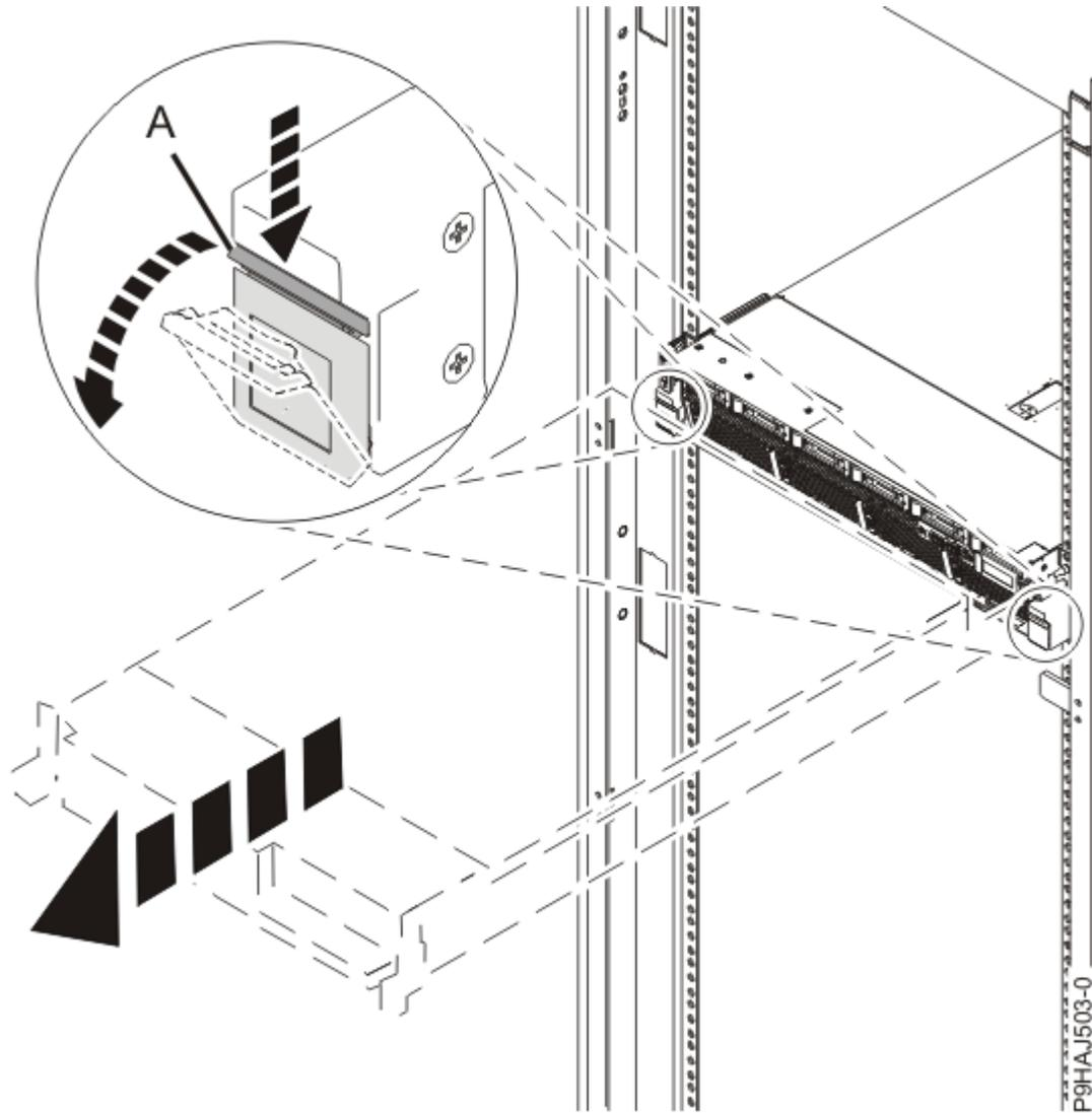
Figura 40. Cómo abrir los pestillos laterales
