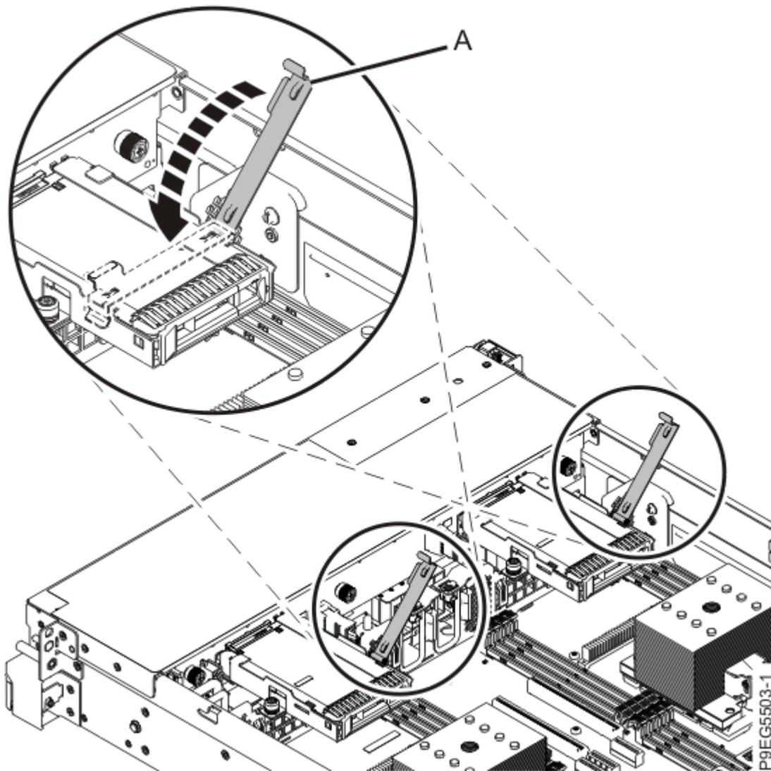
*Figura 15. Cierre de la palanca del soporte de la unidad*
