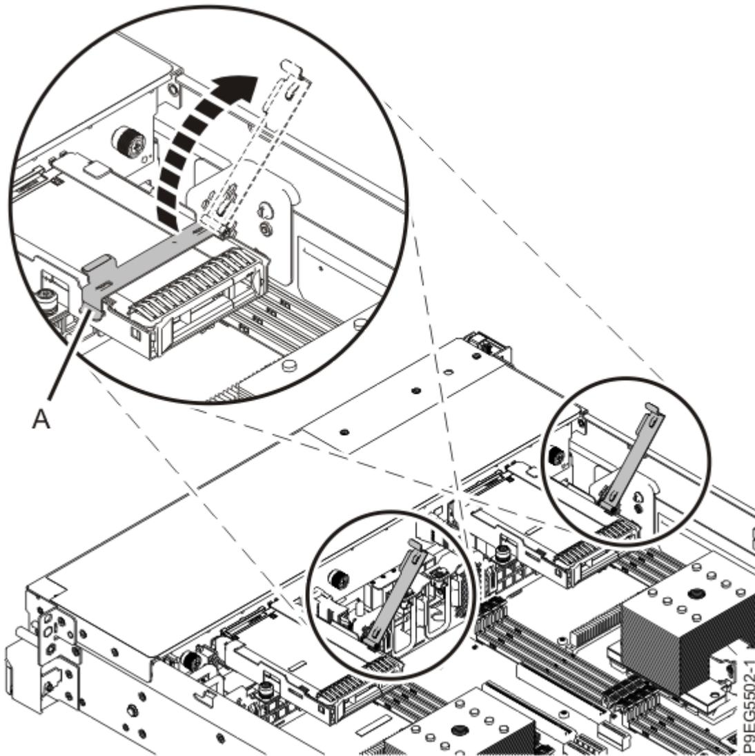
*Figura 27. Apertura de la palanca del soporte de la unidad*
