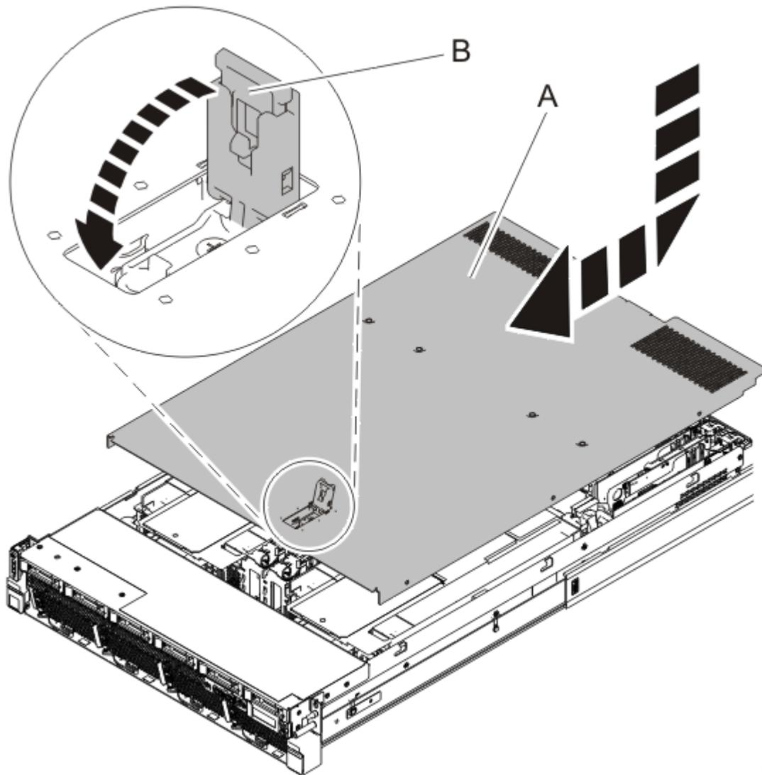
Figura 92. Instalación de la cubierta de acceso de servicio
