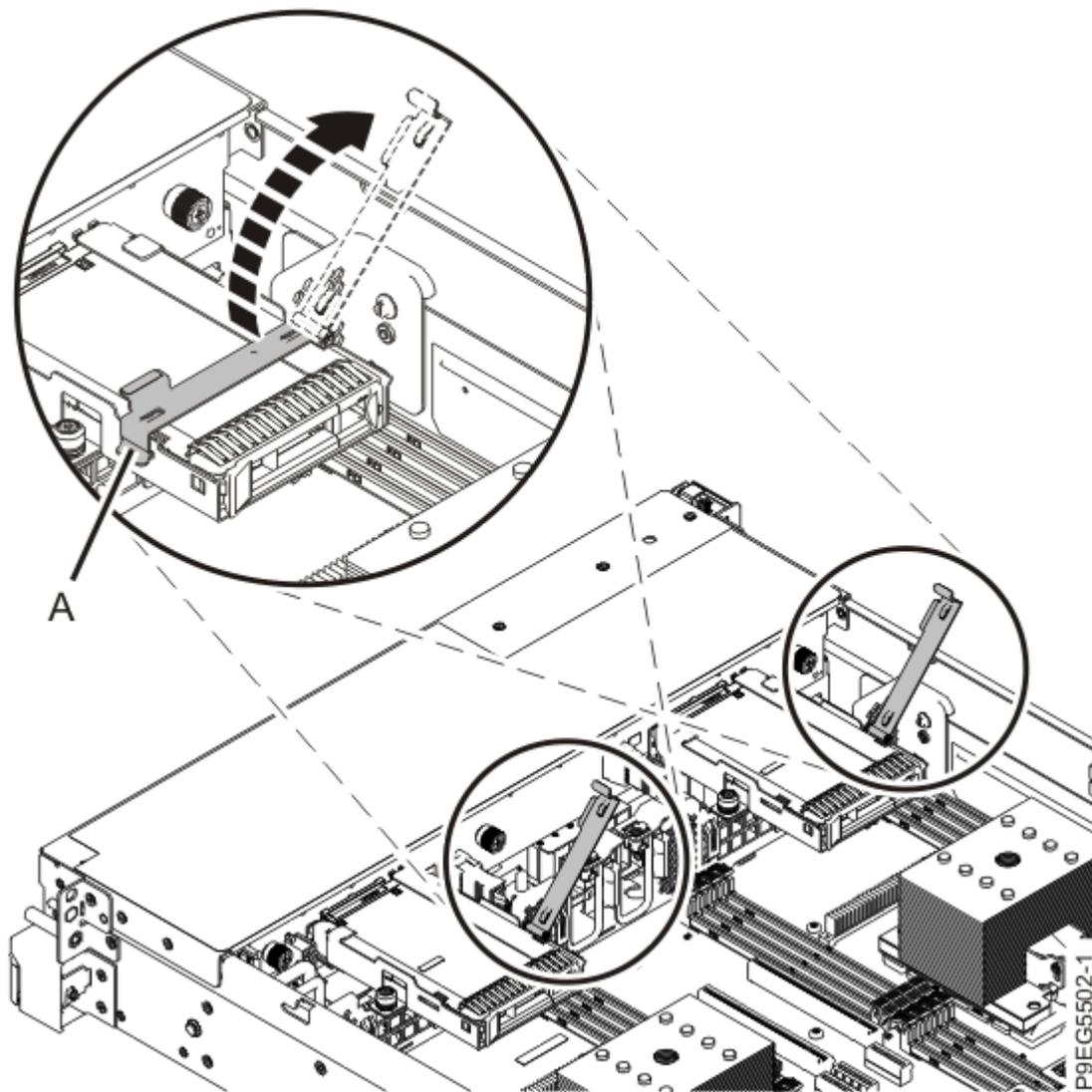
*Figura 62. Apertura de la palanca del soporte de la unidad*
