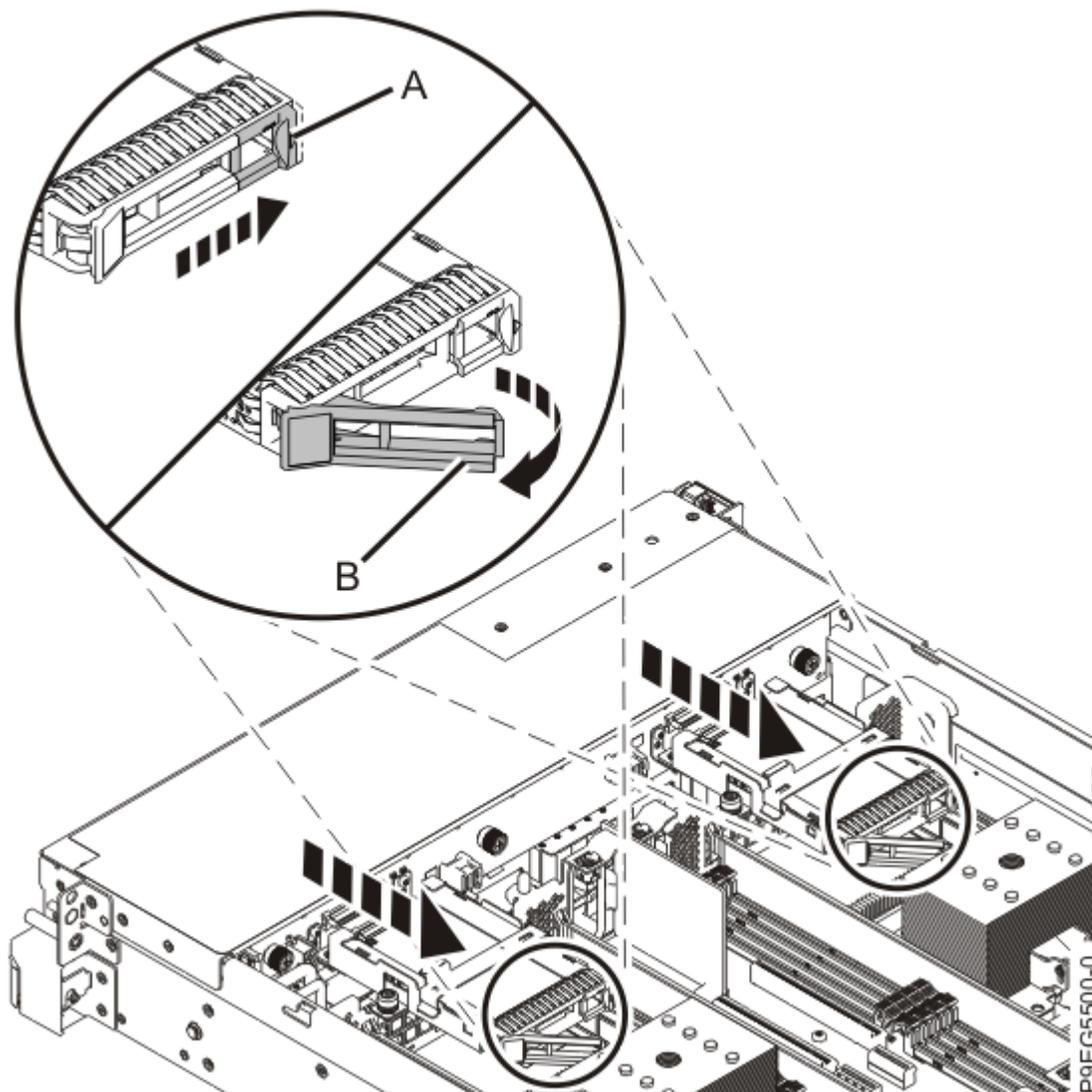
*Figura 86. Desbloqueo del asa de la unidad*
