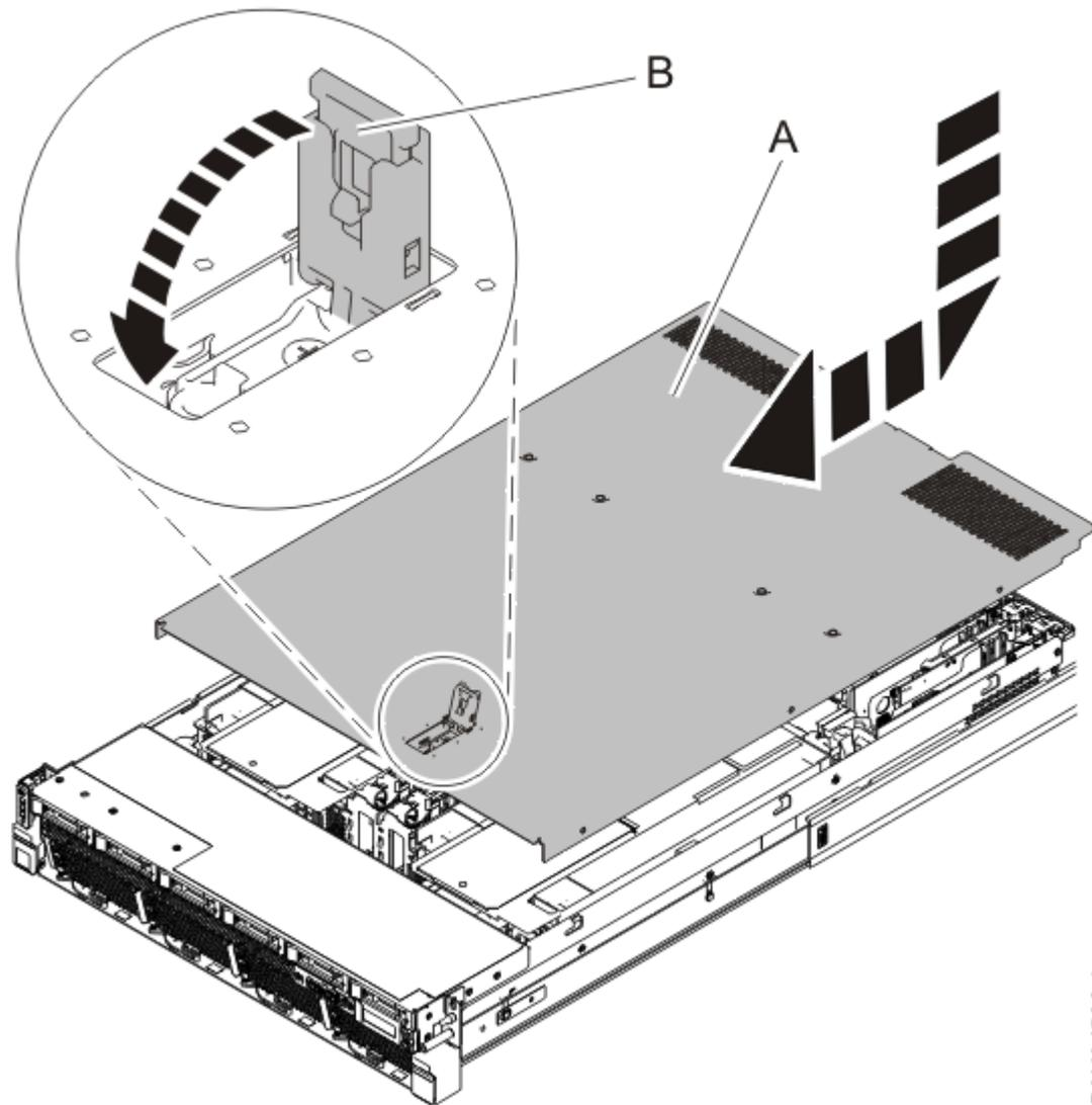
*Figura 76. Instalación de la cubierta de acceso de servicio*
