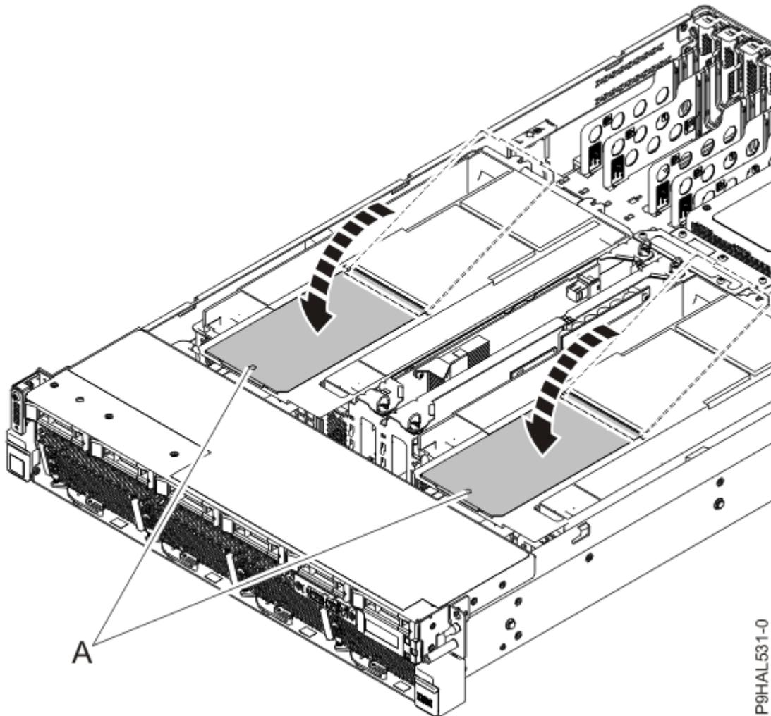
Figura 75. Cierre de las puertas de acceso abatibles en los deflectores de aire del sistema 9008-22L, 9009-22A o 9223-22H
