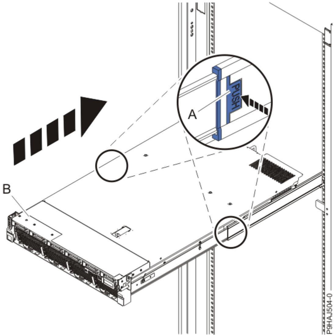
*Figura 93. Colocación del sistema en la posición operativa*
