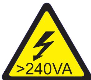
**PRECAUCIÓN:** Niveles energéticos peligrosos. Los voltajes con niveles energéticos peligrosos pueden ocasionar un calentamiento cuando falta el material conductor, cosa que puede provocar salpicaduras de metal, quemaduras o ambas cosas. (L005)
