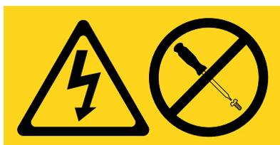
**PELIGRO:** Existen niveles de energía, corriente o voltaje peligrosos dentro de los componentes que tienen adjunta esta etiqueta. No abra ninguna cubierta o barrera que contenga esta etiqueta. (L001)
