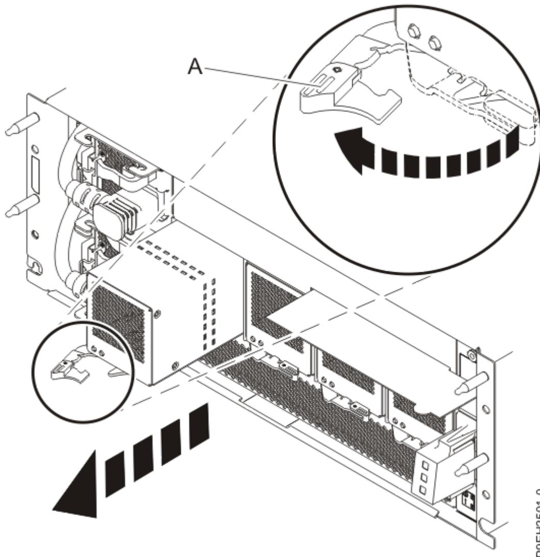
*Figura 4. Extracción de un ventilador del cajón de expansión PCIe3 EMX0*
