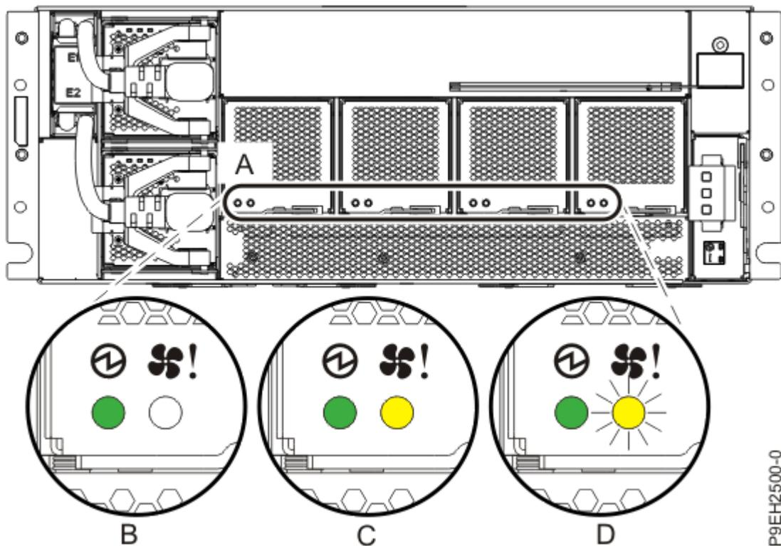
**(B)** Indica que los ventiladores funcionan correctamente. El LED de alimentación de color verde (LED de la izquierda) está encendido de forma fija y el LED de error de color ámbar (LED de la derecha) está apagado.
