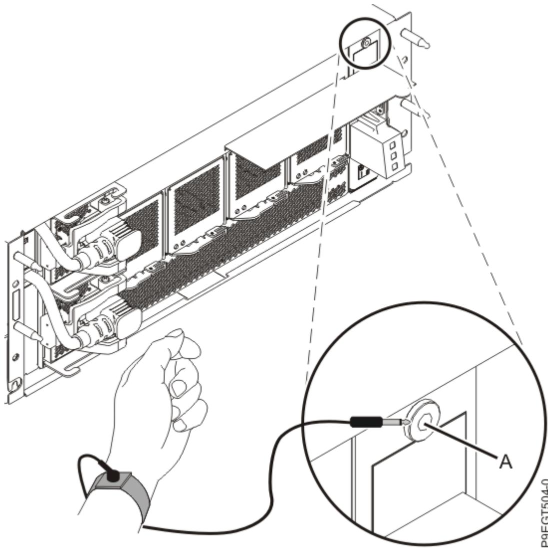
*Figura 2. Fijación de la muñequera antiestática ESD en la clavija ESD frontal*
