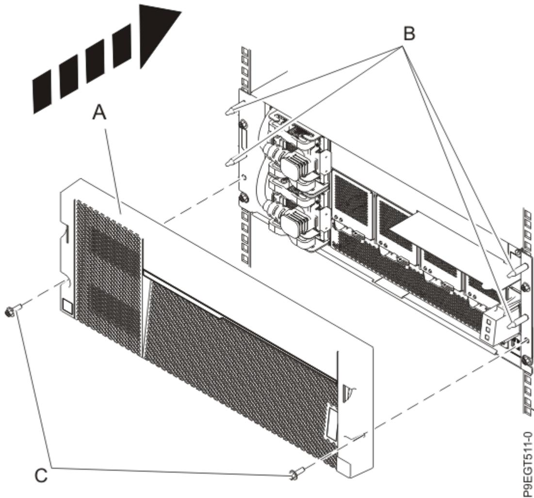
Figura 8. Sustitución de la cubierta frontal
