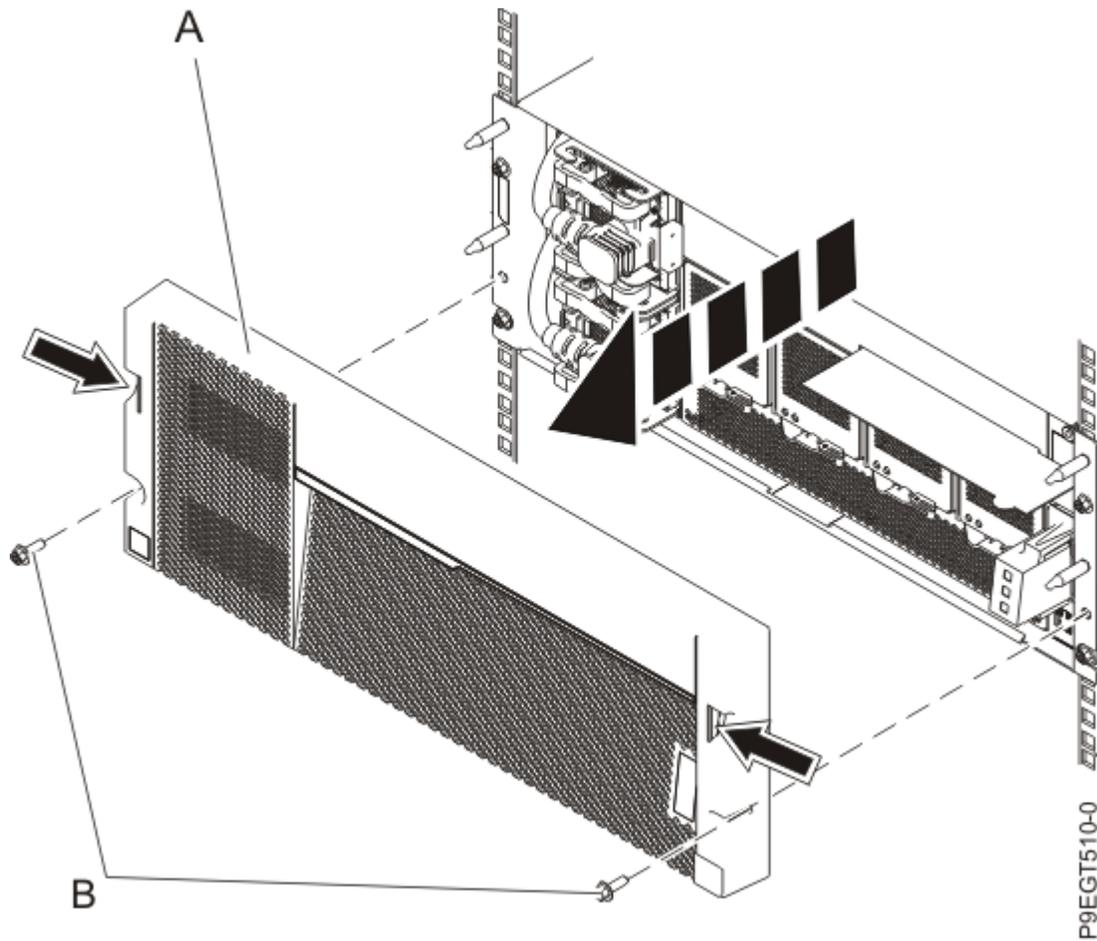
Figura 1. Extracción de la cubierta frontal
