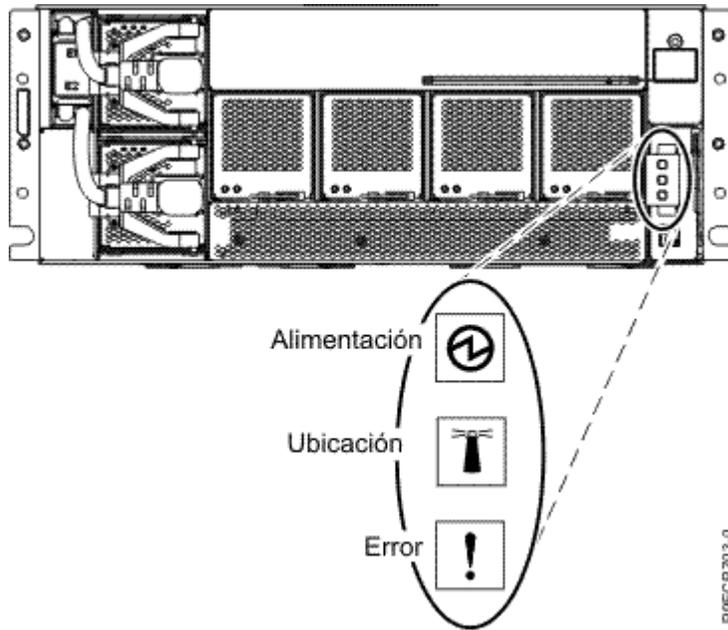
Figura 7. Indicador frontal de alimentación en el cajón de expansión PCIe3 EMX0
