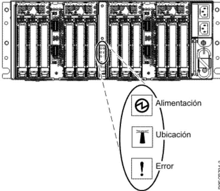
Figura 24. Indicador de alimentación posterior para el cajón de expansión PCIe3 EMX0
