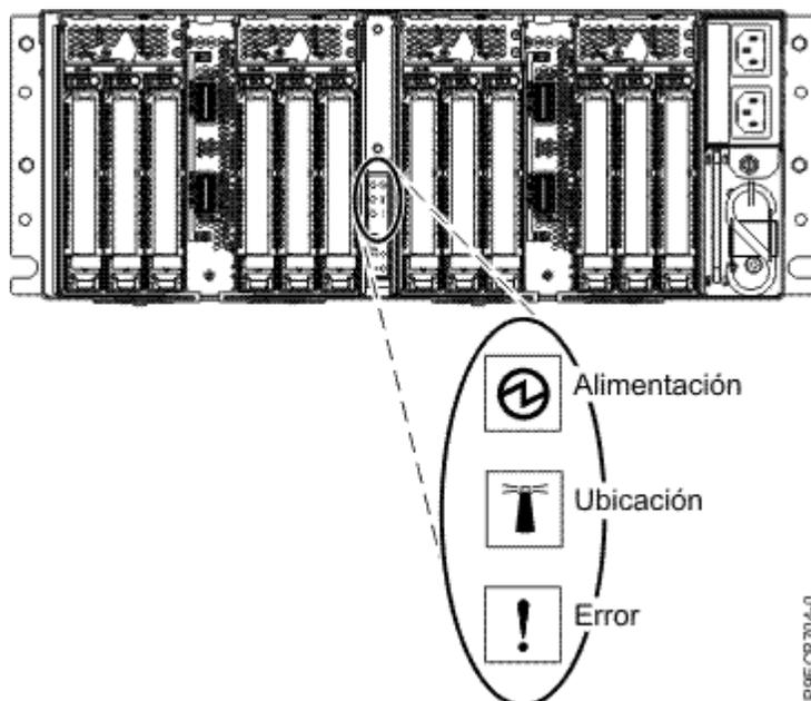
Figura 17. Indicador de alimentación posterior para el cajón de expansión PCIe3 EMX0
