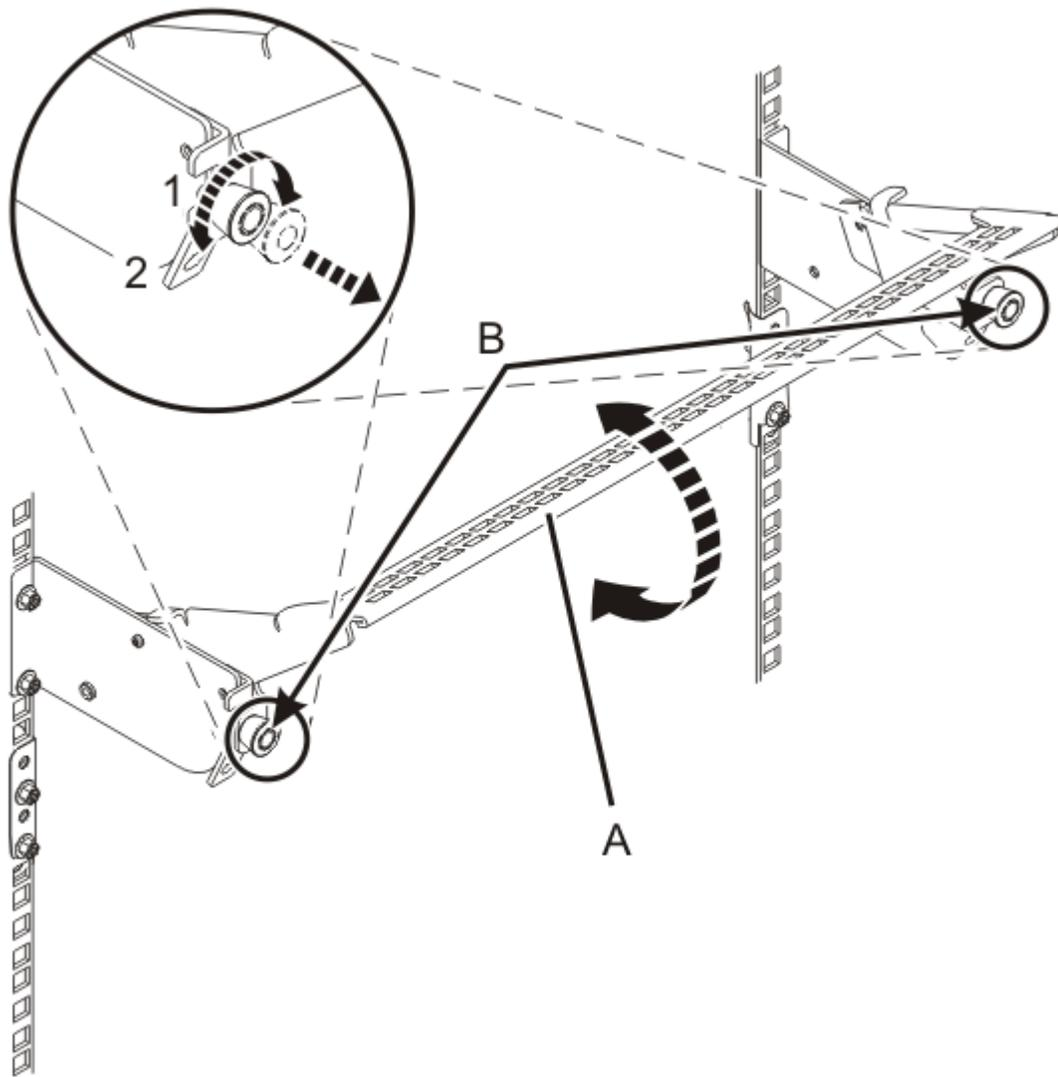
Figura 22. Colocación de la abrazadera portacables en la posición operativa más baja
