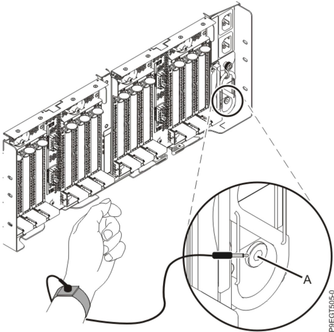
*Figura 8. Ubicación de la clavija ESD en la parte posterior del cajón de expansión PCIe3 EMX0*
