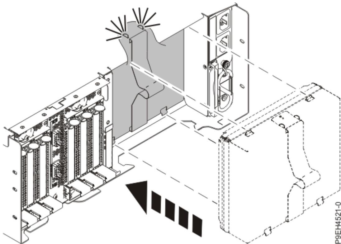
Figura 21. Colocación del panel de relleno
