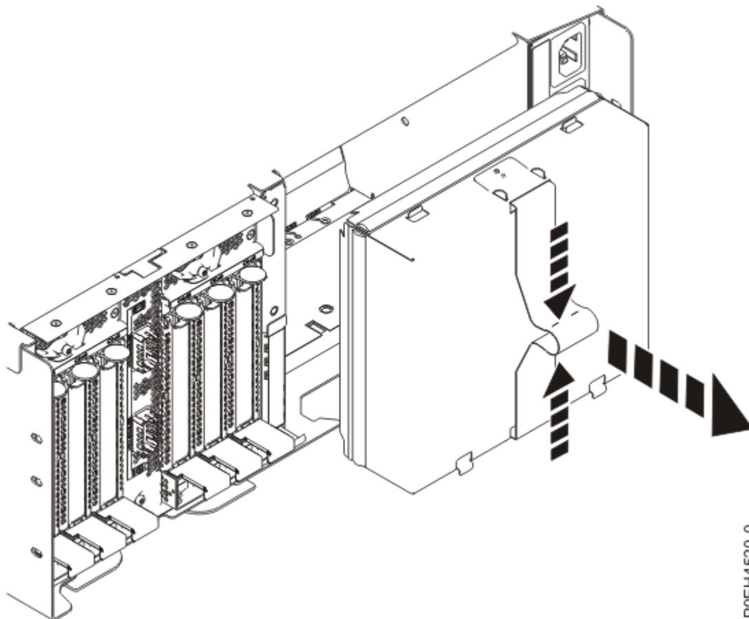
*Figura 3. Extracción del relleno*
