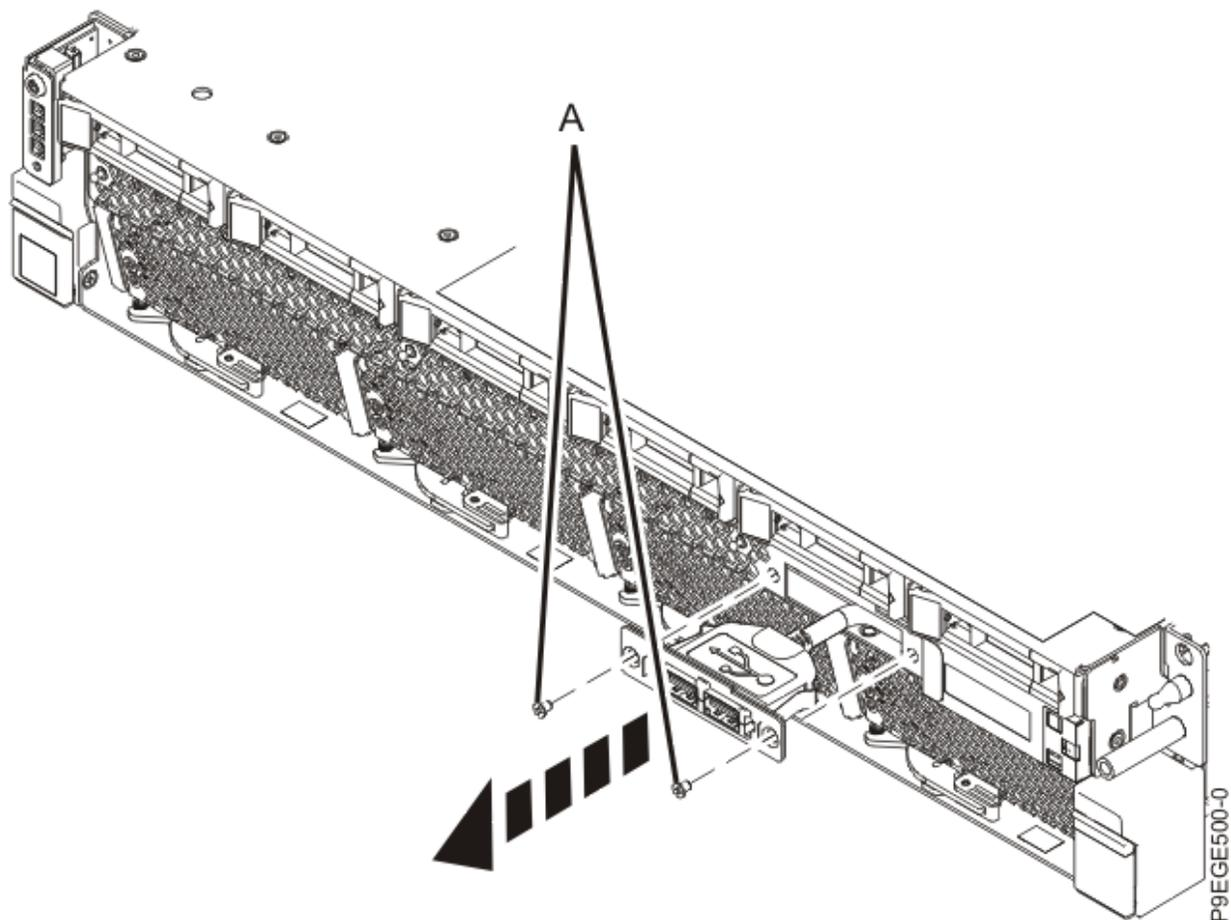
*Figura 8. Extracción de dos tornillos del receptáculo USB frontal*
