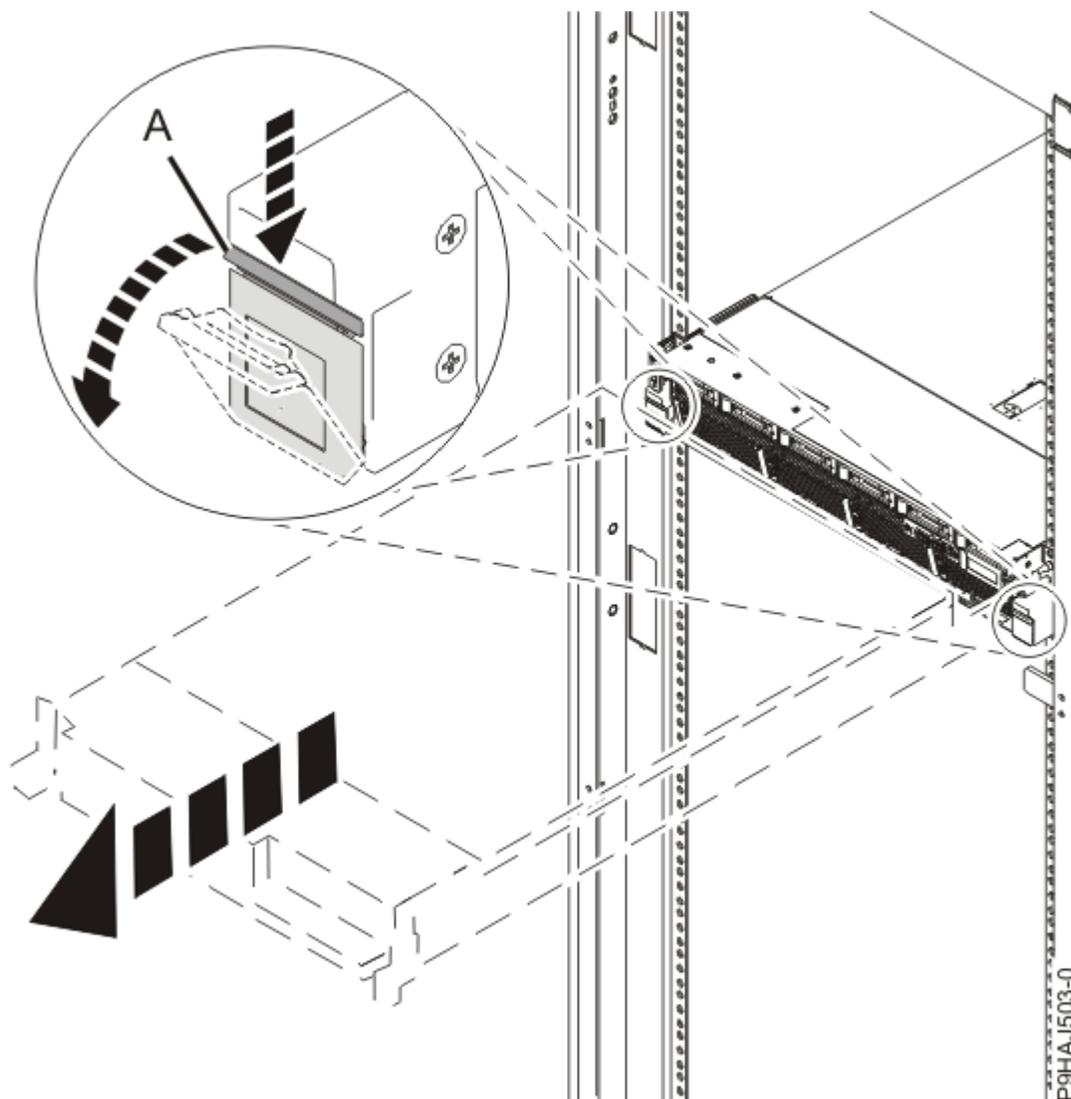
*Figura 3. Cómo abrir los pestillos laterales*
