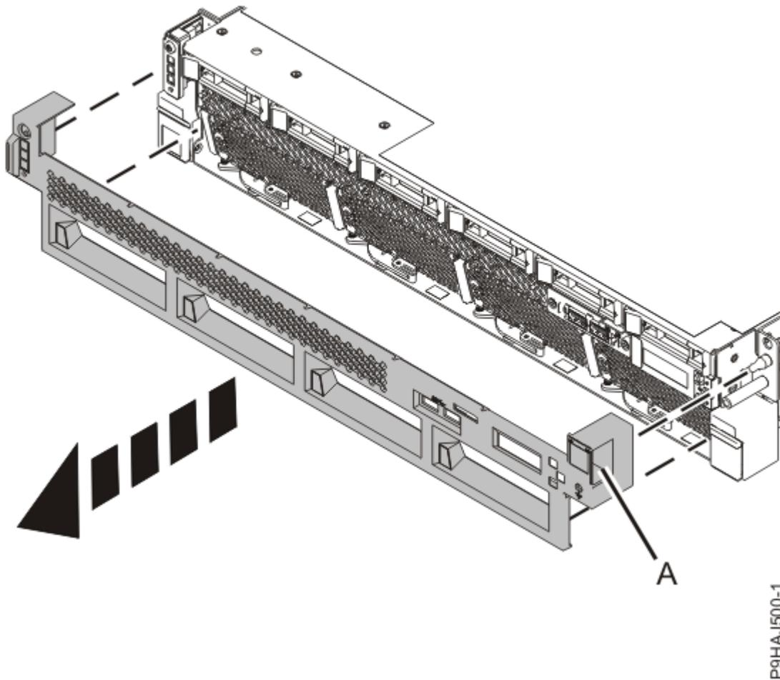
*Figura 2. Extracción de las cubiertas frontales*
