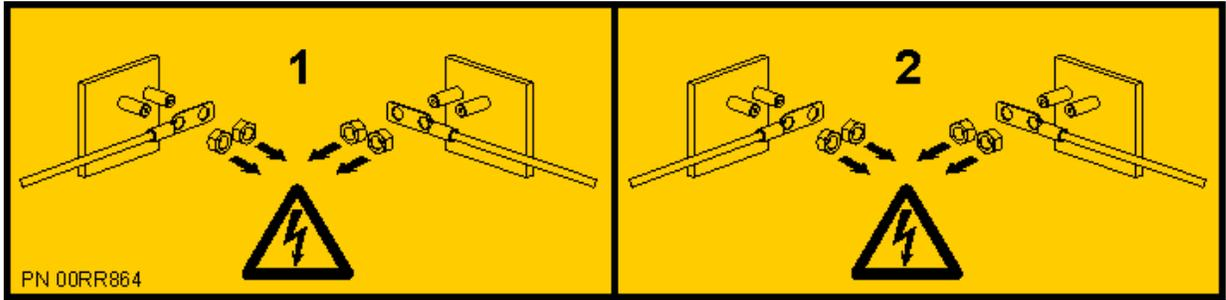
**⚠ PELIGRO:** Varios cables de alimentación. El producto puede estar equipado con múltiples cables de alimentación CA o múltiples cables de alimentación CC. Para evitar todo voltaje peligroso, desconecte todos los cables de alimentación. (L003)
