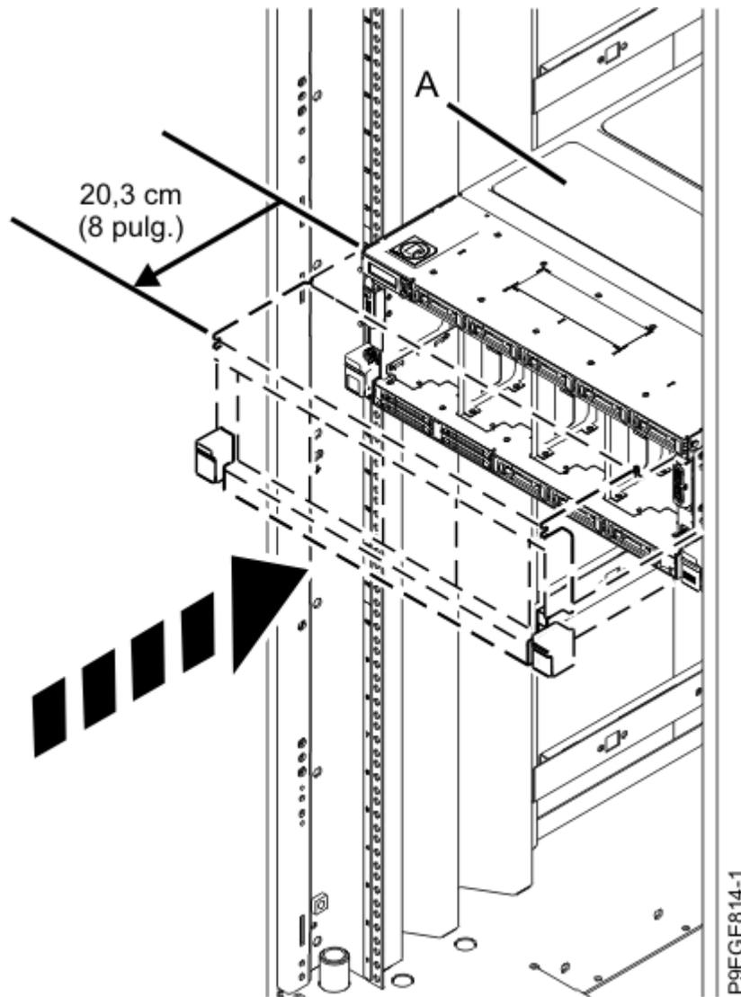
*Figura 43. Colocación del sistema en la posición operativa*
