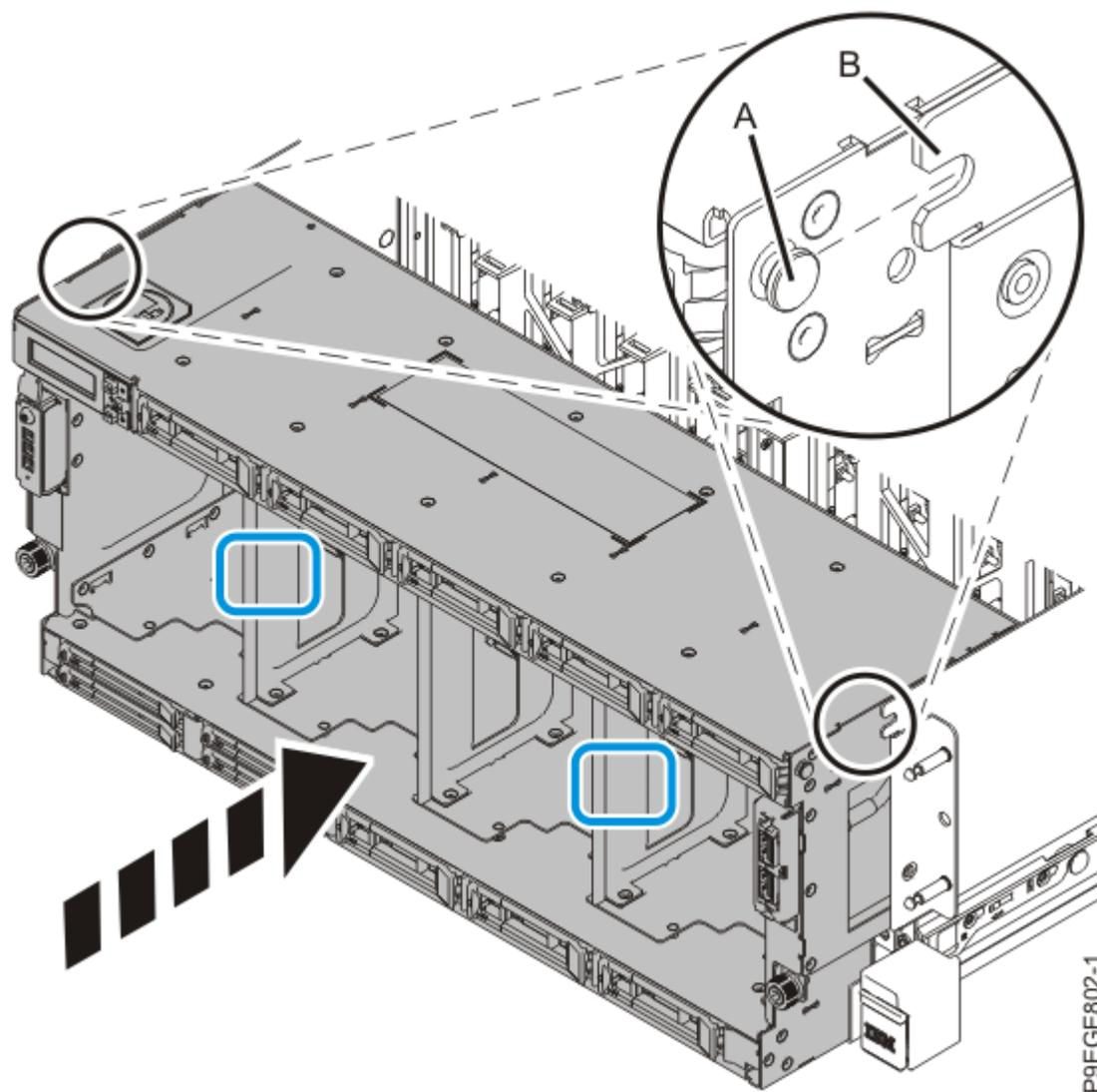
Figura 38. Sustitución parcial de la placa posterior de la unidad de disco
