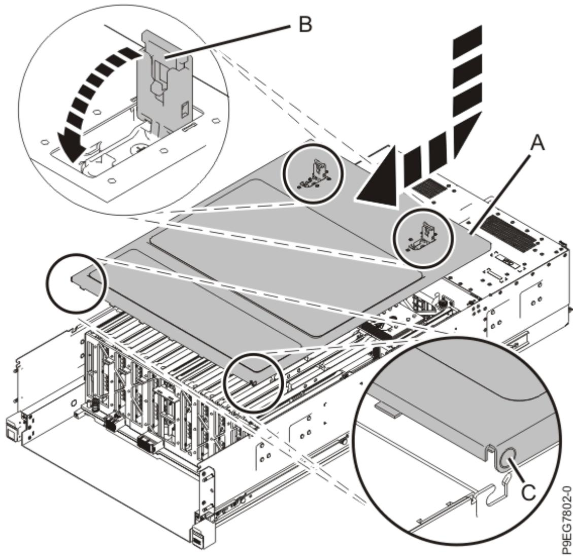
*Figura 18. Instalación de la cubierta de acceso de servicio*
