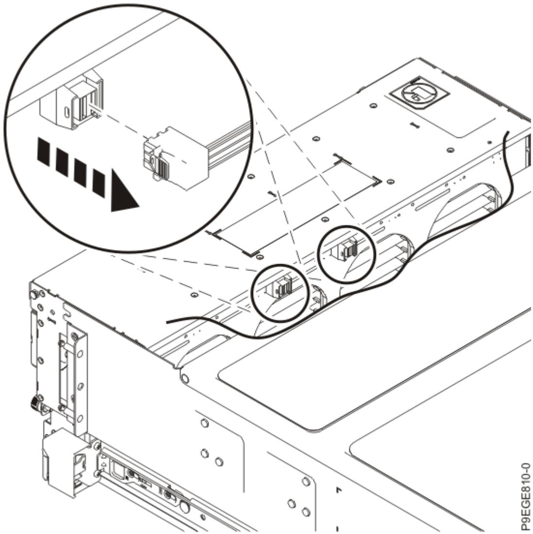
Figura 12. Desconexión de los cables SAS de la placa posterior de la unidad de disco duro base
