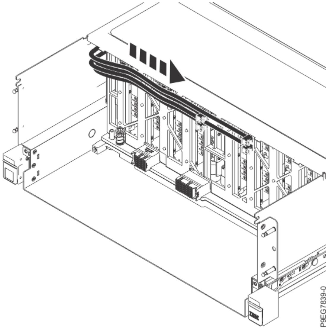
*Figura 37. Direccionamiento de los cables SAS para una placa posterior de unidad de disco de función ampliada*
