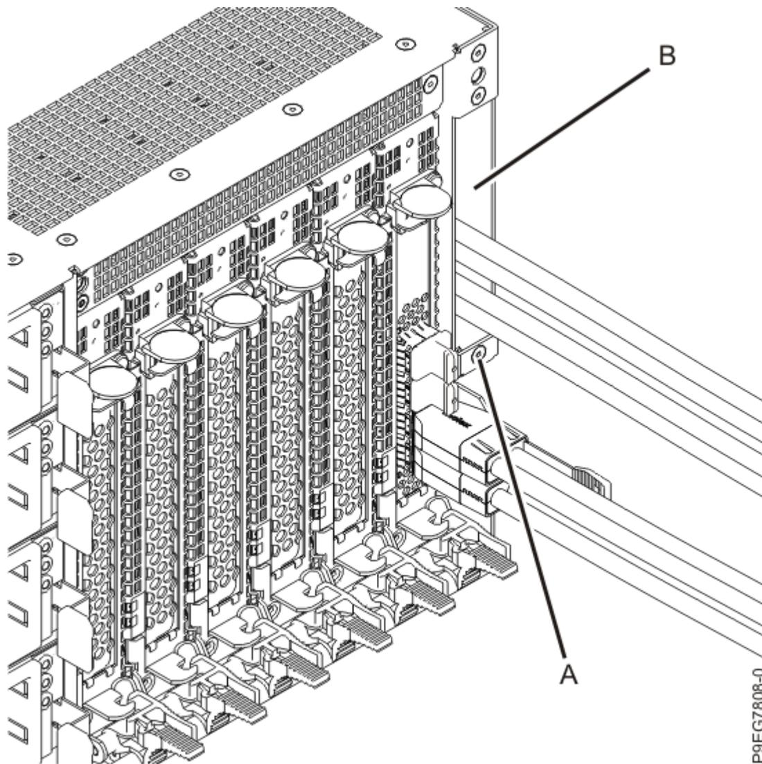
Figura 1. Identificación de los cables SAS protegidos internamente
