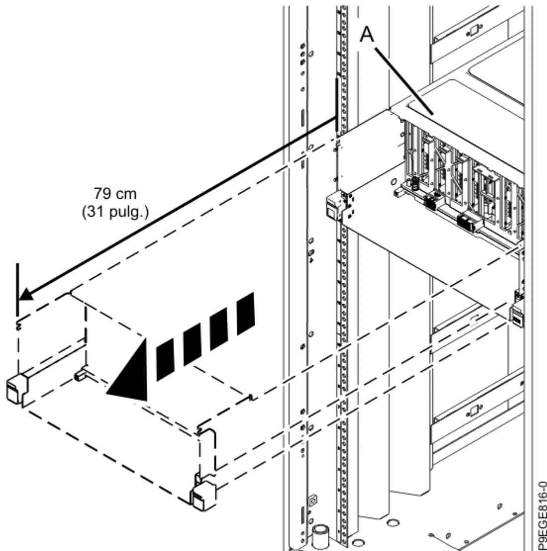
*Figura 15. Deslizamiento parcial del sistema desde el bastidor*
