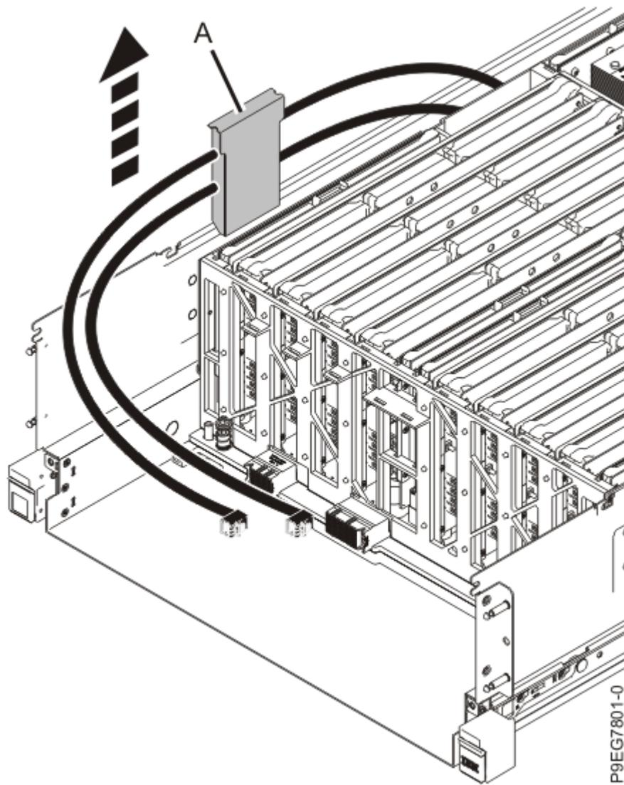
Figura 16. Extracción del soporte del cable SAS para una placa posterior de unidad de disco de función base
