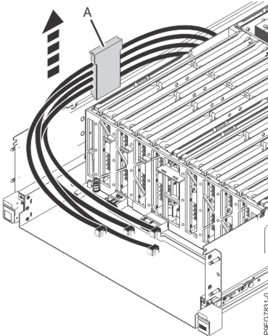
Figura 17. Extracción del soporte de cable SAS para una placa posterior de unidad de disco de función ampliada
