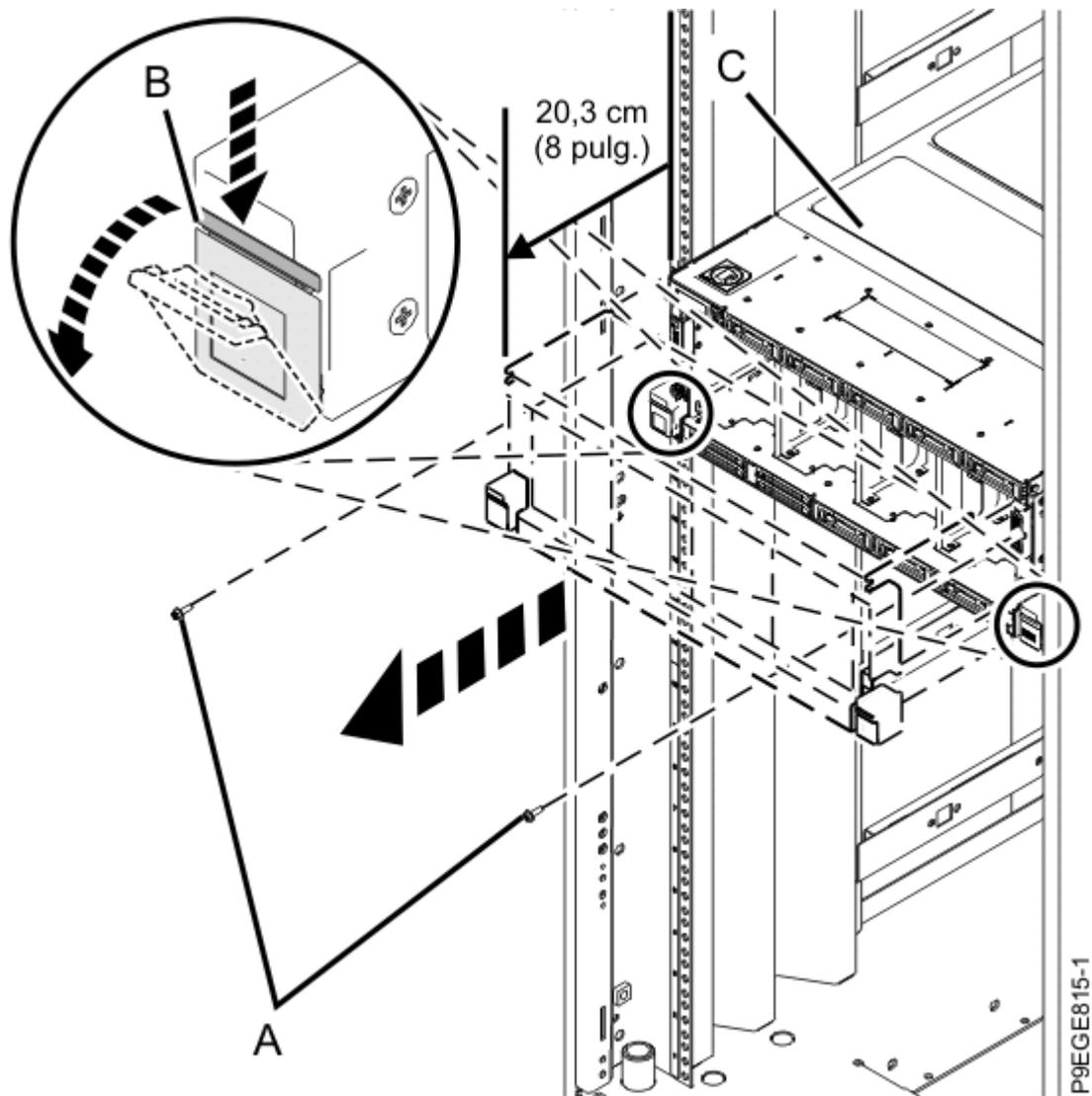
Figura 11. Deslizamiento parcial del sistema desde el bastidor
