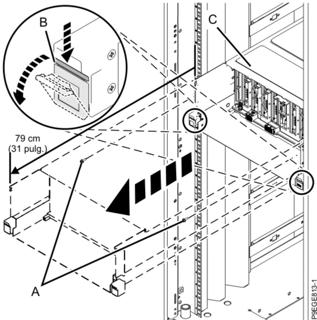
Figura 32. Deslizamiento parcial del sistema desde el bastidor
