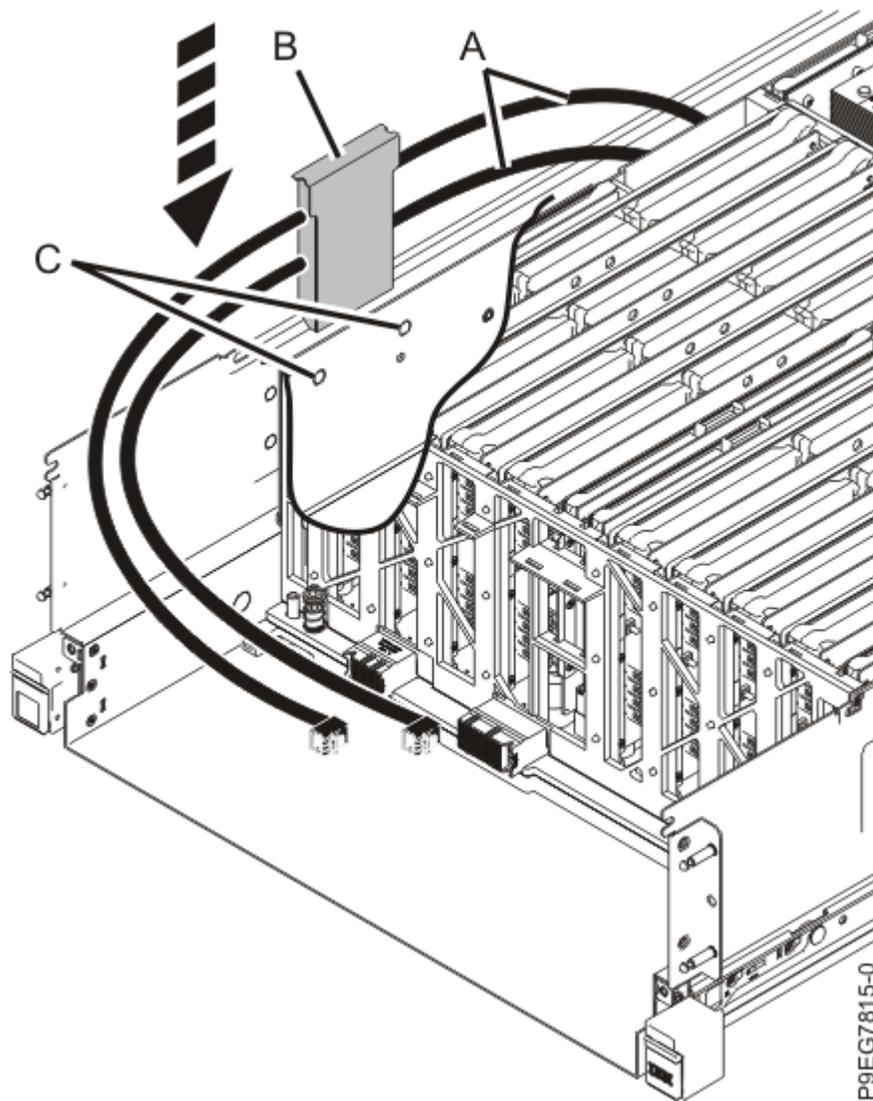
Figura 34. Sustitución del soporte de cable SAS para una placa posterior de unidad de disco de función base
