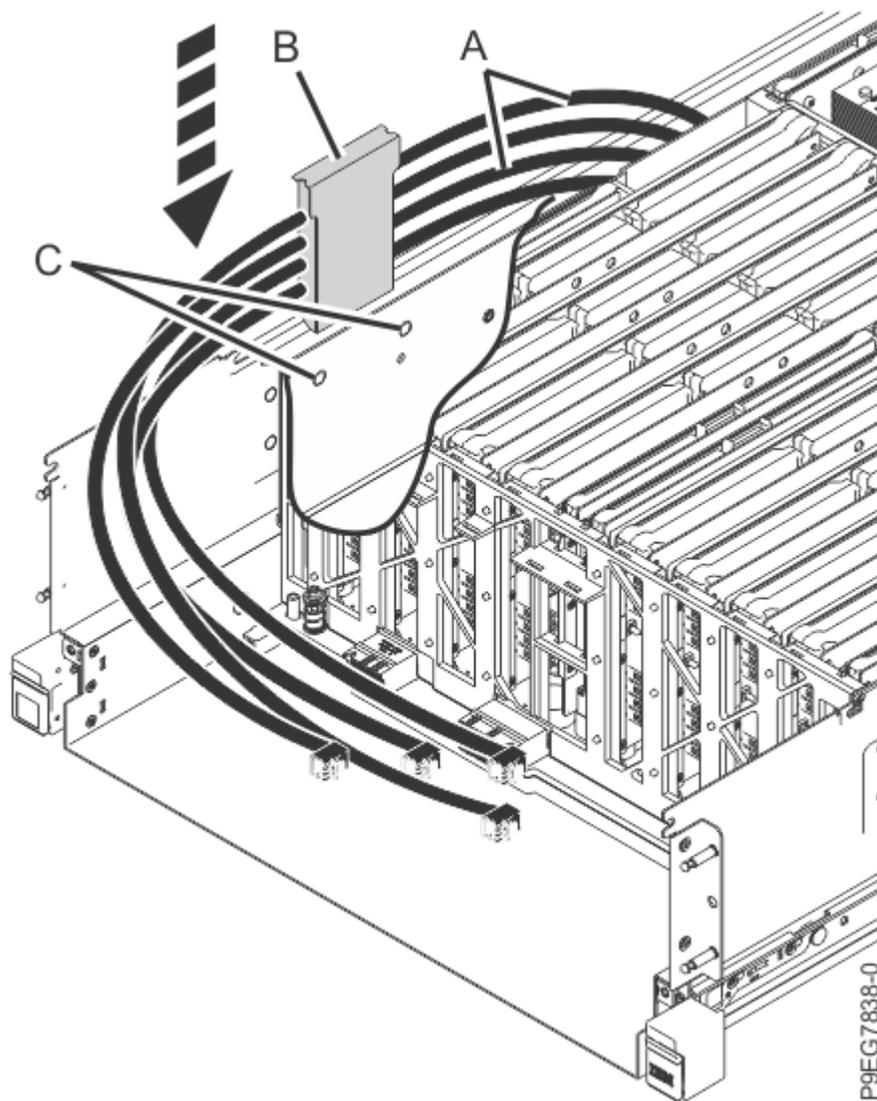
*Figura 35. Sustitución del soporte de cable SAS para una placa posterior de unidad de disco de función ampliada*
