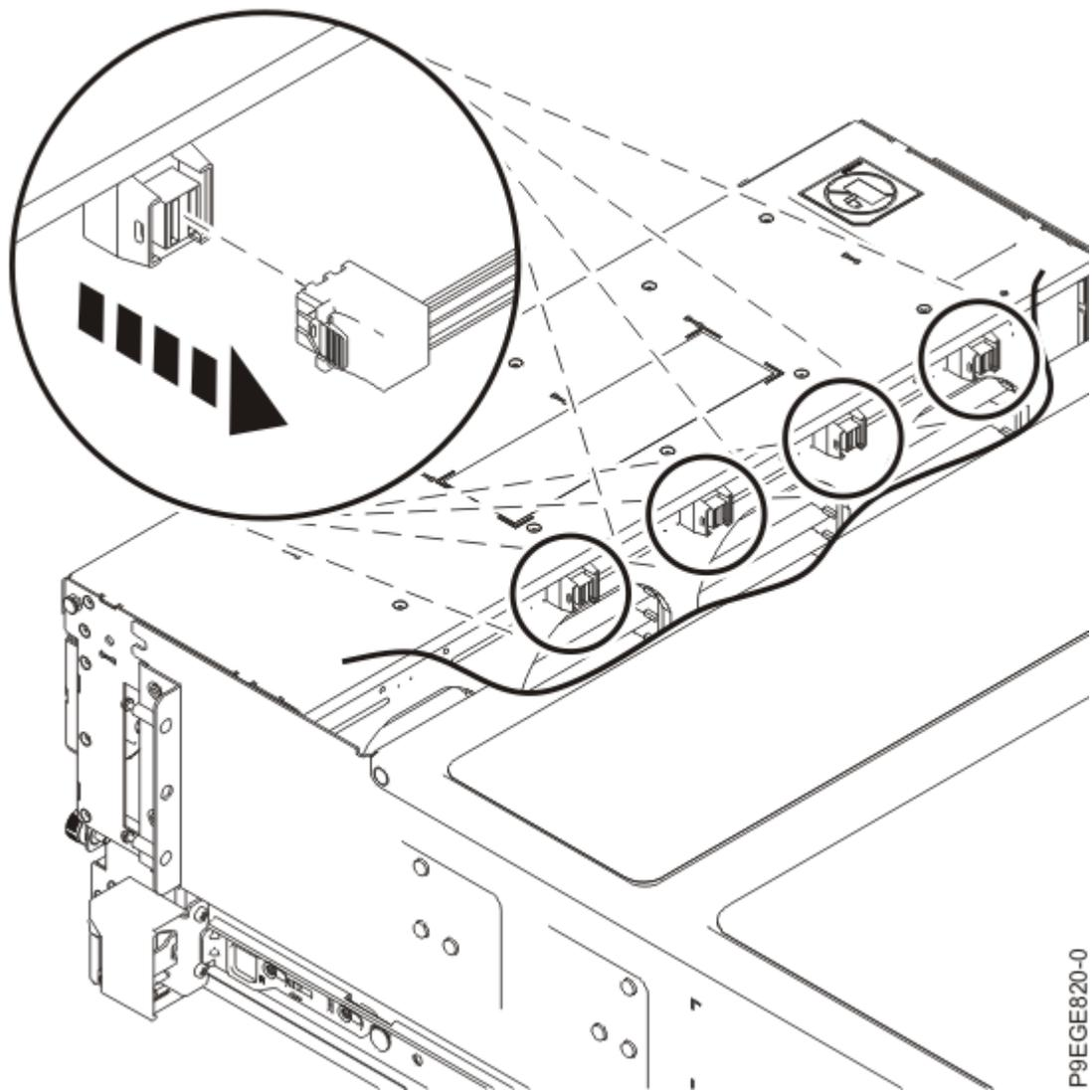
*Figura 13. Desconexión de los cables SAS de la placa posterior de la unidad de disco ampliada*
