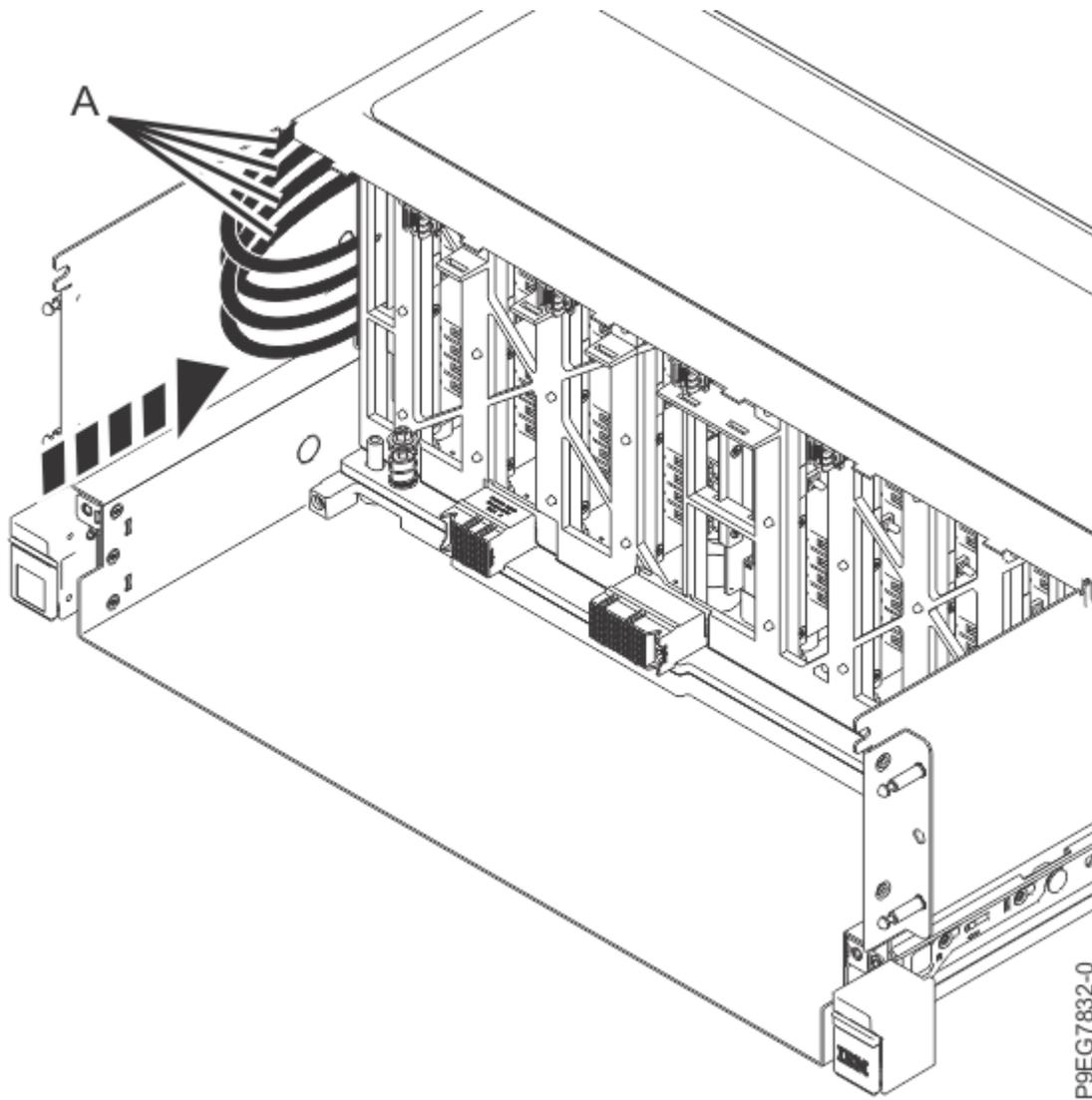
*Figura 20. Enlace en bucle y presión de los cables SAS dentro del sistema para una placa posterior de unidad de disco de función ampliada*
