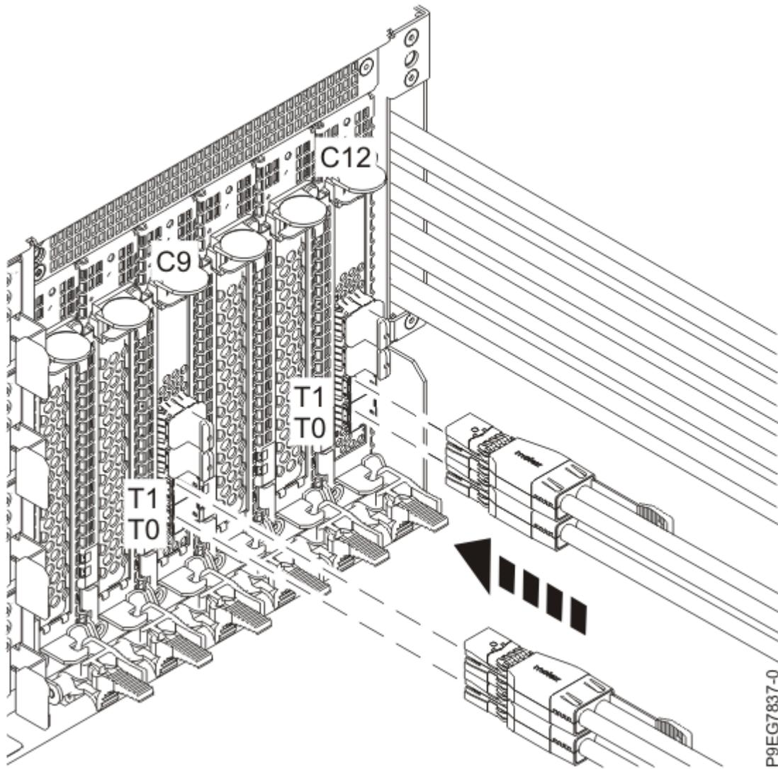
Figura 31. Conexión de los cables SAS para una placa posterior de unidad de disco de función ampliada
