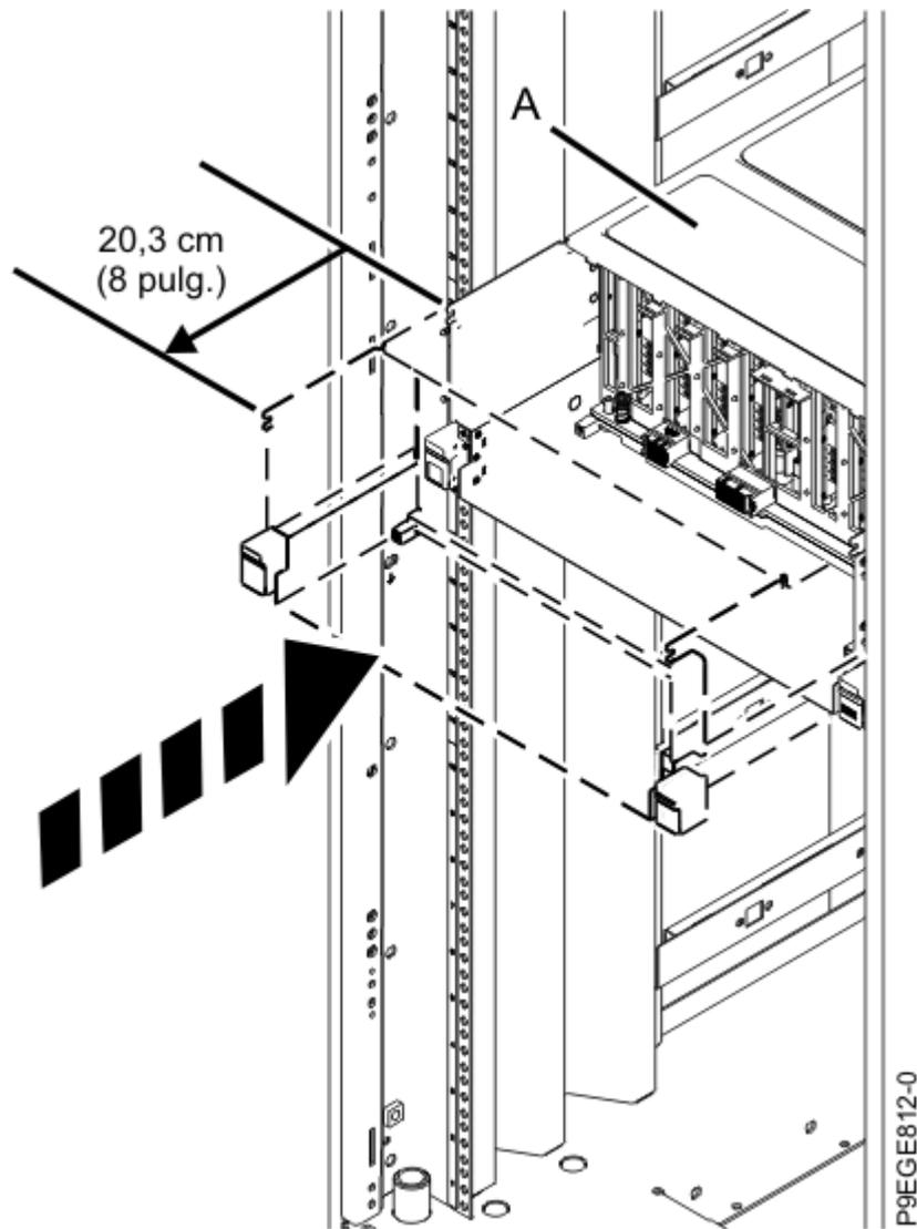
*Figura 39. Deslizamiento parcial del sistema en el bastidor*
