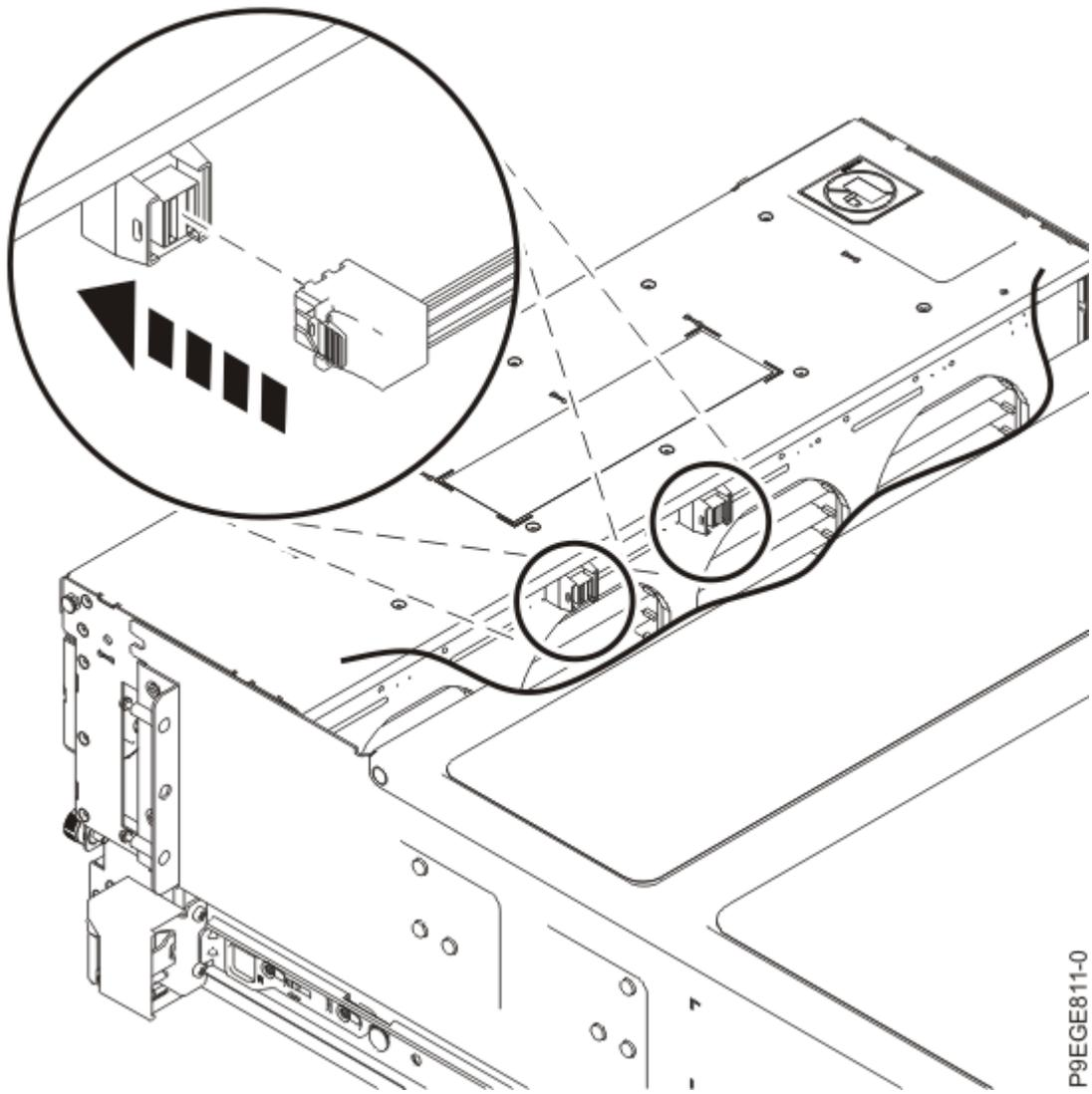
Figura 40. Conexión de los cables SAS a la placa posterior de la unidad de disco de función base
