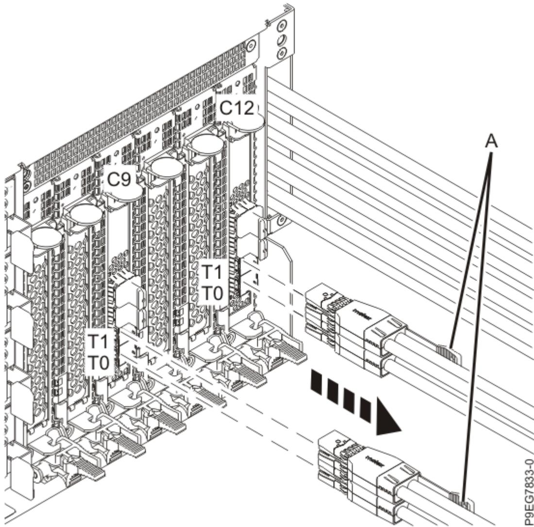
Figura 24. Desconexión de los cables SAS para una placa posterior de unidad de disco de función ampliada
