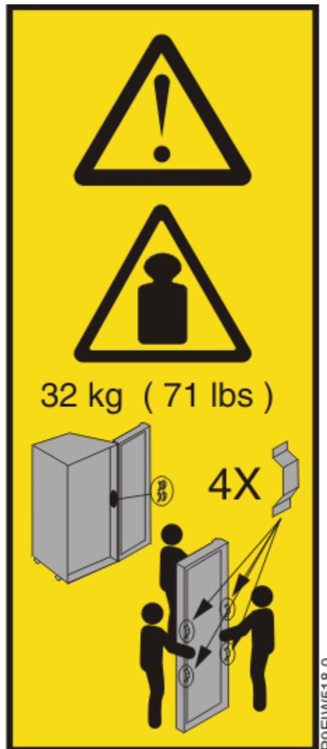
Abbildung 99. Gewicht des Wärmetauschers und Hebegriffe
