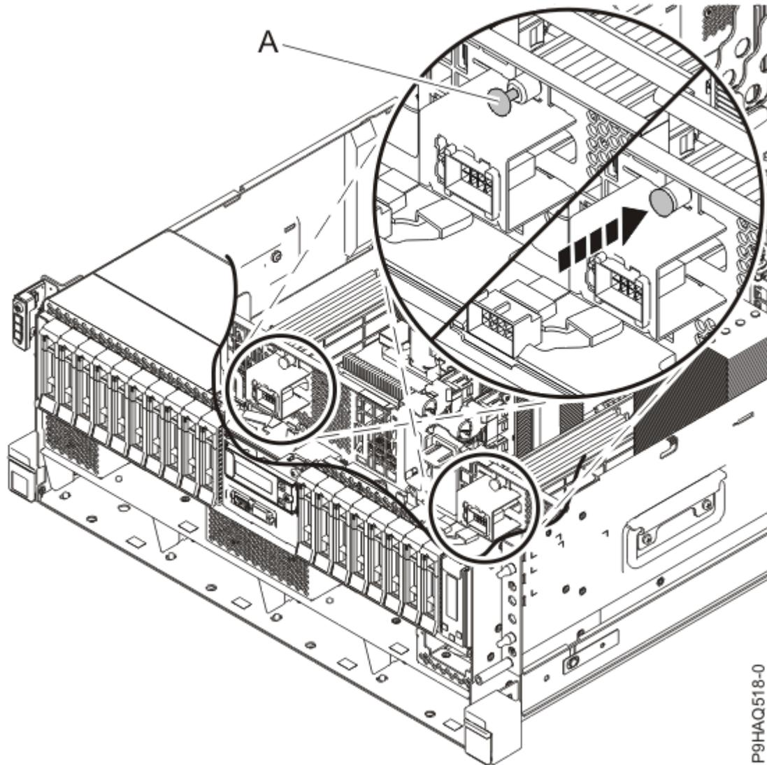
Abbildung 29. Lüftersockel an der Trennwand befestigen
