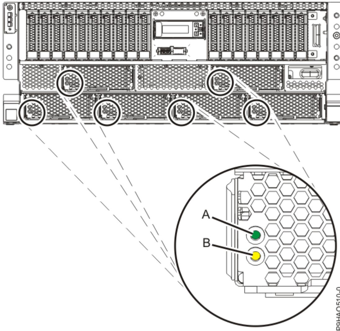
Abbildung 5. Lüfter-LEDs in einem Einschubsystem
