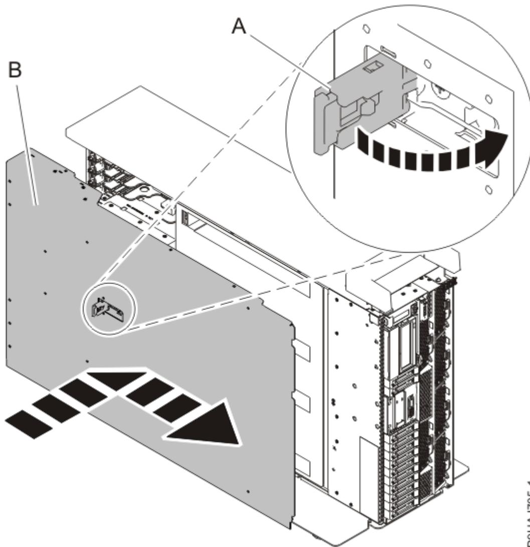
Abbildung 34. Serviceabdeckung installieren
