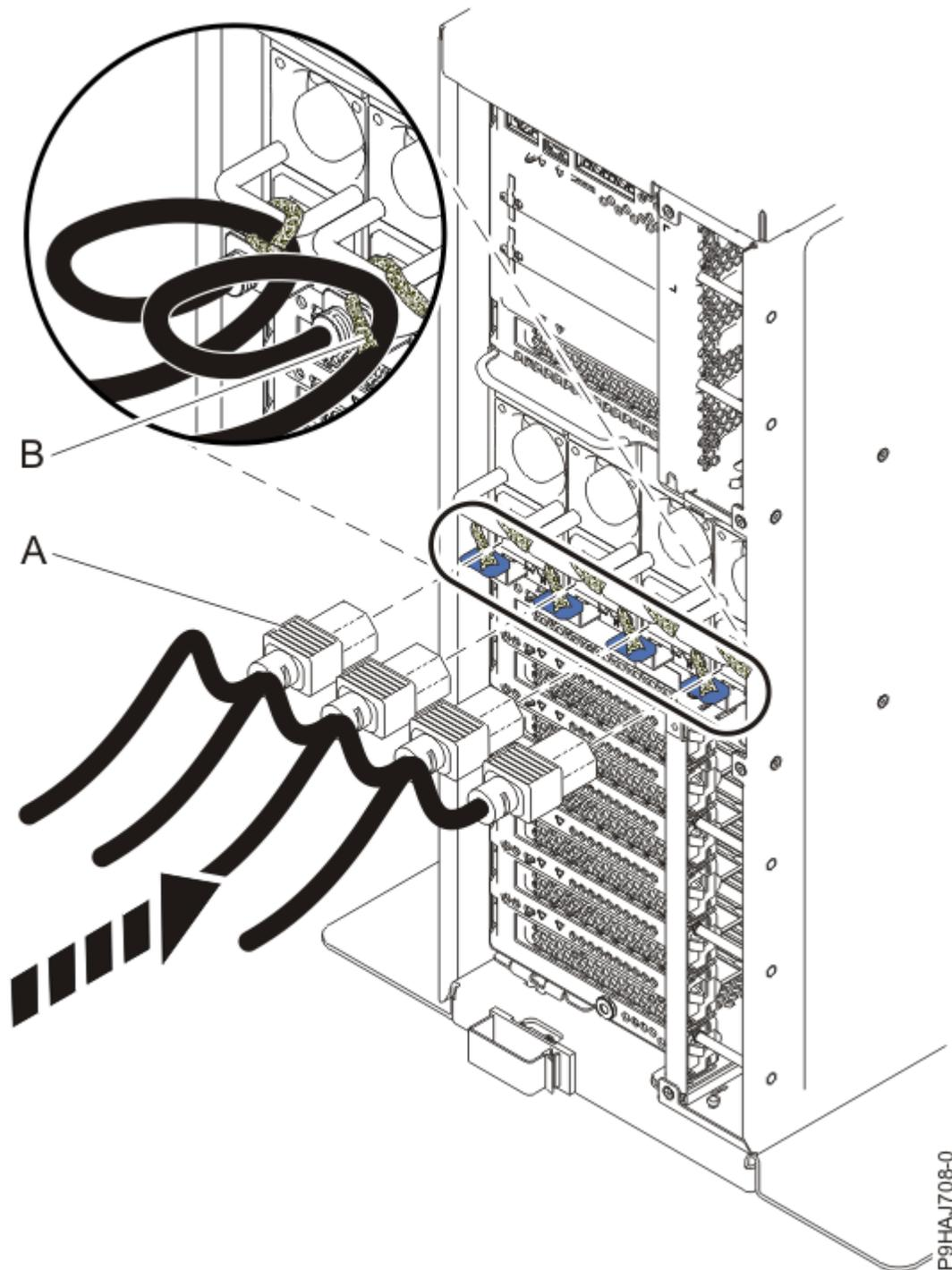
Abbildung 37. Netzkabel an ein Standalone-System anschließen
