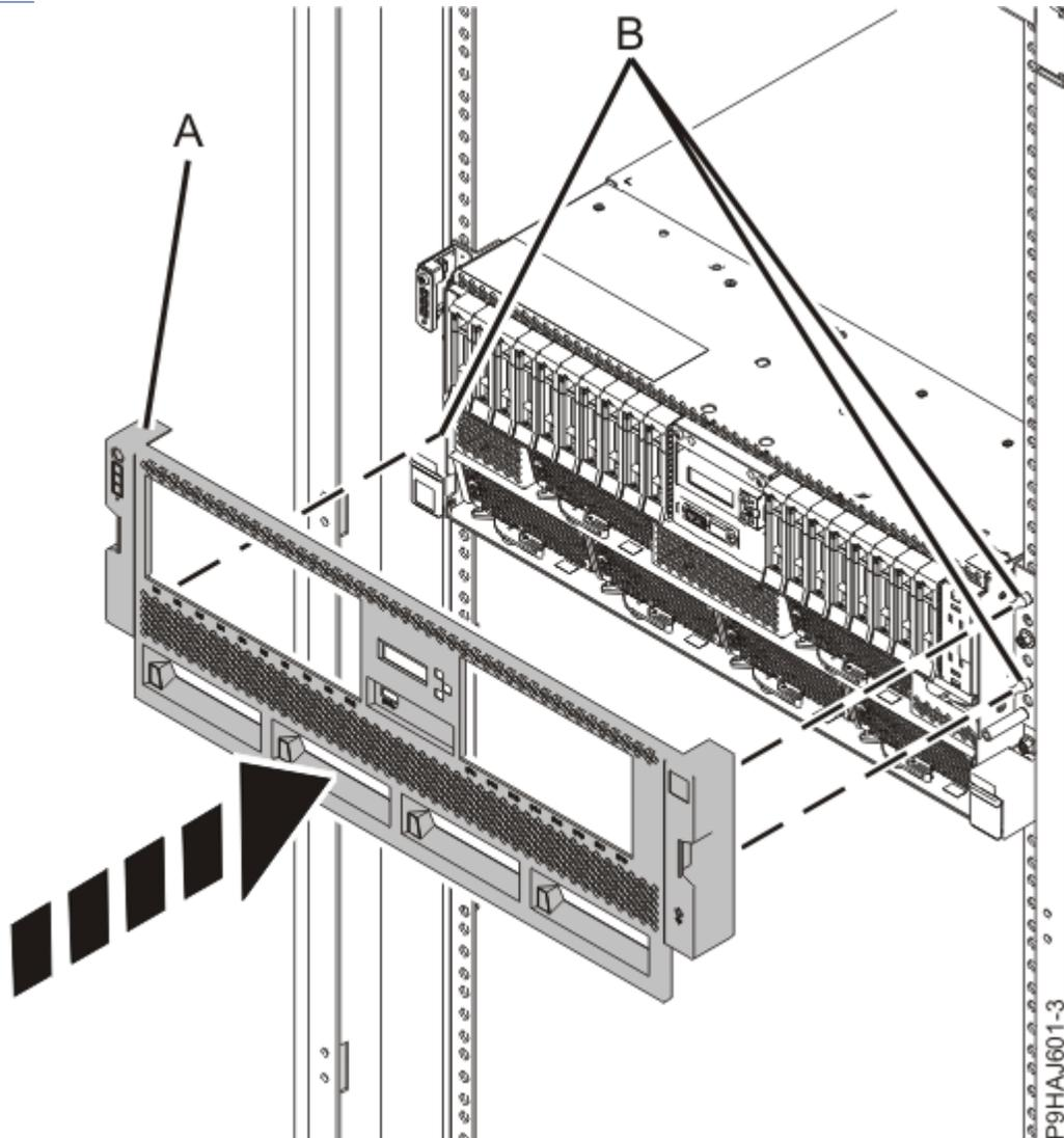
Abbildung 12. Vordere Abdeckung installieren
