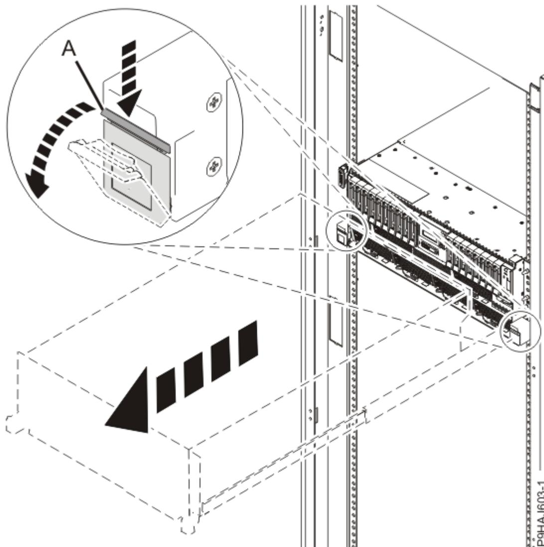
Abbildung 18. Seitliche Verriegelungen entriegeln
