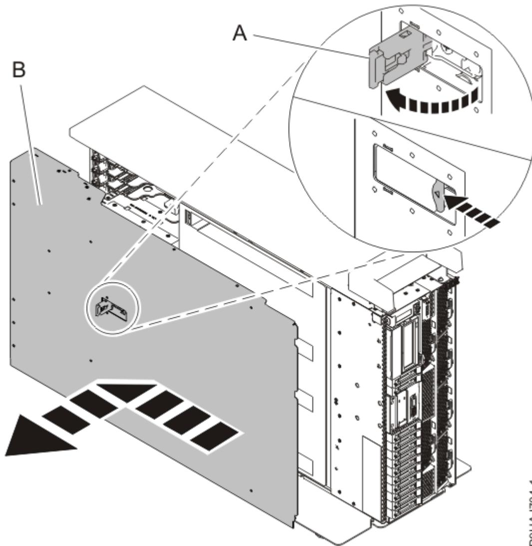
Abbildung 21. Serviceabdeckung ausbauen
