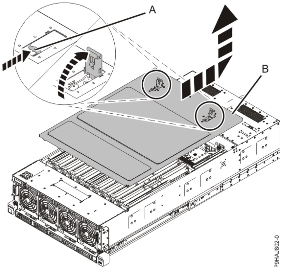
Abbildung 12. Serviceabdeckung ausbauen
