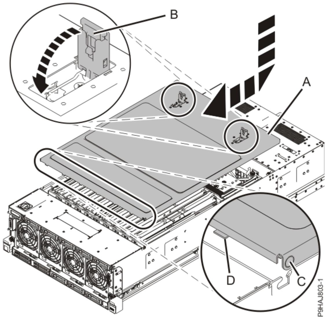
Abbildung 20. Serviceabdeckung installieren
