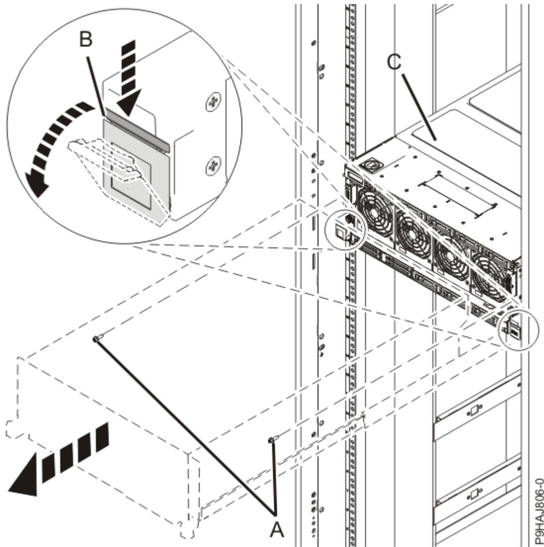
Abbildung 51. System in Serviceposition bringen
