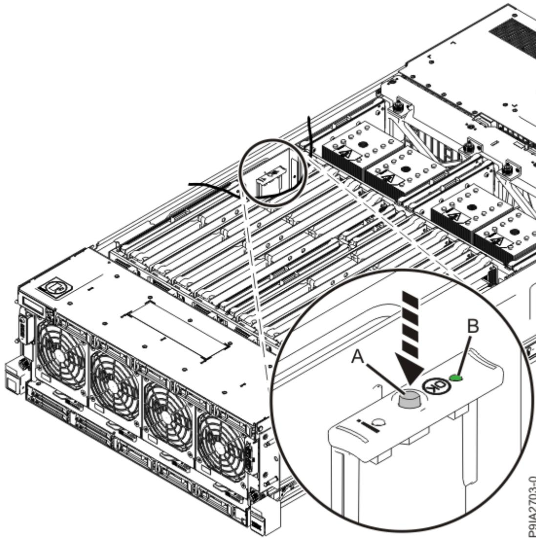
Abbildung 43. Kennzeichnungs-LED aktivieren
