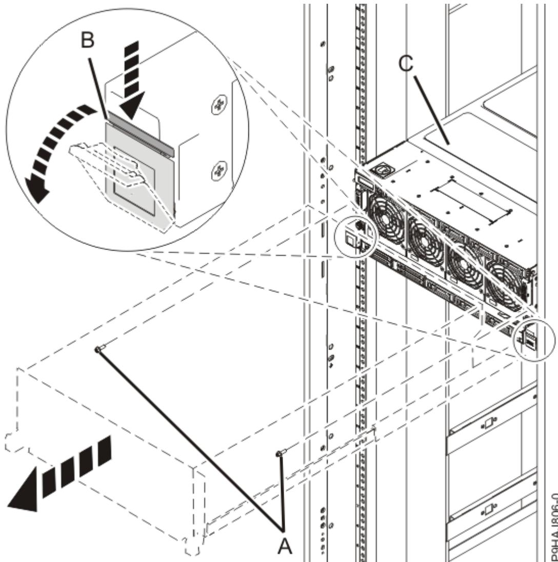
Abbildung 33. System in Serviceposition bringen
