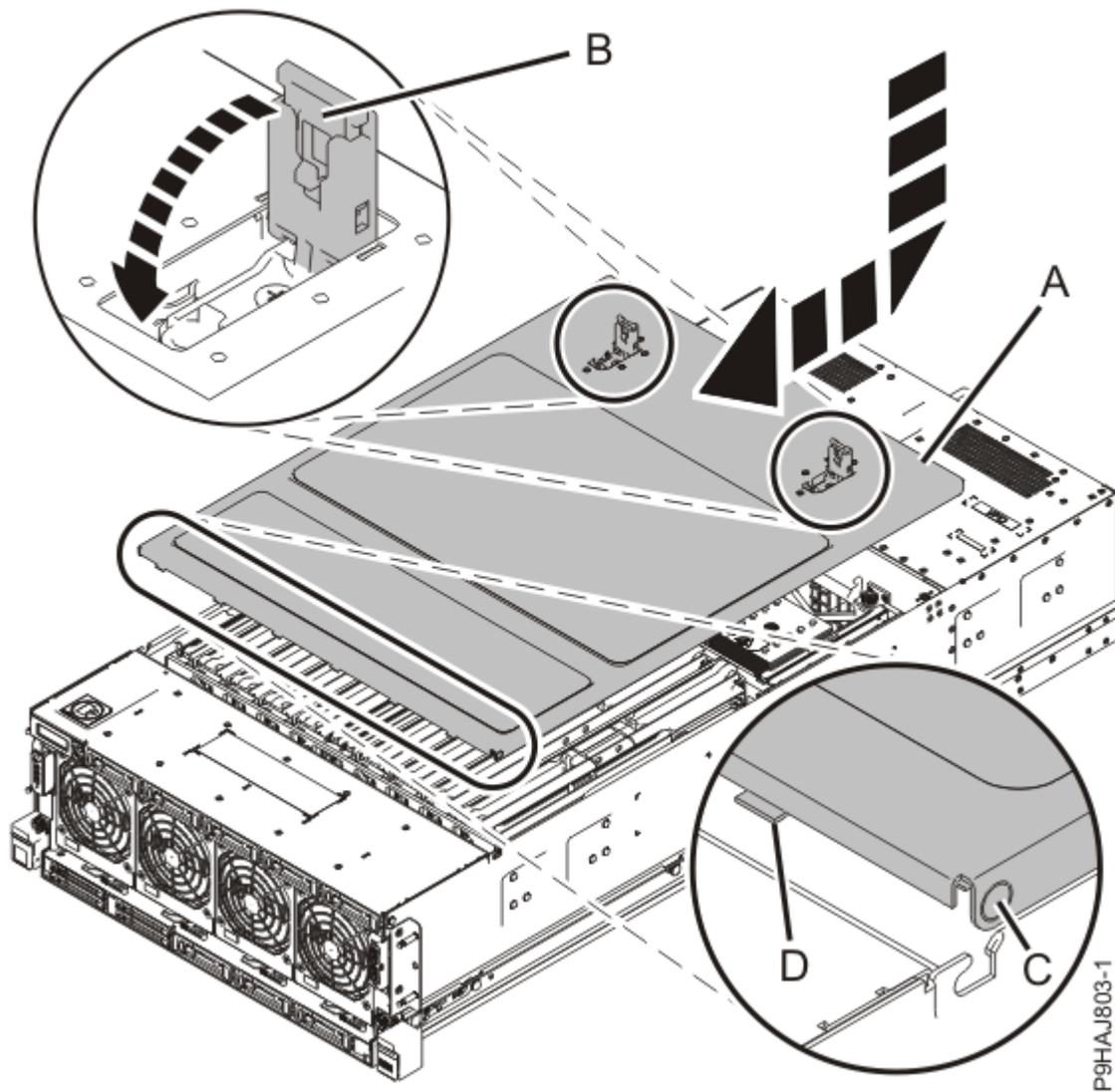
Abbildung 47. Serviceabdeckung installieren
