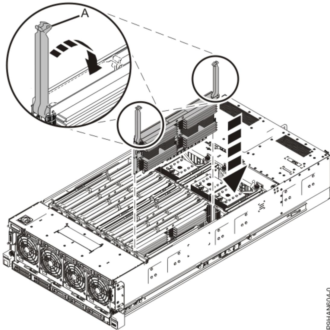
Abbildung 36. Speicherriserkarte einsetzen
