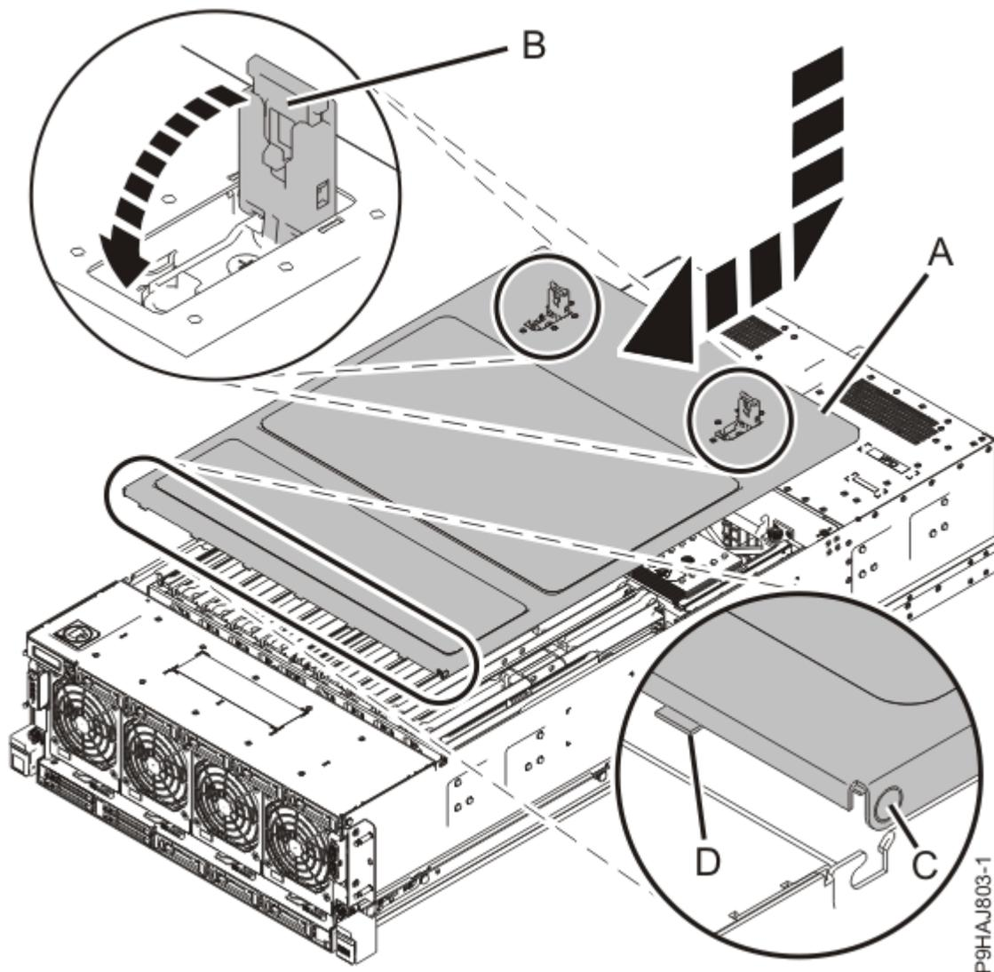
Abbildung 55. Serviceabdeckung installieren
