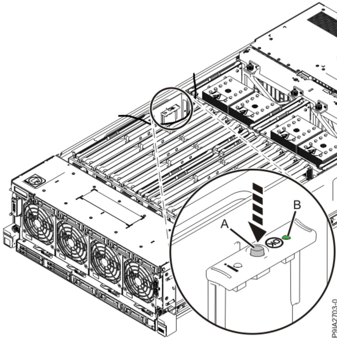
Abbildung 13. Kennzeichnungs-LED aktivieren
