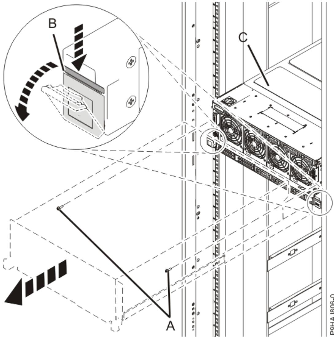
Abbildung 2. System in Serviceposition bringen
