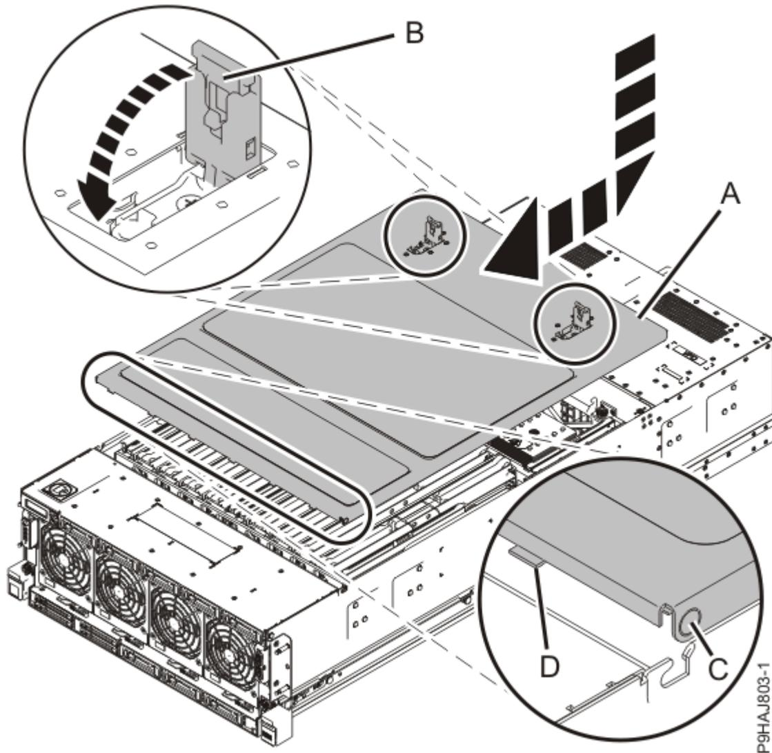
Abbildung 7. Serviceabdeckung installieren
