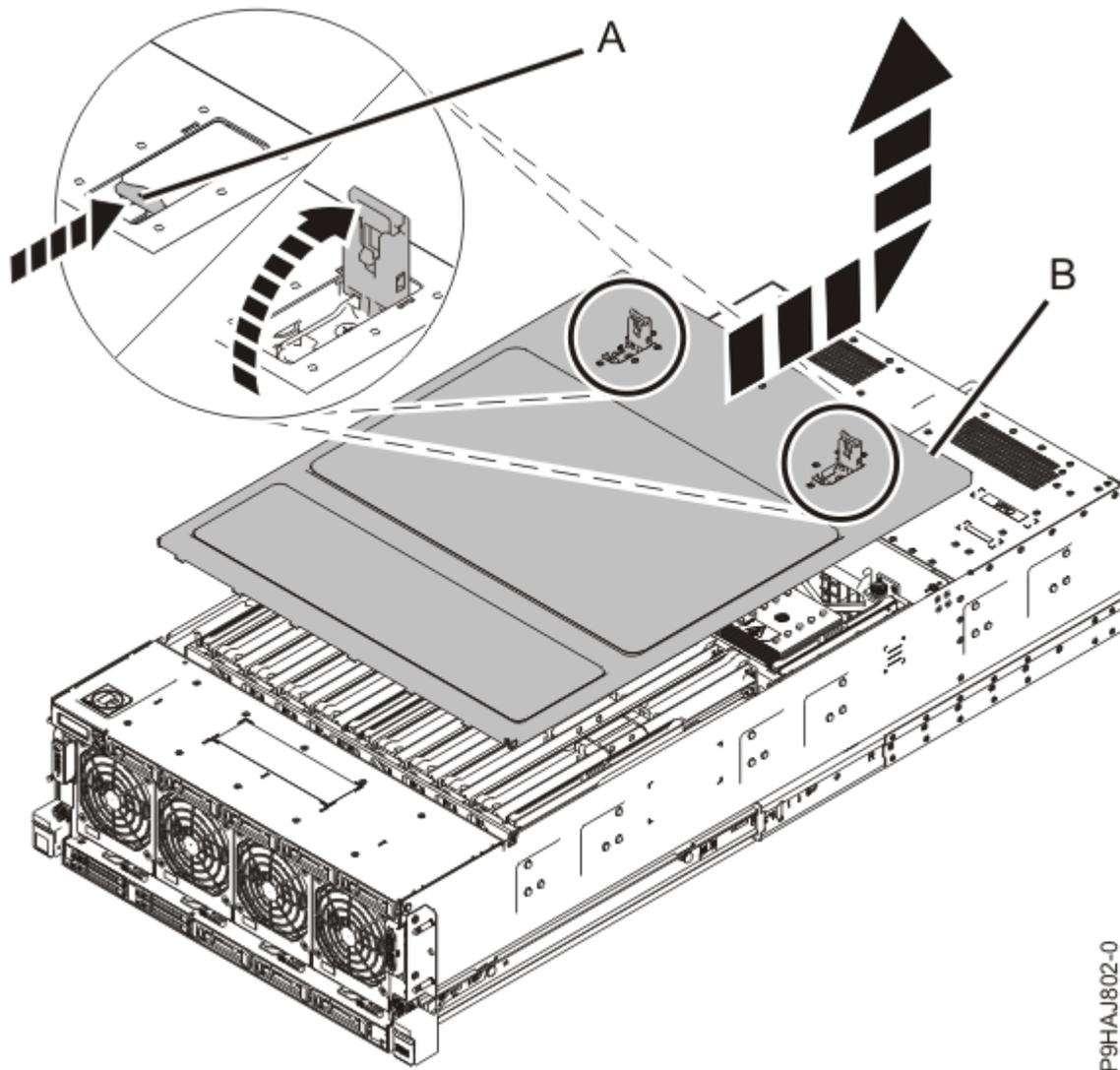
Abbildung 34. Serviceabdeckung ausbauen
