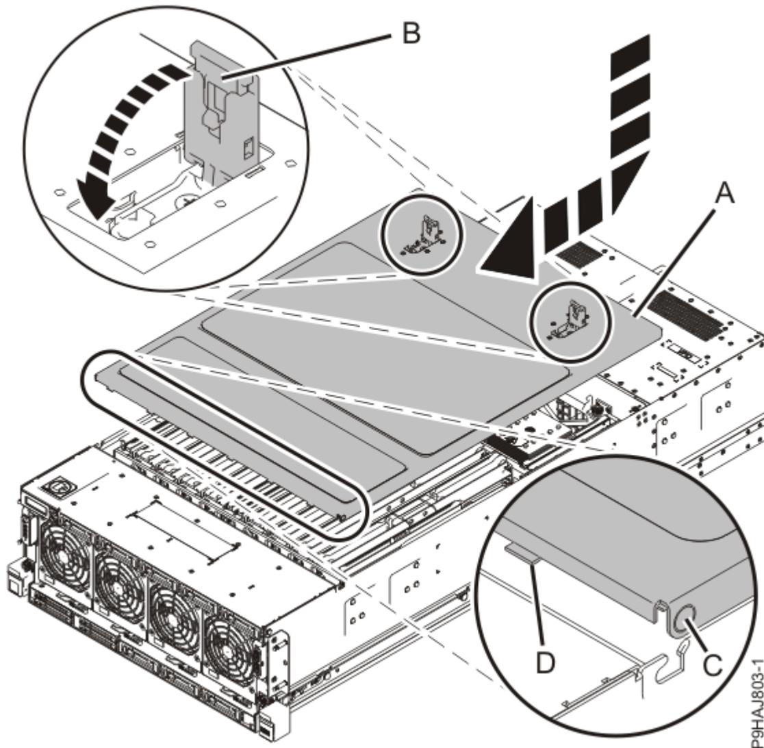
Abbildung 29. Serviceabdeckung installieren
