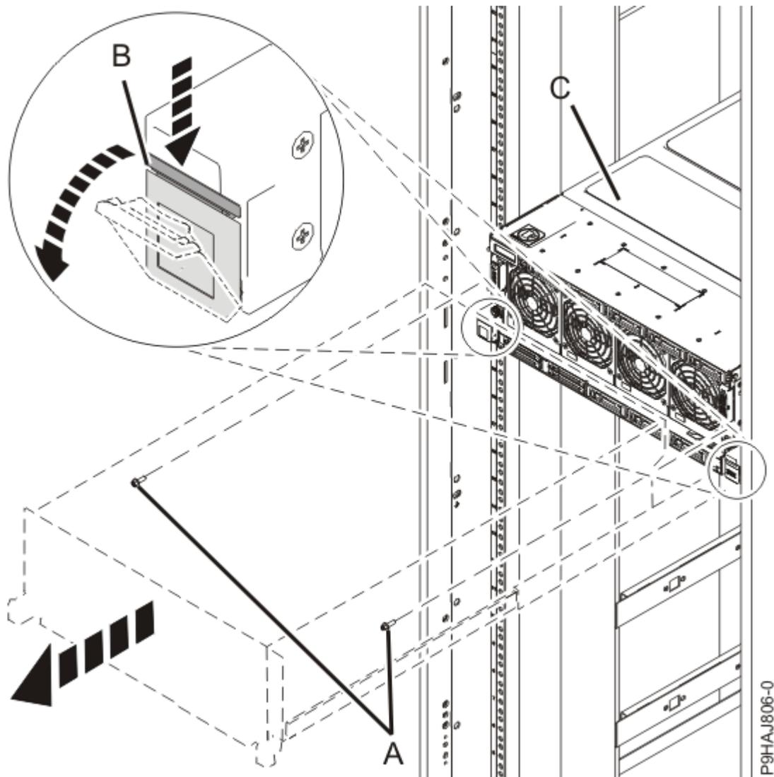
Abbildung 11. System in Serviceposition bringen
