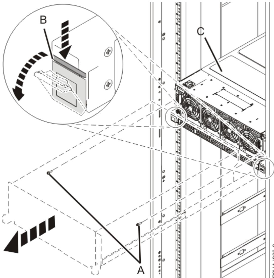
Abbildung 41. System in Serviceposition bringen
