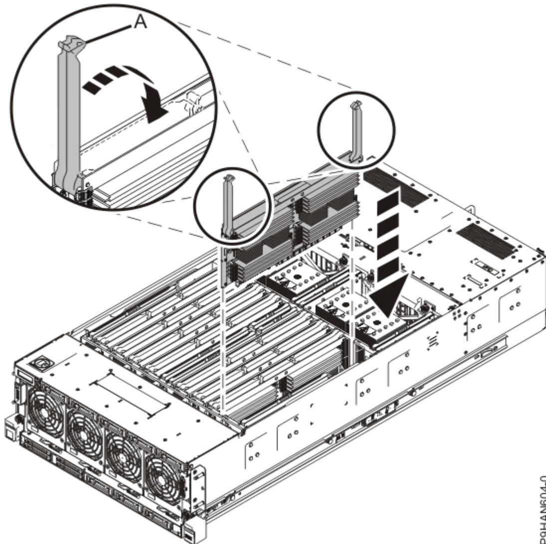
Abbildung 28. Speicherriserkarte einsetzen
