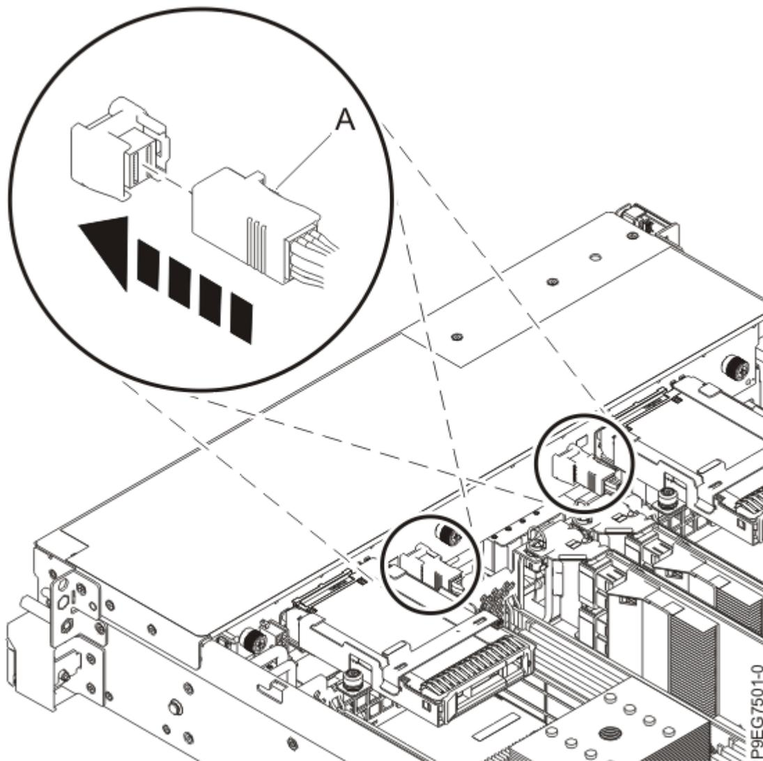
Abbildung 28. Vordere SAS-Kabel wieder anschließen
