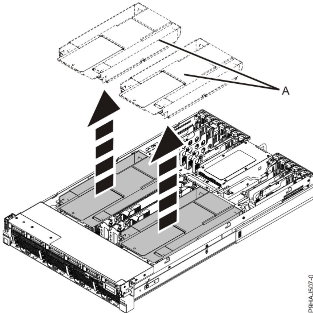
Abbildung 4. Luftführung ausbauen
