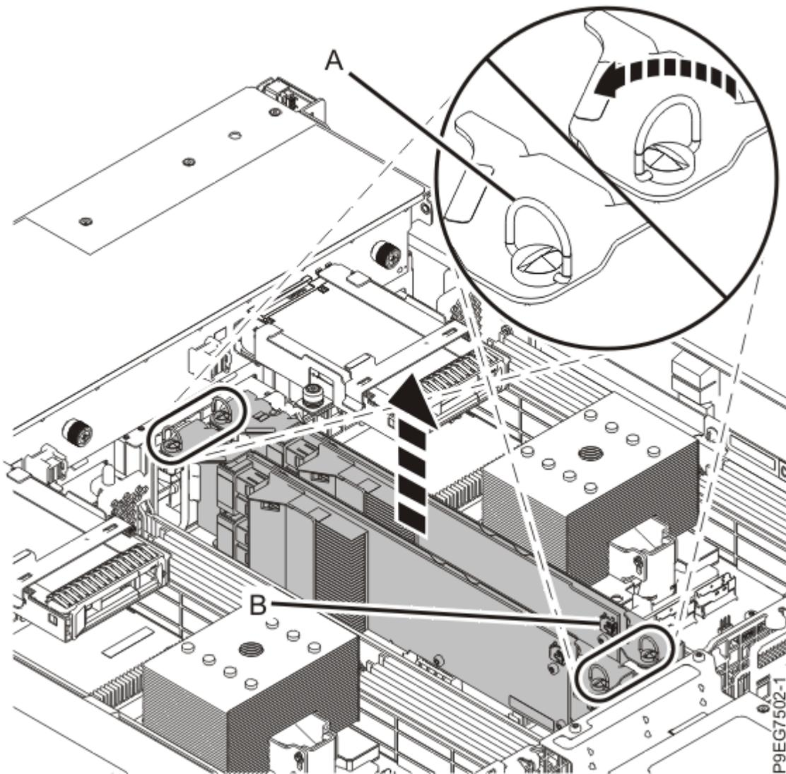
Abbildung 22. SAS-RAID-Adapter entfernen
