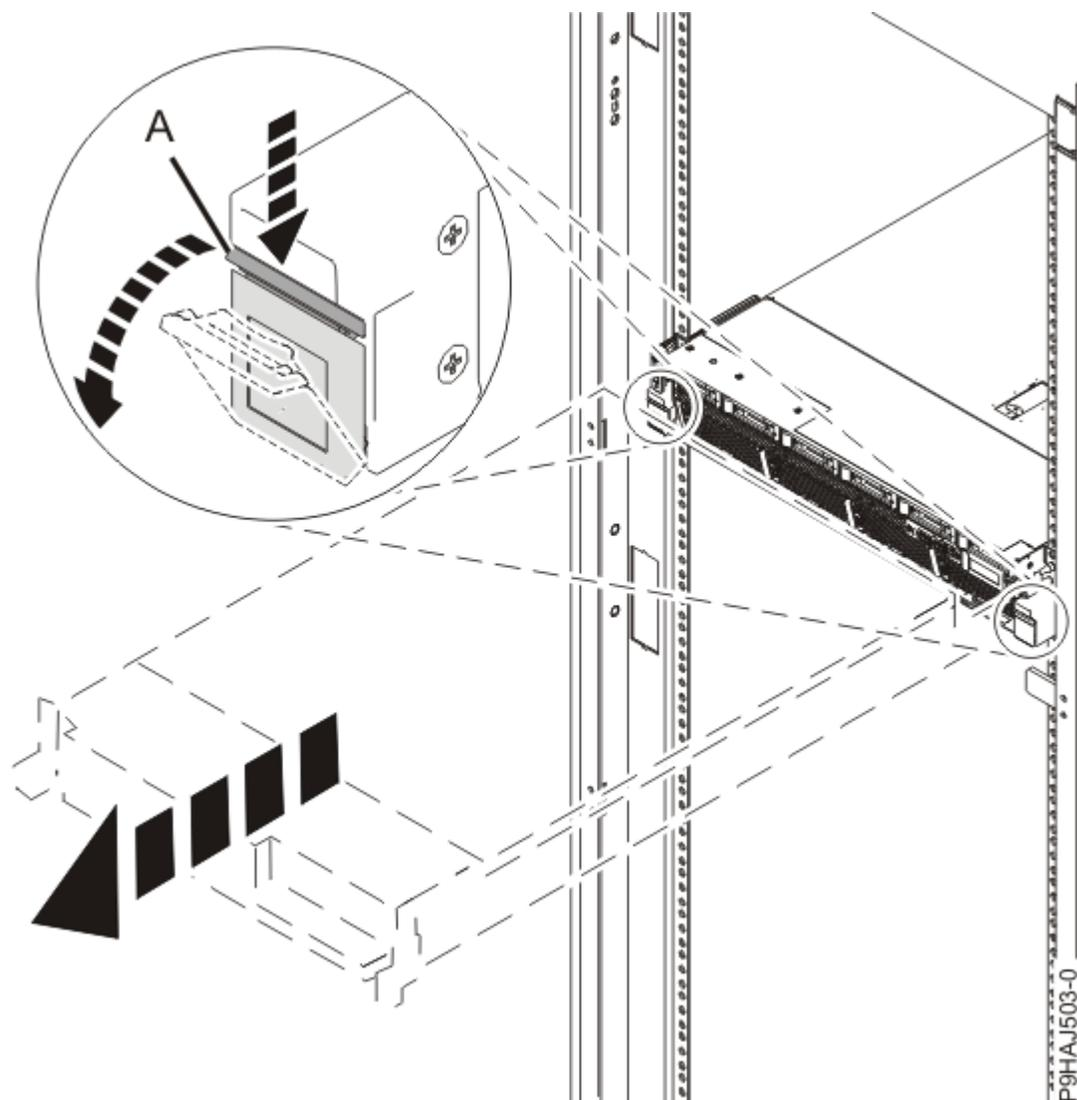
Abbildung 17. Seitliche Verriegelungen entriegeln
