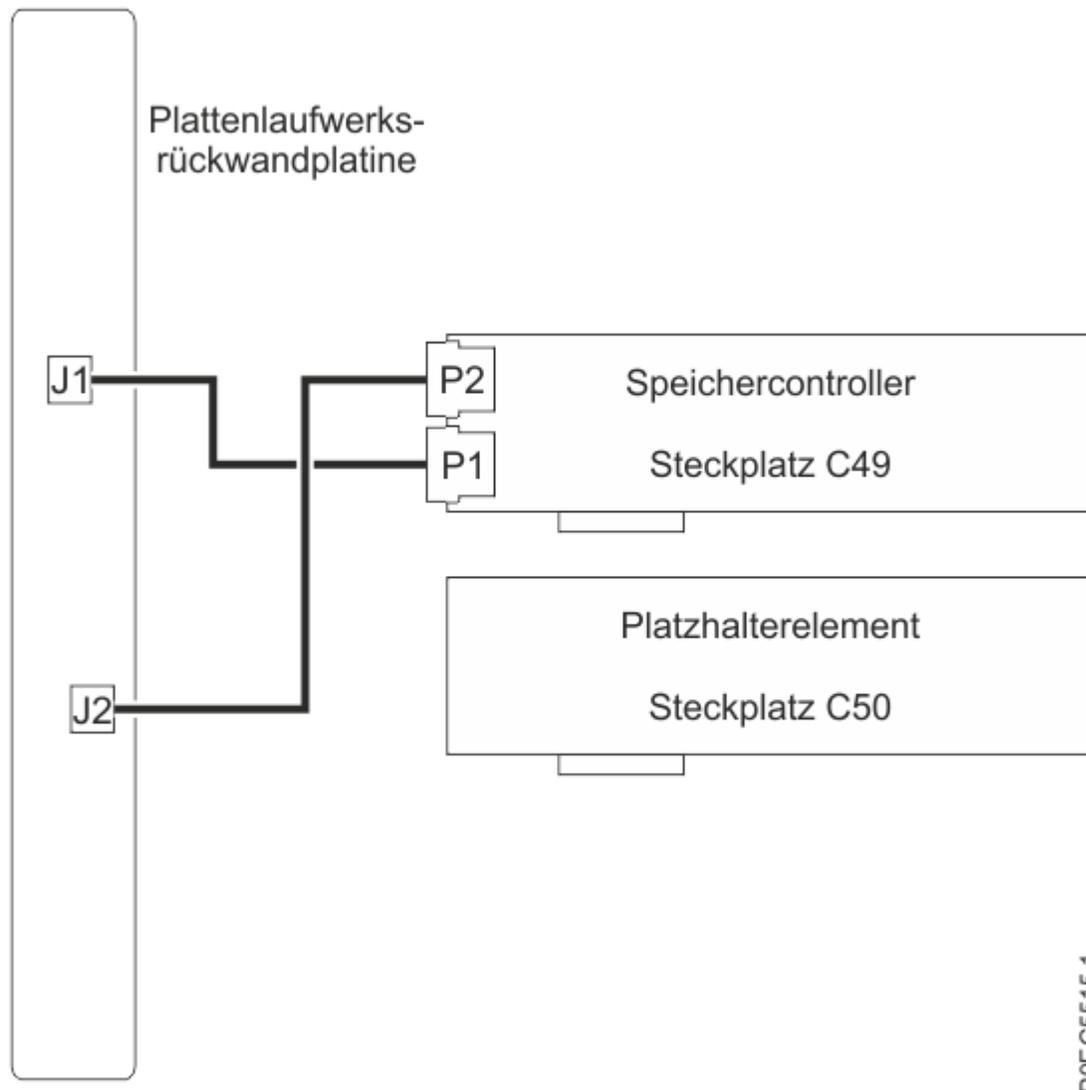
Abbildung 24. SAS-Kabel in einer Basisspeicherkonfiguration wieder anschließen
