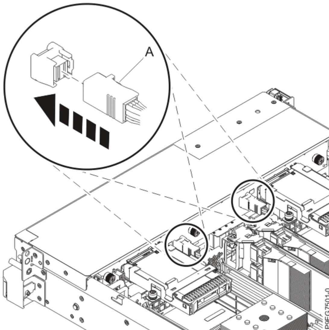
Abbildung 10. Vordere SAS-Kabel wieder anschließen
