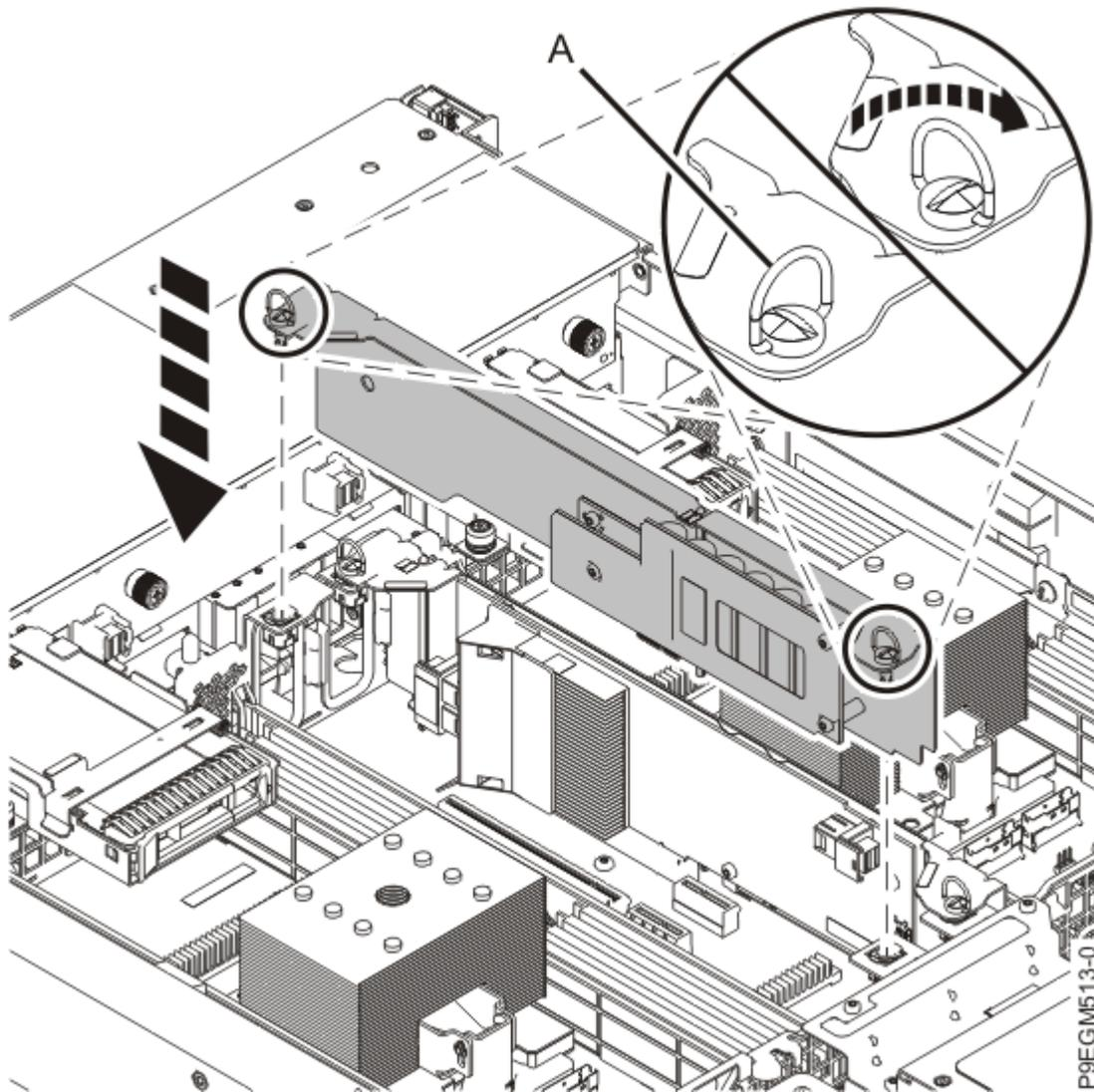
Abbildung 11. Sicherungsstromversorgungsmodul installieren
