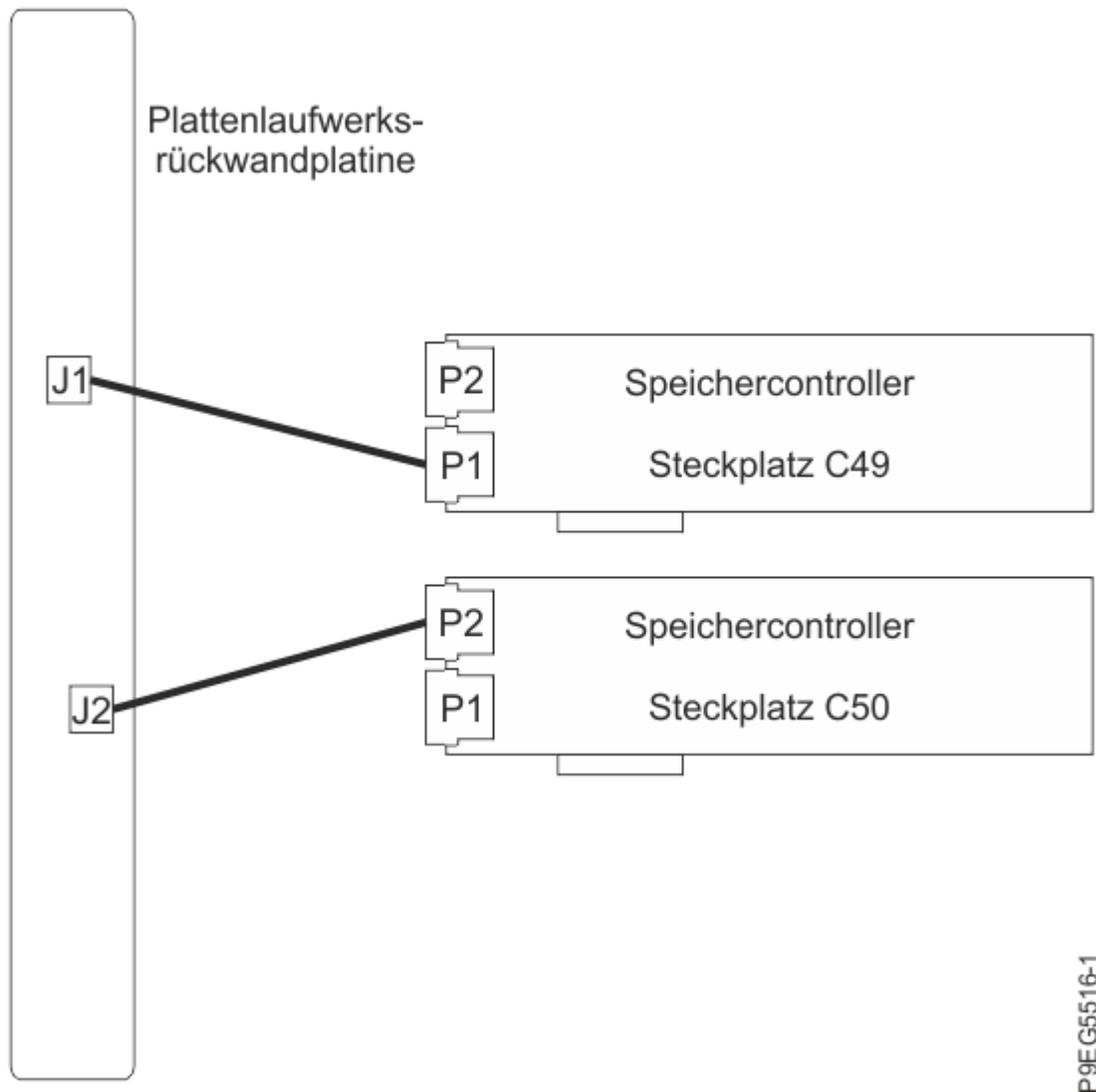
Abbildung 25. SAS-Kabel in einer Konfiguration mit unterteilter Festplatte wieder anschließen
