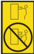
Ziehen Sie die Systemeinheit **(A)** höchstens 79 cm aus dem Rack (siehe folgende Abbildung). Stellen Sie sicher, dass sich die Kabel nicht verfangen, wenn Sie das System herausziehen.
