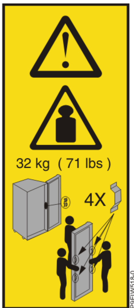
Figura 99. Pes de l'intercanviador de calor i nanes d'elevació
