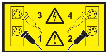
危险：多根电源线。本产品可能配有多根电源线。要消除所有危险电压，请断开所有电源线。 (L003)
