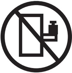
อันตราย: ไม่ควรใช้อุปกรณ์ที่ประกอบเข้ากับชั้นวางเป็นชั้นวางหรือเป็นพื้นที่ใช้งาน (L002)
