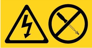
อันตราย: แรงดันไฟ กระแสไฟ หรือระดับพลังงานที่เป็นอันตรายจะแสดงอยู่ภายในส่วนประกอบต่างๆ ที่มีป้ายนี้ติดอยู่ ห้ามเปิดฝาครอบ หรือแผงกันที่ติดป้ายนี้อยู่ (L001)
