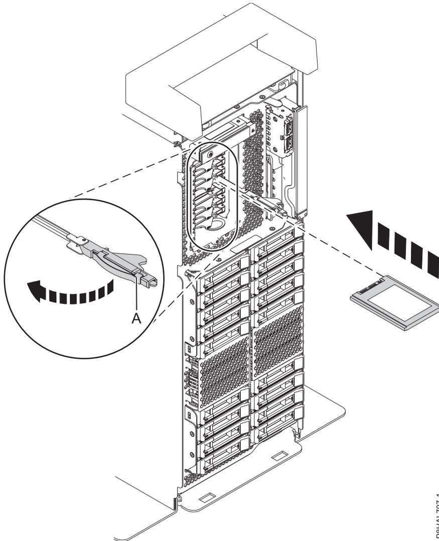
รูปที่ 112. การเปลี่ยน SSD ในระบบ expanded function แบบสแตนด์อะโลน
