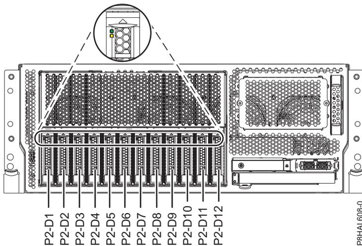
รูปที่ 40. ตำแหน่งของดิสก์ไดรฟ์ หรือโซลิดสเตทไดรฟ์ และไฟแสดงสถานะเซอรัวิสในระบบ base function 8247-42L, 8286-41A หรือ 8286-42A แบบติดตั้งในชั้นวาง
