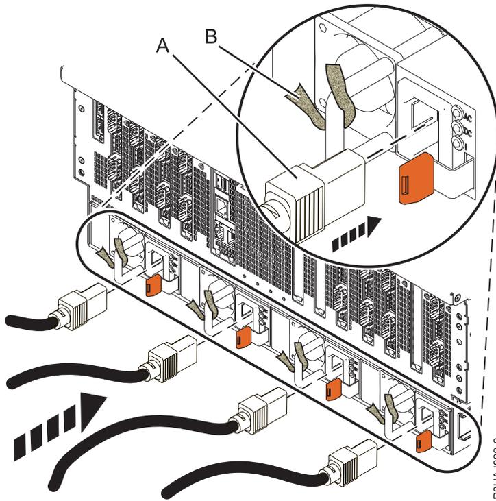
รูปที่ 167. การเชื่อมต่อสายไฟเข้ากับ ระบบ 8408-44E หรือ 8408-E8E
