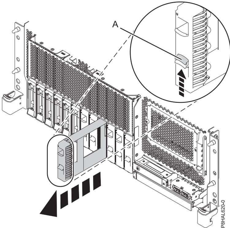
รูปที่ 33. การถอดดิสก์ไดรฟ์ฟิลเลอร์ออกจากระบบ base function ที่ติดตั้งในชั้นวาง
