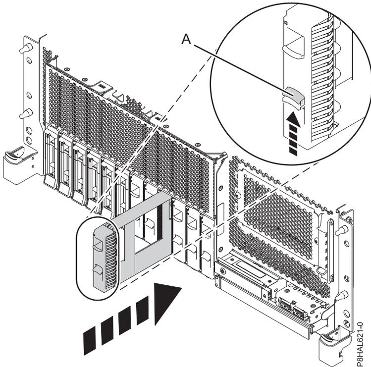
รูปที่ 137. การติดตั้งไดรฟ์ฟิลเลอร์ในระบบ base function ที่ติดตั้งในชั้นวาง
