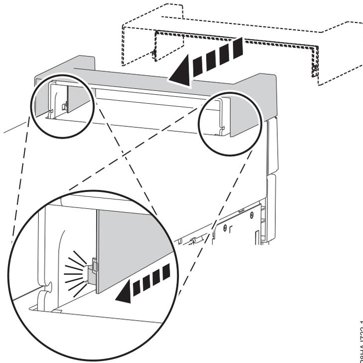
รูปที่ 179. การติดฝาครอบที่จับในระบบสแตนด์อะโลน 8286-41A
