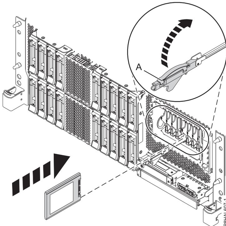
รูปที่ 50. การติดตั้ง SSD ในระบบ expanded function 8286-41A หรือ 8286-42A ที่ติดตั้งในชั้นวาง
