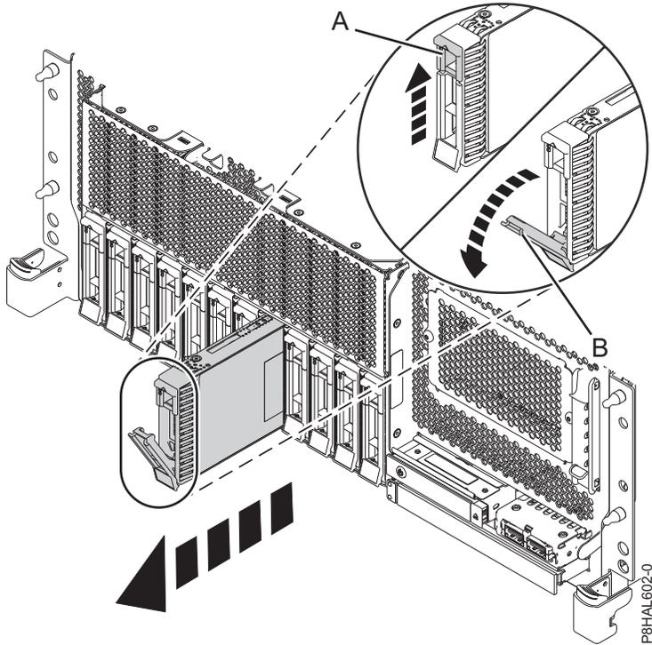
รูปที่ 101. การถอดดิสก์ไดร์ฟออกจากระบบ base function ที่ติดตั้งในชั้นวาง
