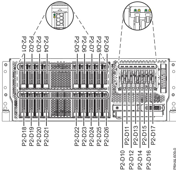
รูปที่ 11. ตำแหน่งของดิสก์ไดรฟ์ โซลิตสเททไดรฟ์ และไฟแสดงสถานะเซอร์วิสในระบบ expanded function 8286-41A หรือ 8286-42A แบบติดตั้งในชั้นวาง
