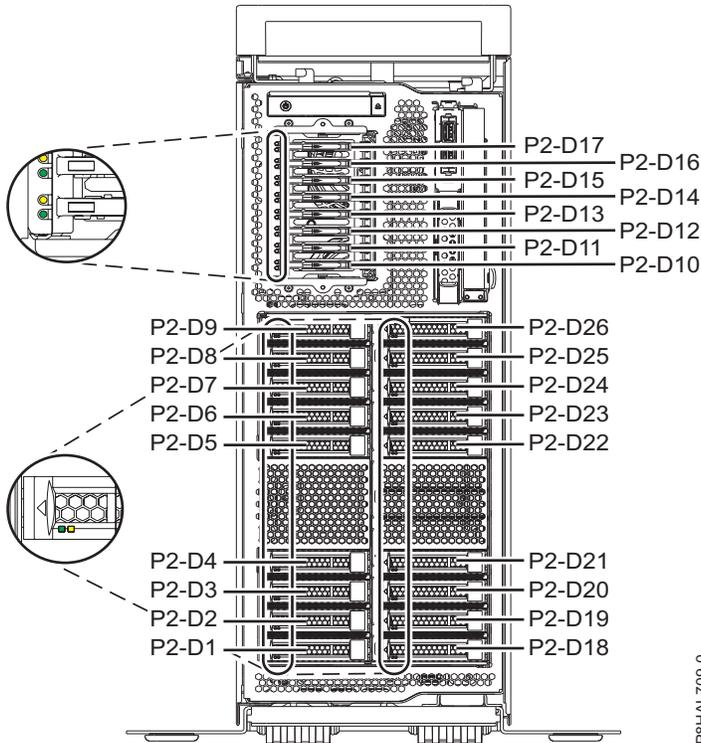
รูปที่ 72. ตำแหน่งของดิสก์ไดรฟ์ โซลิดสเตตไดรฟ์ และไฟแสดงสถานะเซอร์วิสในระบบ expanded function 8286-41A แบบสแตนด์อะโลน
