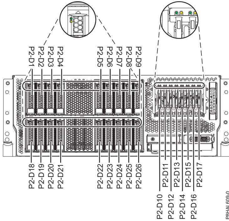
รูปที่ 2. ตำแหน่งของดิสก์ไดรฟ์ โซลิตสเตทไดรฟ์ และไฟแสดงสถานะเซอร์วิสในระบบ expanded function 8286-41A หรือ 8286-42A แบบติดตั้งในชั้นวาง
