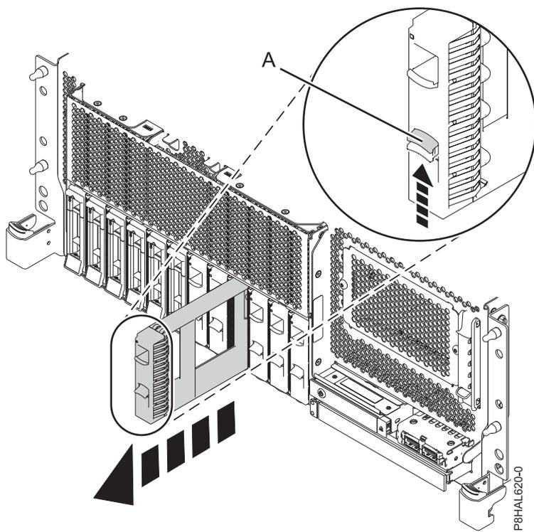
รูปที่ 45. การถอดดิสก์ไดรฟ์ฟิลเลอร์ออกจากระบบ base function ที่ติดตั้งในชั้นวาง
