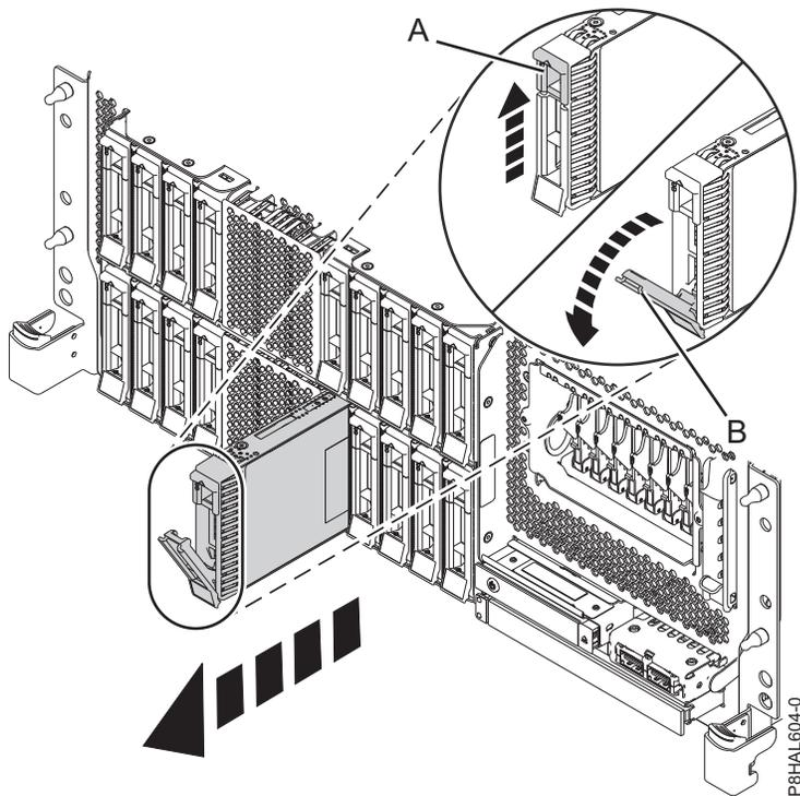
รูปที่ 58. การถอดดิสก์ไดร์ฟออกจากระบบ expanded function ที่ติดตั้งในชั้นวาง
