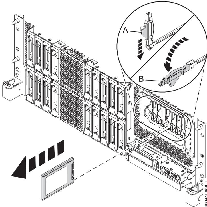
รูปที่ 122. การถอด SSD ออกจากระบบ expanded function ที่ติดตั้งในช่องว่าง
