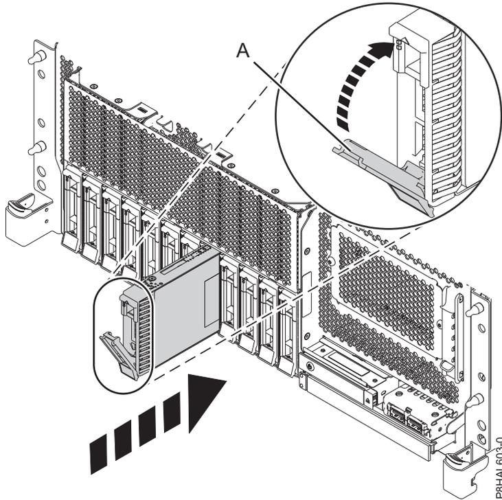
รูปที่ 6. การติดตั้งดิสก์ไดรฟ์ใน ระบบ base function ที่ติดตั้งในชั้นวาง
