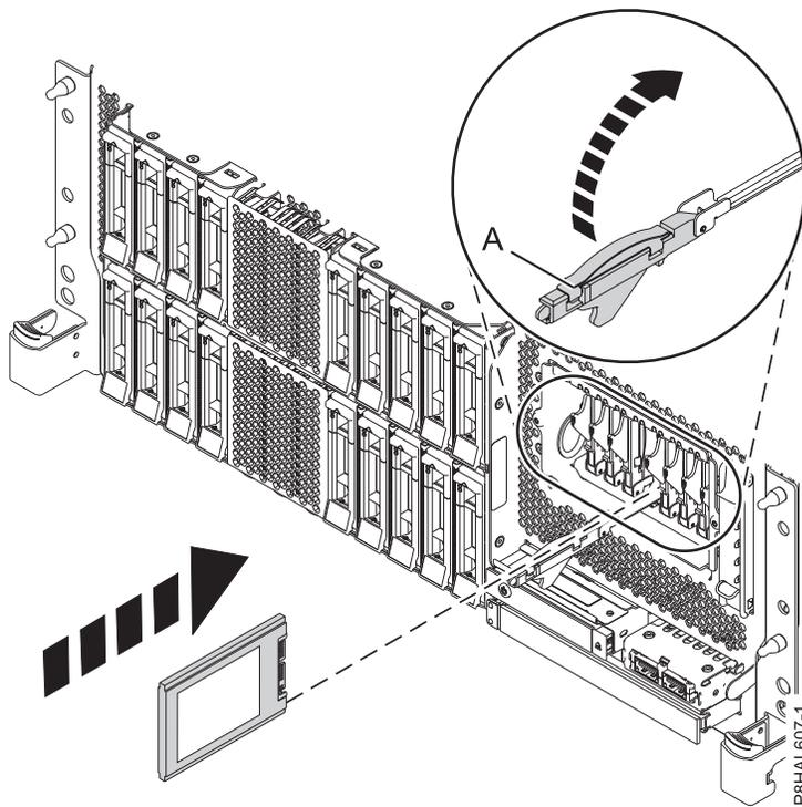
รูปที่ 25. การติดตั้ง SSD ในระบบ expanded function ที่ติดตั้งในชั้นวาง
