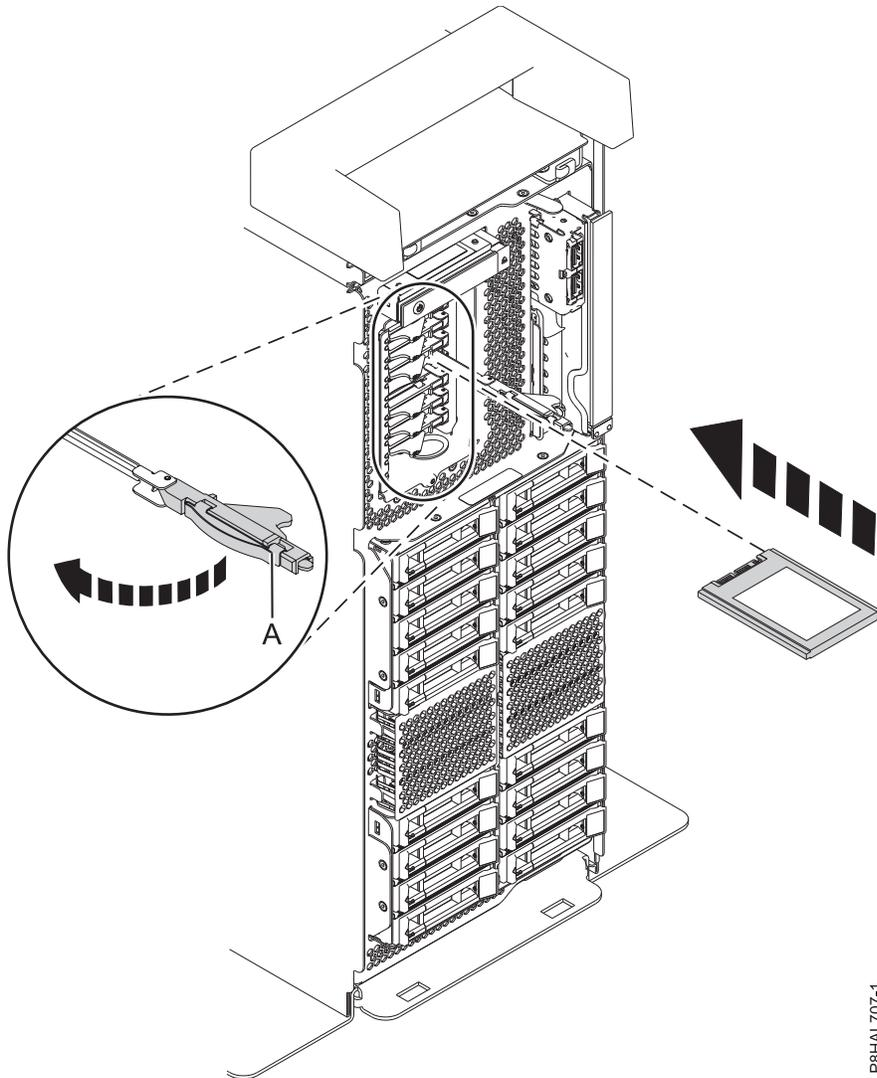
รูปที่ 131. การเปลี่ยน SSD ในระบบ expanded function แบบสแตนด์อะโลน
