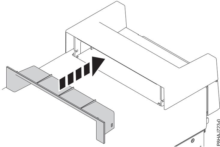
รูปที่ 180. การเสียบชิ้นส่วนภายในฝาครอบที่จับบนระบบสแตนด์อะโลน 8286-41A
