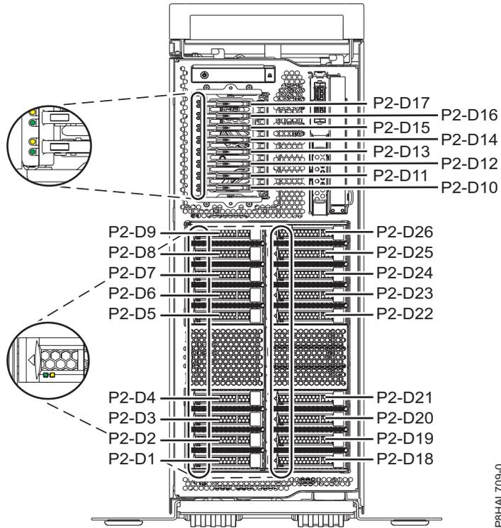
รูปที่ 144. ตำแหน่งของดิสก์ไดรฟ์ โซลิตสเตทไดรฟ์ และตัวบ่งชี้เซอร์วิสในระบบ expanded function 8286-41A แบบสแตนด์อะโลน
