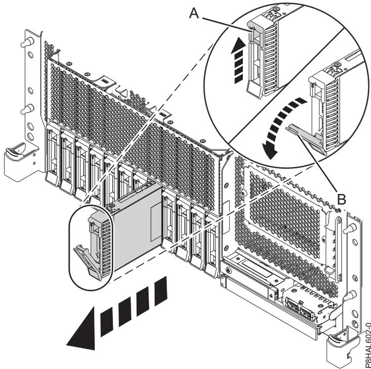
รูปที่ 57. การถอดดิสก์ไดร์ฟออกจากระบบ base function ที่ติดตั้งในชั้นวาง
