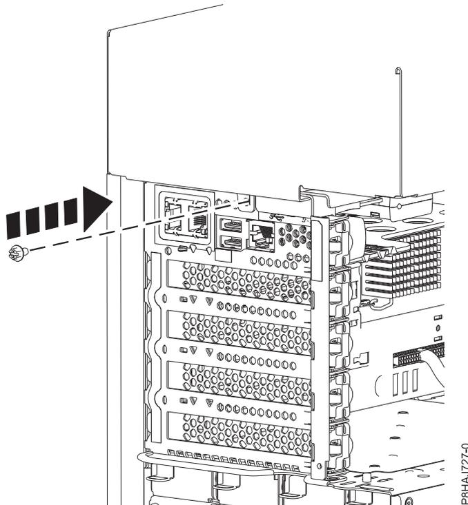
รูปที่ 182. การติดตั้งสกรูของฝาครอบด้านข้างสำหรับ 8286-41A
