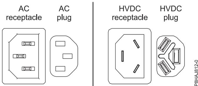
รูปที่ 162. ตัวเชื่อมต่อ AC และ HVDC
