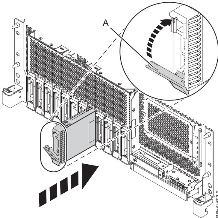
รูปที่ 63. การเปลี่ยน ดิสก์ไดรฟ์ในระบบ base function ที่ติดตั้งในชั้นวาง
