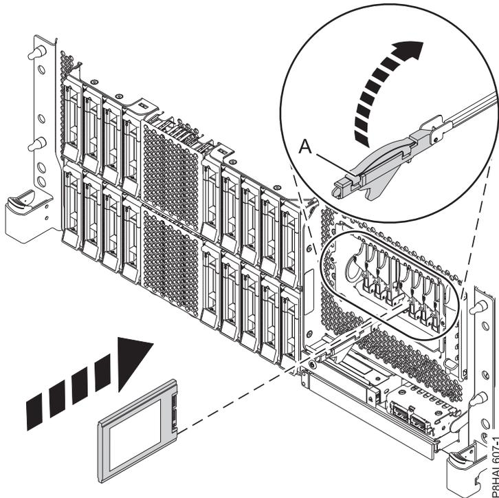
รูปที่ 97. การเปลี่ยน SSD ในระบบ *expanded function* ที่ติดตั้งในชั้นวาง
