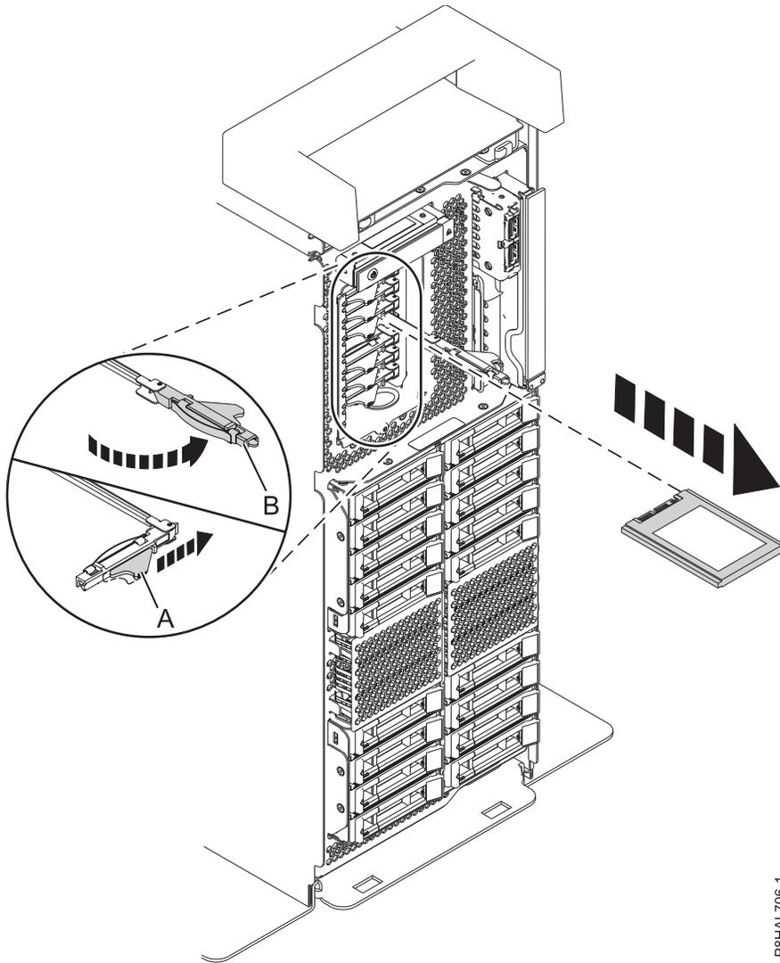
รูปที่ 92. การถอด SSD ออกจากระบบ expanded function แบบสแตนด์อะโลน
