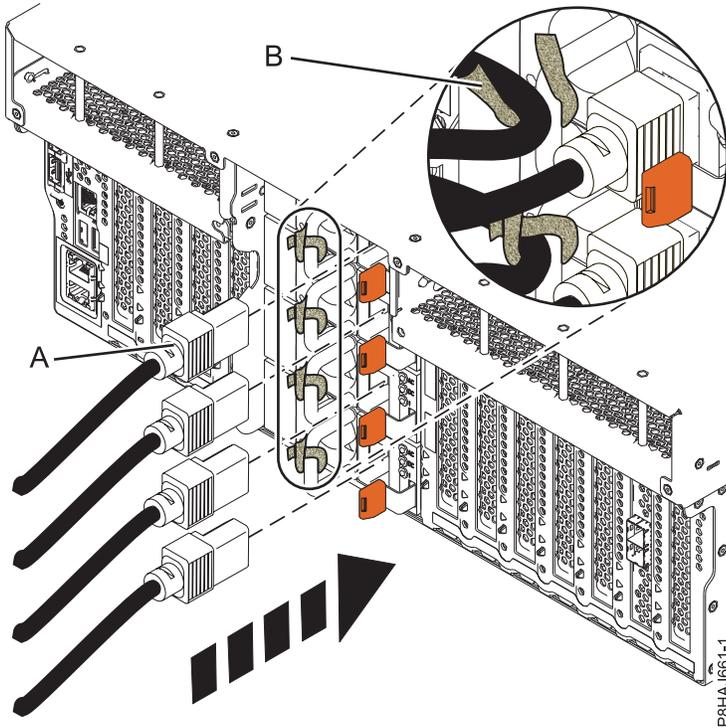
รูปที่ 165. การเชื่อมต่อสายไฟเข้ากับ ระบบ 8247-42L, 8286-41A หรือ 8286-42A
