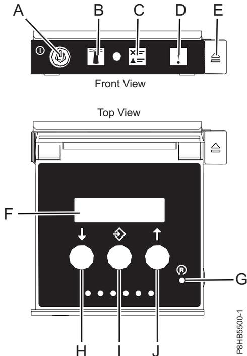
รูปที่ 154. คอนโทรลพาดเนล LEDs
