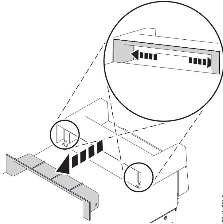
รูปที่ 171. การถอดชิ้นส่วนภายในฝาครอบตัวจับระบบ 8286-41A สแตนด์อะโลน
