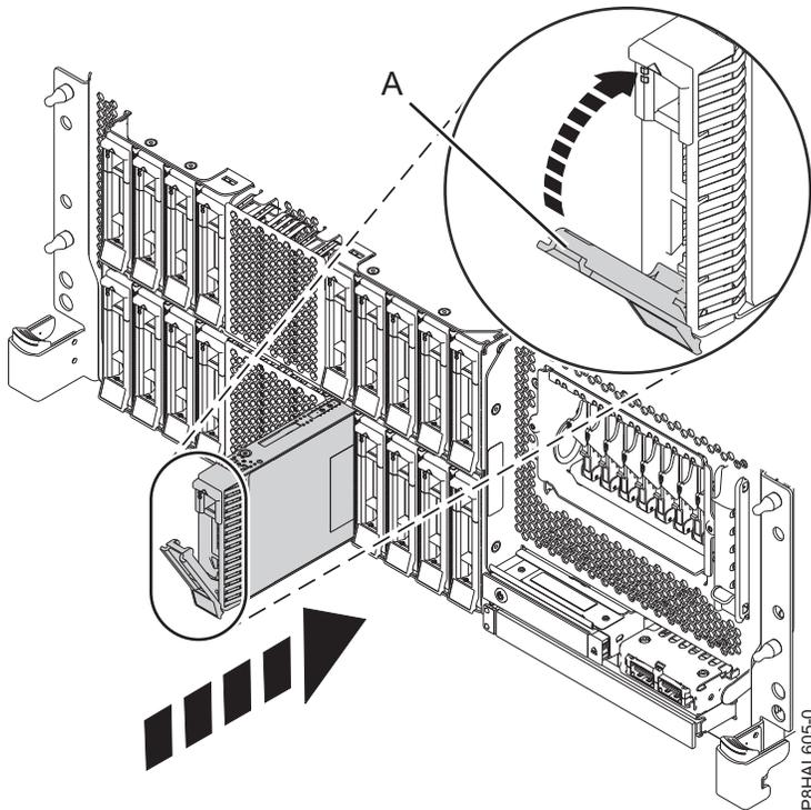
รูปที่ 108. การเปลี่ยน ดิสก์ไดรฟ์ในระบบ expanded function ที่ติดตั้งในชั้นวาง
