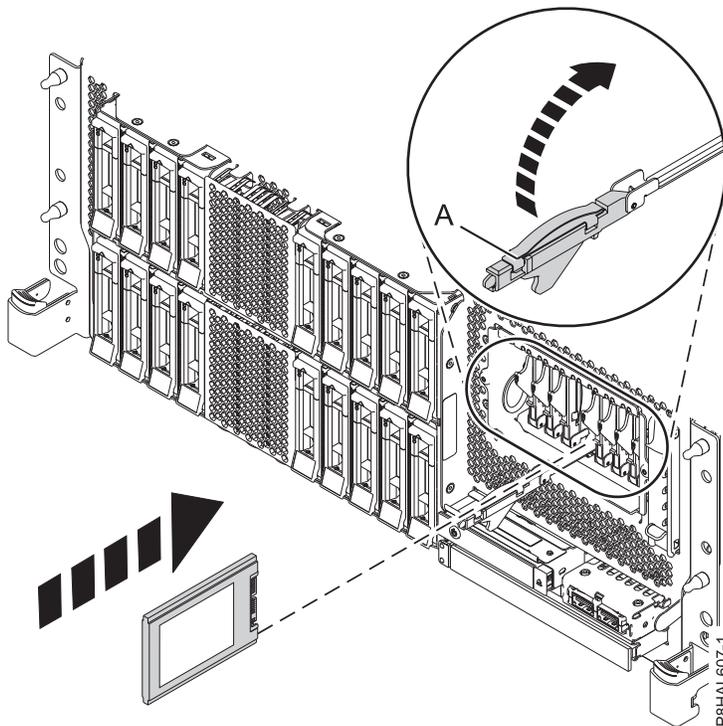
รูปที่ 38. การติดตั้ง SSD ในระบบ expanded function ที่ติดตั้งในชั้นวาง
