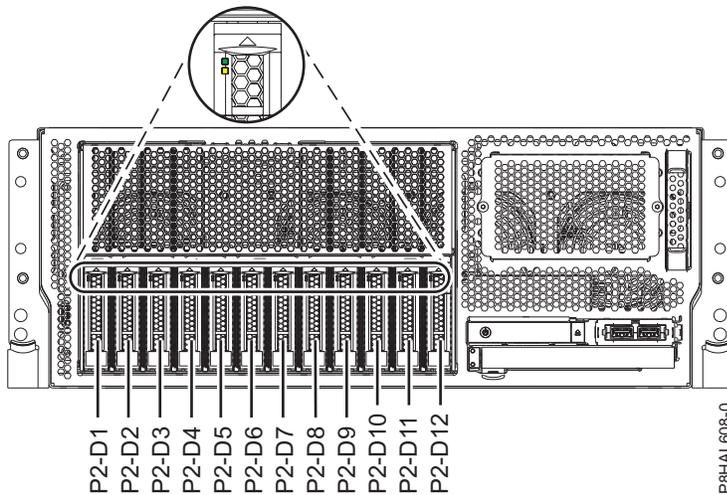
รูปที่ 53. ตำแหน่งของดิสก์ไดร์ฟ หรือโซลิดสเตตไดร์ฟ และไฟแสดงสถานะเซอร์วิสในระบบ base function 8247-42L, 8286-41A หรือ 8286-42A แบบติดตั้งในชั้นวาง
