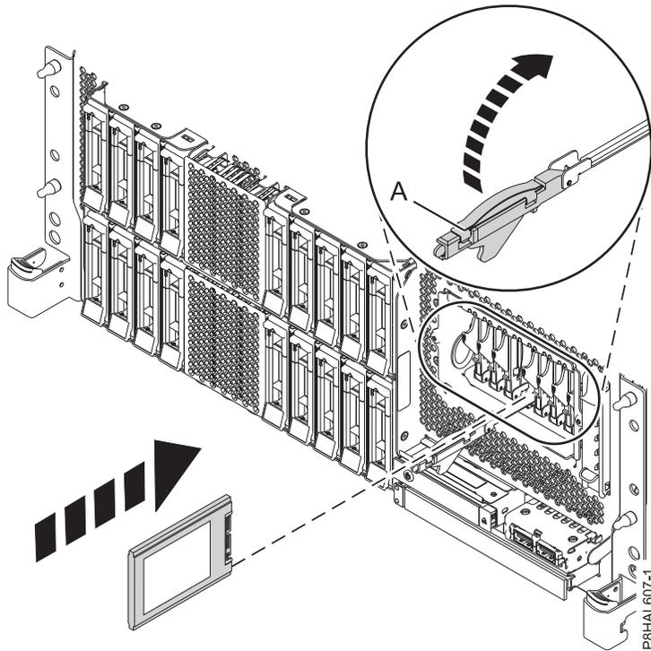
รูปที่ 83. การเปลี่ยน SSD ในระบบ expanded function ที่ติดตั้งในชั้นวาง
