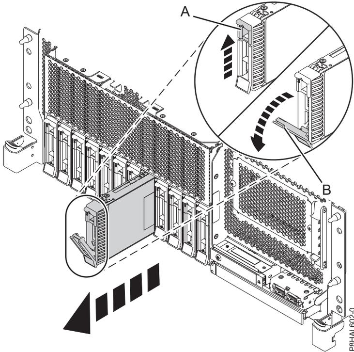
รูปที่ 73. การถอดดิสก์ไดร์ฟออกจากระบบ base function ที่ติดตั้งในชั้นวาง
