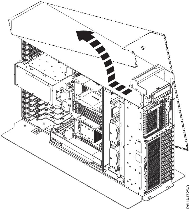
รูปที่ 174. การถอดฝาครอบด้านข้างของ 8286-41A
