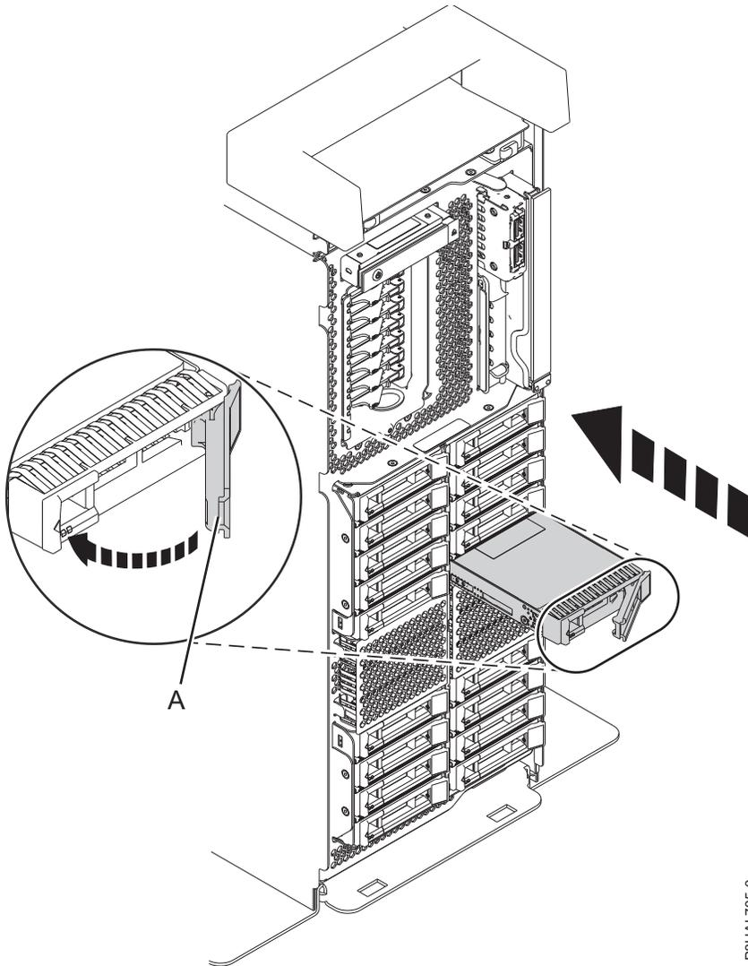
รูปที่ 66. การเปลี่ยนดิสก์ไดรฟ์ในระบบ expanded function แบบสแตนด์อะโลน
