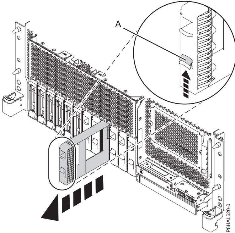
รูปที่ 20. การถอดดิสก์ไดรฟ์ฟิลเลอร์ออกจากระบบ base function ที่ติดตั้งในชั้นวาง
