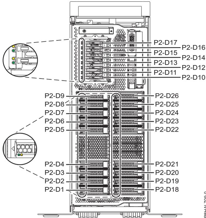
รูปที่ 30. ตำแหน่งของดิสก์ไดรฟ์ โซลิดสเตตไดรฟ์ และไฟแสดงสถานะเซอร์วิสในระบบ expanded function 8286-41A แบบสแตนด์อะโลน
