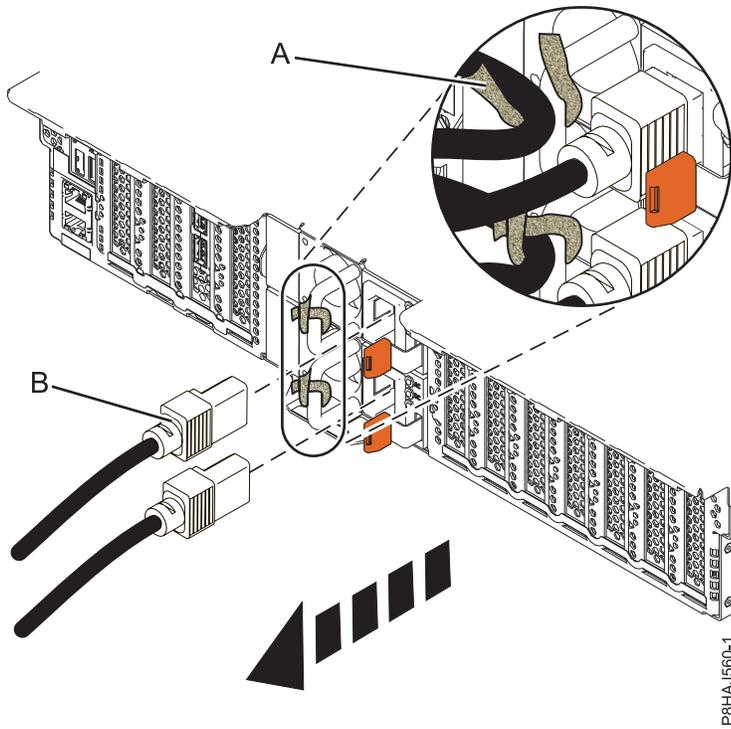
รูปที่ 160. การถอดสายไฟออกจากระบบ 5148-21L, 5148-22L, 8247-21L, 8247-22L, 8284-21A, or 8284-22A
