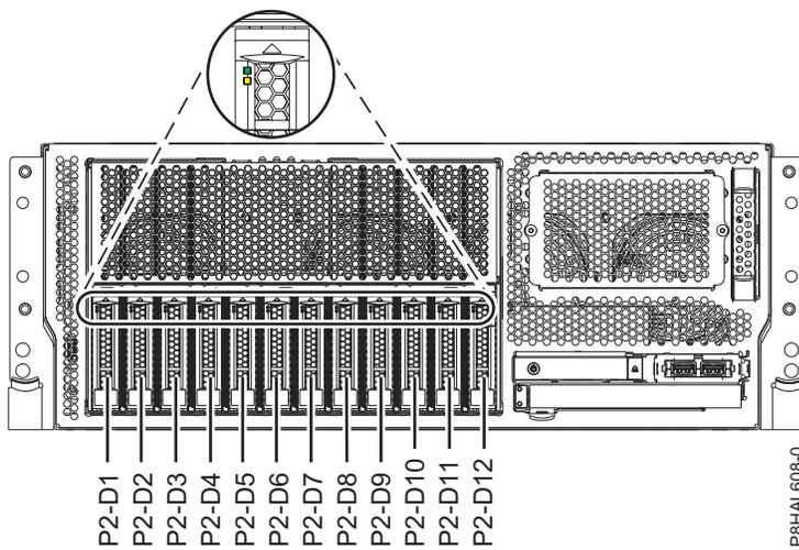
รูปที่ 10. ตำแหน่งของดิสก์ไดรฟ์ หรือโซลิดสเตตไดรฟ์ และไฟแสดงสถานะเซอร์วิสในระบบ base function 8247-42L, 8286-41A หรือ 8286-42A แบบติดตั้งในชั้นวาง
