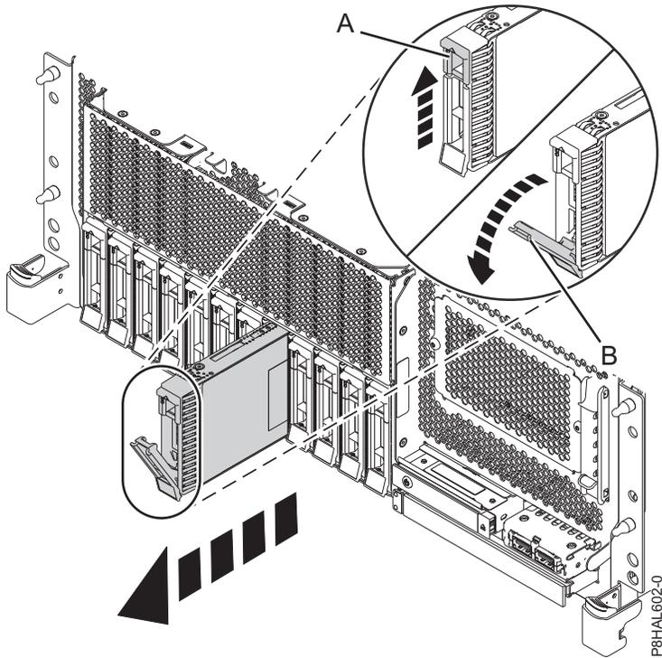
รูปที่ 118. การถอดดิสก์ไดร์ฟออกจากระบบ base function ที่ติดตั้งในชั้นวาง
