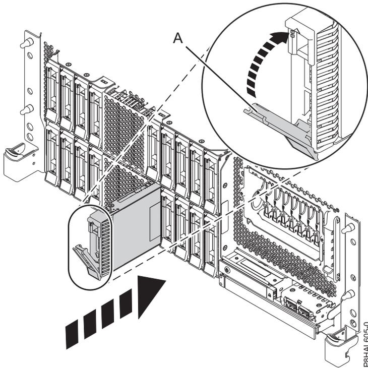
รูปที่ 80. การเปลี่ยน ดิสก์ไดร์ฟในระบบ expanded function ที่ติดตั้งในชั้นวาง
