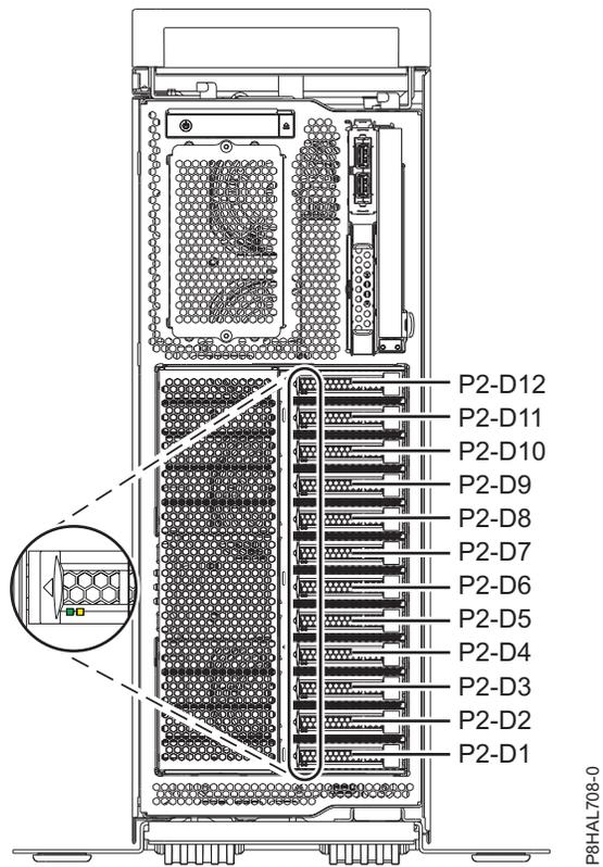
รูปที่ 12. ตำแหน่งของดิสก์ไดรฟ์ หรือโซลิดสเตตไดรฟ์ และไฟแสดงสถานะเซอร์วิสในระบบ base function 8286-41A แบบสแตนด์อะโลน
