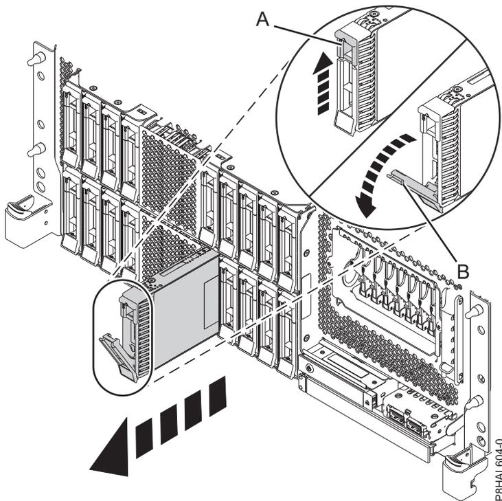
รูปที่ 74. การถอดดิสก์ไดร์ฟออกจากระบบ expanded function ที่ติดตั้งในชั้นวาง
