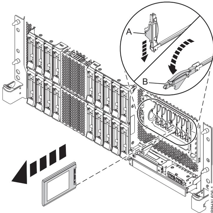
รูปที่ 77. การถอด SSD ออกจากระบบ expanded function ที่ติดตั้งในชั้นวาง
