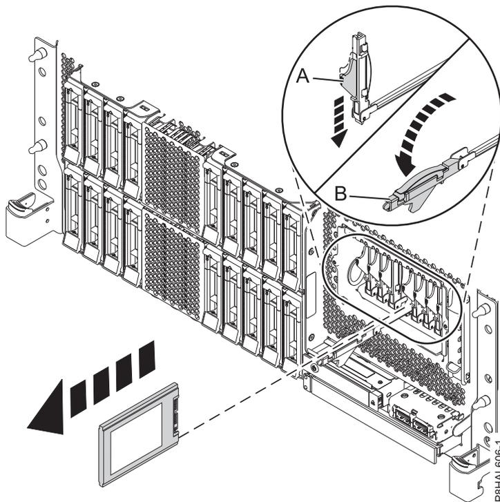
รูปที่ 91. การถอด SSD ออกจากระบบ expanded function ที่ติดตั้งในชั้นวาง
