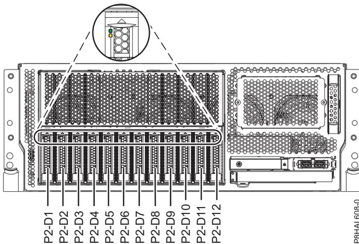
รูปที่ 16. ตำแหน่งของดิสก์ไดรฟ์ หรือโซลิตสเตทไดรฟ์ และไฟแสดงสถานะเซอร์วิสในระบบ base function 8247-42L, 8286-41A หรือ 8286-42A แบบติดตั้งในชั้นวาง
