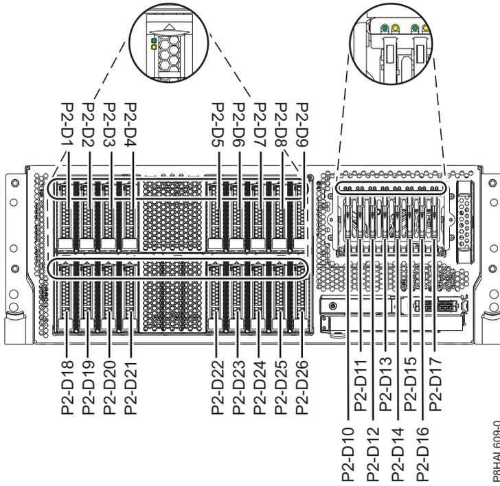
รูปที่ 41. ตำแหน่งของดิสก์ไดรฟ์ โซลิตสเททไดรฟ์ และไฟแสดงสถานะเซอร์วิสในระบบ expanded function 8286-41A หรือ 8286-42A แบบติดตั้งในชั้นวาง
