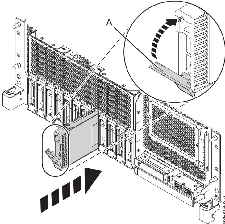
รูปที่ 46. การติดตั้งดิสก์ไดรฟ์ใน ระบบ base function ที่ติดตั้งในชั้นวาง
