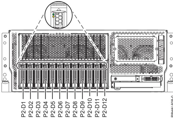
รูปที่ 141. ตำแหน่งของดิสก์ไดรฟ์ หรือโซลิดสเตทไดรฟ์ และไฟแสดงสถานะเซอร์วิสในระบบ base function 8247-42L, 8286-41A หรือ 8286-42A ที่ติดตั้งในชั้นวาง
