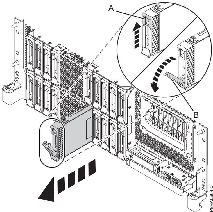
รูปที่ 119. การถอดดิสก์ไดร์ฟออกจากระบบ expanded function ที่ติดตั้งในชั้นวาง
