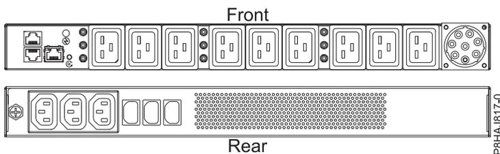
รูปที่ 164. PDU สำหรับระบบ 8408-44E
