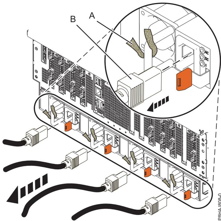
รูปที่ 161. การถอดสายไฟออกจากระบบ 8408-44E หรือ 8408-E8E
