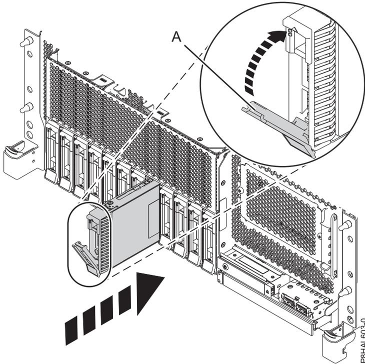
รูปที่ 125. การเปลี่ยน ดิสก์ไดรฟ์ในระบบ base function ที่ติดตั้งในชั้นวาง
