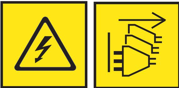
อันตราย: สายไฟหลายเส้น ผลิตกันที่อาจมากับสายไฟกระแสดตรง หลายเส้น หรือสายไฟกระแสสลับหลายเส้น ปลดการเชื่อมต่อสายไฟทั้งหมดเพื่อถอดสายไฟ และสายเคเบิลที่เป็นอันตรายออกไป (L003)
