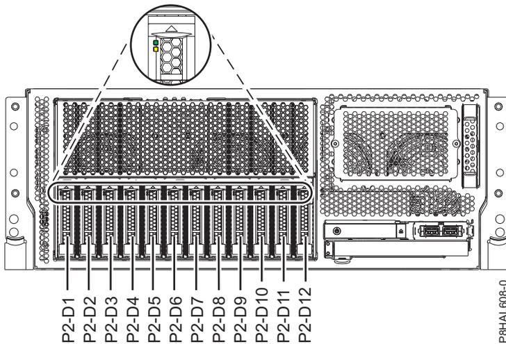
รูปที่ 27. ตำแหน่งของดิสก์ไดรฟ์ หรือโซลิดสเตทไดรฟ์ และไฟแสดงสถานะเซอรัวิสในระบบ base function 8247-42L, 8286-41A หรือ 8286-42A แบบติดตั้งในชั้นวาง
