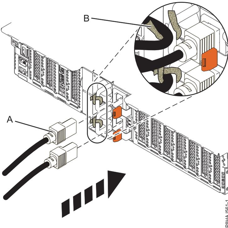
รูปที่ 166. การเชื่อมต่อสายไฟเข้ากับระบบ 5148-21L, 5148-22L, 8247-21L, 8247-22L, 8284-21A, or 8284-22A
