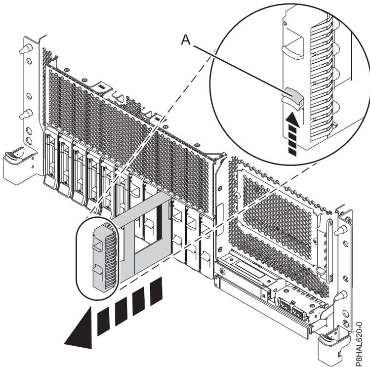
รูปที่ 133. การถอดดิสก์ไดรฟ์ฟิลเลอร์ ออกจากระบบ base function ที่ติดตั้งในชั้นวาง
