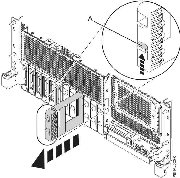
รูปที่ 5. การถอดดิสก์ไดรฟ์ฟิลเลอร์ออกจากระบบ base function ที่ติดตั้งในชั้นวาง
