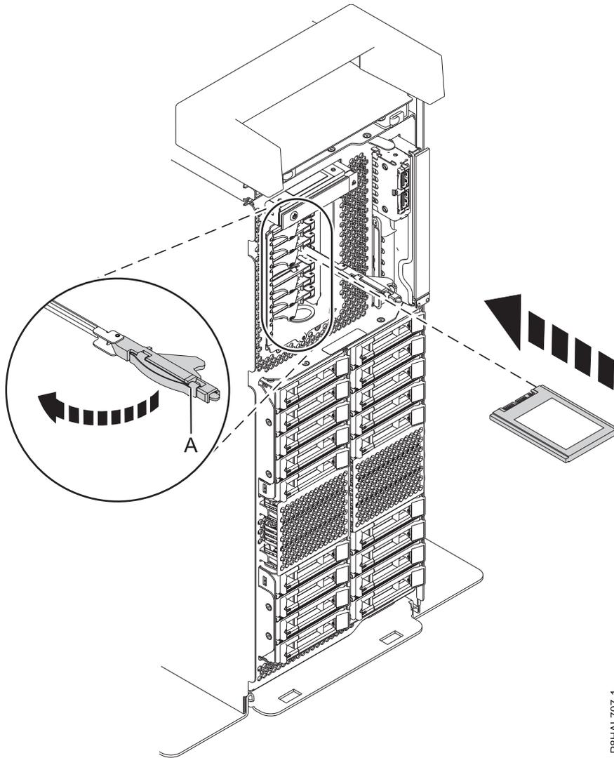
รูปที่ 98. การเปลี่ยน SSD ในระบบ expanded function แบบสแตนด์อะโลน
