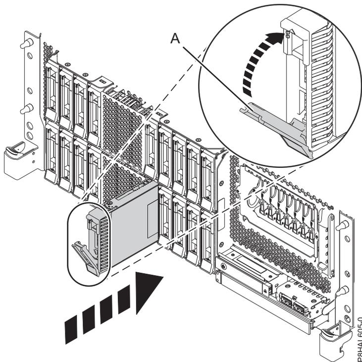
รูปที่ 7. การติดตั้งดิสก์ไดรฟ์ใน ระบบ expanded function ที่ติดตั้งในชั้นวาง
