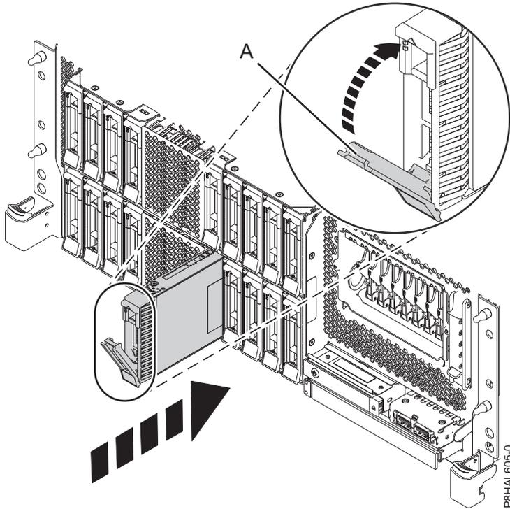
รูปที่ 47. การติดตั้งดิสก์ไดรฟ์ในระบบ *expanded function* ที่ติดตั้งในชั้นวาง
