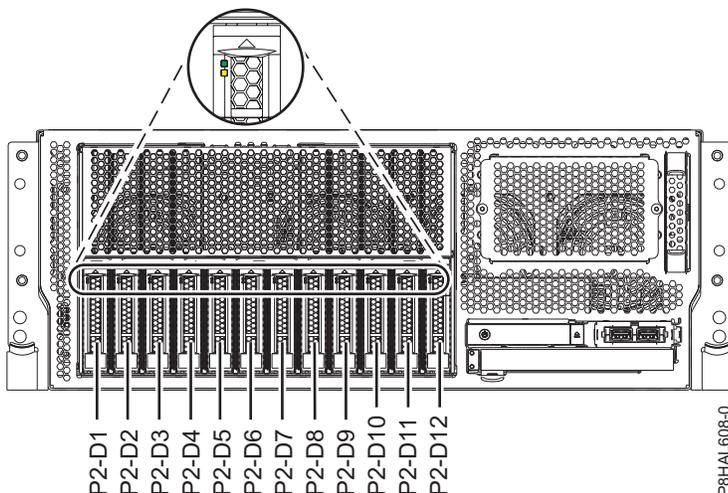
รูปที่ 1. ตำแหน่งของดิสก์ไดรฟ์ หรือโซลิดสเตทไดรฟ์ และไฟแสดงสถานะเซอร์วิสในระบบ base function 8247-42L, 8286-41A หรือ 8286-42A แบบติดตั้งในชั้นวาง
