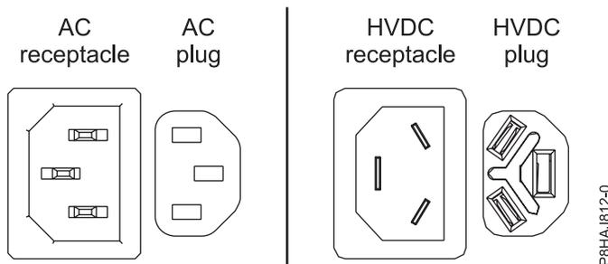
รูปที่ 156. ตัวเชื่อมต่อ AC และ HVDC
