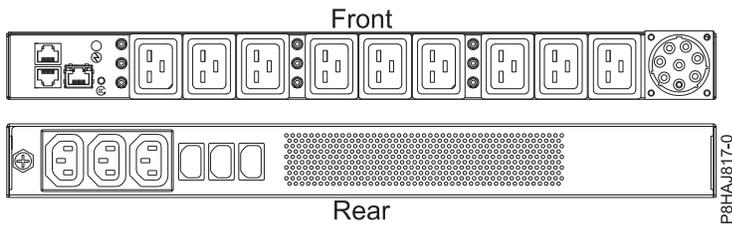
รูปที่ 158. PDU สำหรับระบบ 8408-44E
