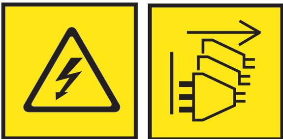
อันตราย: สายไฟหลายเส้น ผลิตภัณฑ์อาจมาพร้อมกับสายไฟกระแสตรง หลายเส้น หรือสายไฟกระแสสลับหลายเส้น ปลดการเชื่อมต่อสายไฟทั้งหมดเพื่อถอดสายไฟ และสายเคเบิลที่เป็นอันตรายออกไป (L003)
