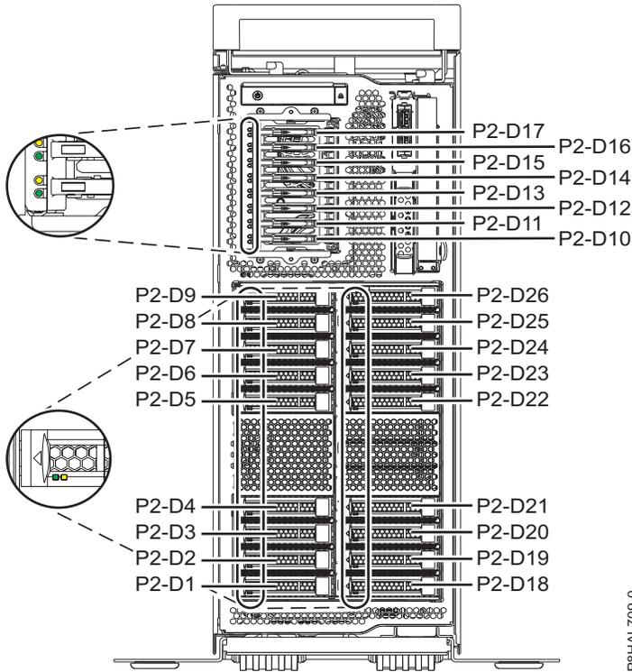
รูปที่ 43. ตำแหน่งของดิสก์ไดรฟ์ โซลิดสเตทไดรฟ์ และไฟแสดงสถานะเซอร์วิสในระบบ expanded function 8286-41A แบบสแตนด์อะโลน
