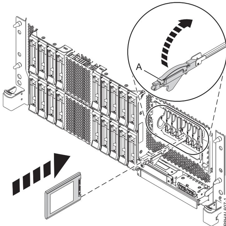
รูปที่ 14. การติดตั้ง SSD ในระบบ expanded function ที่ติดตั้งในชั้นวาง
