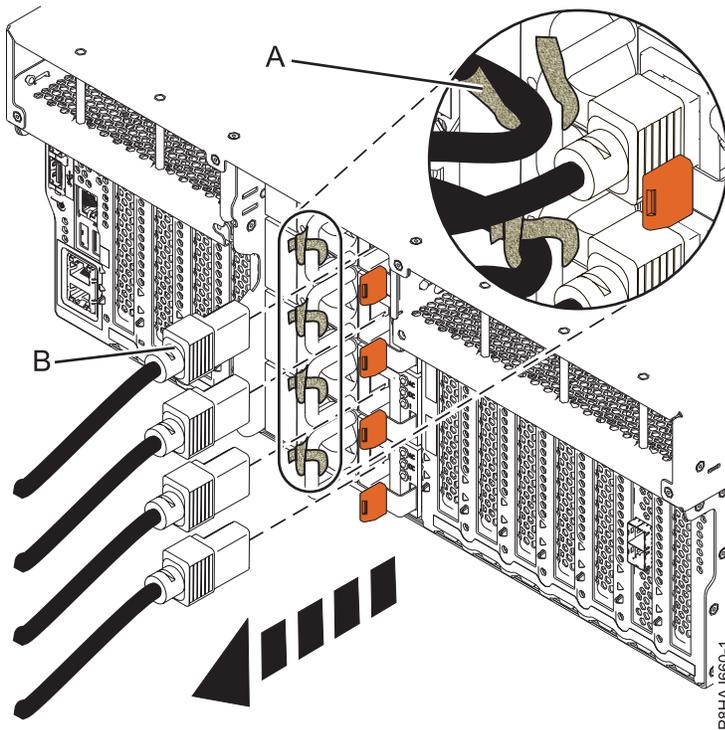
รูปที่ 159. การถอดสายไฟออกจากระบบ 8247-42L, 8286-41A หรือ 8286-42A
