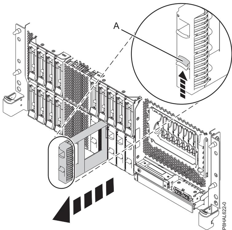
รูปที่ 134. การถอดดิสก์ไดรฟ์ฟิลเลอร์ออกจากระบบ expanded function ที่ติดตั้งในชั้นวาง
