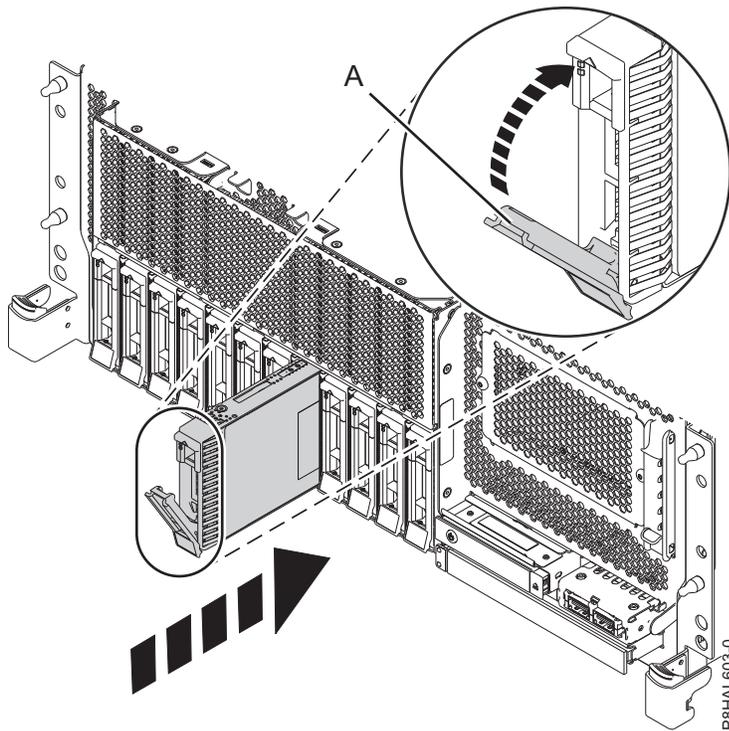
รูปที่ 79. การเปลี่ยน ดิสก์ไดรฟ์ในระบบ base function ที่ติดตั้งในชั้นวาง
