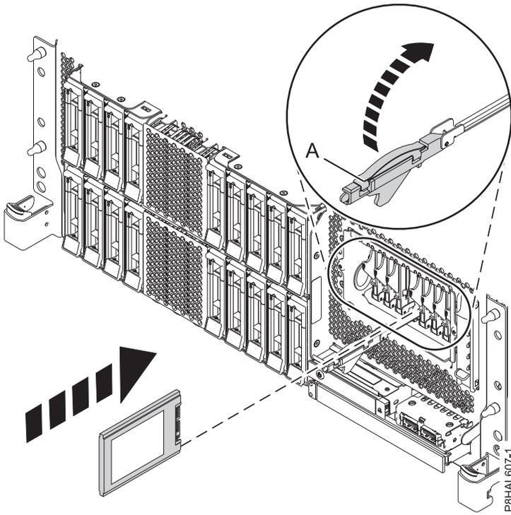
รูปที่ 67. การเปลี่ยน SSD ในระบบ expanded function ที่ติดตั้งในชั้นวาง
