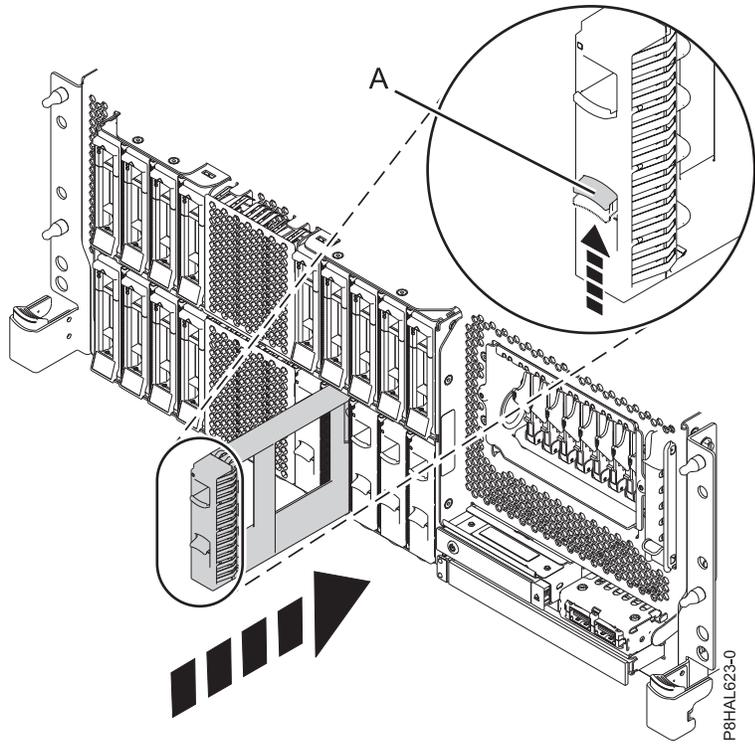
รูปที่ 138. การติดตั้งดิสก์ไดรฟ์ฟิลเลอร์ในระบบ expanded function ที่ติดตั้งในชั้นวาง
