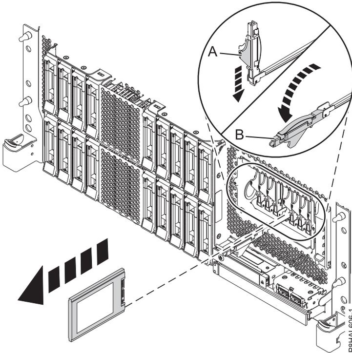
รูปที่ 61. การถอด SSD ออกจากระบบ expanded function ที่ติดตั้งในช่องว่าง
