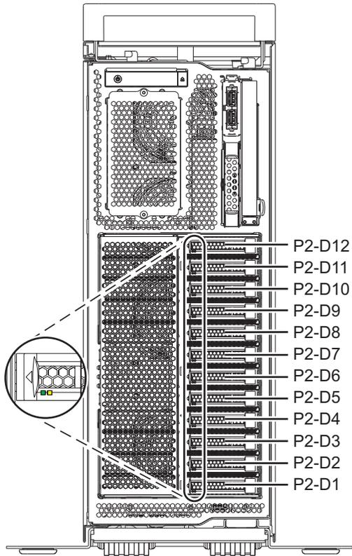
รูปที่ 3. ตำแหน่งของดิสก์ไดรฟ์ หรือโซลิดสเตตไดรฟ์ และไฟแสดงสถานะเซอร์วิสในระบบ base function 8286-41A แบบสแตนด์อะโลน
