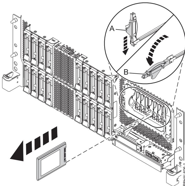
รูปที่ 105. การถอด SSD ออกจากระบบ expanded function ที่ติดตั้งในชั้นวาง
