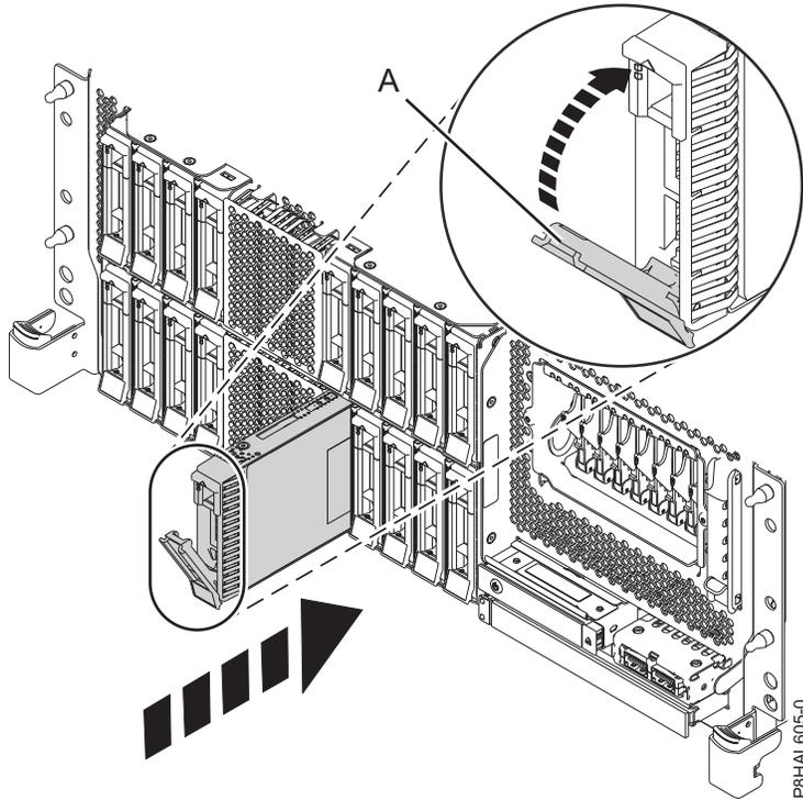
รูปที่ 64. การเปลี่ยน ดิสก์ไดร์ฟในระบบ expanded function ที่ติดตั้งในชั้นวาง
