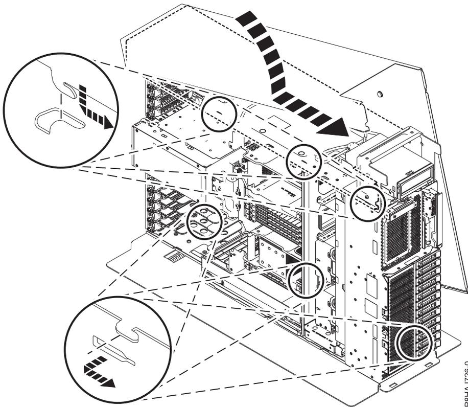
รูปที่ 181. การติดตั้งฝาครอบด้านข้างของ 8286-41A
