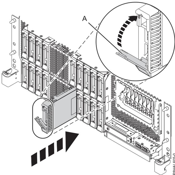
รูปที่ 126. การเปลี่ยน ดิสก์ไดรฟ์ในระบบ expanded function ที่ติดตั้งในชั้นวาง
