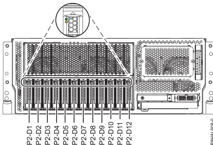
รูปที่ 69. ตำแหน่งของดิสก์ไดรฟ์ หรือโซลิดสเตตไดรฟ์ และไฟแสดงสถานะเซอร์วิสในระบบ base function 8247-42L, 8286-41A หรือ 8286-42A แบบติดตั้งในชั้นวาง
