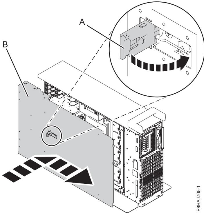
รูปที่ 186. การติดตั้ง ฝาครอบการเข้าถึงเซอรวีส
