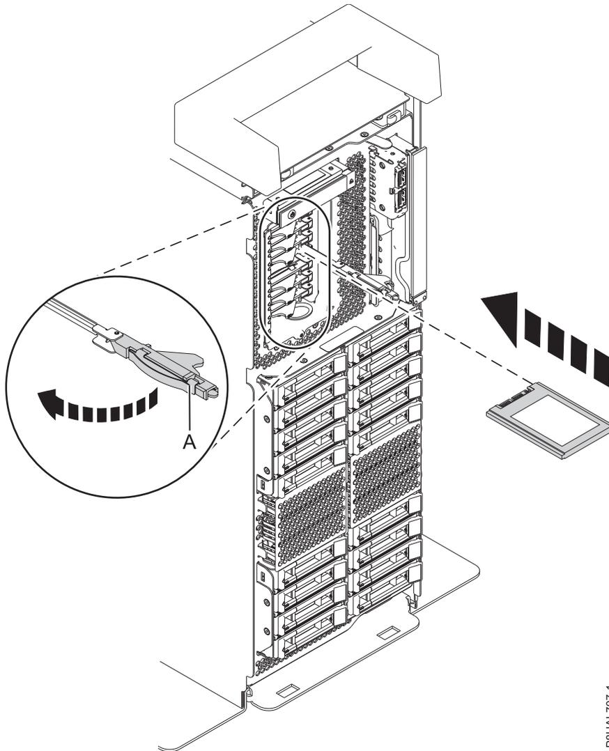
รูปที่ 39. การติดตั้ง SSD ในระบบ expanded function แบบสแตนด์อะโลน
