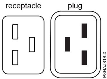
รูปที่ 157. ตัวเชื่อมต่อสำหรับระบบ 8408-44E
