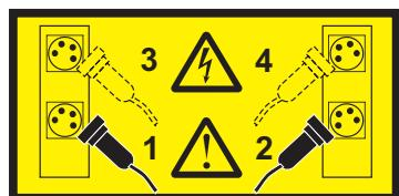
**NEVARNOST:** Več napajalnih kablov. Izdelek je lahko opremljen z več napajalnimi kabli. Da odstranite vso nevarno napetost, izklopite vse napajalne kable. (L003)
