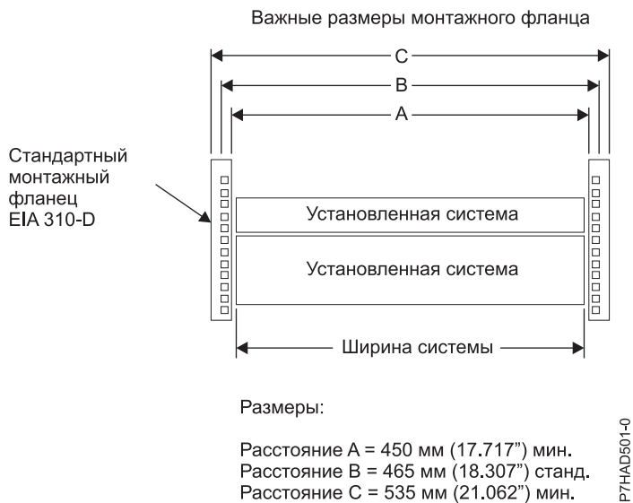
Рисунок 66. Критически важные размеры монтажных фланцев
