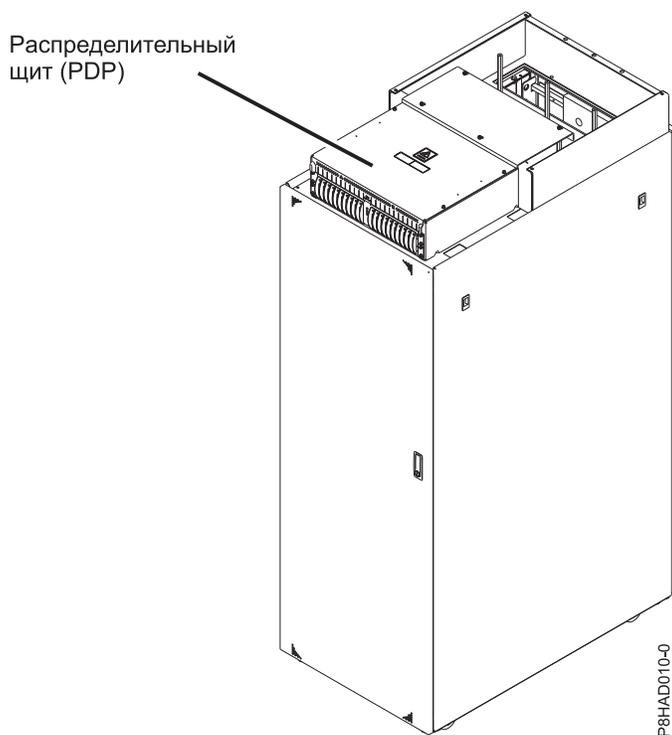
*Рисунок 21. FC EPB8 - распределительный щит питания*
