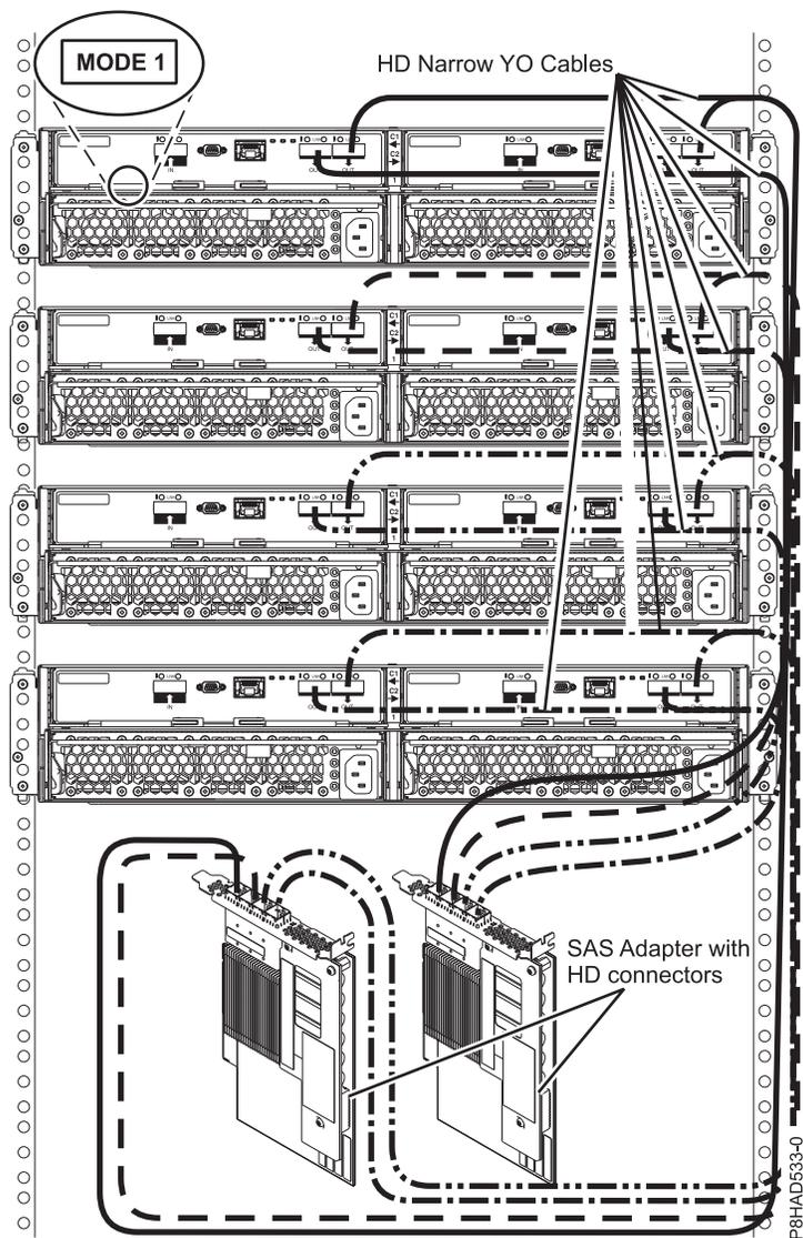
Рисунок 88. Подключение четырех корпусов 5887 к двум адаптерам SAS PCIe3 с помощью узких разъемов HD, режим 1
