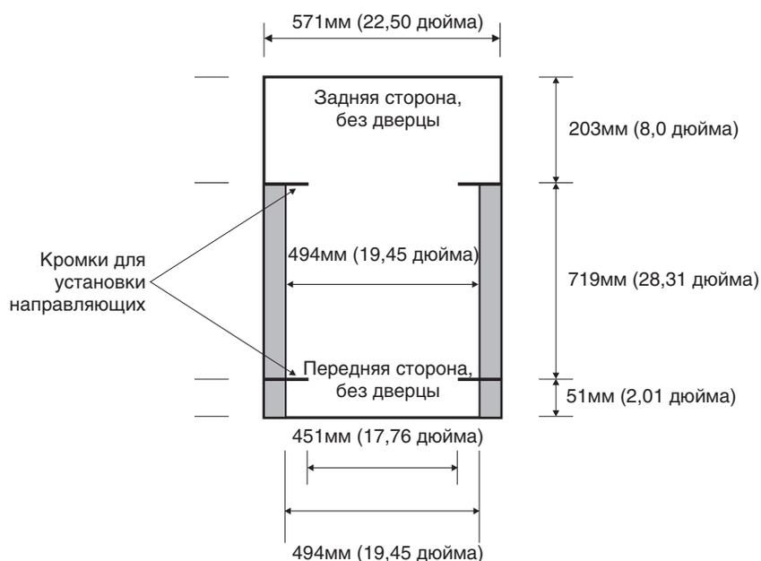
Последовательные расстояния между тремя монтажными отверстиями одной группы по вертикали (снизу вверх) должны составлять 15,9, 15,9 и 12,67 мм, при этом группы должны отстоять друг от друга на 44,45 мм. Передний и задний монтажные фланцы в стойке должны находиться на расстоянии не менее 719 мм (28,3 дюйма) друг от друга, а внутреннее расстояние между ними должно быть не менее 494 мм (19,45 дюймов), чтобы направляющие IBM поместились в стойке или ящике (см. следующий рисунок).
