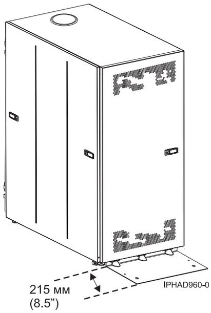
Рисунок 18. Модели 0555 и 7014-S25 с опорами стабилизации
