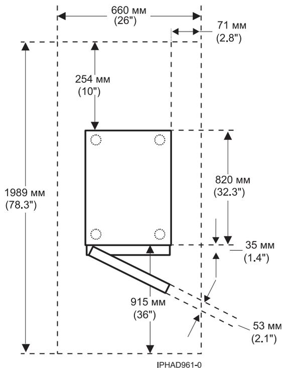
Рисунок 16. Схема расположения модели 0554 и 7014-S11
