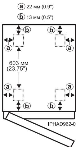
Рисунок 17. Расположения роликов для моделей 0554 и 7014-S11
