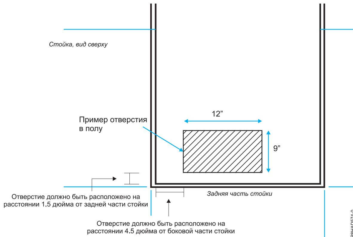
Рисунок 35. Отверстие в полу
