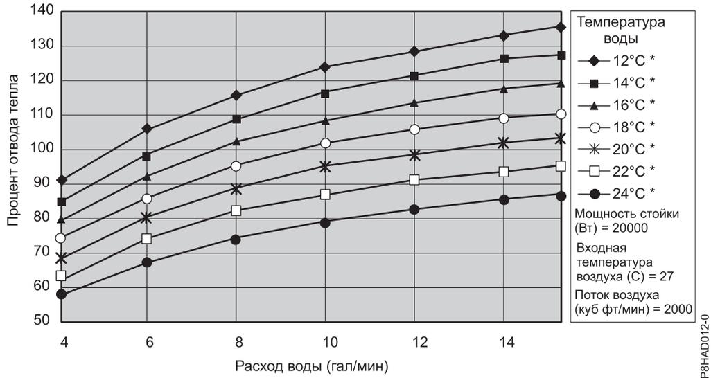
Рисунок 40. Типичная характеристика теплообменника, тепловая нагрузка 20 кВт
