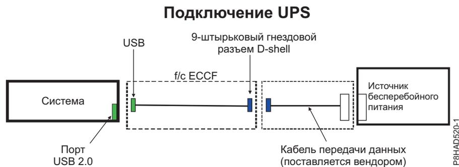
Рисунок 45. Подключение UPS для 5148-21L, 5148-22L, 8247-21L, 8247-21L, 8247-22L, 8247-42L, 8284-22A, 8286-41A и 8286-42A
