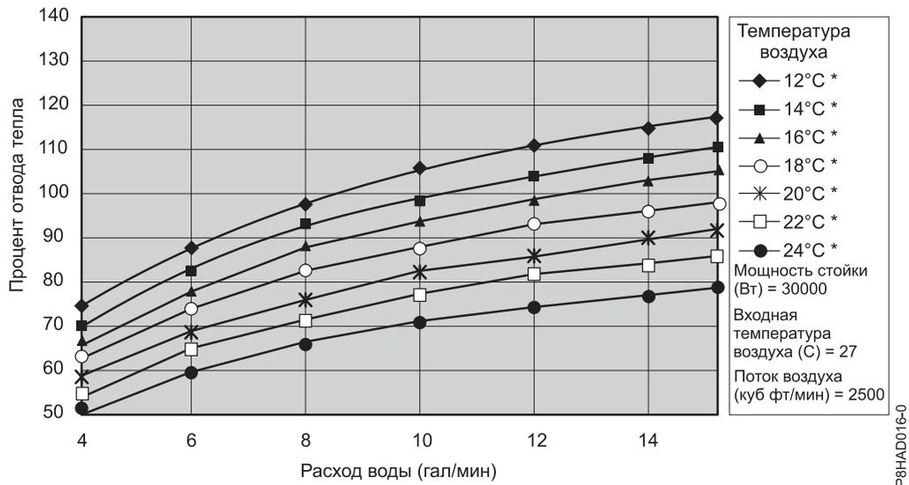
Рисунок 41. Типичная характеристика теплообменника, тепловая нагрузка 30 кВт
