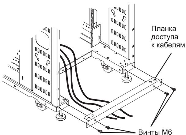
Рисунок 28. Планка доступа к кабелям
