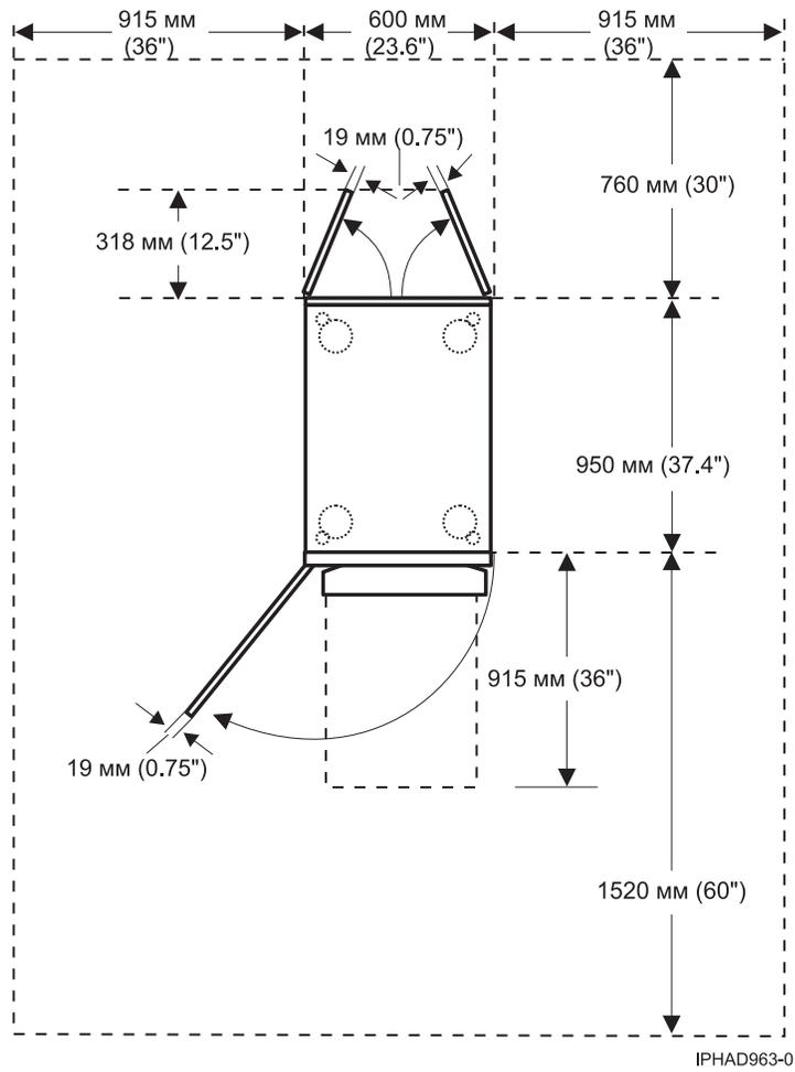
Рисунок 19. Схема расположения модели 0555 и 7014-S25
