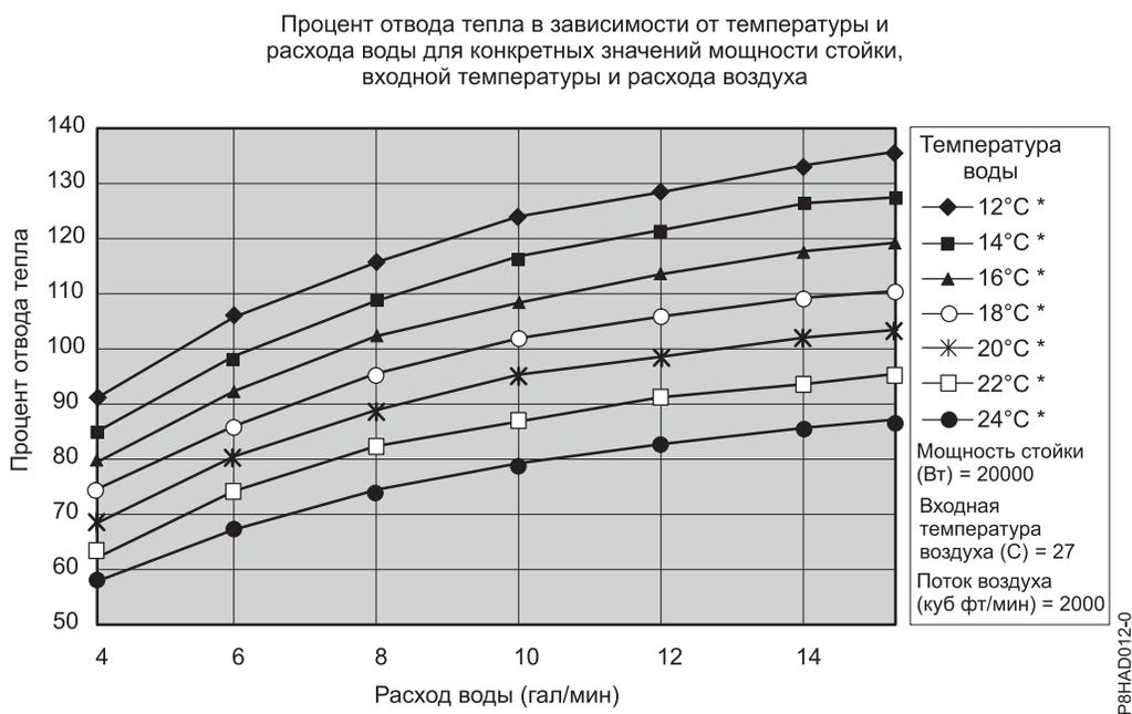
Рисунок 32. Типичная характеристика теплообменника, тепловая нагрузка 20 кВт
