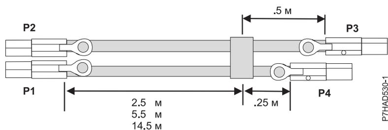
Рисунок 53. Длины внешних кабелей X SAS с разъемами
