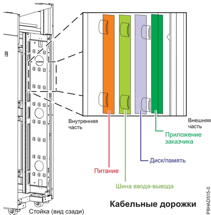
Рисунок 50. Перемычки фиксации кабелей
