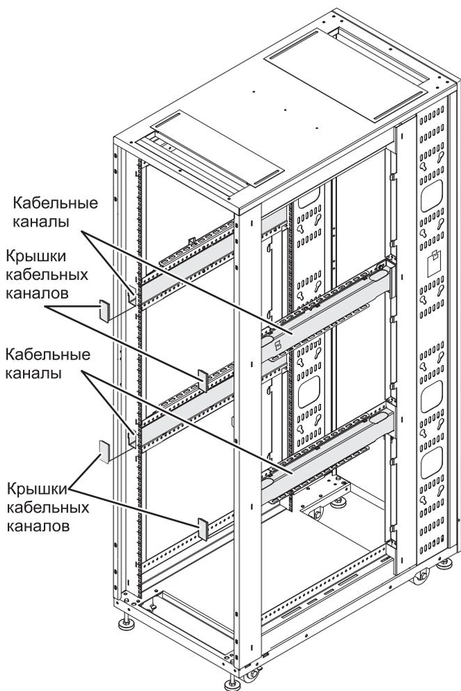
Рисунок 27. Прокладка кабелей внутри стойки
