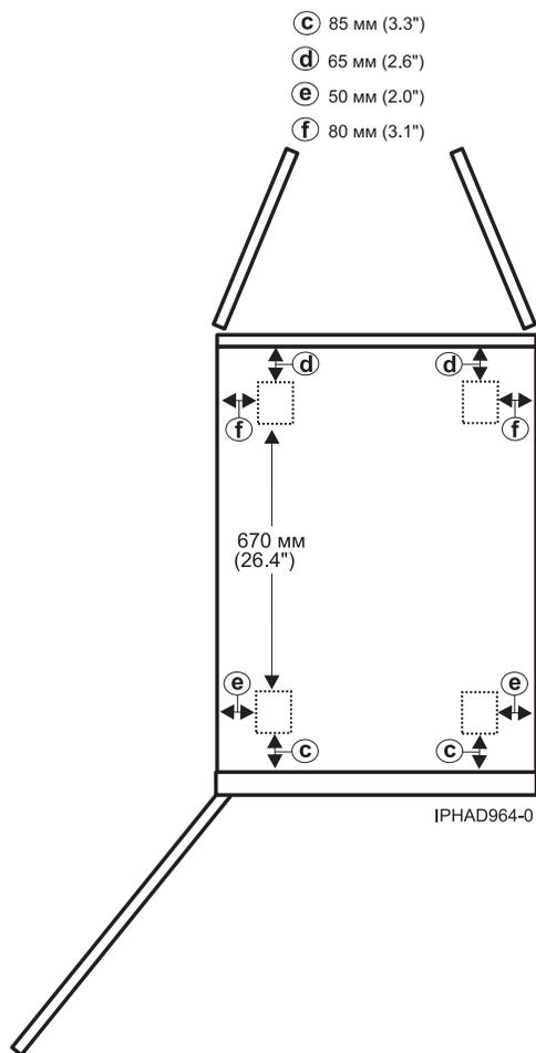
Рисунок 20. Расположения роликов для моделей 0555 и 7014-S25
