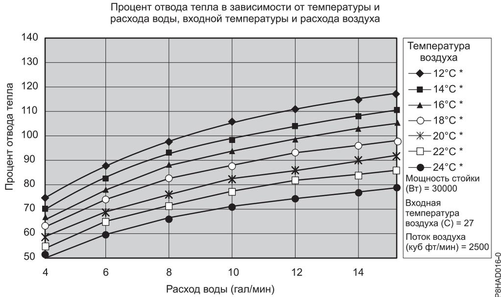
Рисунок 33. Типичная характеристика теплообменника, тепловая нагрузка 30 кВт
