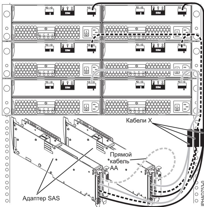
При подключении только жестких дисков также возможно подключить каскадно второй блок расширения диска для двух из трех блоков максимум из пяти блоков расширения диска на один адаптер. Обратитесь к разделу рис. 58 на стр. 130.
