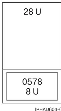
Рисунок 12. Код продукта 0578 - блок расширения PCI-X в стойке
