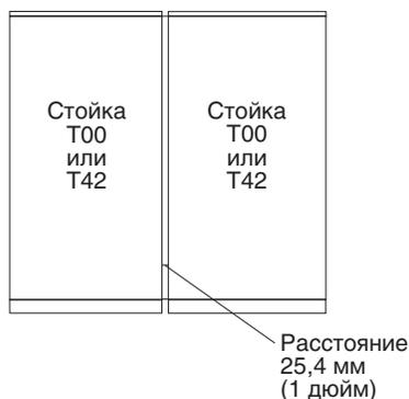
Для соединения стоек можно заказать комплект болтов, вставок и декоративных накладок, закрывающих зазор шириной 25,4 мм. Размеры пространства для обслуживания приведены в таблице для стойки модели 7014-T00.
