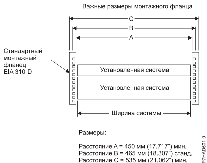
Рисунок 43. Критически важные размеры монтажных фланцев
