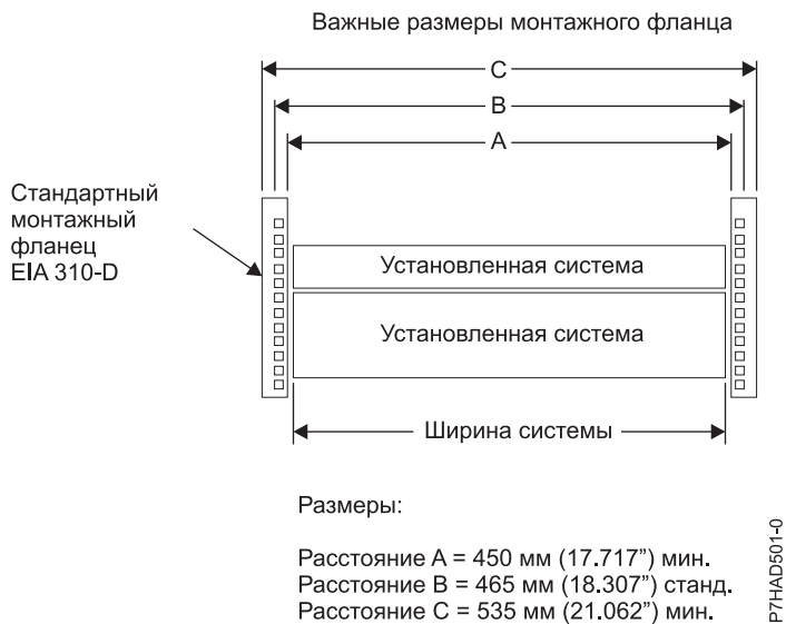
Рисунок 43. Критически важные размеры монтажных фланцев
