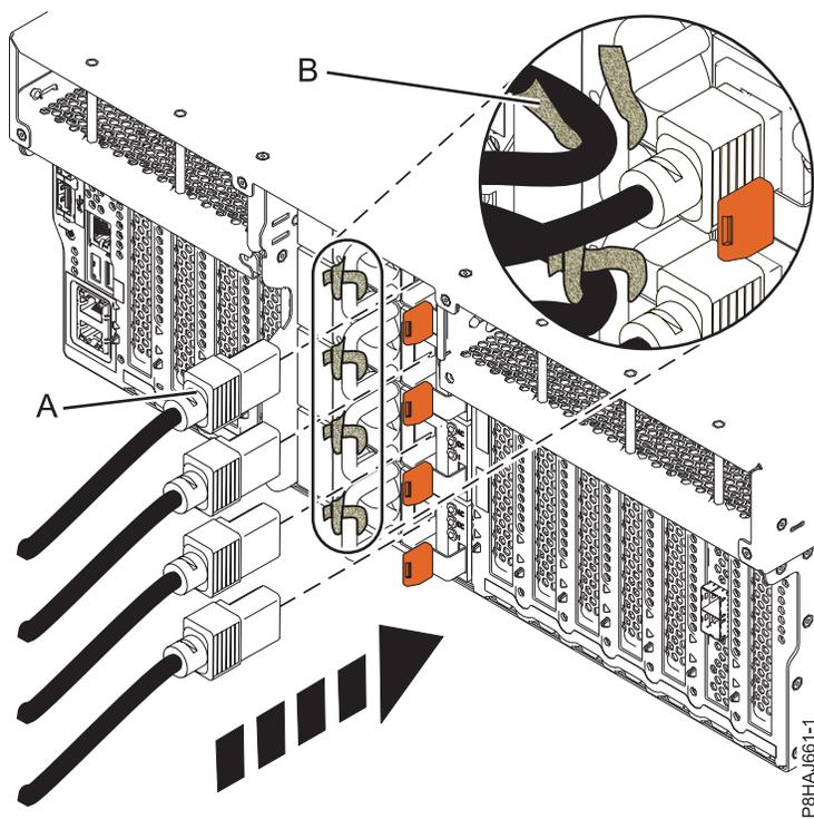
Figura 126. Ligar os cabos de alimentação a um sistema 8247-42L, 8286-41A ou 8286-42A
