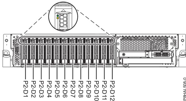
Figura 104. Localizações das unidades de disco e indicadores de assistência para um sistema de função base 5148-21L, 5148-22L, 8247-21L, 8247-22L, 8284-21A ou 8284-22A
