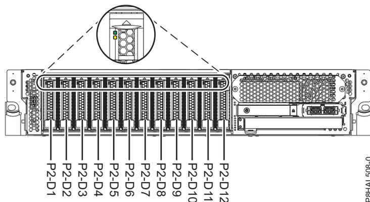
Figura 70. Localizações das unidades de disco e indicadores de assistência para um sistema de função base
