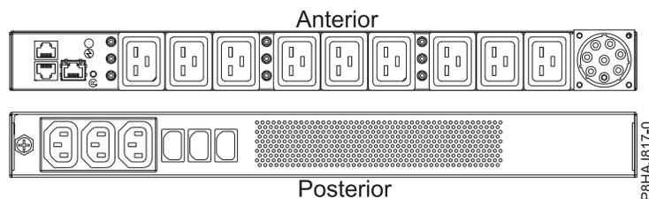
Figura 125. PDU para o sistema 8408-44E
