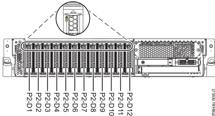
Figura 10. Localizações das unidades de disco e indicadores de assistência para um sistema de função base
