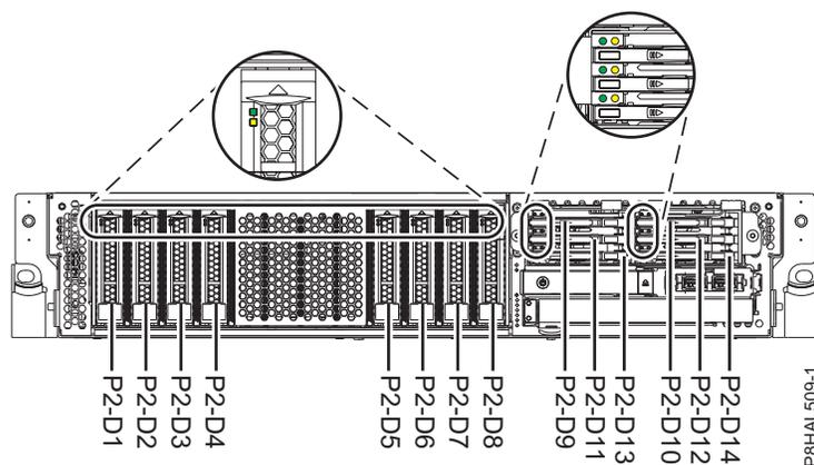
*Figura 6. Localização da unidade de disco, unidade de segunda geração e indicadores de assistência para um sistema de função expandida*
