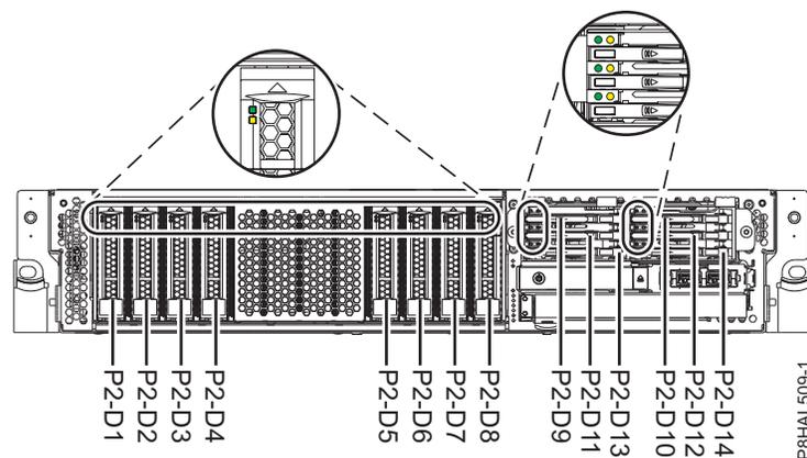
Figura 59. Localização da unidade de disco, unidade de segunda geração e indicadores de assistência para um sistema de função expandida
