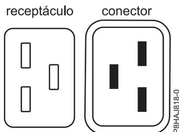
Figura 124. Conectores para o sistema 8408-44E
