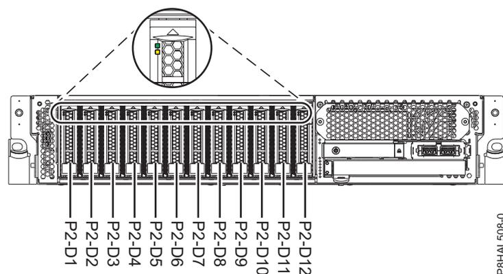
Figura 58. Localizações das unidades de disco e indicadores de assistência para um sistema de função base
