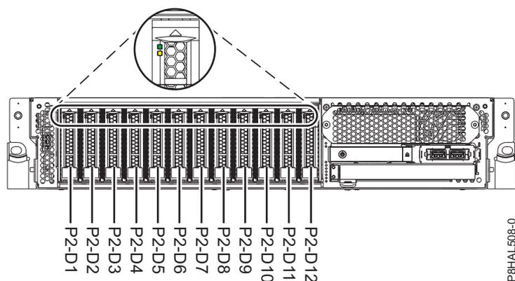
Figura 48. Localizações das unidades de disco e indicadores de assistência para um sistema de função base
