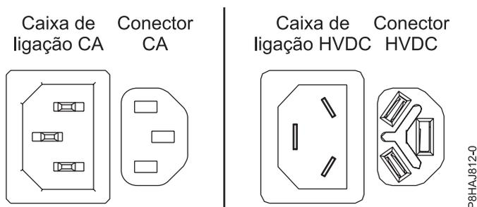
Figura 123. Conectores de AC e de HVDC
