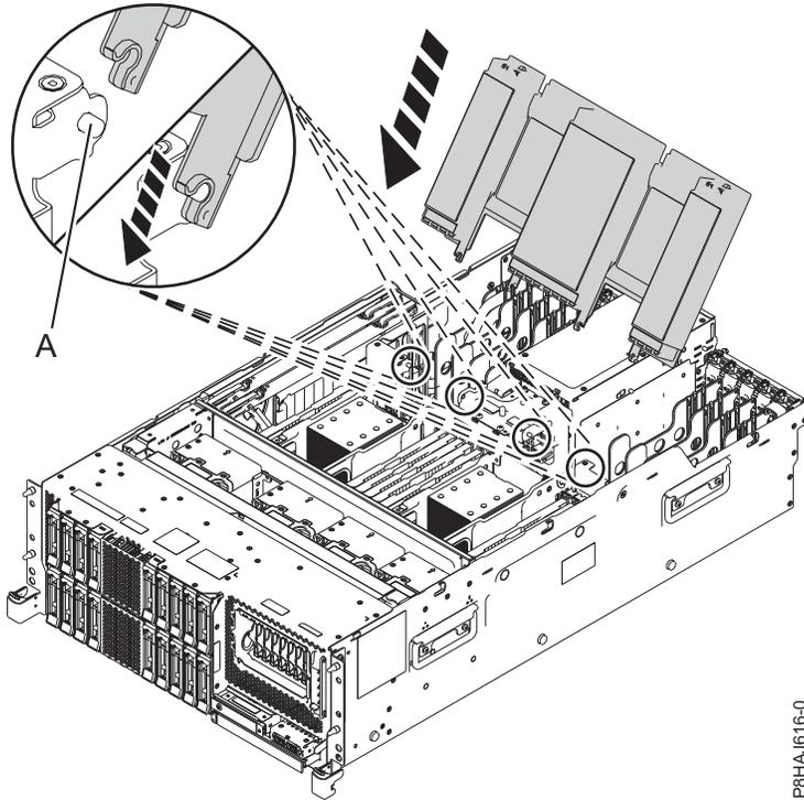
Figura 151. Substituir a conduta de ventilação
