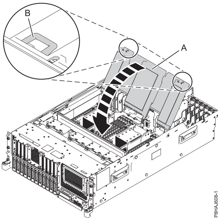
Figura 149. Fechar a conduta de ventilação
