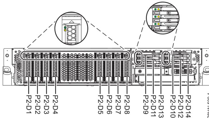
Figura 71. Localização da unidade de disco, unidade de segunda geração e indicadores de assistência para um sistema de função expandida
