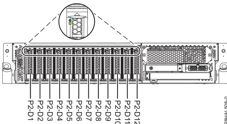
Figura 28. Localizações das unidades de disco e indicadores de assistência para um sistema de função base
