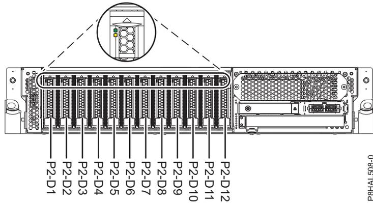
Figura 38. Localizações das unidades de disco e indicadores de assistência para um sistema de função base
