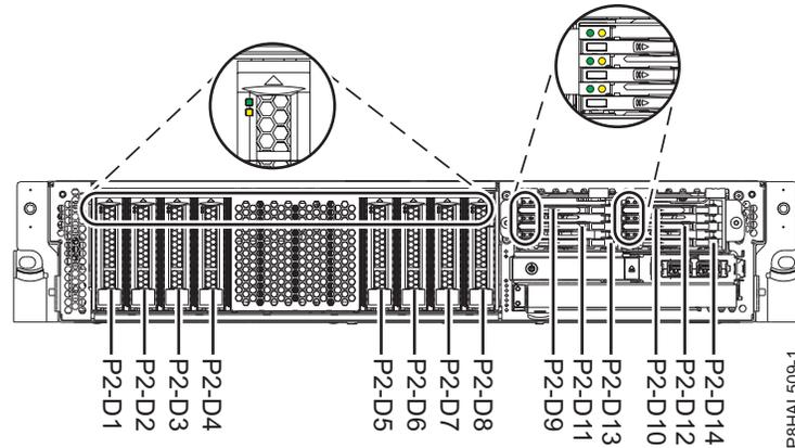
Figura 29. Localização da unidade de disco, unidade de segunda geração e indicadores de assistência para um sistema de função expandida
