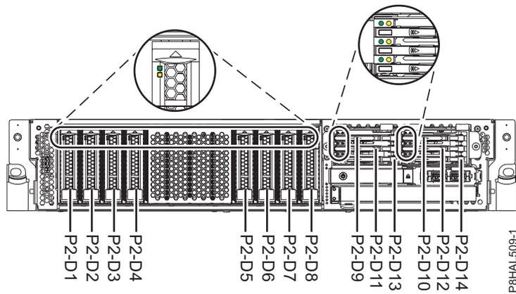
Figura 39. Localização da unidade de disco, unidade de segunda geração e indicadores de assistência para um sistema de função expandida
