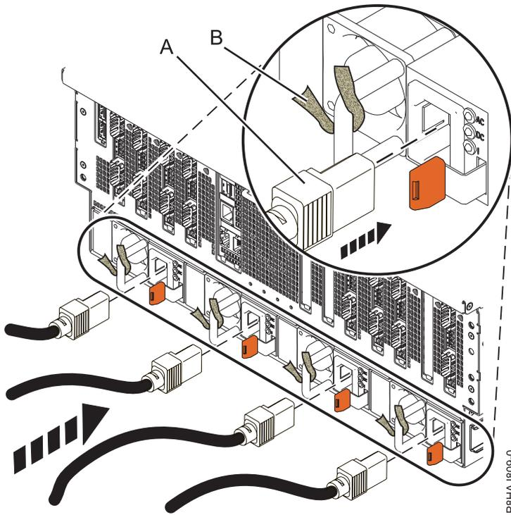
Figura 128. Ligar os cabos de alimentação a um sistema 8408-44E ou 8408-E8E
