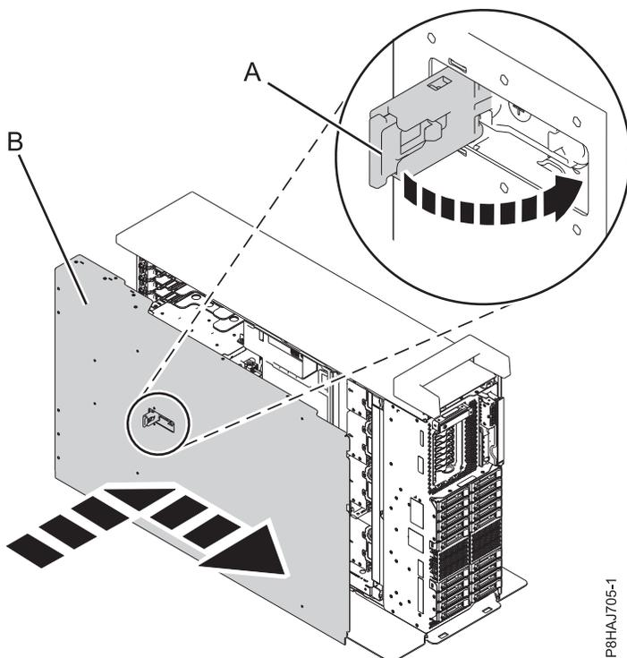
Figura 147. Instalar a tampa de acesso para assistência
