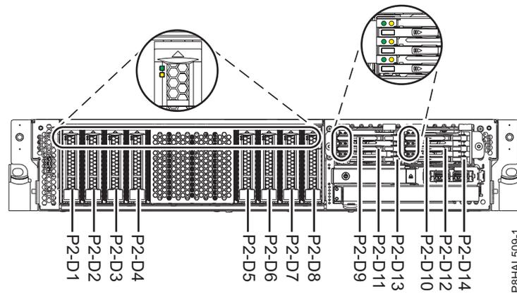
Figura 83. Localização da unidade de disco, unidade de segunda geração e indicadores de assistência para um sistema de função expandida
