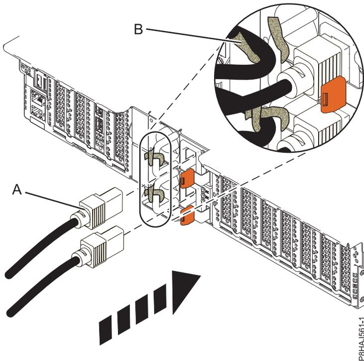
Figura 127. Ligar os cabos de alimentação a um sistema 5148-21L, 5148-22L, 8247-21L, 8247-22L, 8284-21A ou 8284-22A
