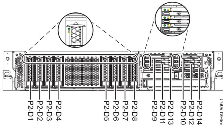
Figura 19. Localização da unidade de disco, unidade de segunda geração e indicadores de assistência para um sistema de função expandida
