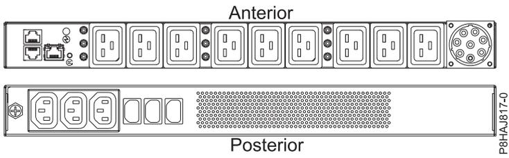
Figura 119. PDU para o sistema 8408-44E
