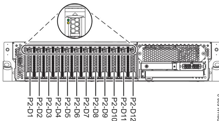
Figura 1. Localizações das unidades de disco e indicadores de assistência para um sistema de função base
