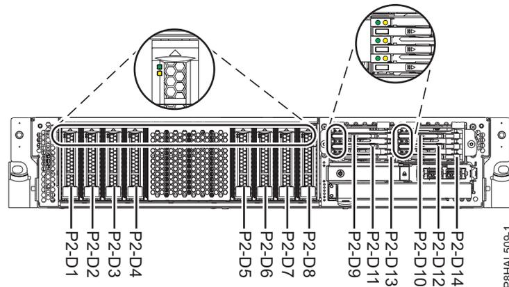
Figura 2. Localização da unidade de disco, unidade de segunda geração e indicadores de assistência para um sistema de função expandida
