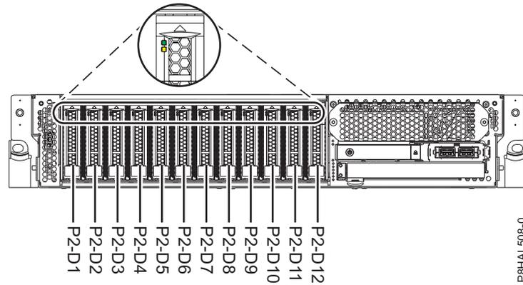
Figura 82. Localizações das unidades de disco e indicadores de assistência para um sistema de função base
