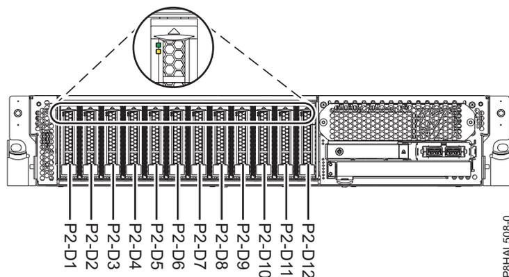
Figura 18. Localizações das unidades de disco e indicadores de assistência para um sistema de função base
