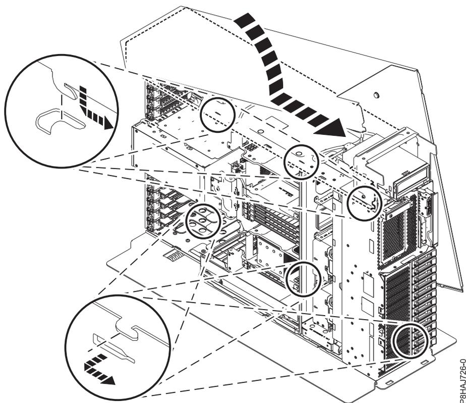
Figura 142. Instalar a tampa lateral de 8286-41A
