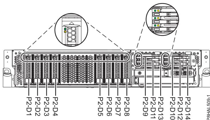
Figura 49. Localização da unidade de disco, unidade de segunda geração e indicadores de assistência para um sistema de função expandida
