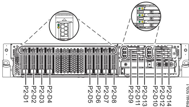
Figura 11. Localização da unidade de disco, unidade de segunda geração e indicadores de assistência para um sistema de função expandida
