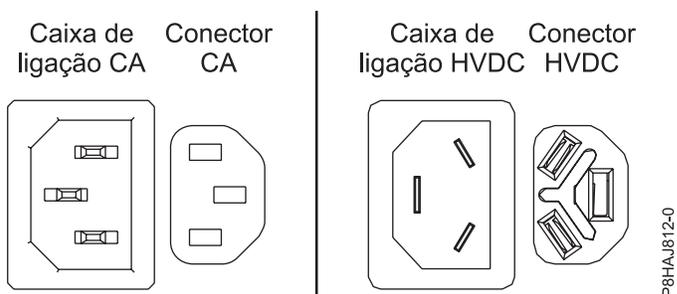
Figura 117. Conectores de AC e de HVDC
