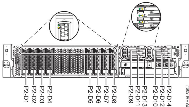
Figura 105. Localização da unidade de disco, unidade de segunda geração e indicadores de assistência para um sistema de função expandida 5148-21L, 5148-22L, 8247-21L, 8247-22L, 8284-21A ou 8284-22A
