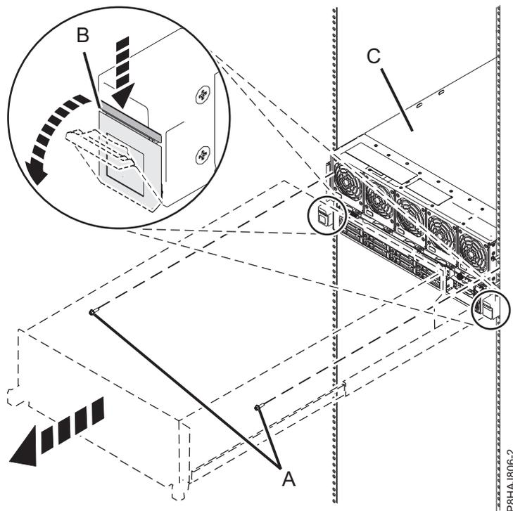
Figura 45. Colocando o sistema na posição de serviço
