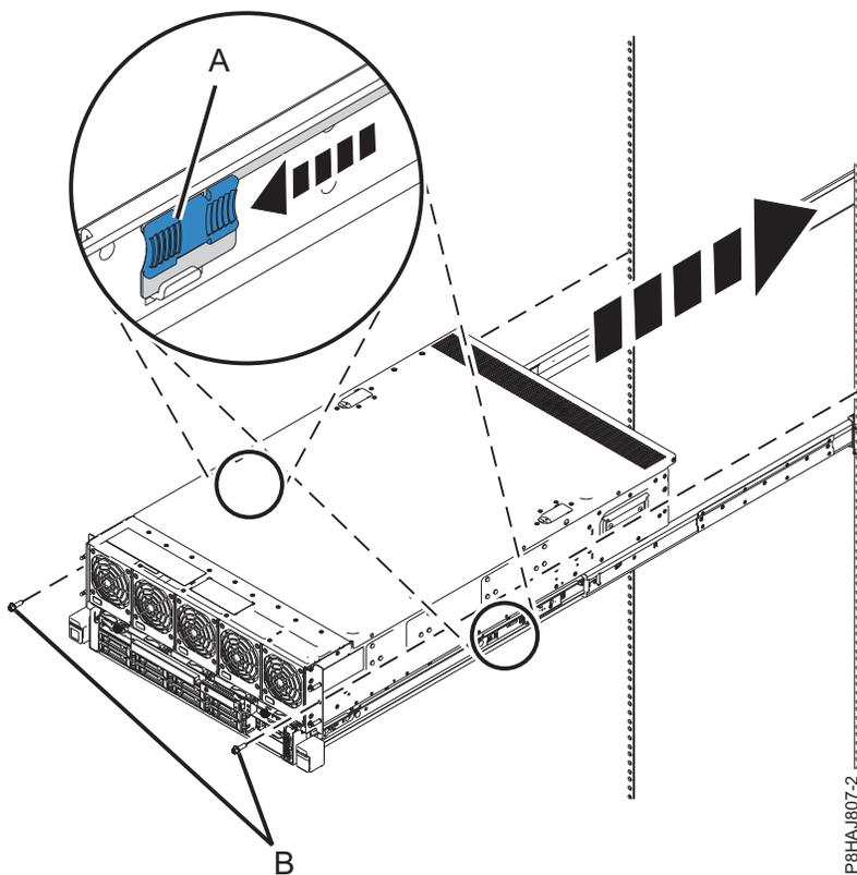
Figura 46. Colocando o Sistema na Posição de Operação
