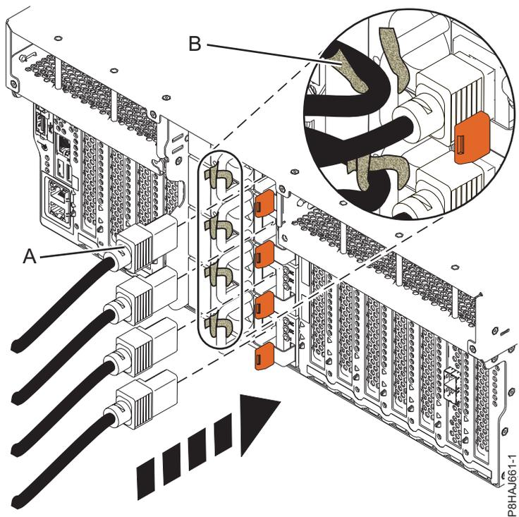
Figura 34. Conectando os cabos de energia a um sistema 8247-42L, 8286-41A ou 8286-42A
