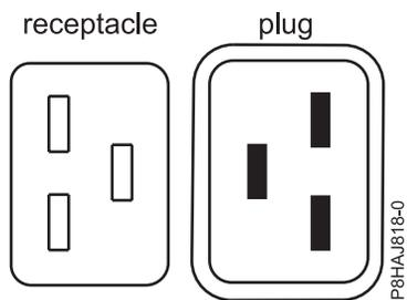
Figura 32. Conectores do sistema 8408-44E
