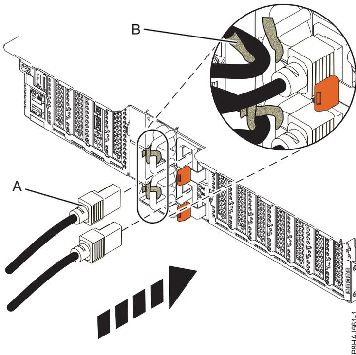
Figura 35. Conectando os cabos de energia a um sistema 5148-21L, 5148-22L, 8247-21L, 8247-22L, 8284-21A ou 8284-22A
