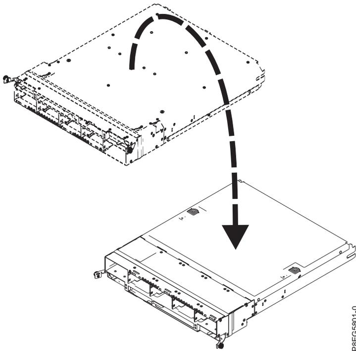
Figura 8. Girando o conjunto RAID de cabeça para baixo
