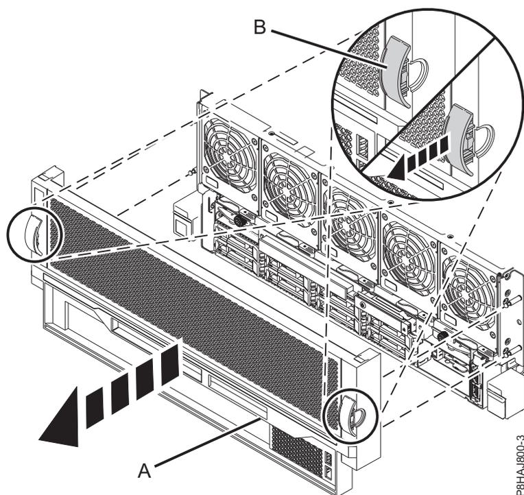
Figura 37. Removendo a Tampa Frontal
