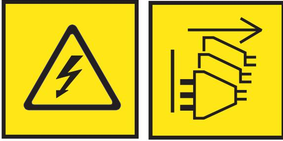
**PERIGO:** Vários cabos de alimentação. O produto deve estar equipado com vários cabos de energia de corrente alternada ou vários cabos de energia de corrente contínua. Para remover todas as voltagens perigosas, desconecte todos os cabos de energia. (L003)
