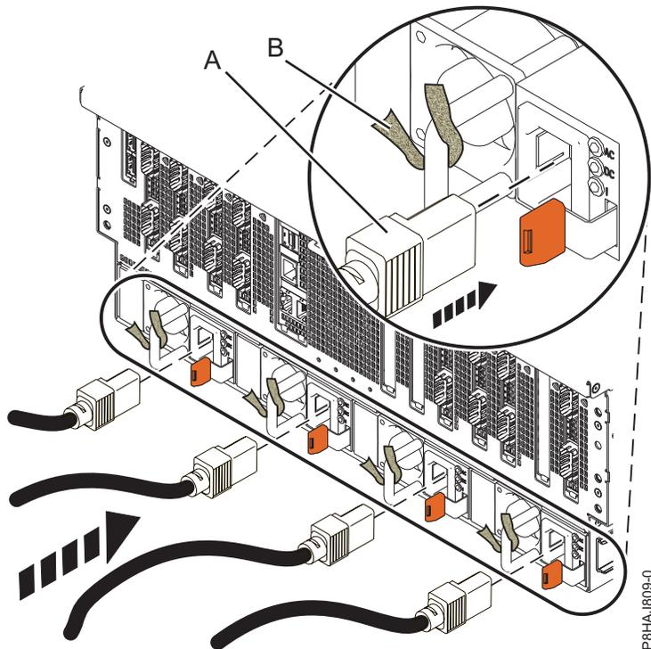
Figura 36. Conectando os cabos de energia a um sistema 8408-44E ou 8408-E8E
