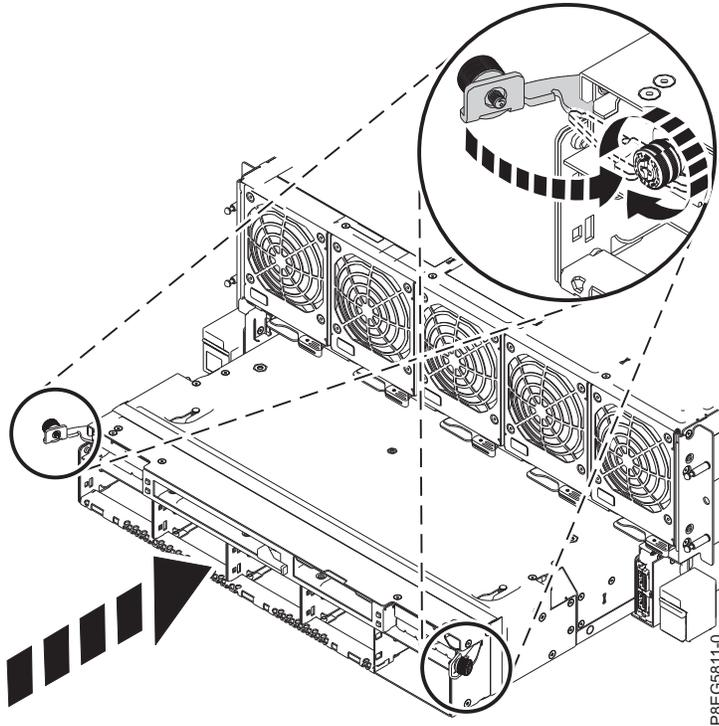
Figura 18. Substituindo o conjunto RAID
