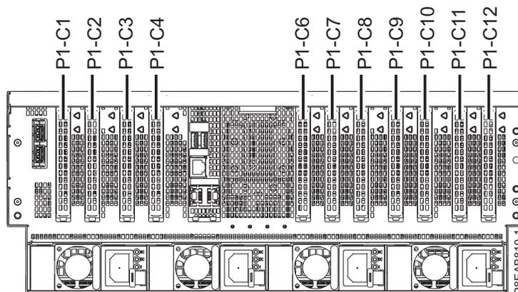
Figura 1. Vista posterior de um sistema 8408-44E ou 8408-E8E com códigos de local dos slots PCIe
