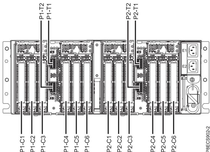
Figura 2. Vista posterior de um Gaveta de expansão PCIe3 EMX0 com códigos de local dos slots do PCIe
