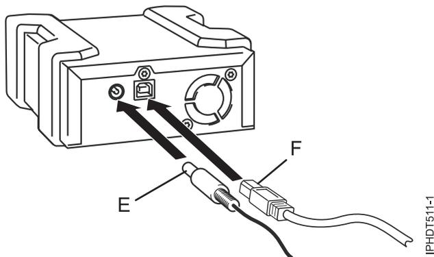
図 2. 外付けドライブ上の背面図およびコネクタ
