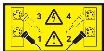
**危険:** 複数の電源コード。この製品は複数の電源コードを備えていることがあります。 危険な電圧をすべて除去するには、すべての電源コードを取り外してください。 (L003)
