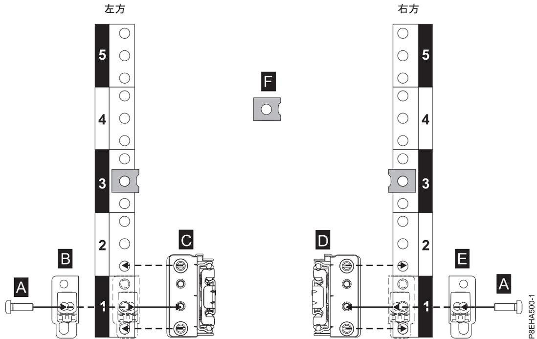
図 4. ラックの前面でのスライド・レールの取り付け
