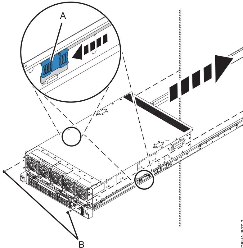
図 13. レールの中央にあるラッチを解放し、ラック内に完全に収まるようにシステムを押し入れる
