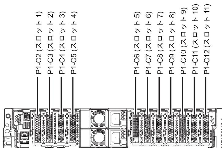
図 1. PCIe スロットのロケーション・コード付きの 5148-21L、5148-22L、8247-21L、8247-22L、8284-21A、または 8284-22A システムの背面図
