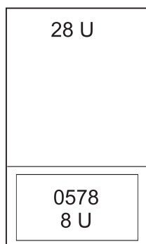
12. ábra: 0578 termékkód - PCI-X bővíítőegység rackben
