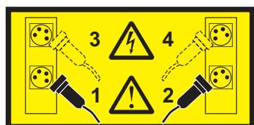
**OPASNOST:** Višestruke naponske žice. Proizvod može biti opremljen s više naponskih kablova. Da bi uklonili sve rizične napone odspojite sve naponske žice. (L003)
