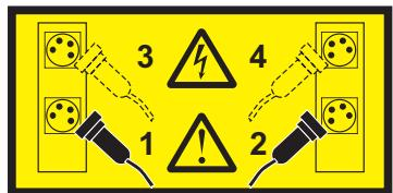
**OPASNOST:** Višestruke naponske žice. Proizvod može biti opremljen s više naponskih kablova. Da bi uklonili sve rizične napone odsvojite sve naponske žice. (L003)
