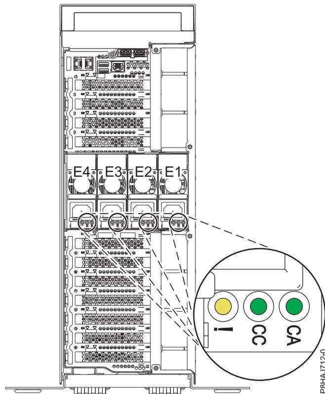
Figure 2. Emplacement des blocs d'alimentation et des voyants dans un système autonome
