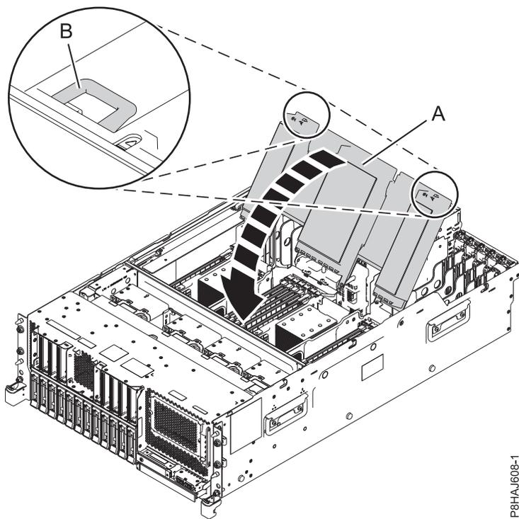
Figure 59. Fermeture du déflecteur d'air
