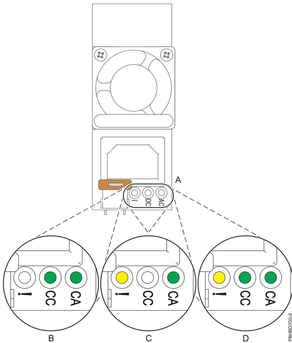
Figure 24. Voyants pour un bloc d'alimentation opérationnel et défaillant dans un système autonome
