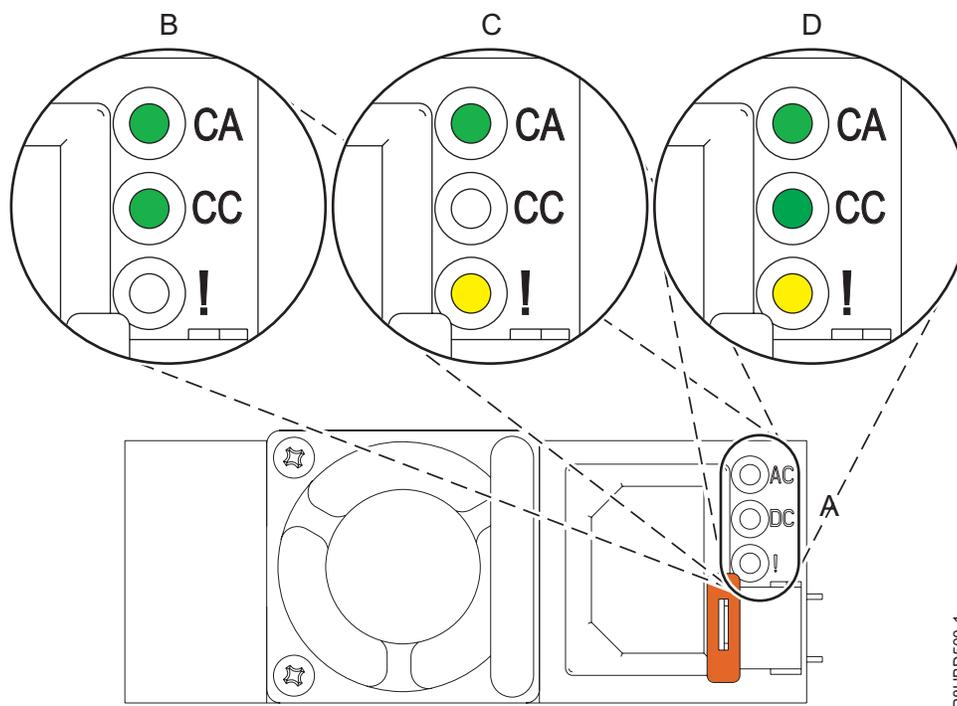
Figure 11. Voyants pour un bloc d'alimentation opérationnel et défectueux dans un système monté en armoire
