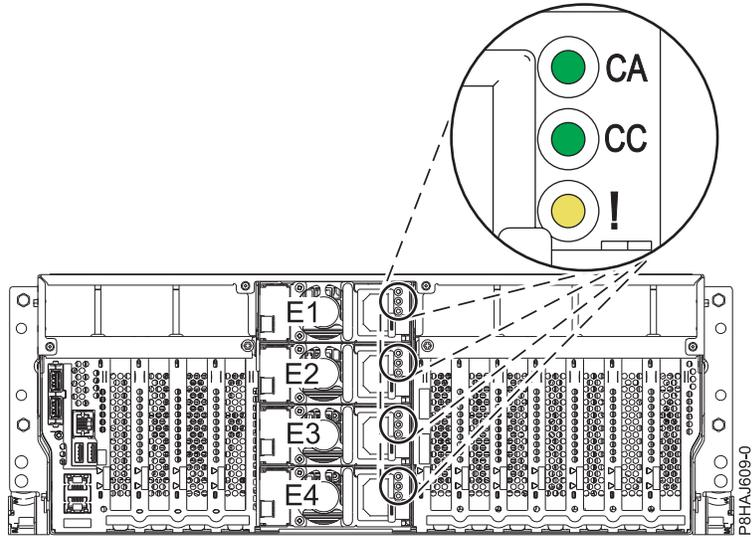
Figure 1. Emplacement des blocs d'alimentation et des voyants dans un système monté en armoire
