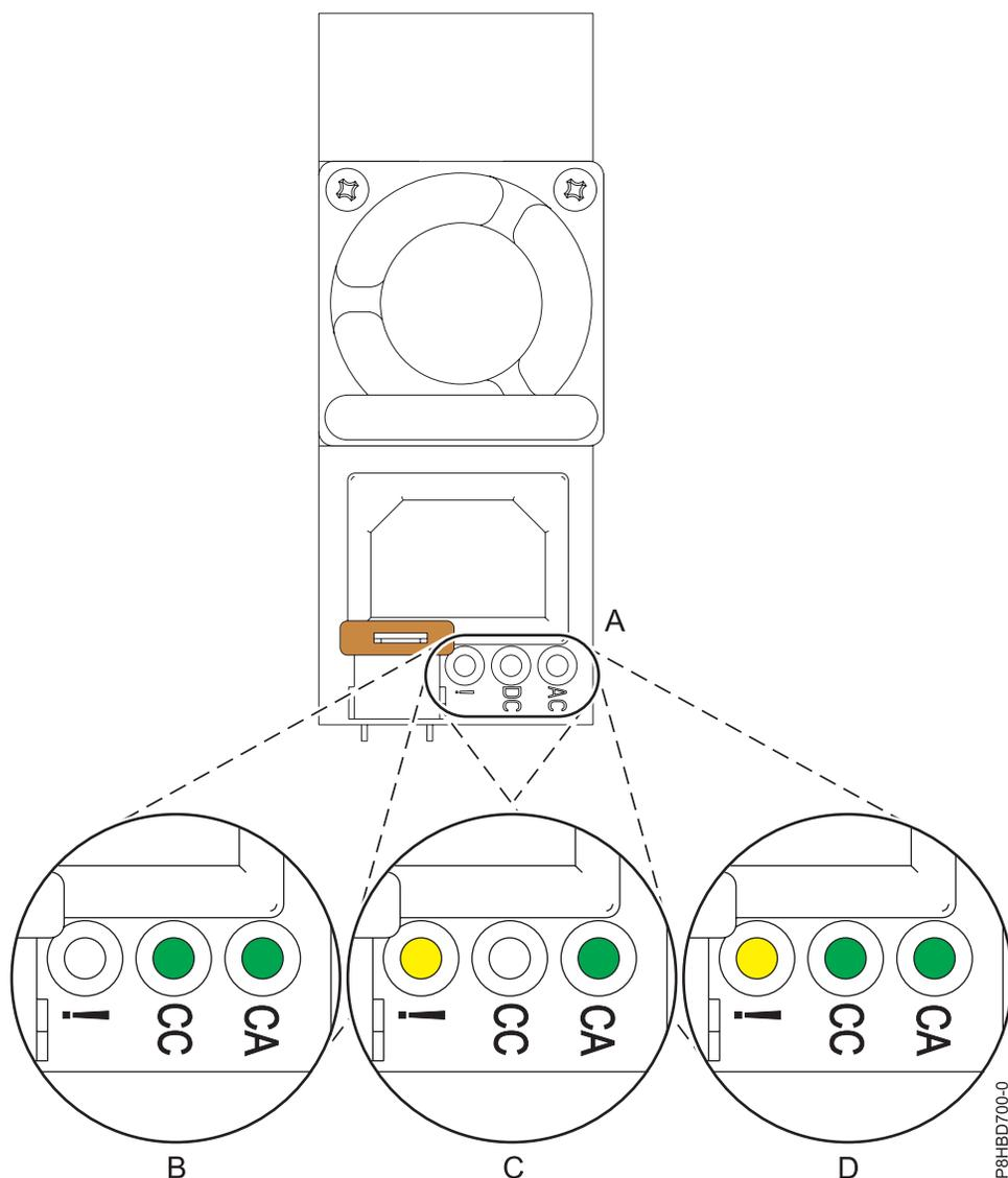
Figure 18. Voyants pour un bloc d'alimentation opérationnel et défaillant dans un système autonome
