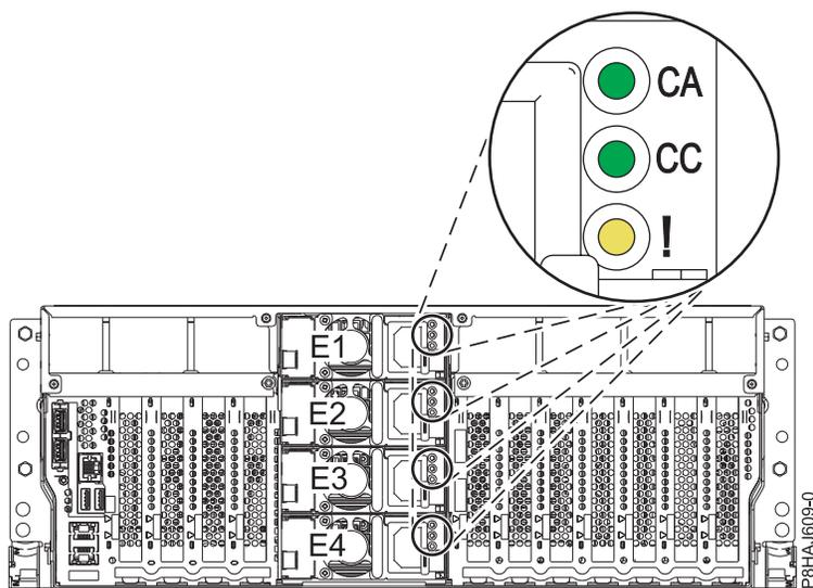
Figure 13. Emplacement des blocs d'alimentation et des voyants dans un système monté en armoire
