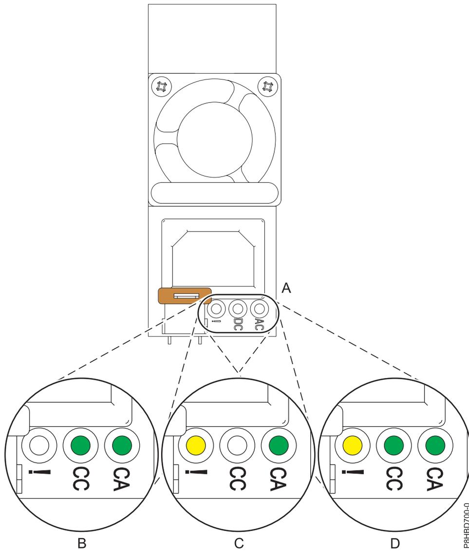
Figure 16. Voyants pour un bloc d'alimentation opérationnel et défaillant dans un système autonome
