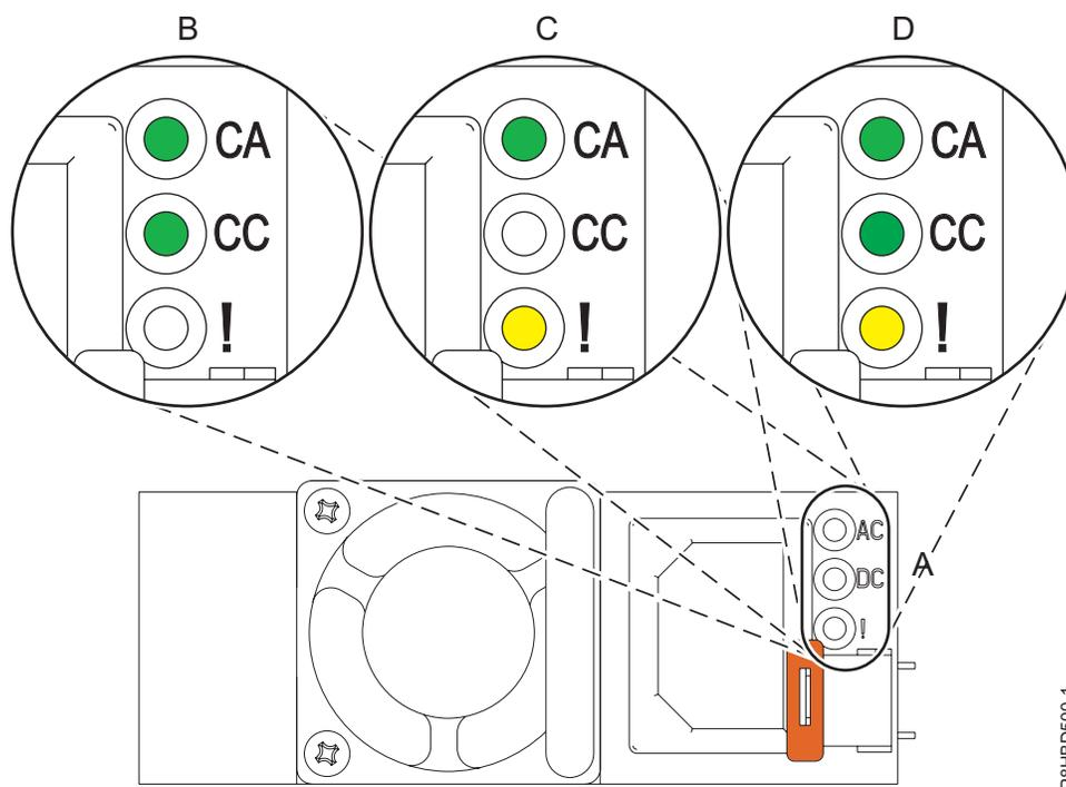
Figure 3. Voyants pour un bloc d'alimentation opérationnel et défaillant dans un système monté en armoire
