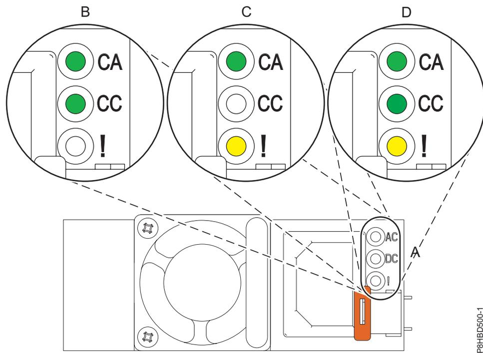
Figure 15. Voyants pour un bloc d'alimentation opérationnel et défaillant dans un système monté en armoire
