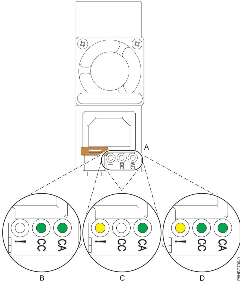
Figure 12. Voyants pour un bloc d'alimentation opérationnel et défaillant dans un système autonome
