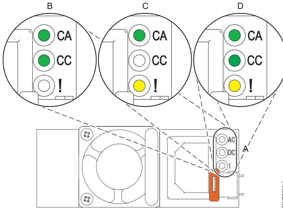
Figure 23. Voyants pour un bloc d'alimentation opérationnel et défectueux dans un système monté en armoire
