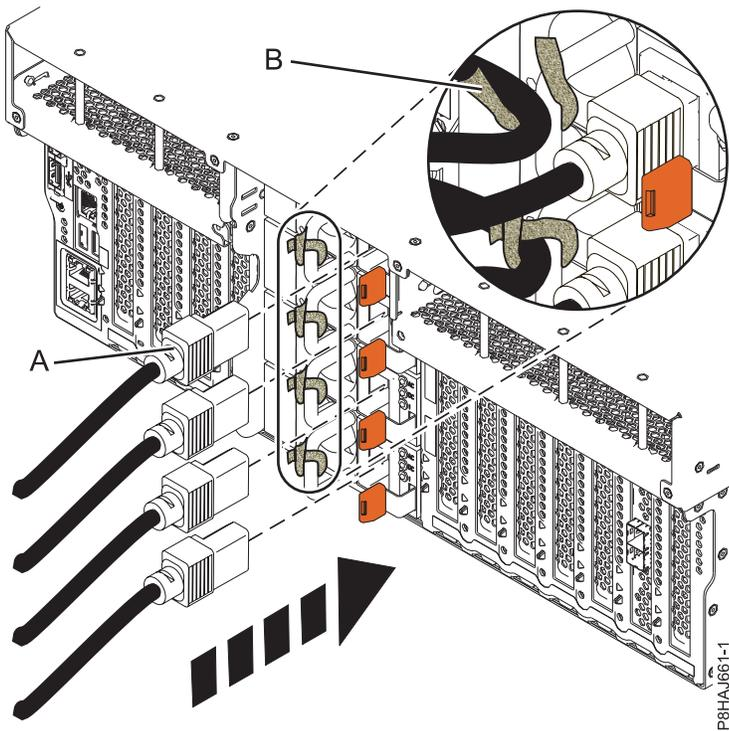
Figure 36. Connexion des cordons d'alimentation à un système 8247-42L, 8286-41A ou 8286-42A
