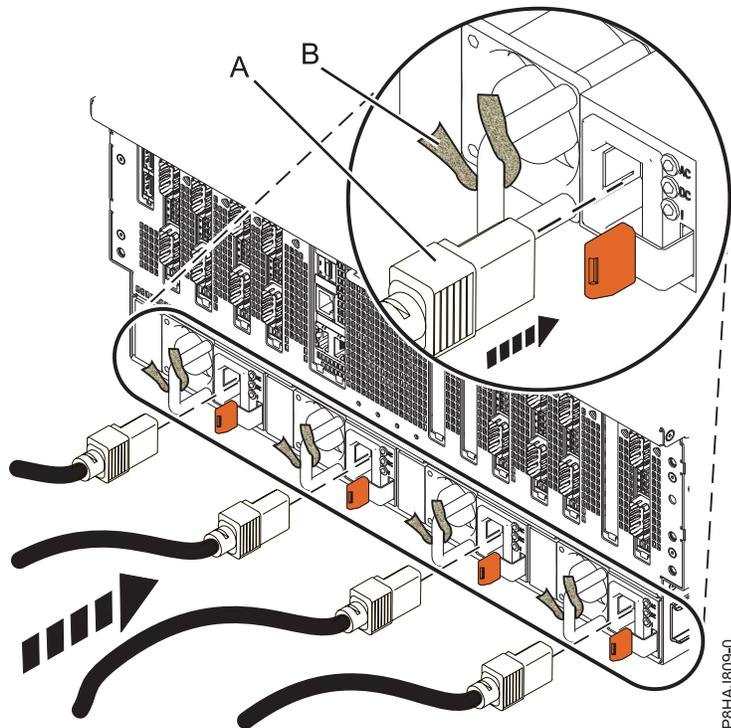
Figure 38. Connexion des cordons d'alimentation à un système 8408-44E ou 8408-E8E
