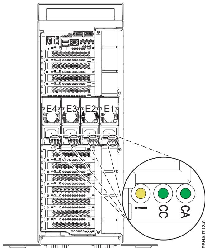
Figure 14. Emplacement des blocs d'alimentation et des voyants dans un système autonome
