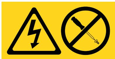
**DANGER :** Présence de tensions ou de niveaux d'énergie dangereux dans tout composant sur lequel cette étiquette est apposée. N'ouvrez aucun capot ou panneau sur lequel figure cette étiquette. (L001)
