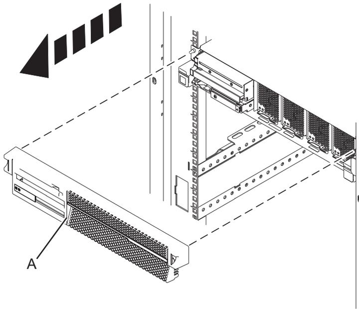
Figure 40. Retrait du capot avant de l'unité de contrôle système
