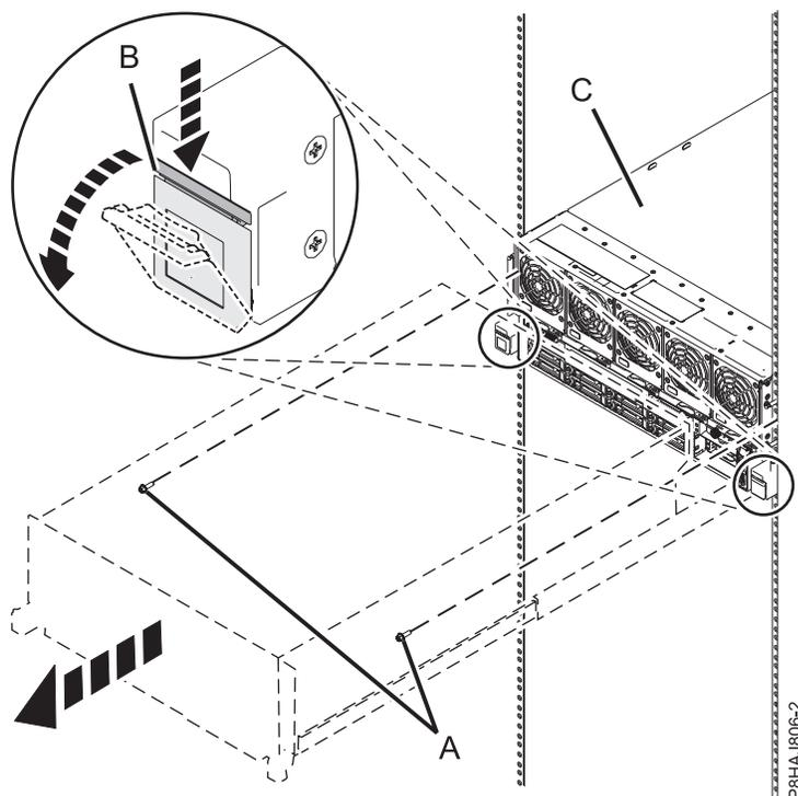
Figure 46. Mise en position de maintenance du système
