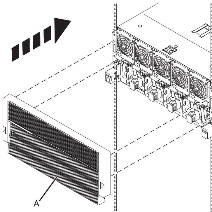
Figure 41. Installation du capot avant
