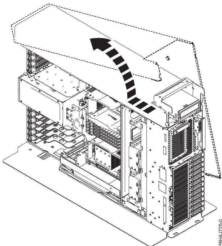
Figure 14. Retrait du capot latéral du système 8286-41A
