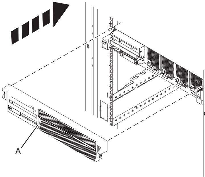
Figure 42. Installation du capot avant de l'unité de contrôle système
