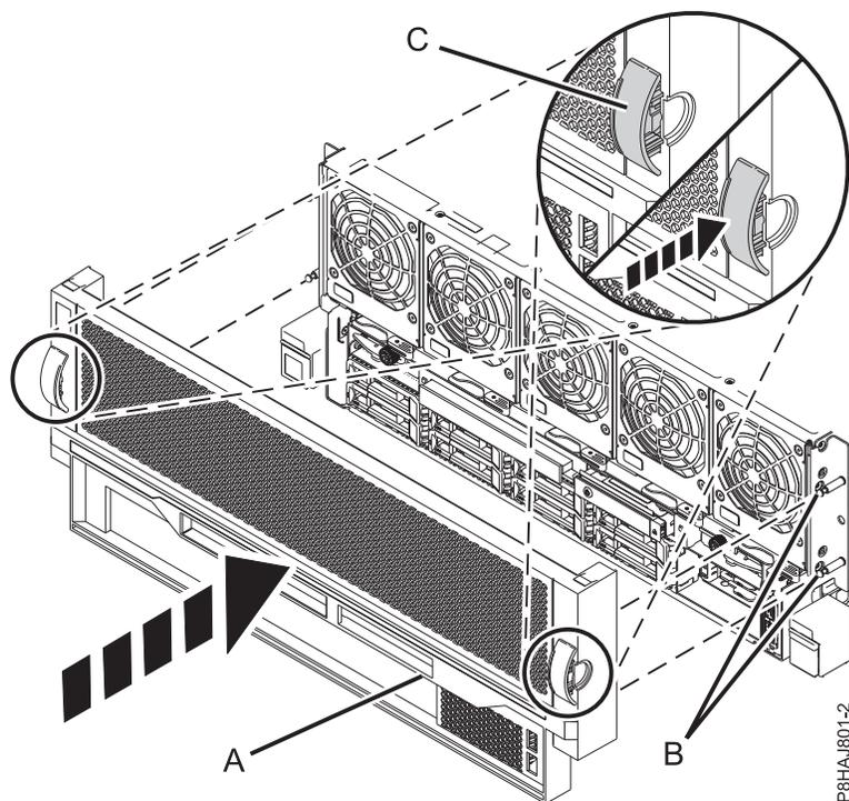
Figure 32. Installation du capot avant
