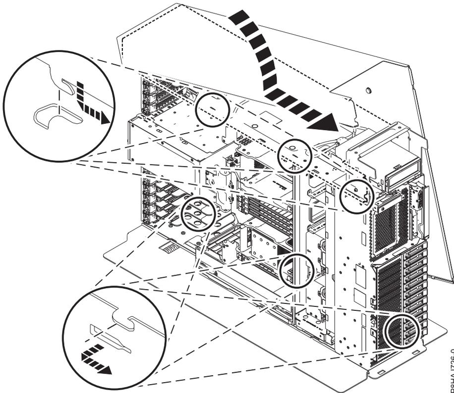
Figure 21. Installation du capot latéral du système 8286-41A
