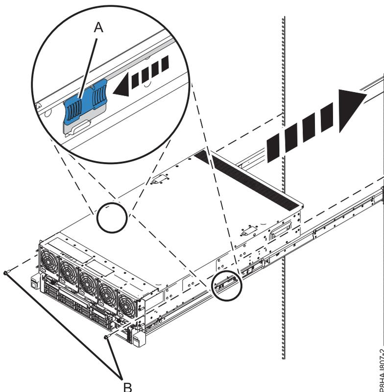
Figure 47. Mise en position de fonctionnement du système
