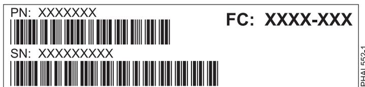
Figure 20. Exemple d'étiquette sur une unité centrale ou une unité d'extension
