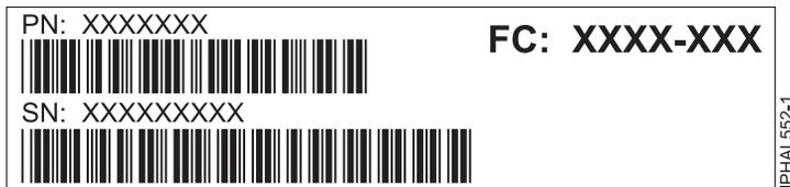
Figure 35. Exemple d'étiquette sur une unité centrale ou une unité d'extension
