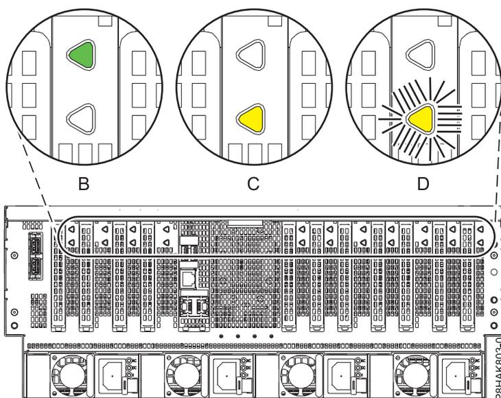
Figure 20. Emplacement des voyants de carte PCIe sur le système 8408-44E ou 8408-E8E
