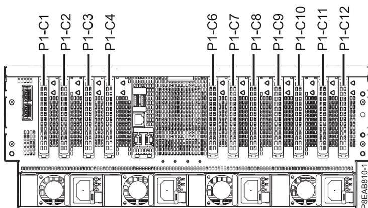
Figure 9. Emplacements de carte PCIe sur le système 8408-44E ou 8408-E8E
