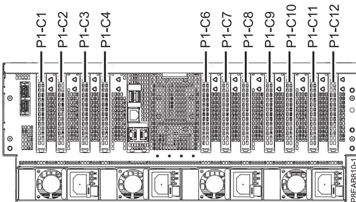
Figure 1. Emplacements de carte PCIe sur le système 8408-44E ou 8408-E8E
