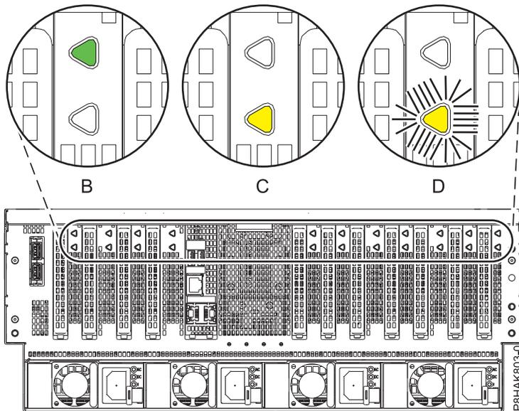
Figure 10. Emplacement des voyants de carte PCIe sur le système 8408-44E ou 8408-E8E
