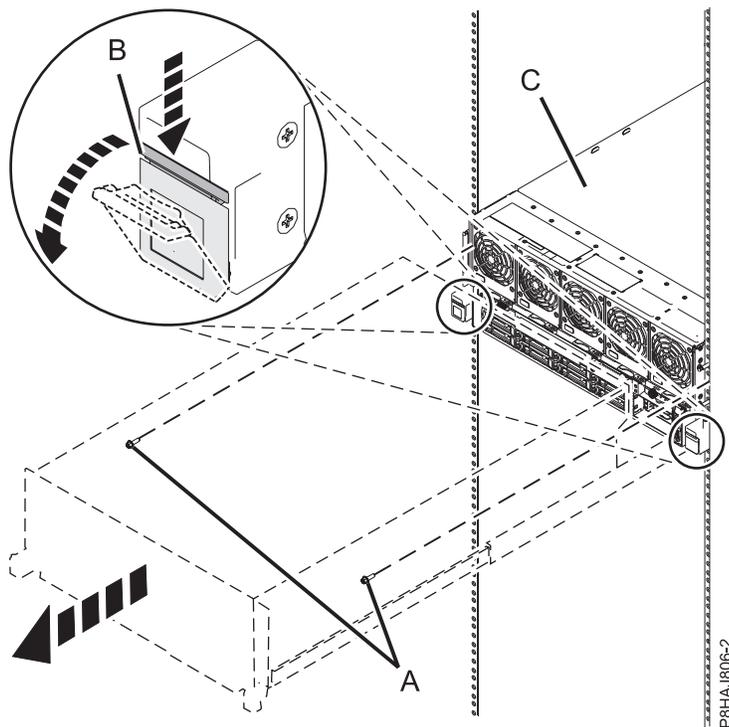
Figure 44. Mise en position de maintenance du système
