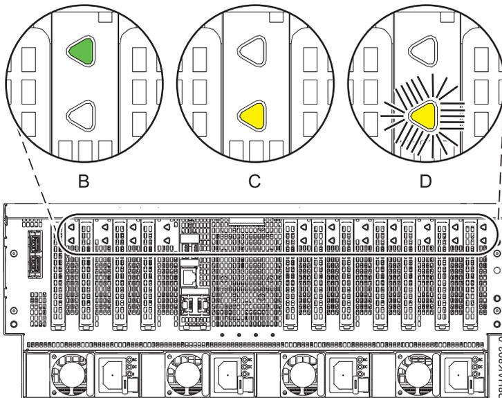
Figure 2. Emplacement des voyants de carte PCIe sur le système 8408-44E ou 8408-E8E
