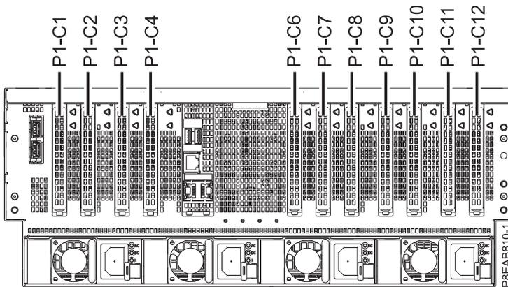
Figure 5. Emplacements de carte PCIe sur le système 8408-44E ou 8408-E8E
