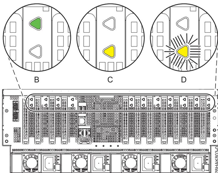
Figure 14. Emplacement des voyants de carte PCIe sur le système 8408-44E ou 8408-E8E
