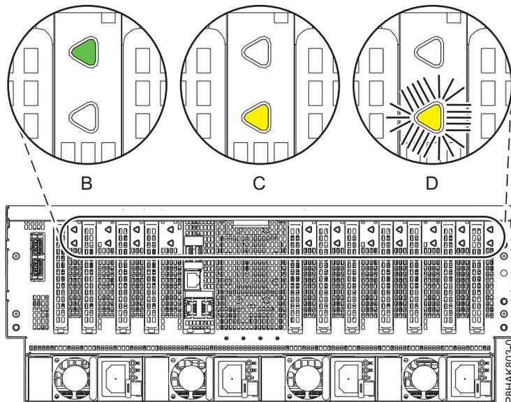
Figure 25. Emplacement des voyants de carte PCIe sur le système 8408-44E ou 8408-E8E
