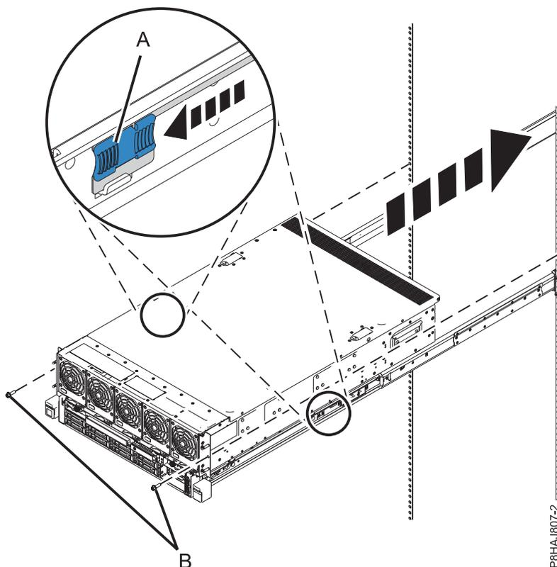
Figure 45. Mise en position de fonctionnement du système
