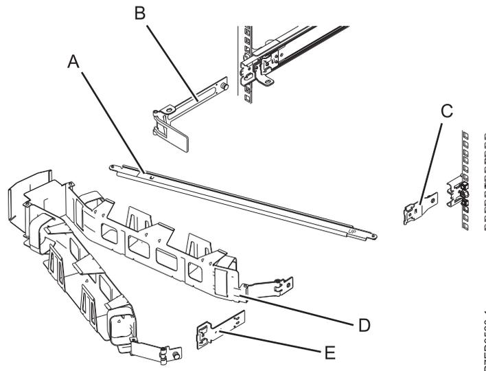
Figure 8. Positionnement relatif des parties du bras de routage des câbles avant assemblage
