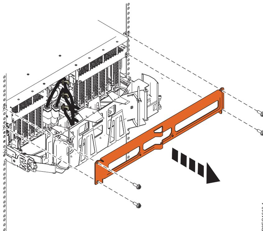
Figure 16. Retrait du support de transport de l'arrière du châssis
