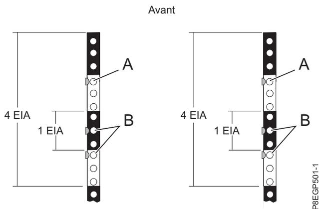
Figure 2. Marquage des emplacements d'installation à l'avant
