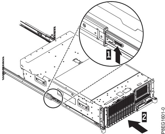
Figure 7. Taquets de déverrouillage et serveur
