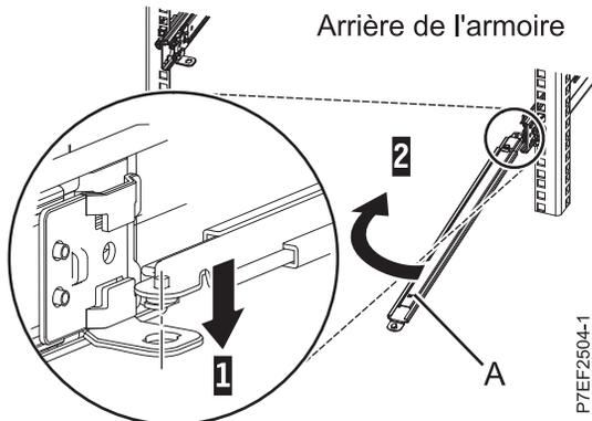
Figure 9. Connexion du bras de support
