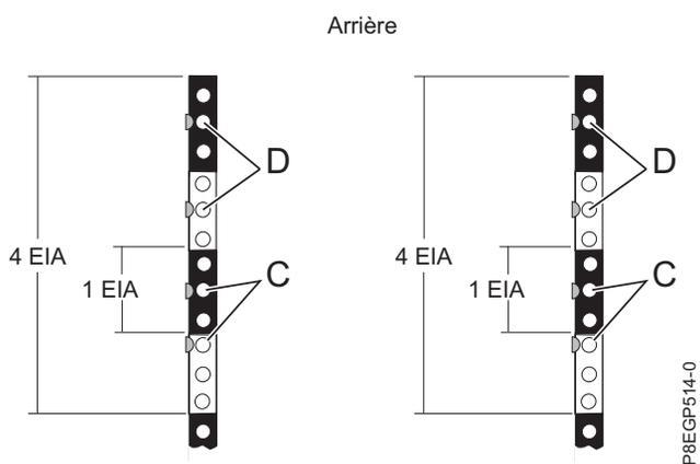
Figure 3. Marquage des emplacements d'installation à l'arrière
