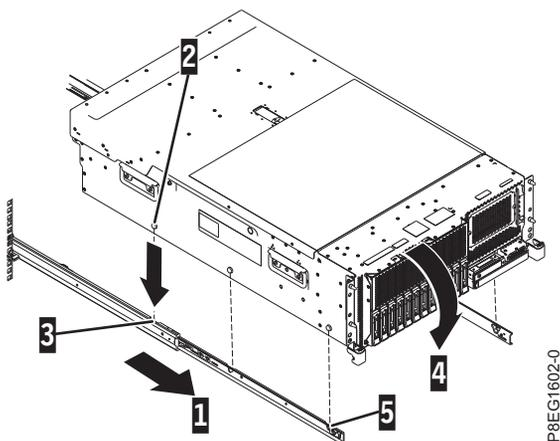
Figure 6. Extension des glissières et alignement des têtes de clou du serveur sur les logements de la glissière
