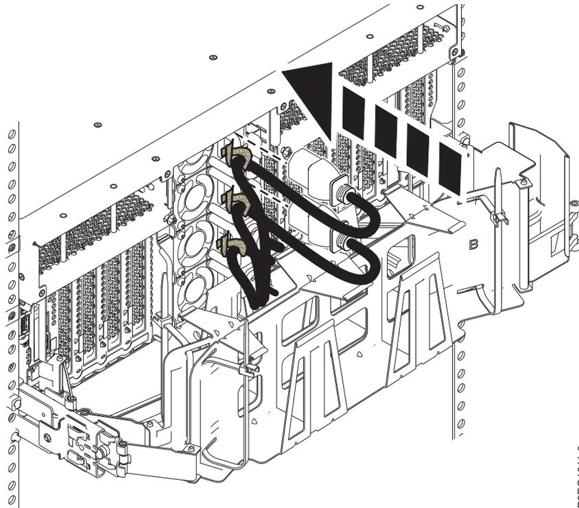
Figure 17. Branchement des cordons d'alimentation aux blocs d'alimentation et connexion des câbles aux poignées des blocs d'alimentation
