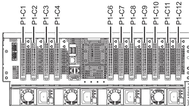
Figure 1. Vue arrière d'un système 8408-44E ou 8408-E8E avec codes d'emplacement PCIe
