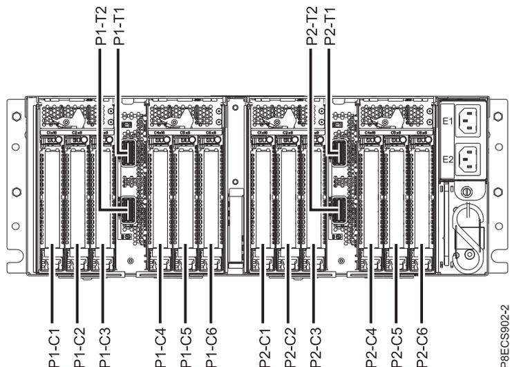
Figure 2. Vue arrière d'un tiroir d'extension EMX0 PCIe3 avec les codes d'emplacement PCIe
